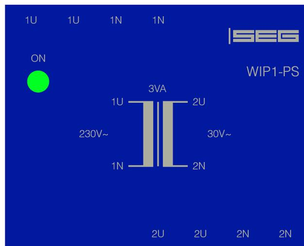
**ZUSATZSPANNUNGSVERSORGUNG FÜR DAS SCHUTZGERÄT WIP1-2/3**
