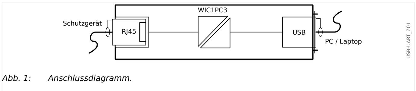
Abb. 1: Anschlussdiagramm.
