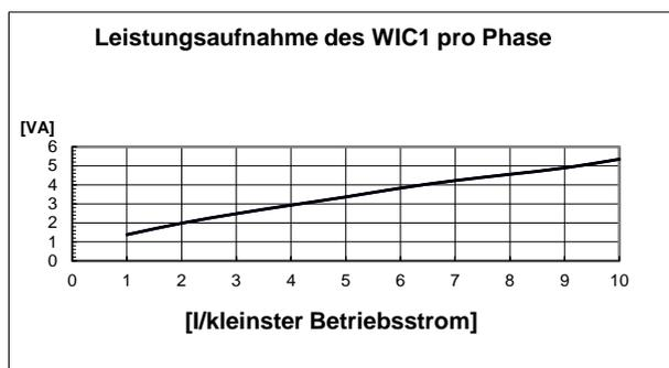
Abbildung 7.2: Leistungsaufnahme einer Phase über den Bereich 1,0 bis 10 kleinsten Betriebsstrom
