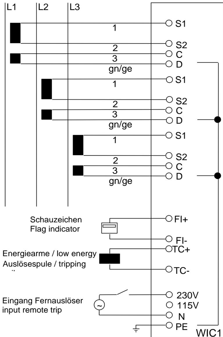
Abbildung 3.1: Anschlussdiagramm WIC1
