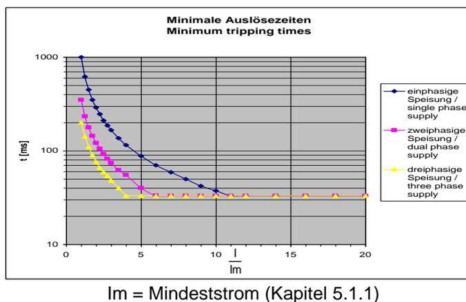
Mit dem WIC1-Schutzsystem sind minimale Auslösezeiten von 40 ms erreichbar.
