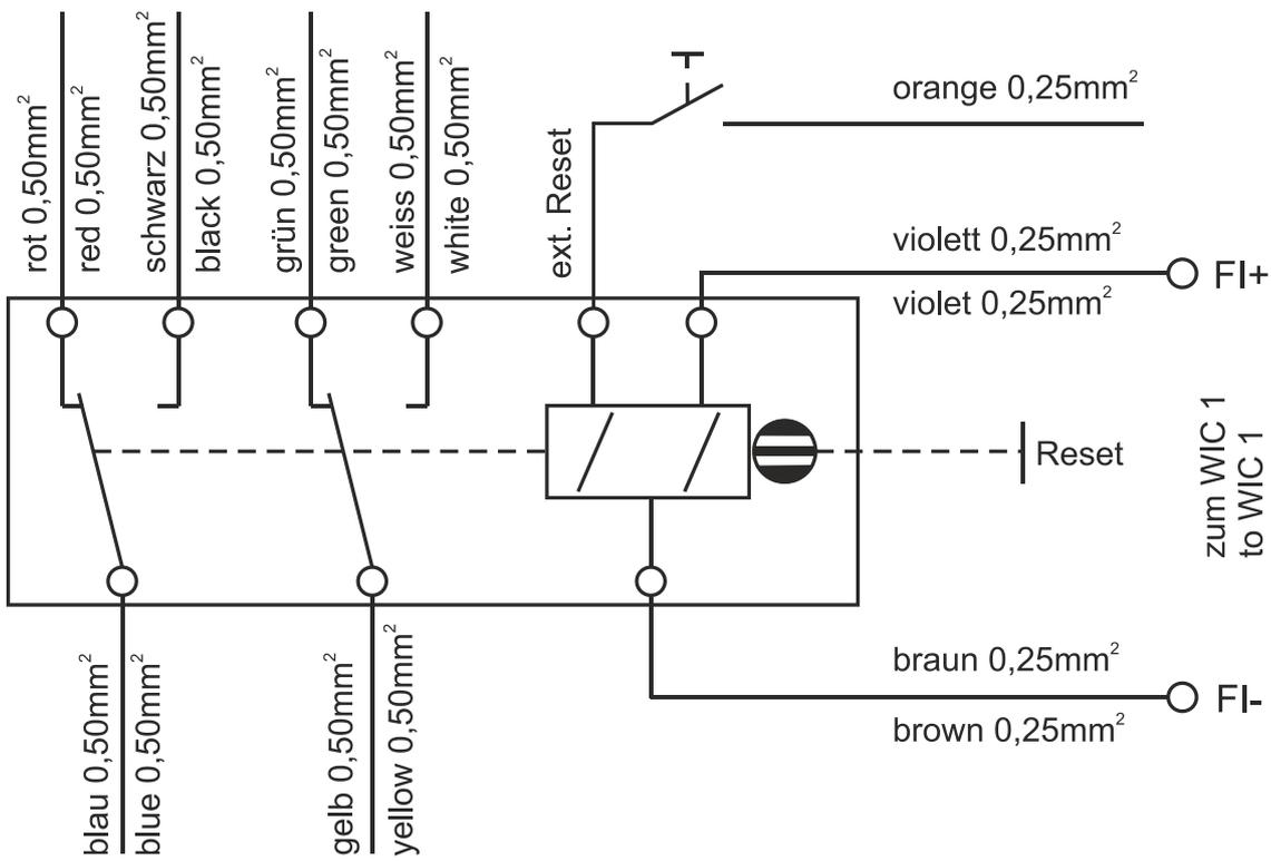
Abbildung 3.3: Anschlussdiagramm WI-SZ5 Schauzeichen
