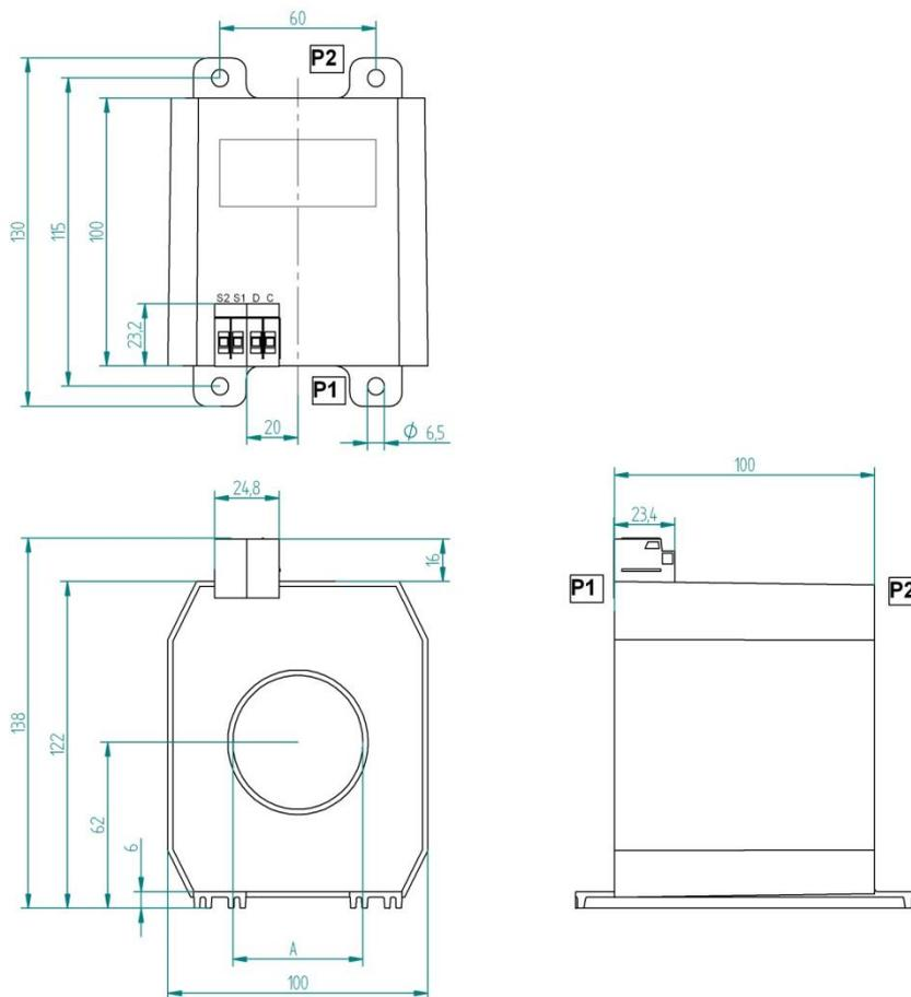
Figure 4.3: Typ WIC1W2AS1 – WIC1W5AS1 für Montageplattenaufbau
