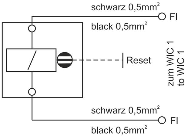
Abbildung 3.2: Anschlussdiagramm WI-SZ4 Schauzeichen
