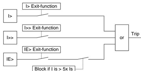
Theoretisch kann die  $I>$  Überstromstufe und die  $I>>$  Kurzschlussstufe deaktiviert sein. Ist die  $I>$  Überstromstufe deaktiviert und die  $I>>$  Kurzschlussstufe auf 5 x  $I_S$  eingestellt, kann die Erdstromstufe nicht auslösen, wenn der tatsächlich gemessene Phasenstrom 5 x  $I_S$  beträgt.
