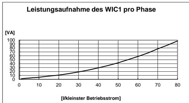
Abbildung 7.1: Leistungsaufnahme einer Phase über den gesamten Messbereich des WIC1
