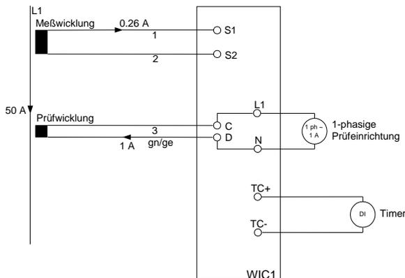
Abbildung 7.3: Anschluss einer 1-phasigen Prüfeinrichtung
