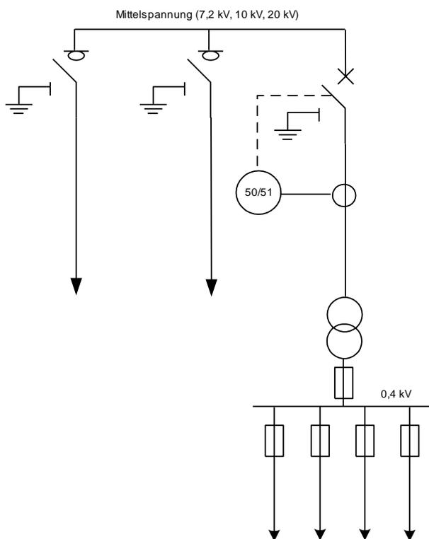
Abbildung 6.1: Prinzipschaltbild einer typischen Schaltanlage mit 2 Einspeisefeldern und einem Transformatorabgangsfeld.
