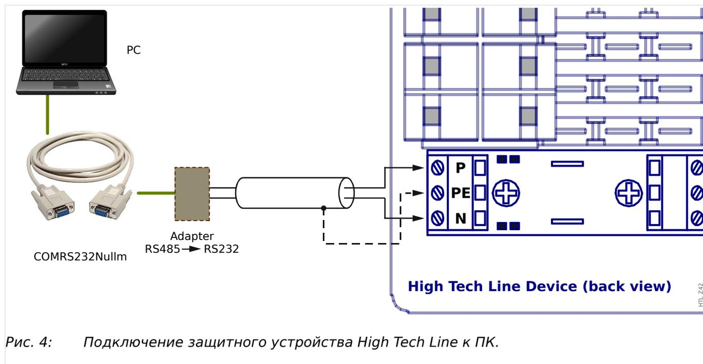
Рис. 4: Подключение защитного устройства High Tech Line к ПК.
