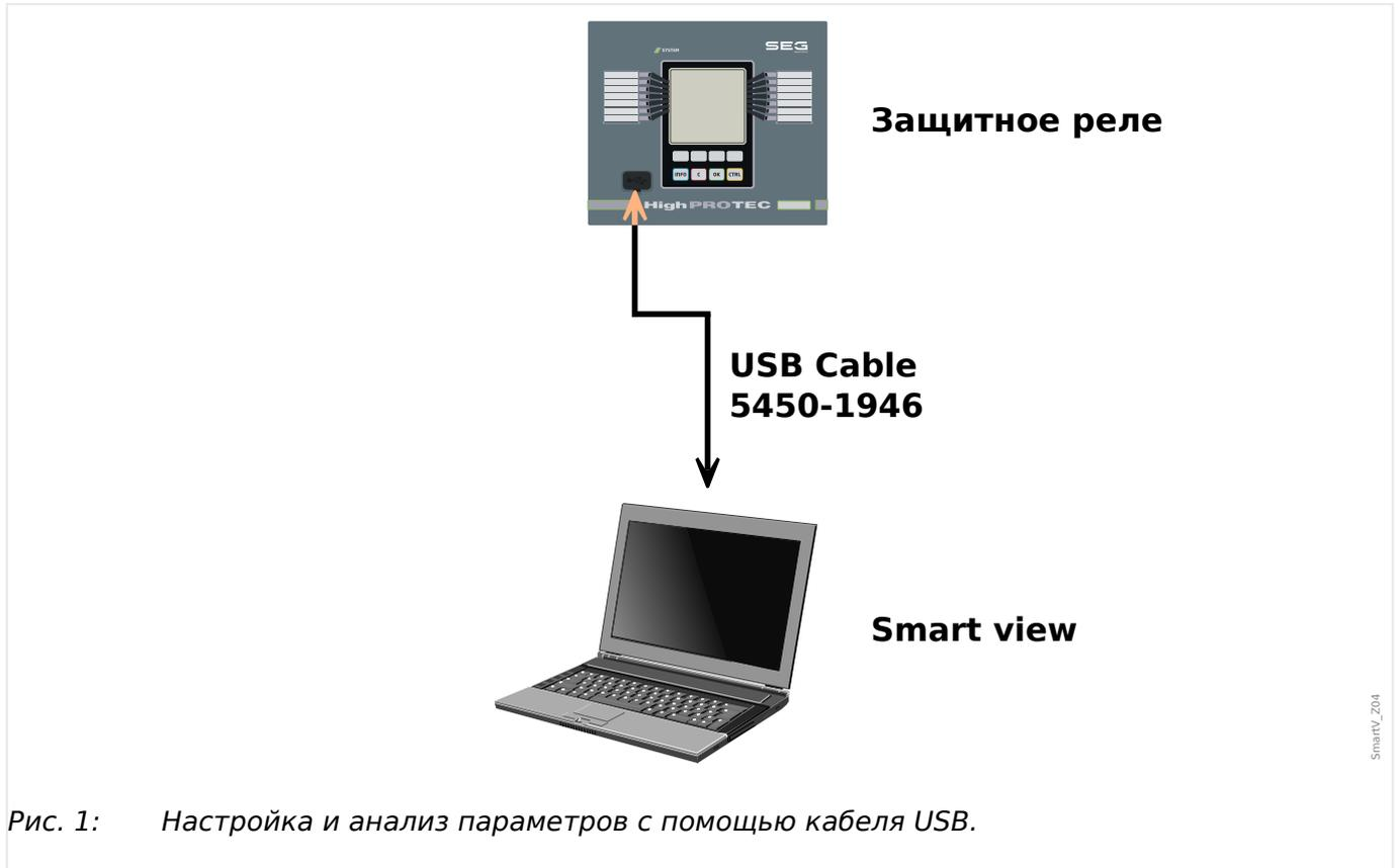
Рис. 1: Настройка и анализ параметров с помощью кабеля USB.
