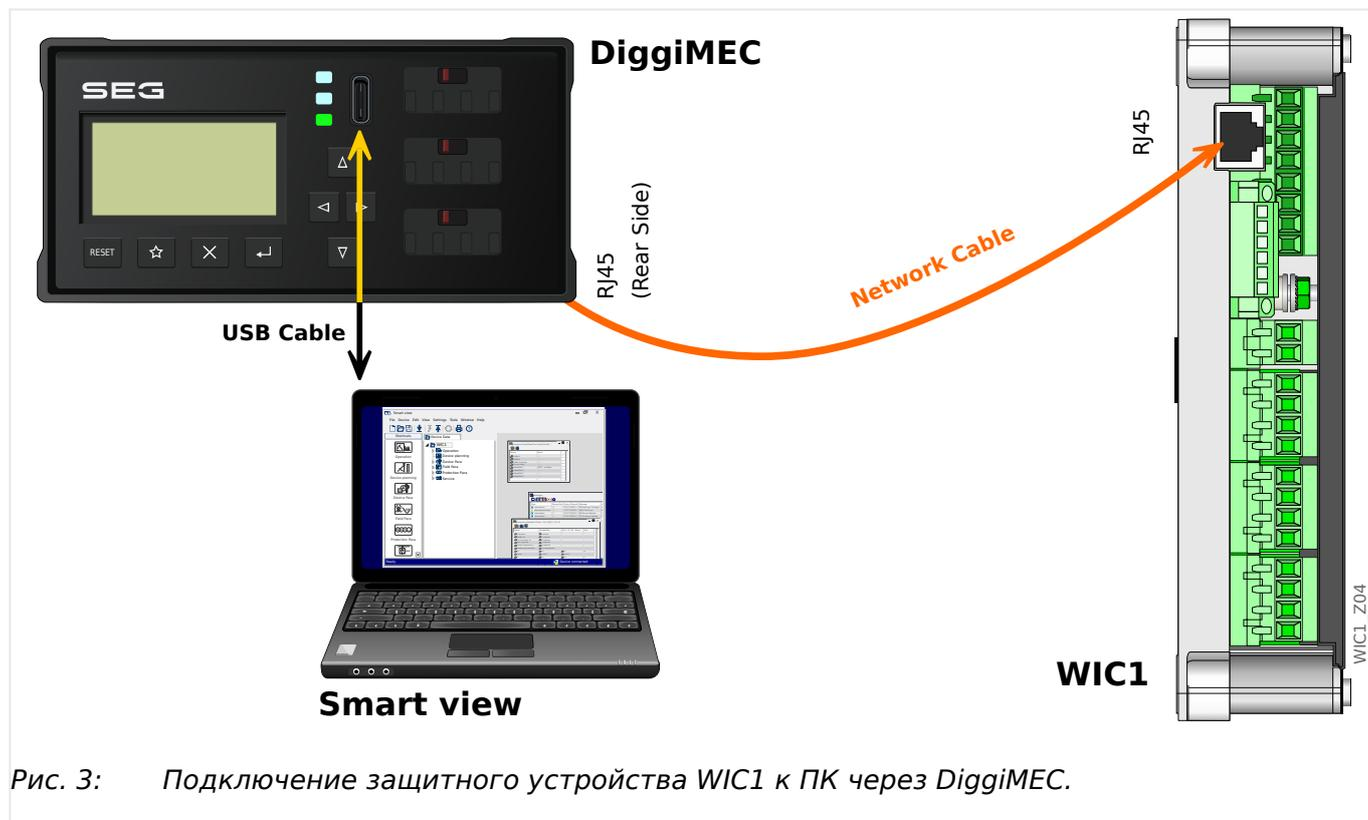
Рис. 3: Подключение защитного устройства WIC1 к ПК через DiggiMEC.
