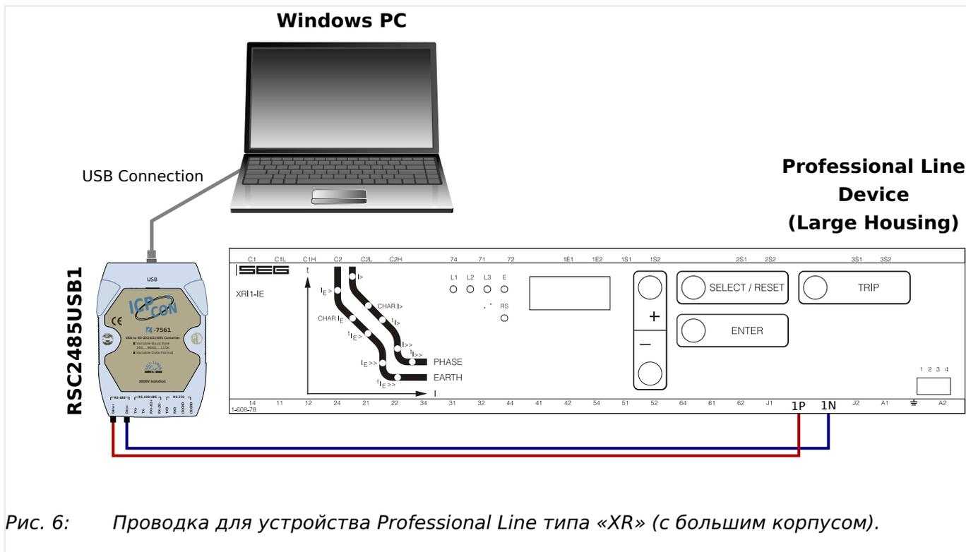
Рис. 6: Проводка для устройства Professional Line типа «XR» (с большим корпусом).
