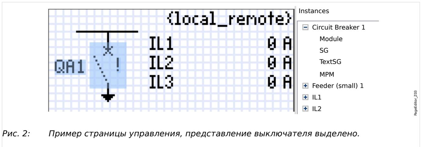
Рис. 2: Пример страницы управления, представление выключателя выделено.
