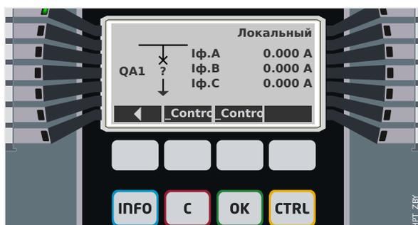
Рис. 4: Пример страницы управления, выключатель в аварийном (недопустимое состояние) положении.
