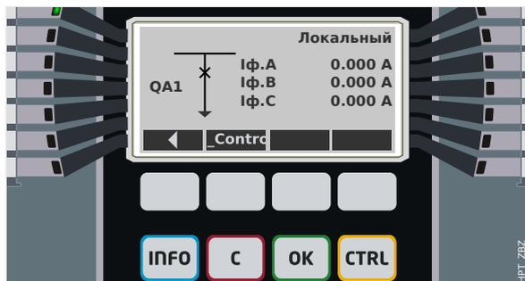
Рис. 3: Пример страницы управления, выключатель в замкнутом положении.
