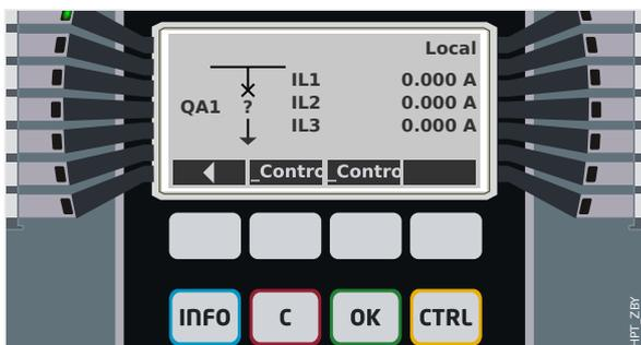
Fig. 4: Ejemplo de página de control, con el circuito en posición de fallo (o improbable).
