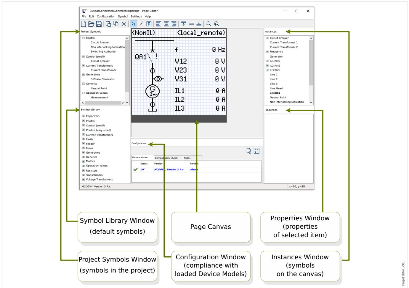
La página de control (diagrama de línea única) se muestra después de presionar la tecla »CTRL« en la HMI del dispositivo de HighPROTEC. Se puede sustituir por otro para adaptarlo a su aplicación. En este contexto, es importante saber lo siguiente:
