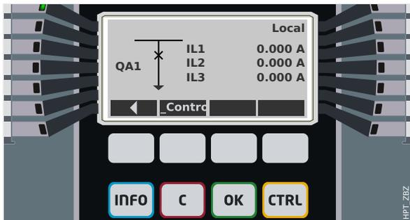
Fig. 3: Ejemplo de página de control, con el circuito en posición cerrada.
