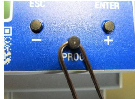
[2.] Diese Taste ist mit einer Bohrung versehen, durch die der Plombierdraht geführt werden kann
