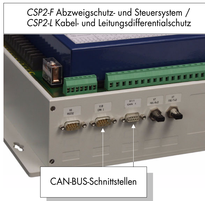
Abbildung 2.42: CSP2: CAN-BUS-Schnittstellen (interner Systembus)
