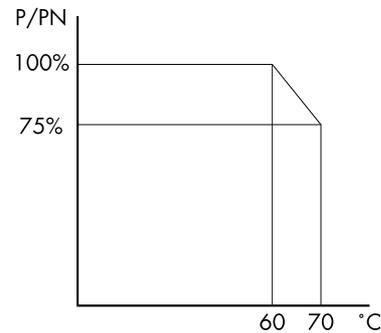
Figura 3.5: Reducción de la potencia de salida
