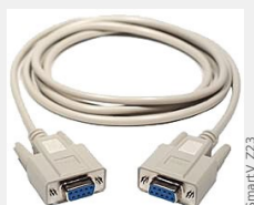
Kabel typu null-modem
