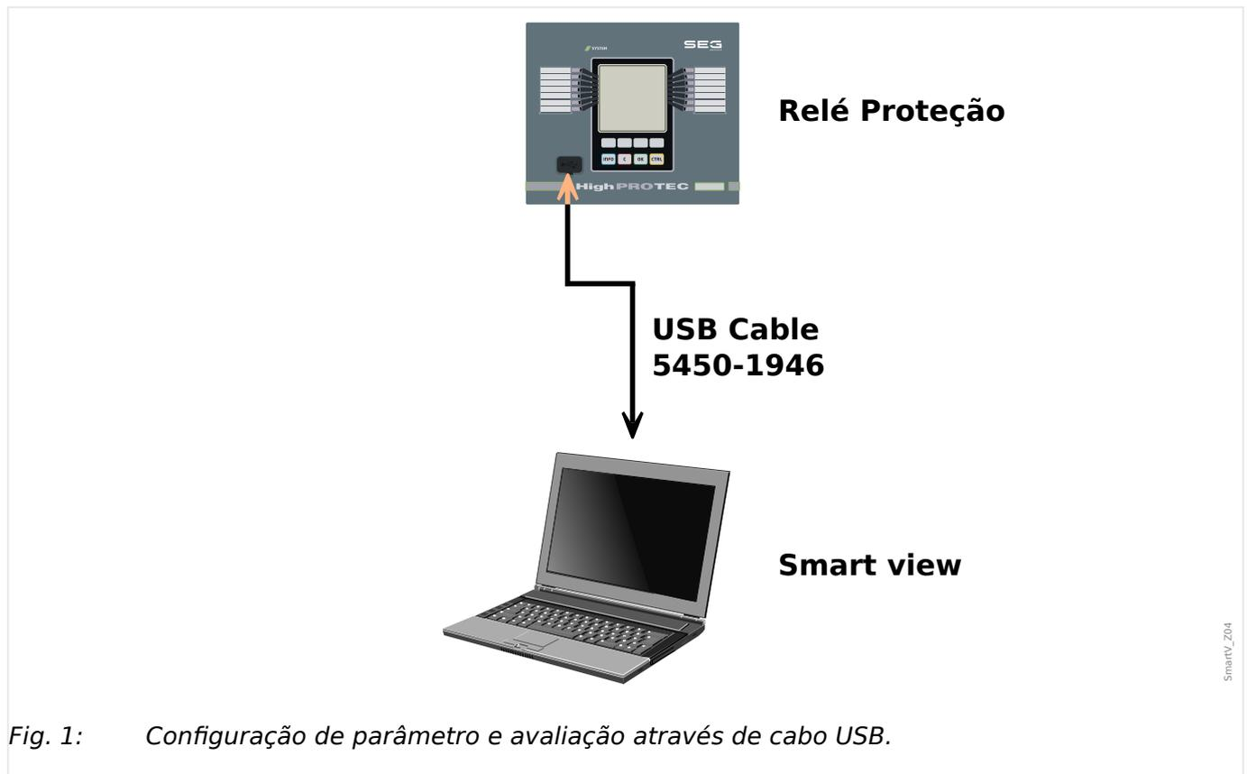
Fig. 1: Configuração de parâmetro e avaliação através de cabo USB.
