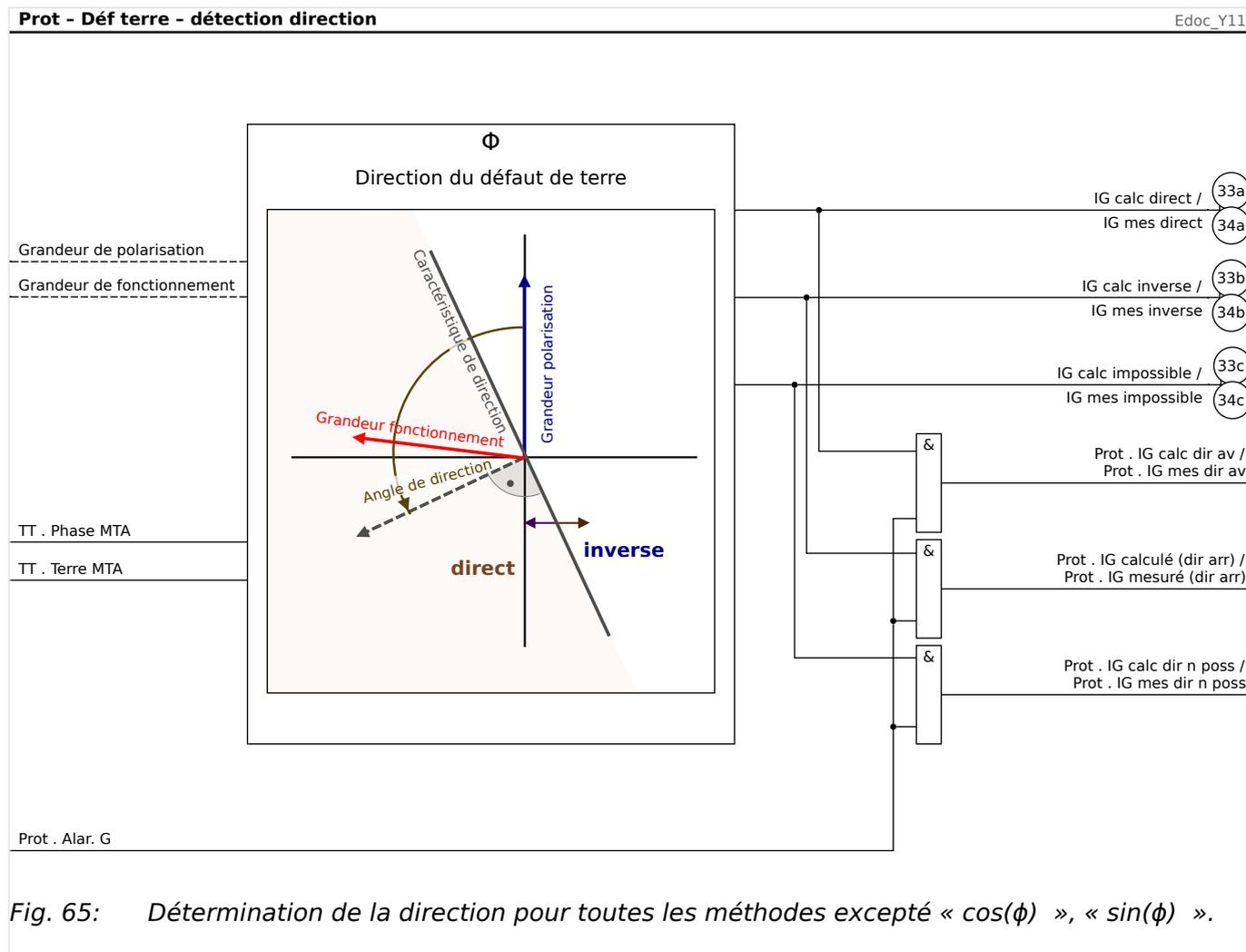
Fig. 65: Détermination de la direction pour toutes les méthodes excepté «  $\cos(\phi)$  », «  $\sin(\phi)$  ».
