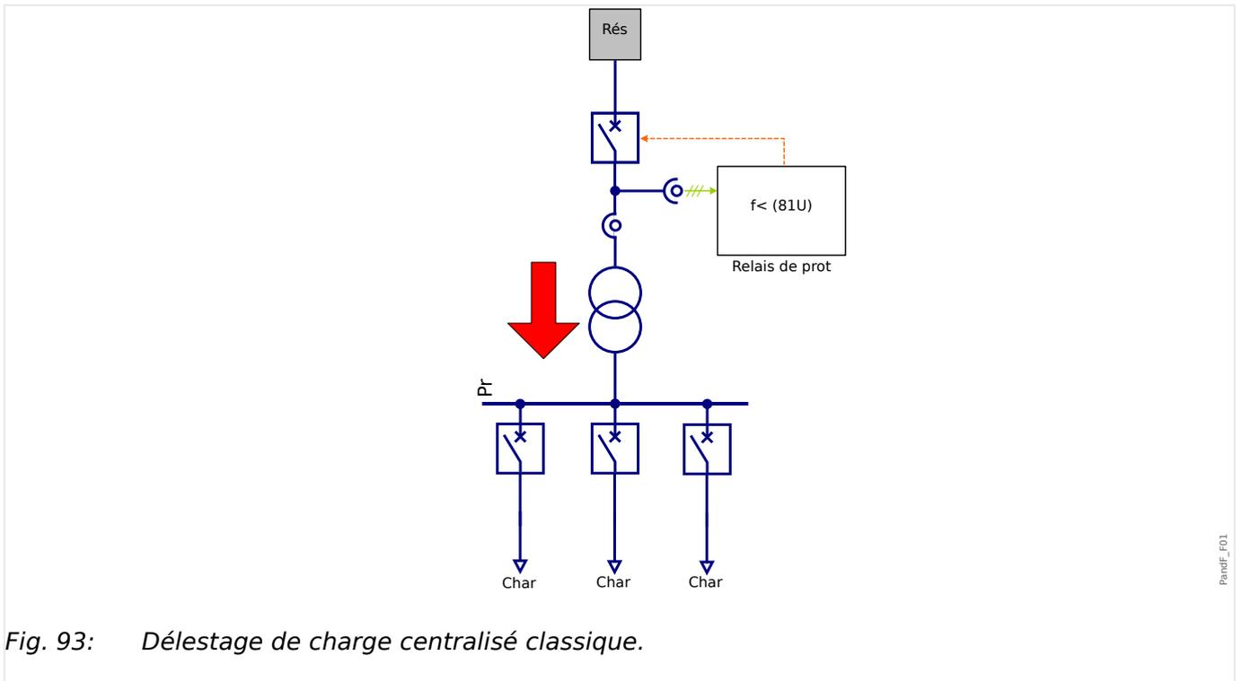
Délestage de charge classique d'un sous-réseau à partir d'un point de connexion central. Le délestage de charge sera initié par sous-fréquence.
