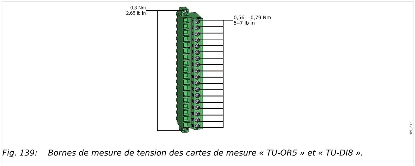
Fig. 139: Bornes de mesure de tension des cartes de mesure « TU-OR5 » et « TU-DI8 ».
