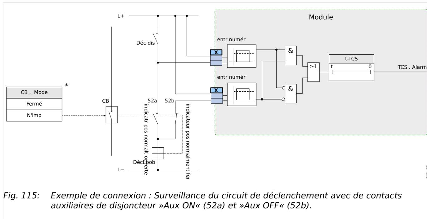
Fig. 115: Exemple de connexion : Surveillance du circuit de déclenchement avec de contacts auxiliaires de disjoncteur »Aux ON« (52a) et »Aux OFF« (52b).
