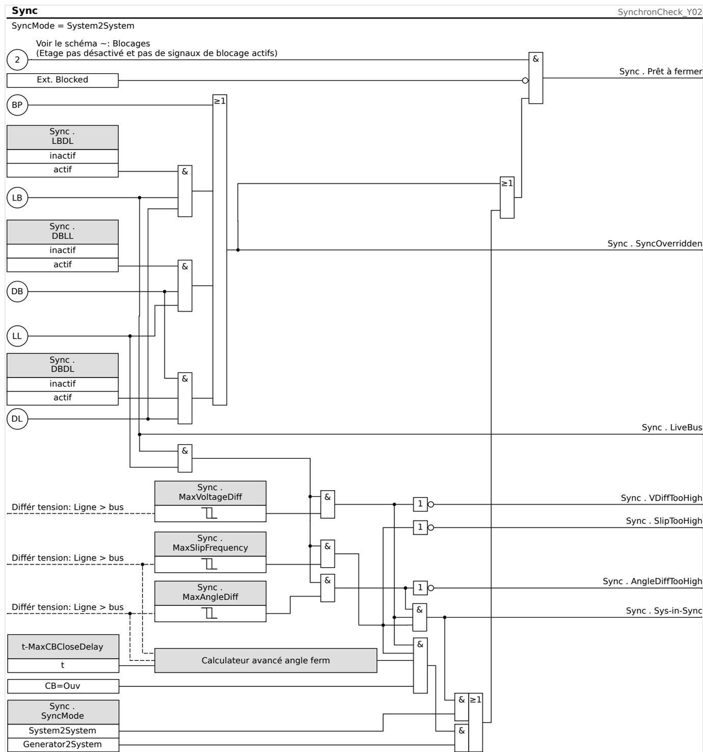
Fig. 112: Fonctionnalité du module «Sync», « System2System ».
