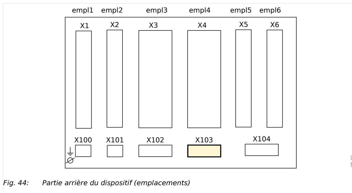
L'interface de communication des données de l'emplacement **X103** dépend du **type de dispositif commandé**. Les fonctions disponibles dépendent du type d'interface de communication des données.
