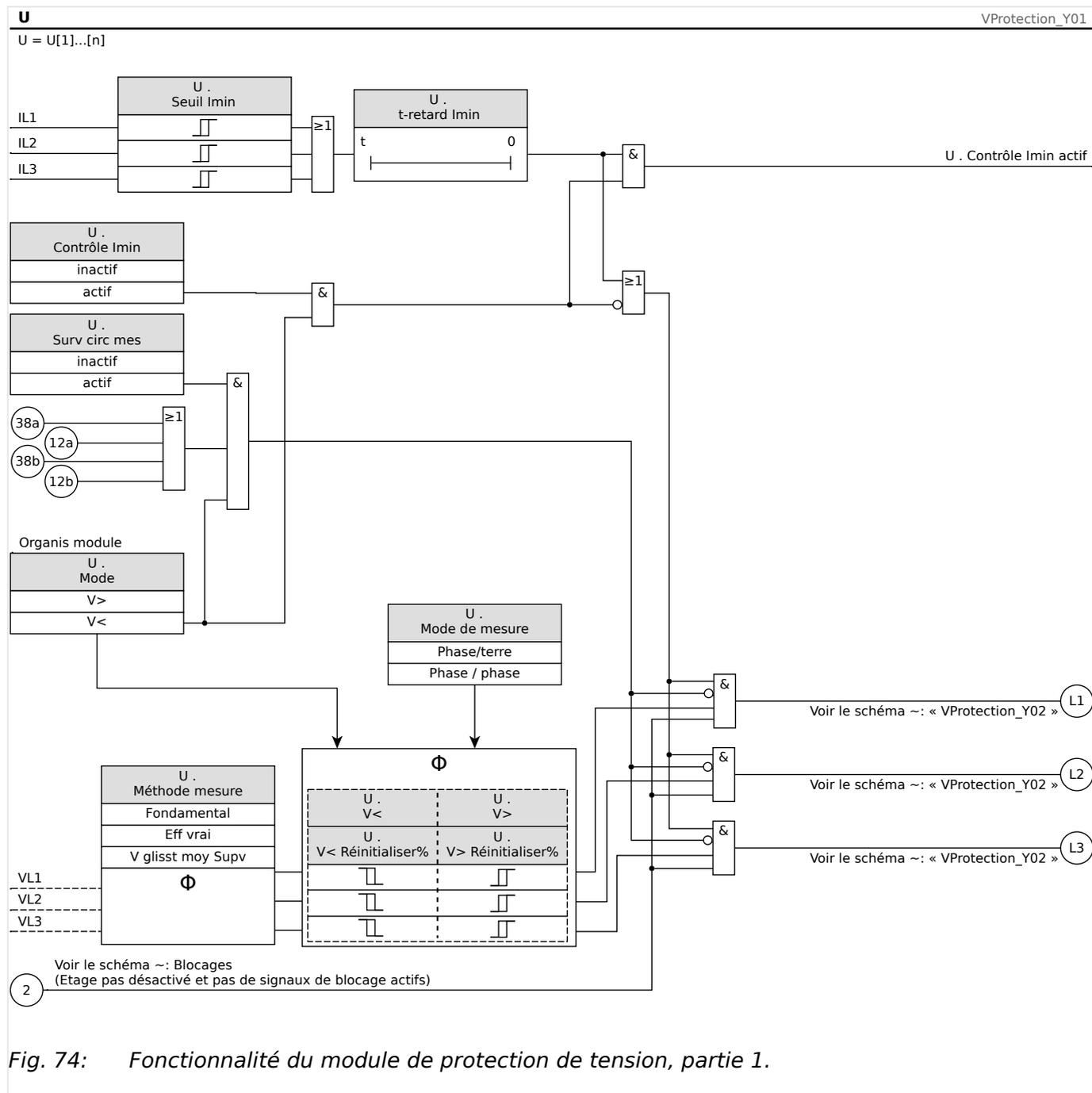
Fig. 74: Fonctionnalité du module de protection de tension, partie 1.
