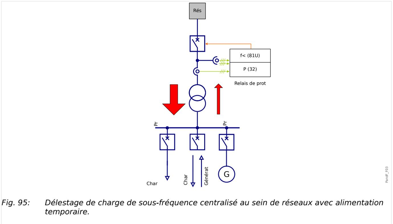
La détection de la direction du flux de puissance (si activée) permet de bloquer le délestage des sous-réseaux en cas de situation de sous-fréquence de ces sous-réseaux qui stabilisent la fréquence. Le sous-réseau sera délesté uniquement s'il diminue la fréquence (en consommant de la puissance active).
