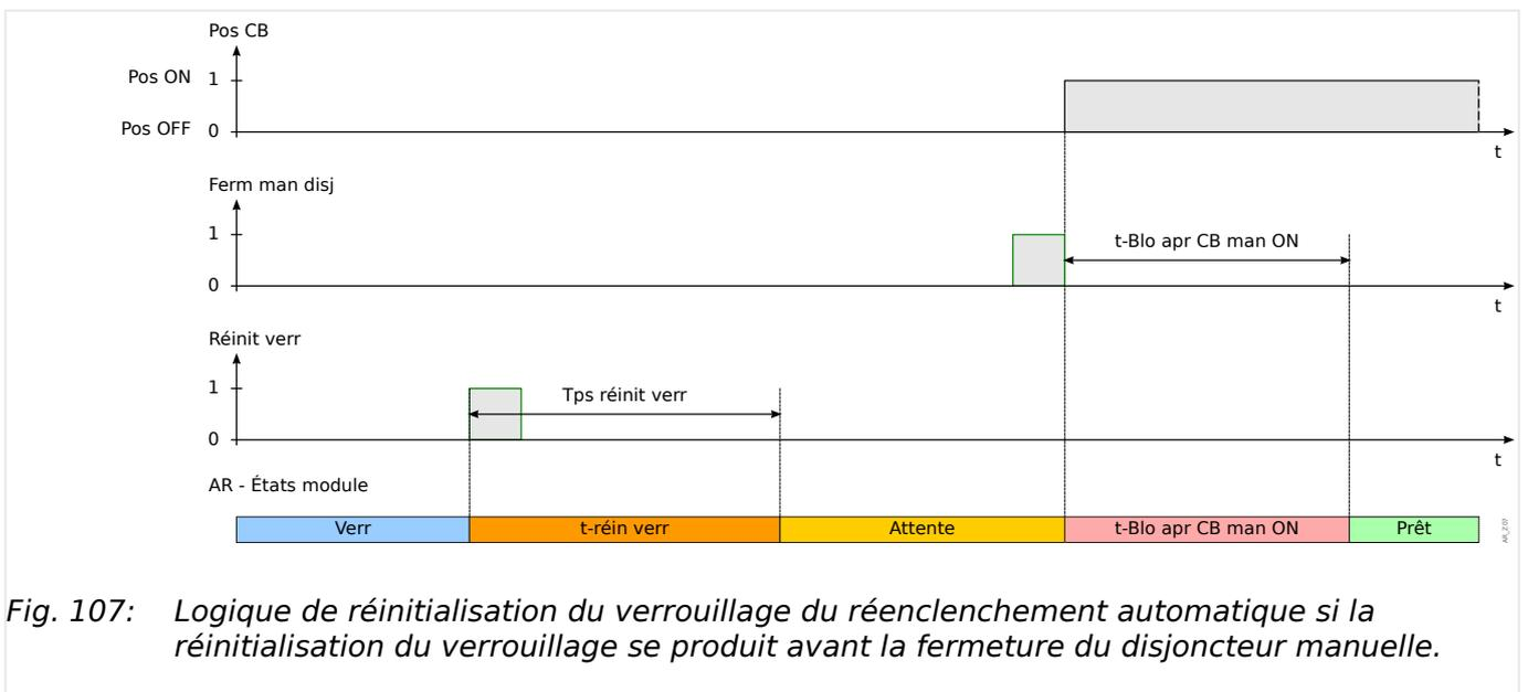
Fig. 107: Logique de réinitialisation du verrouillage du réenclenchement automatique si la réinitialisation du verrouillage se produit avant la fermeture du disjoncteur manuelle.
