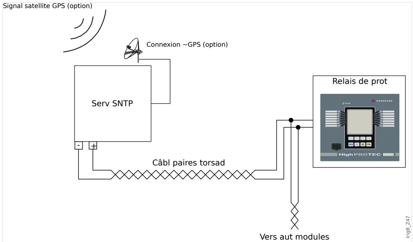
L'emplacement de l'interface IRIG-B dépend du type de module. Reportez-vous au schéma de câblage fourni avec le dispositif de protection.
