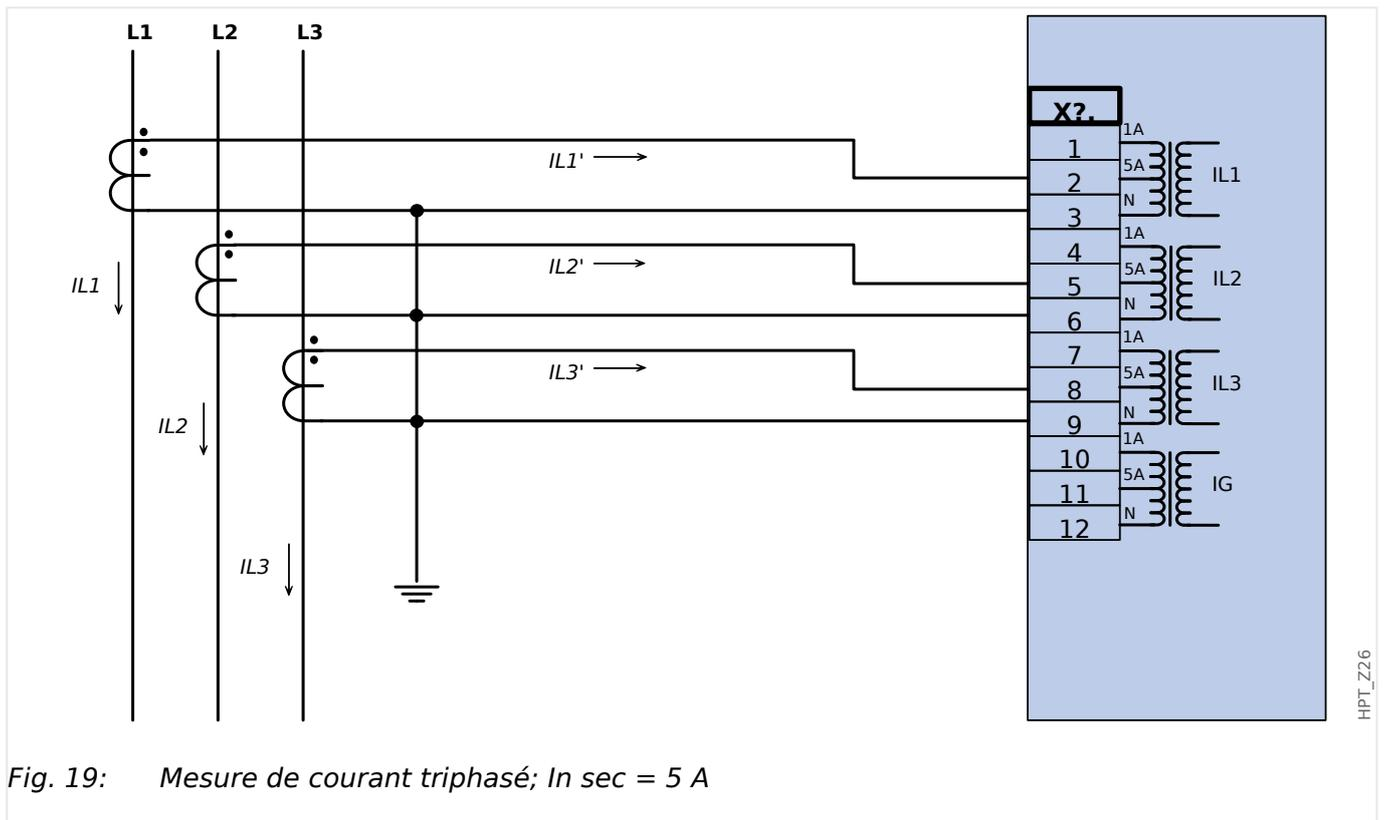
Fig. 19: *Mesure de courant triphasé; In sec = 5 A*
