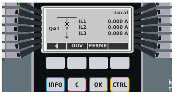
Fig. 120: Exemple de page de contrôle, avec le « disjoncteur » en position de dysfonctionnement (ou invraisemblable).
