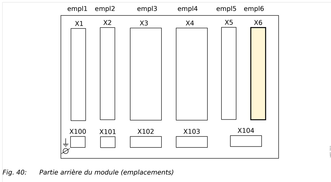
Fig. 40: Partie arrière du module (emplacements)
