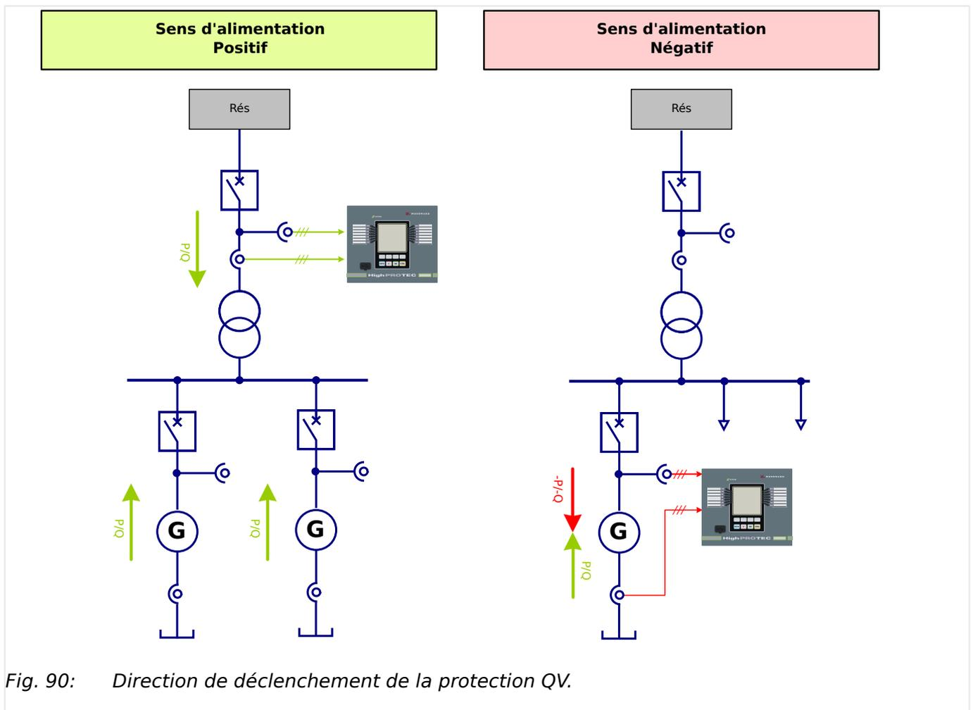
Fig. 90: Direction de déclenchement de la protection QV.
