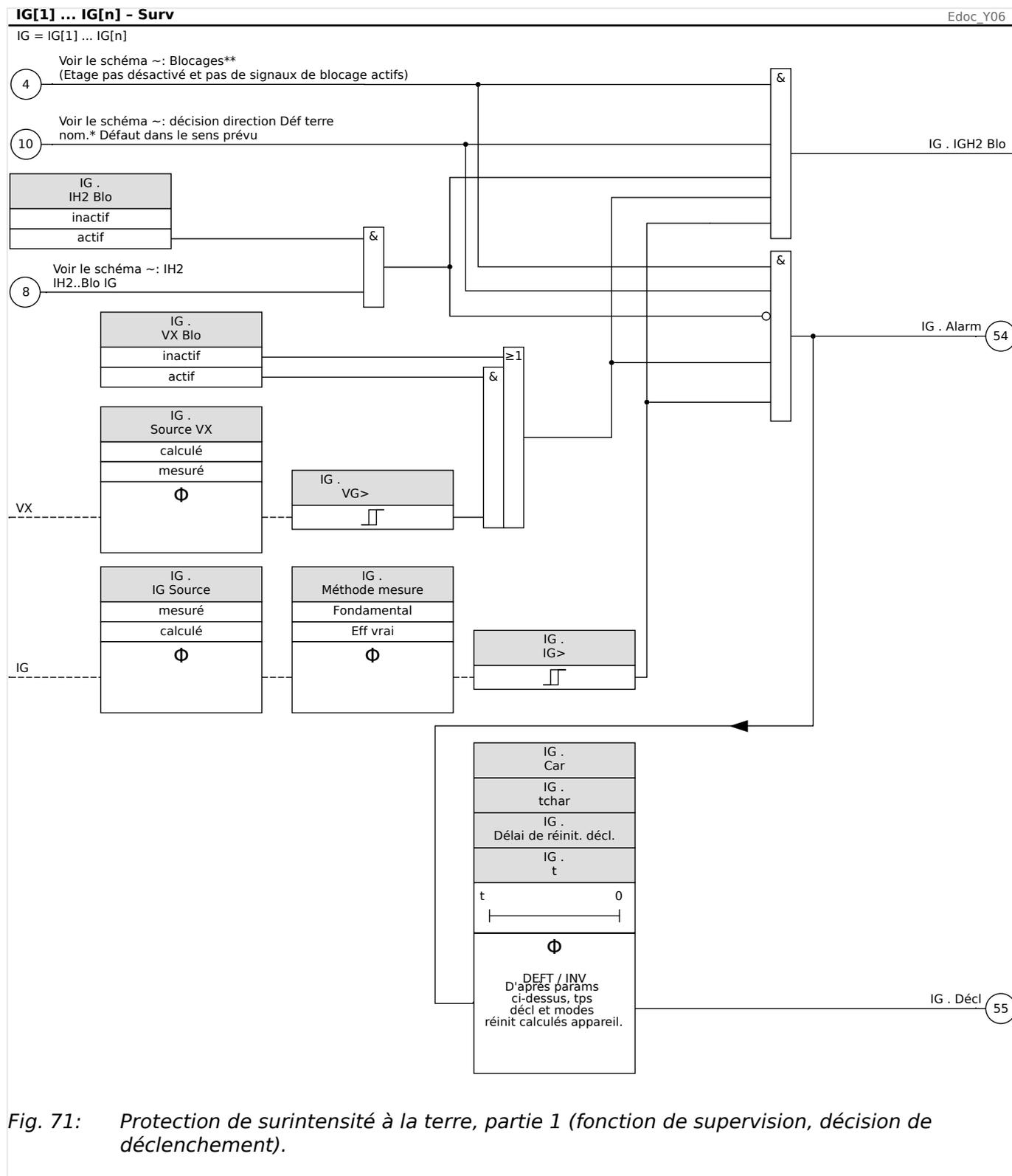
Fig. 71: Protection de surintensité à la terre, partie 1 (fonction de supervision, décision de déclenchement).
