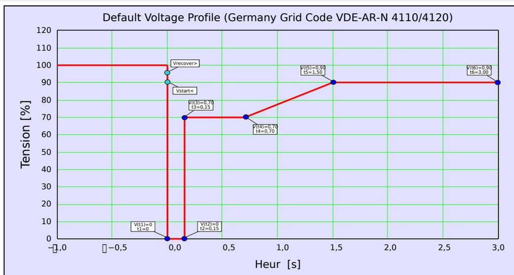
Fig. 80: Profil LVRT prédéfini en usine (Type I).
