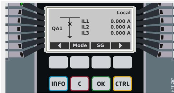
La nouvelle position du dispositif d'appareillage de connexion est affichée (dès qu'elle est atteinte selon le retour de l'indication de position ou une fois le temps de commutation configuré écoulé).
