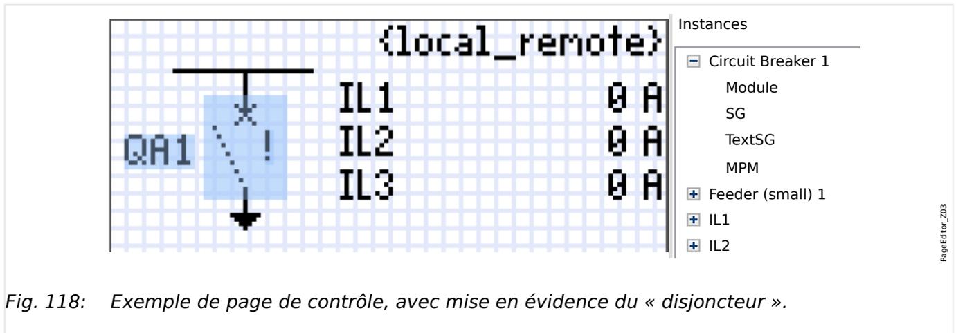
Fig. 118: Exemple de page de contrôle, avec mise en évidence du « disjoncteur ».
