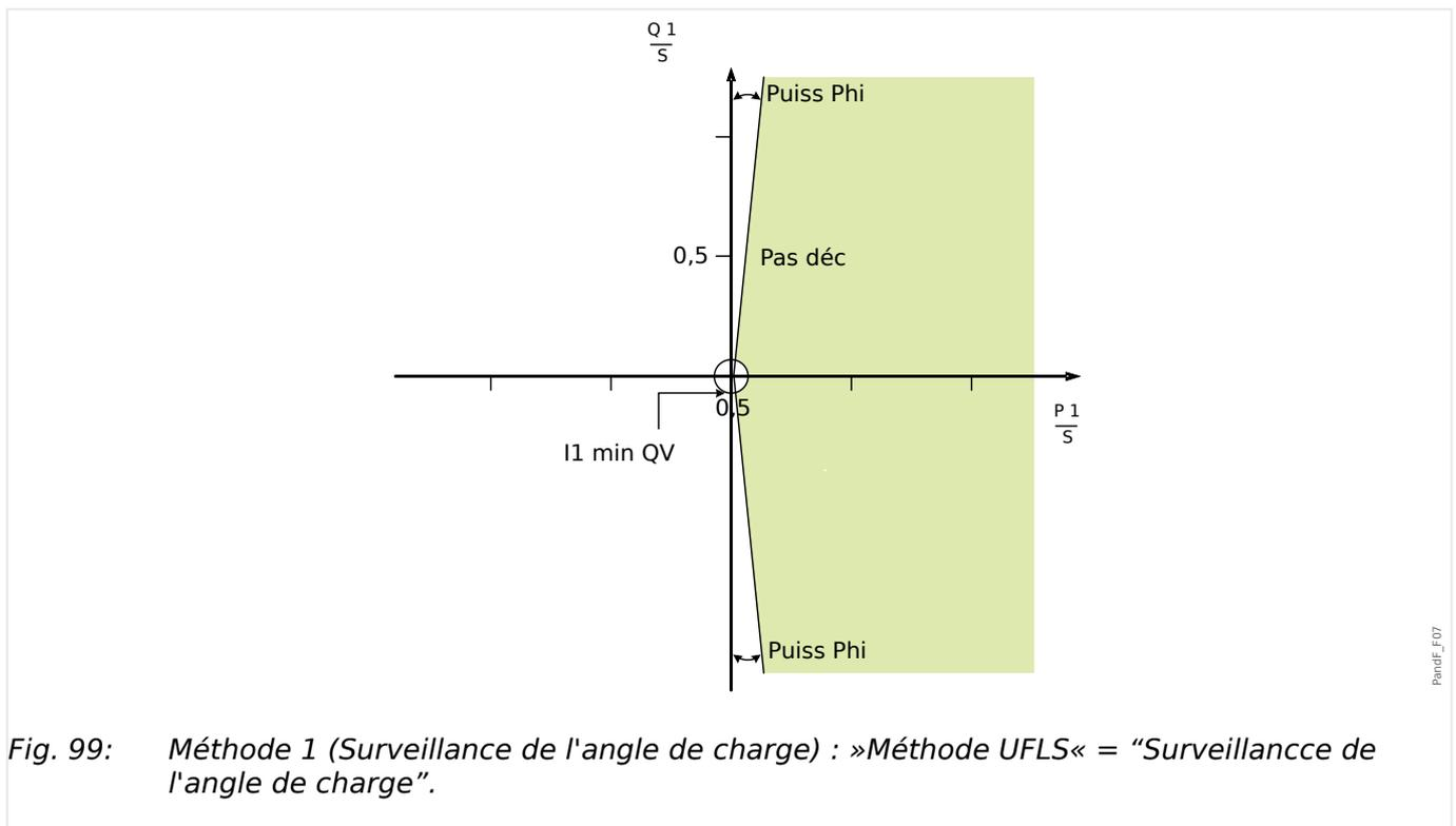
Un délestage de charge au cours d'une sous-fréquence sera bloqué, si la puissance active se situe dans la zone délimitée par l'angle de charge.
