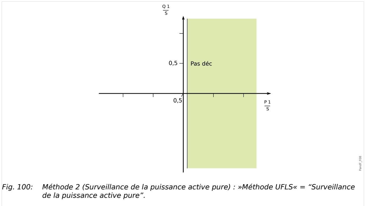
Un déclenchement au cours d'une sous-fréquence sera bloqué si la puissance active est au-dessus du seuil fixé.
