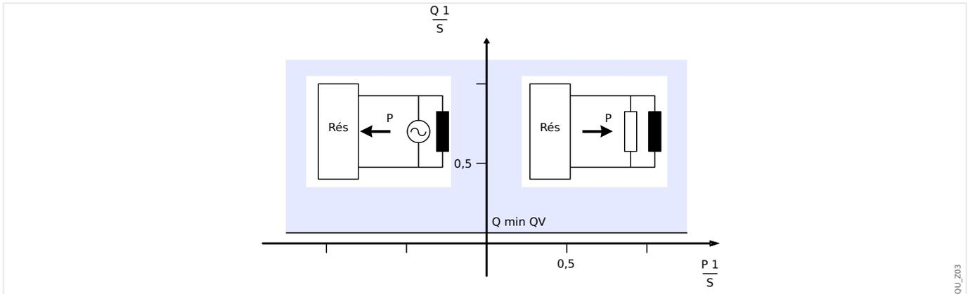
Fig. 92: Méthode 2 : Surveillance de la puissance réactive pure
