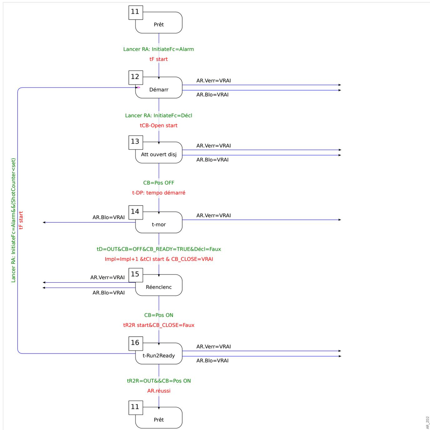
Fig. 102: Cycle d'exécution du AR (état 4).
