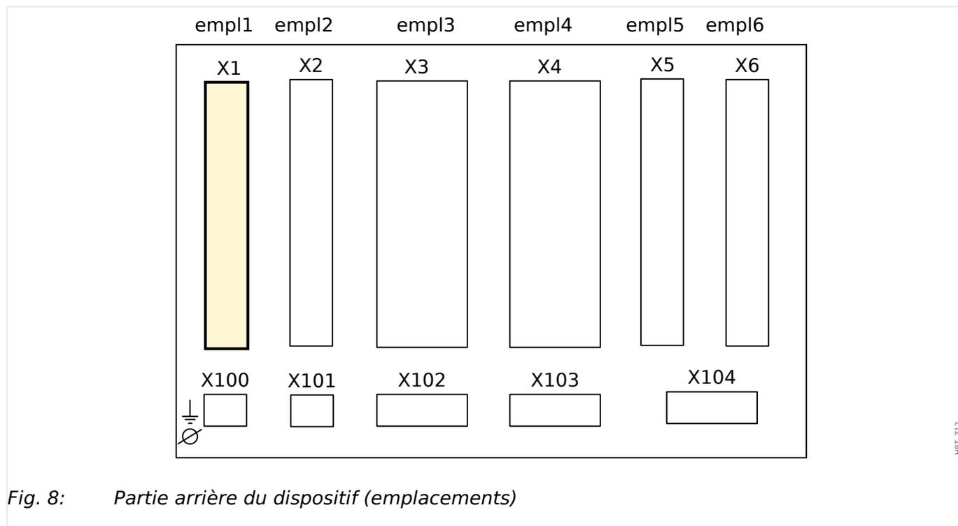
Le type de carte d'alimentation et le nombre d'entrées numériques utilisées sur cet emplacement dépendent du **type de dispositif commandé**. Les diverses variantes proposent des fonctions différentes.
