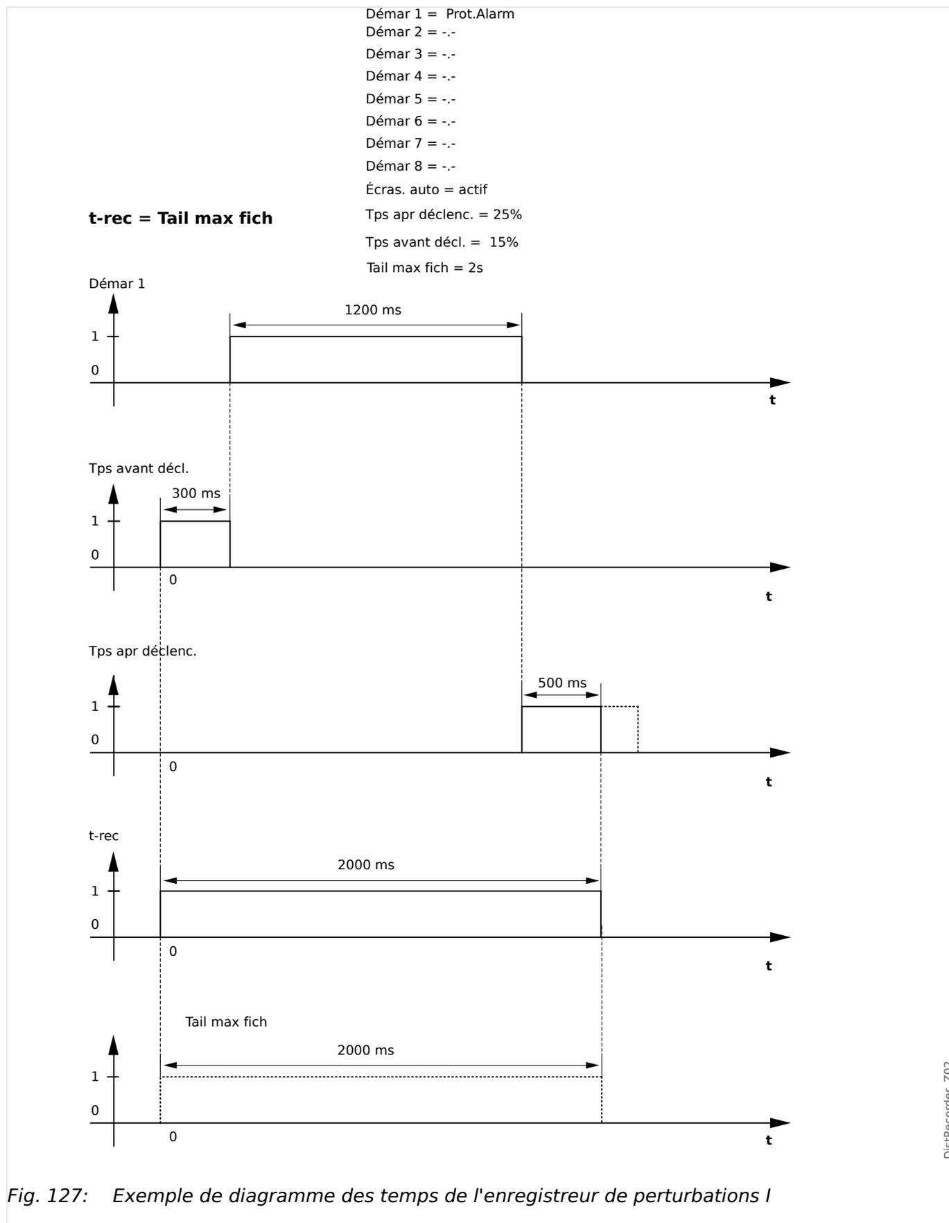
Fig. 127: Exemple de diagramme des temps de l'enregistreur de perturbations I
