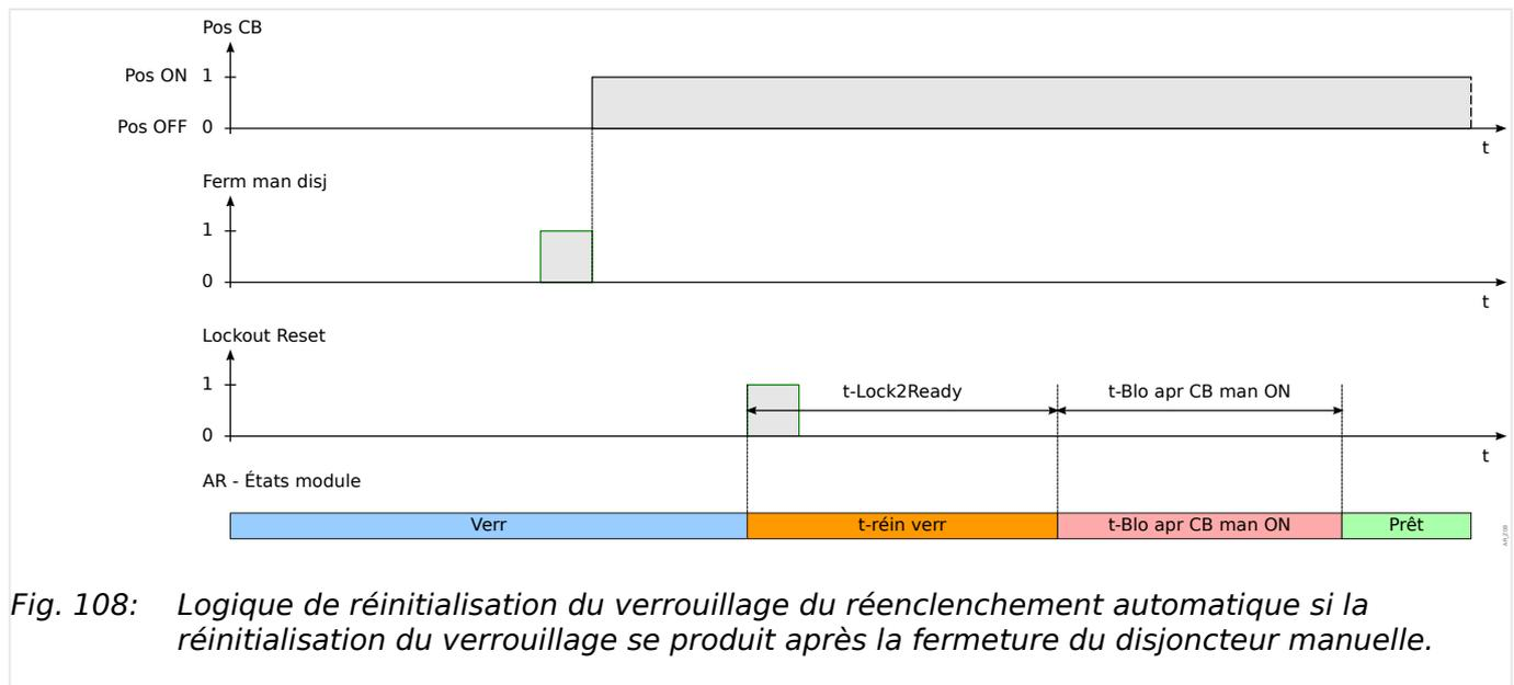
Fig. 108: Logique de réinitialisation du verrouillage du réenclenchement automatique si la réinitialisation du verrouillage se produit après la fermeture du disjoncteur manuelle.
