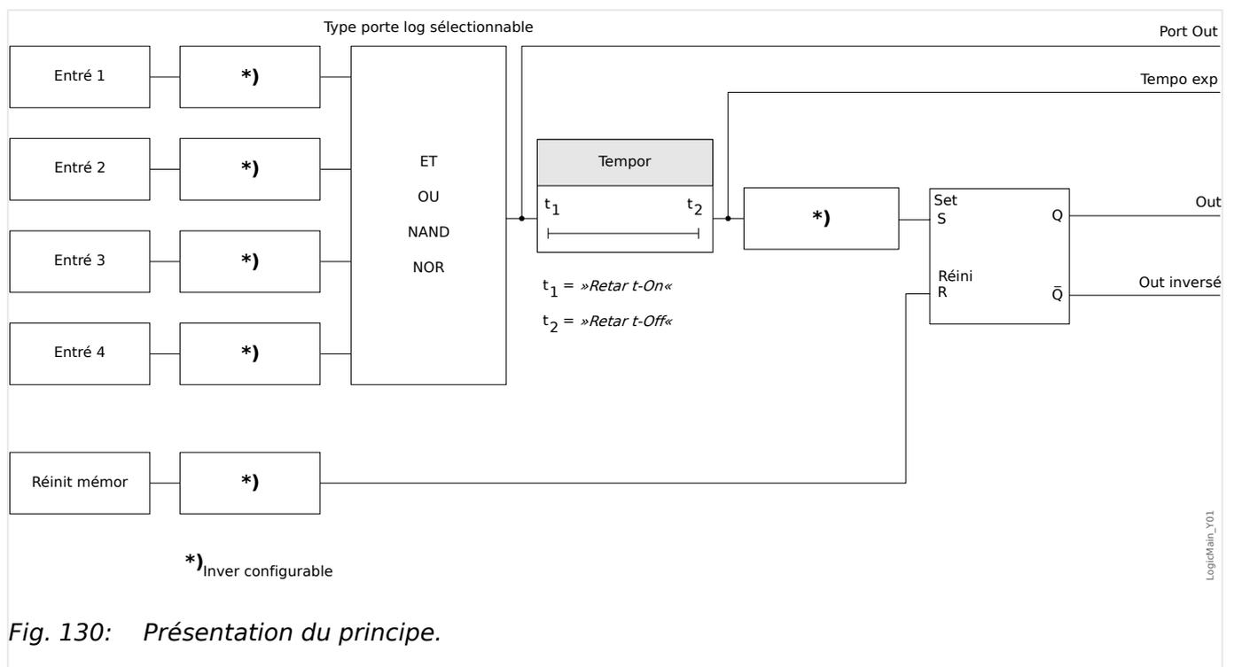
Fig. 130: Présentation du principe.
