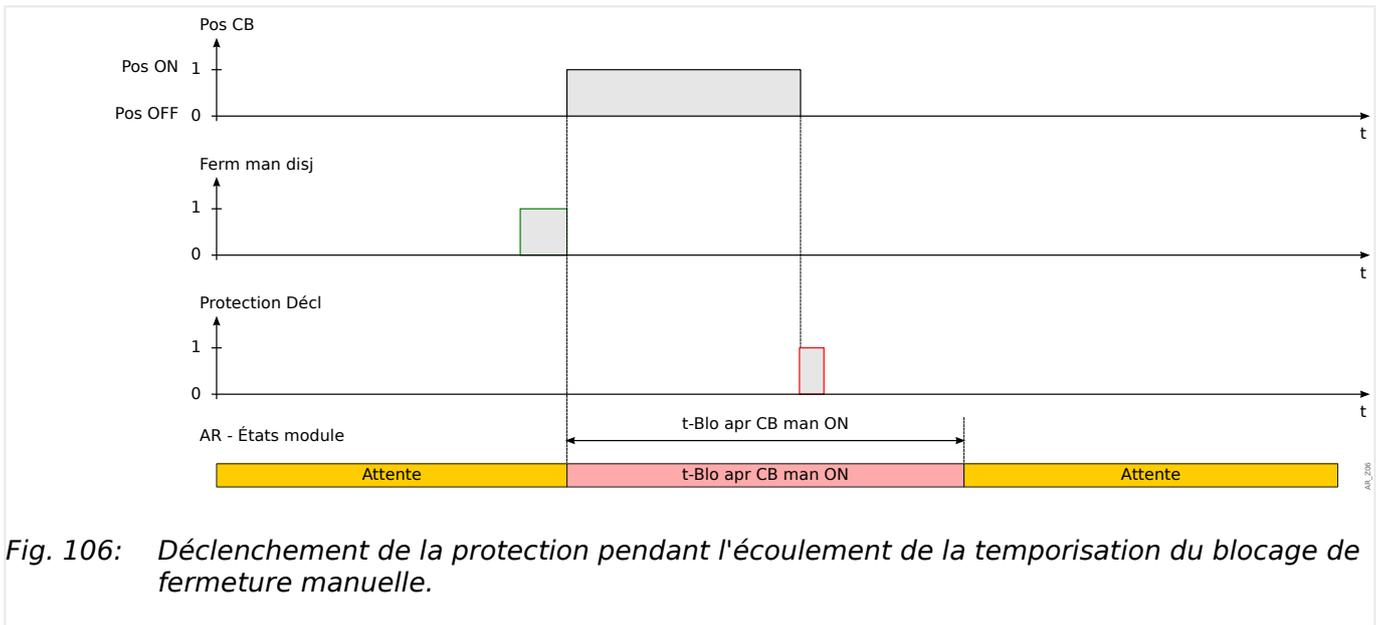
Fig. 106: Déclenchement de la protection pendant l'écoulement de la temporisation du blocage de fermeture manuelle.
