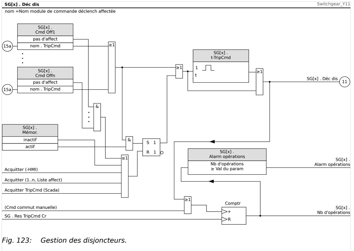
Notez que sur le schéma ci-dessus, « SG[x] » représente le « numéro d'appareillage de connexion x ». Cependant, la dénomination exacte est définie dans le fichier de ligne simple, voir aussi
