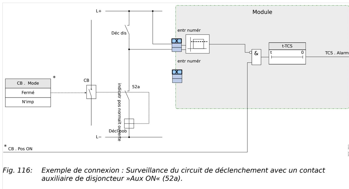
Fig. 116: Exemple de connexion : Surveillance du circuit de déclenchement avec un contact auxiliaire de disjoncteur »Aux ON« (52a).
