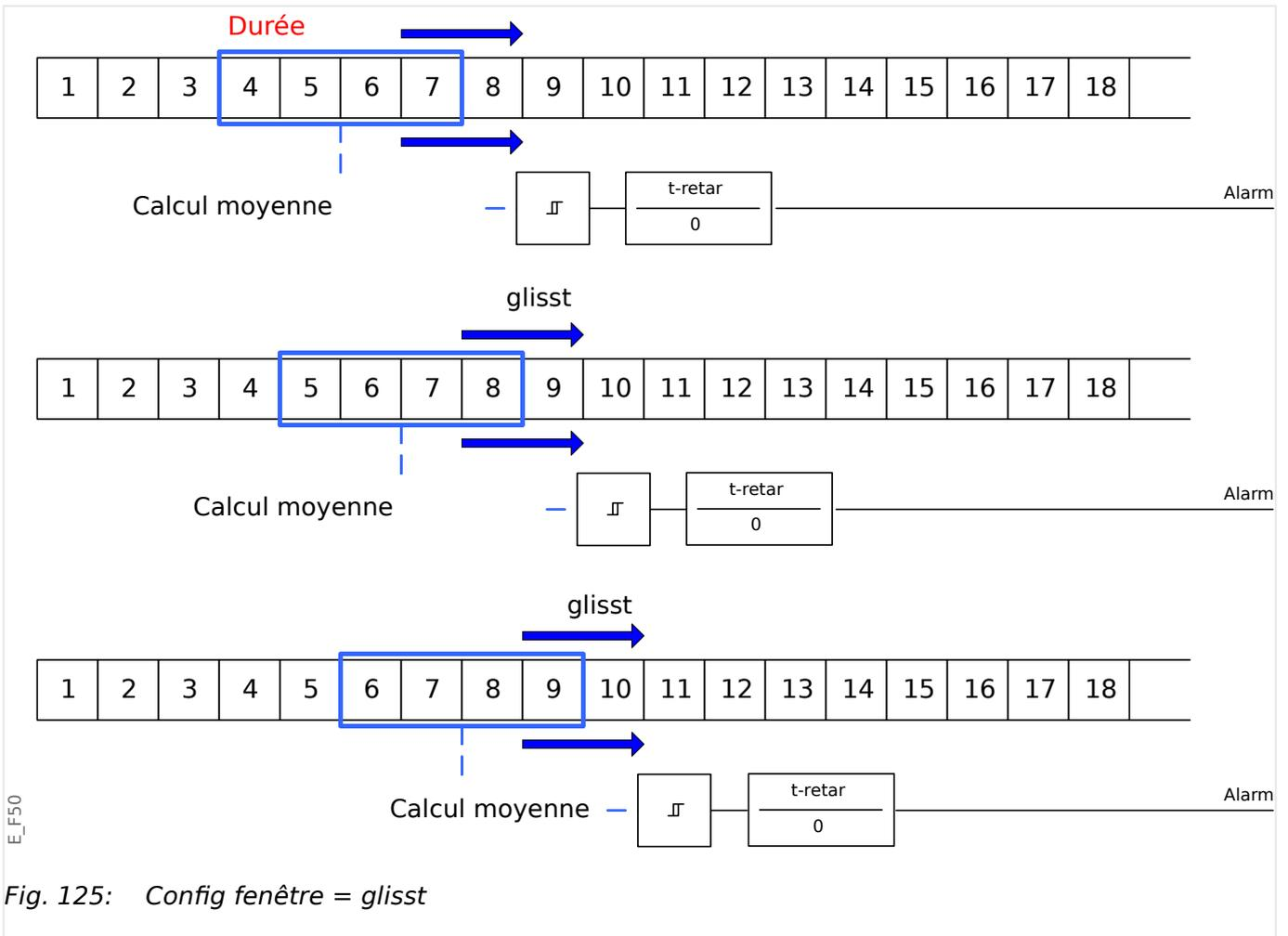
Fig. 125: Config fenêtre = glisst
