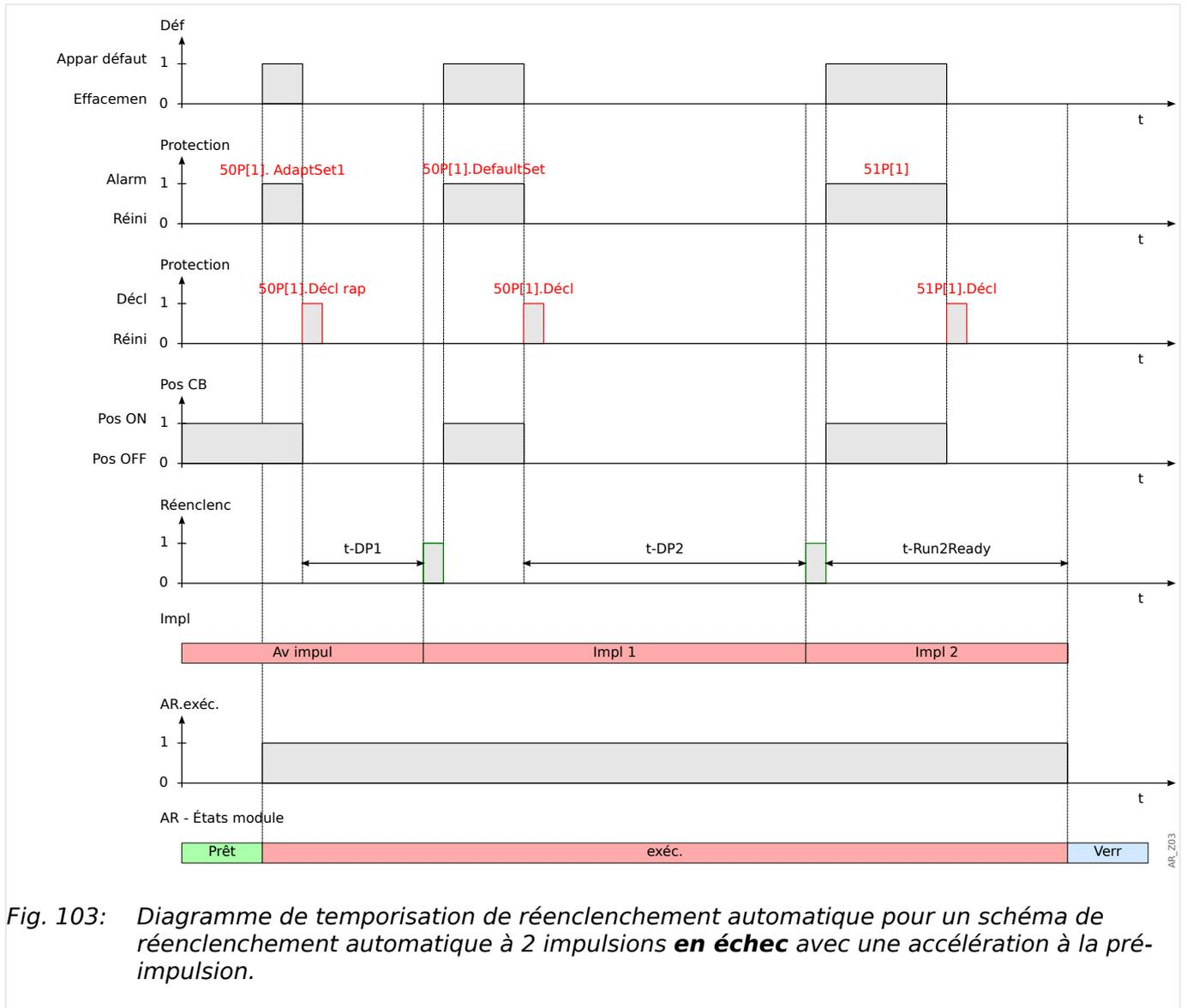
Fig. 103: Diagramme de temporisation de réenclenchement automatique pour un schéma de réenclenchement automatique à 2 impulsions **en échec** avec une accélération à la pré-impulsion.
