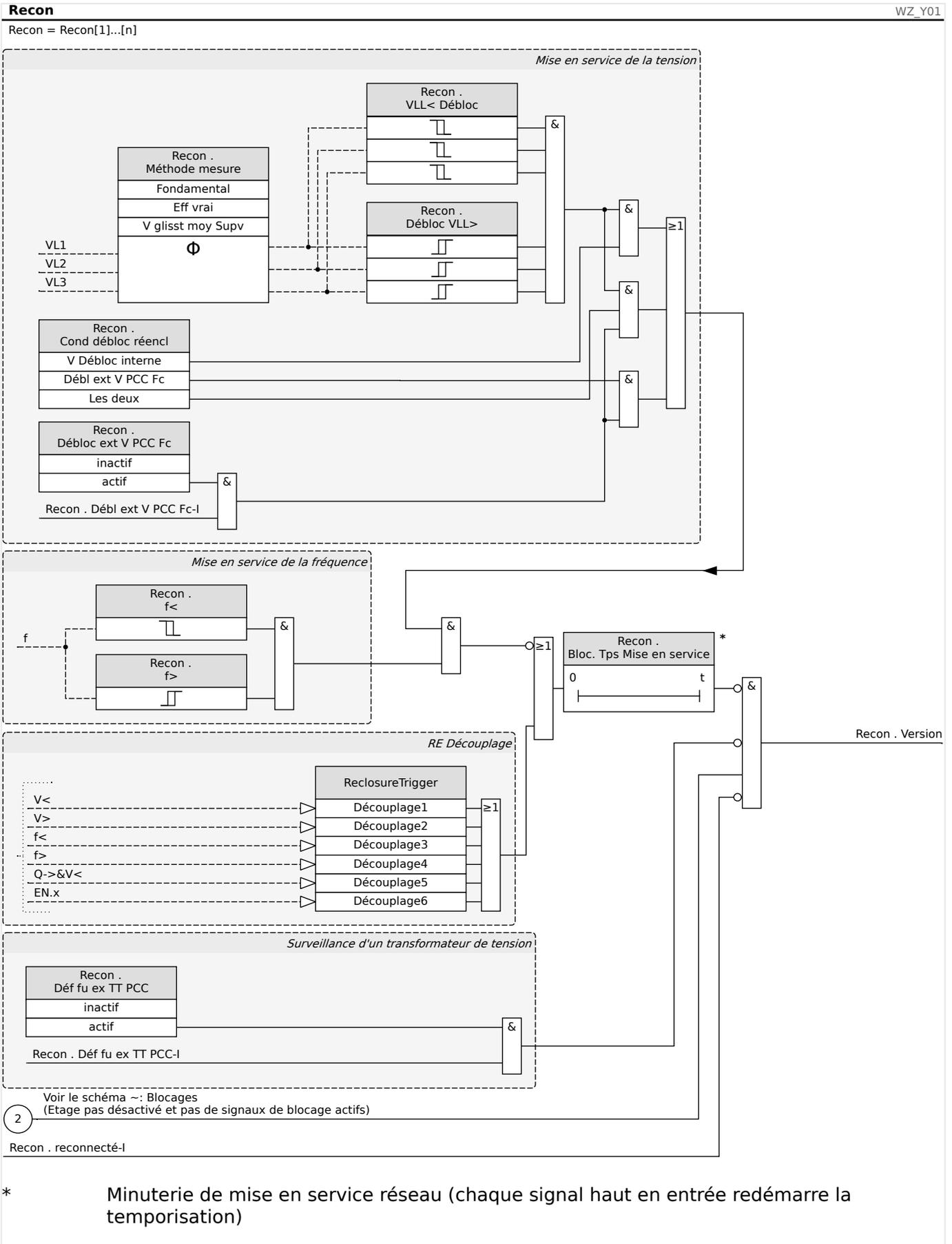
Si le disjoncteur au point de couplage commun a été déclenché, la reconnexion doit être réalisée manuellement. Aucune logique de blocage spéciale n'est nécessaire.
