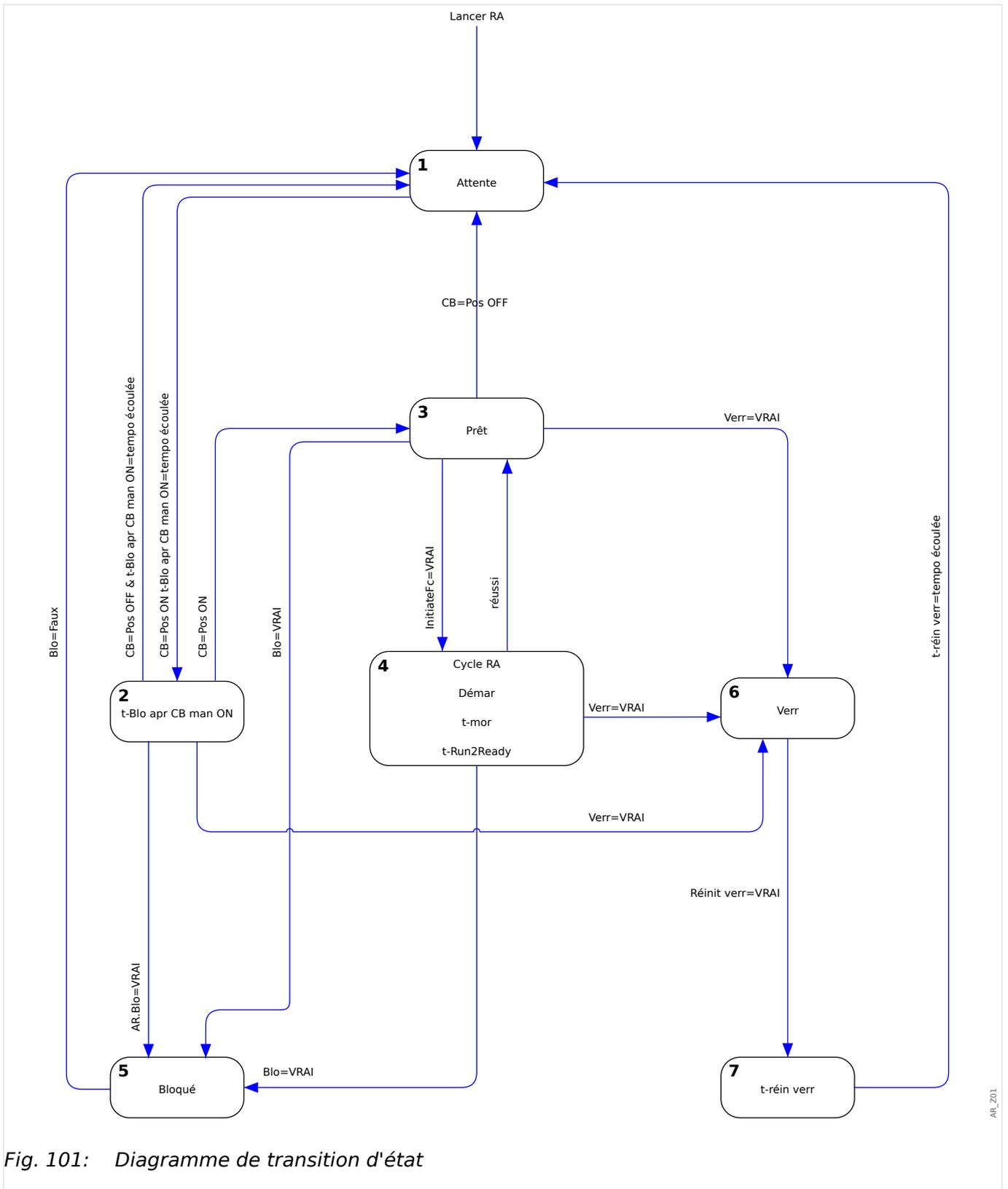
Fig. 101: Diagramme de transition d'état
