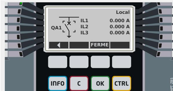
La touche de fonction « ► » (Entrée) vous permet d’accéder à une ligne unique améliorée (après avoir entré le mot de passe pour le niveau d’accès « Control-Lv1 »). Le dispositif d’appareillage de connexion est mis en évidence à l’aide de petits marqueurs (et, dans le cas de la mise en œuvre de plusieurs dispositifs d’appareillage de connexion, la touche de fonction « Sélection » apparaît pour vous permettre de sélectionner un autre dispositif).
