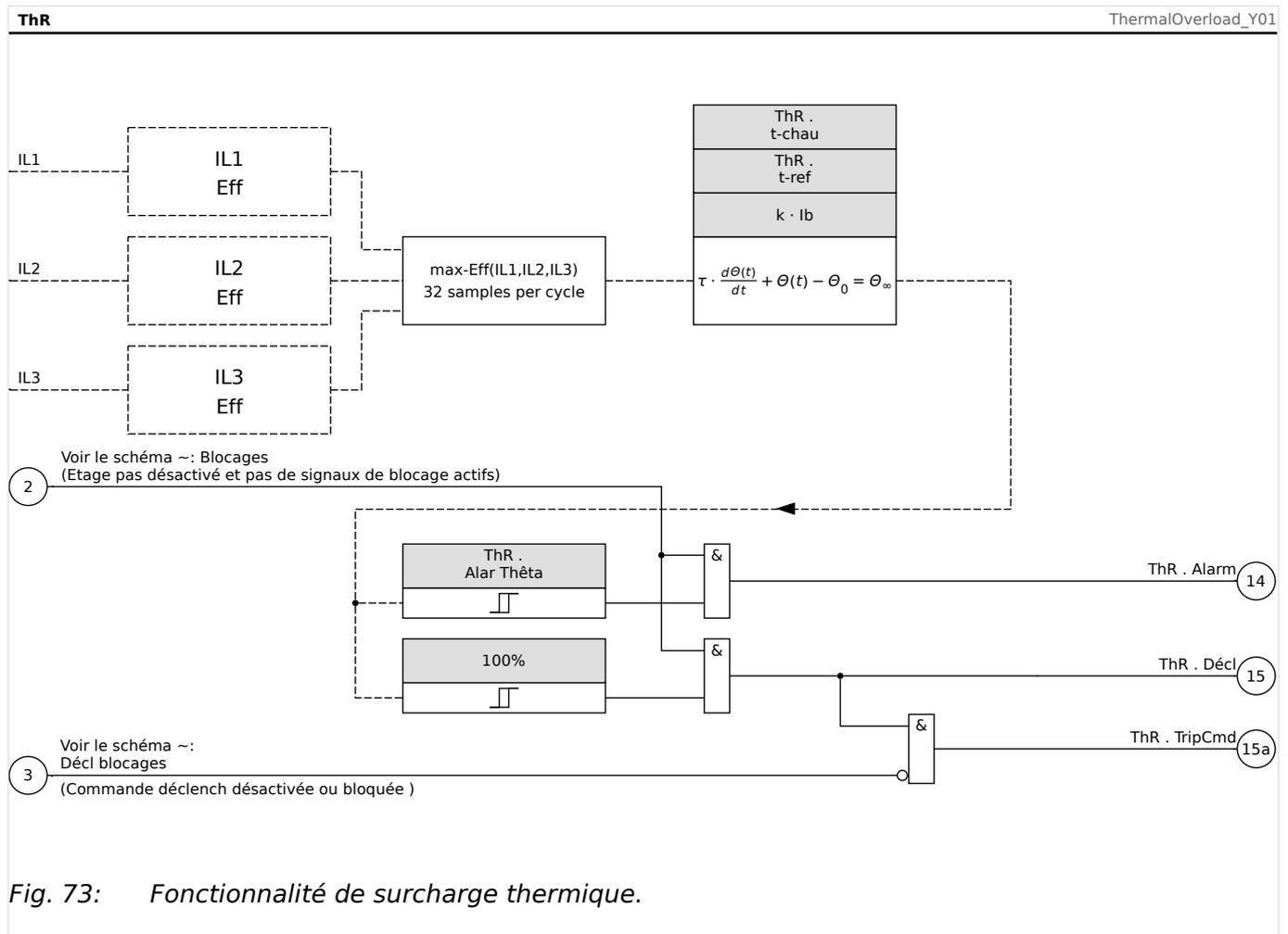
Fig. 73: Fonctionnalité de surcharge thermique.
