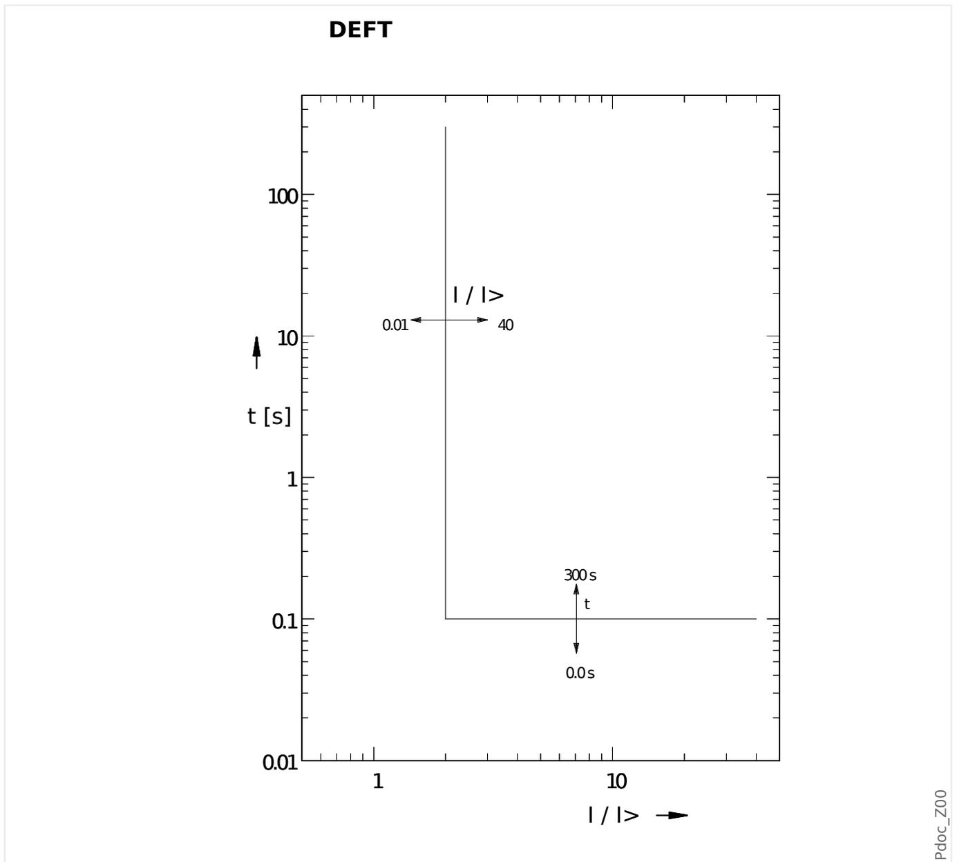
Délai de déclenchement pour  $I > I>$ , configurable via [Param protect / Set 1...4 / I-Prot / I[x]] »t«.
