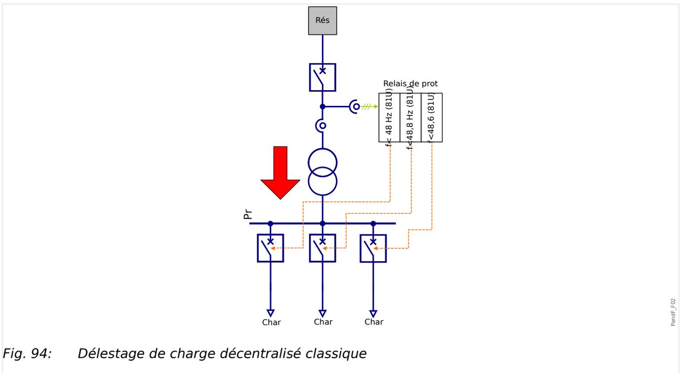
Un délestage de charge décentralisé classique peut être effectué par désactivation de la détection de la direction du flux de puissance.
