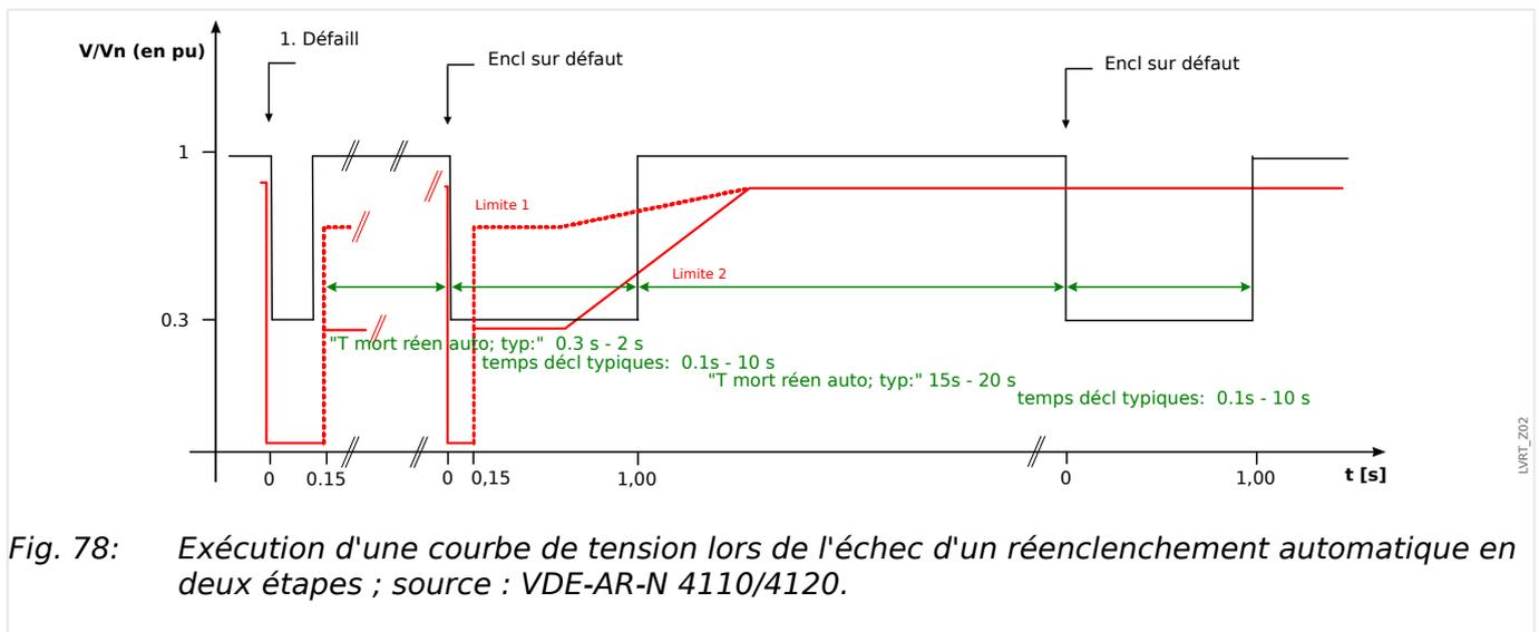
Fig. 78: Exécution d'une courbe de tension lors de l'échec d'un réenclenchement automatique en deux étapes ; source : VDE-AR-N 4110/4120.
