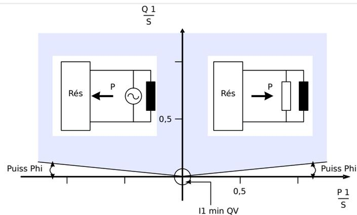
Fig. 91: Méthode 1 : Surveillance de l'angle de charge
