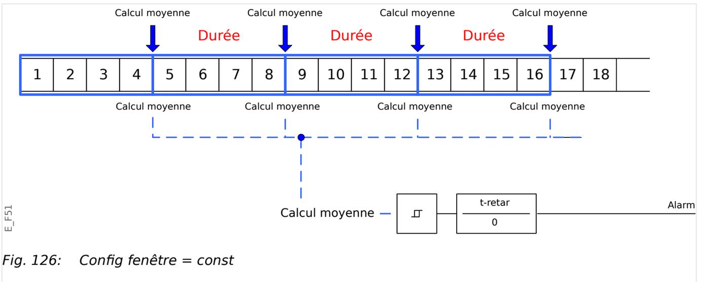
Fig. 126: Config fenêtre = const
