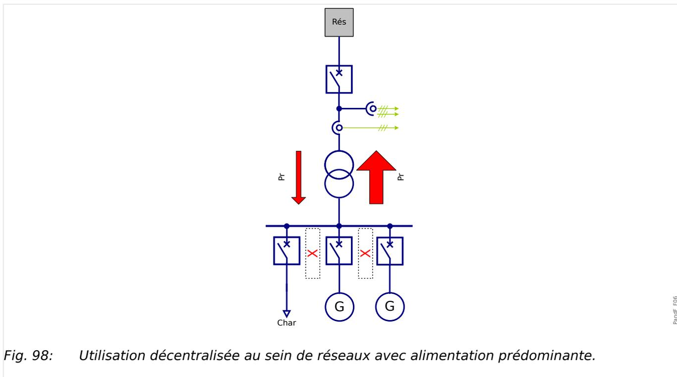
Fig. 98: Utilisation décentralisée au sein de réseaux avec alimentation prédominante.
