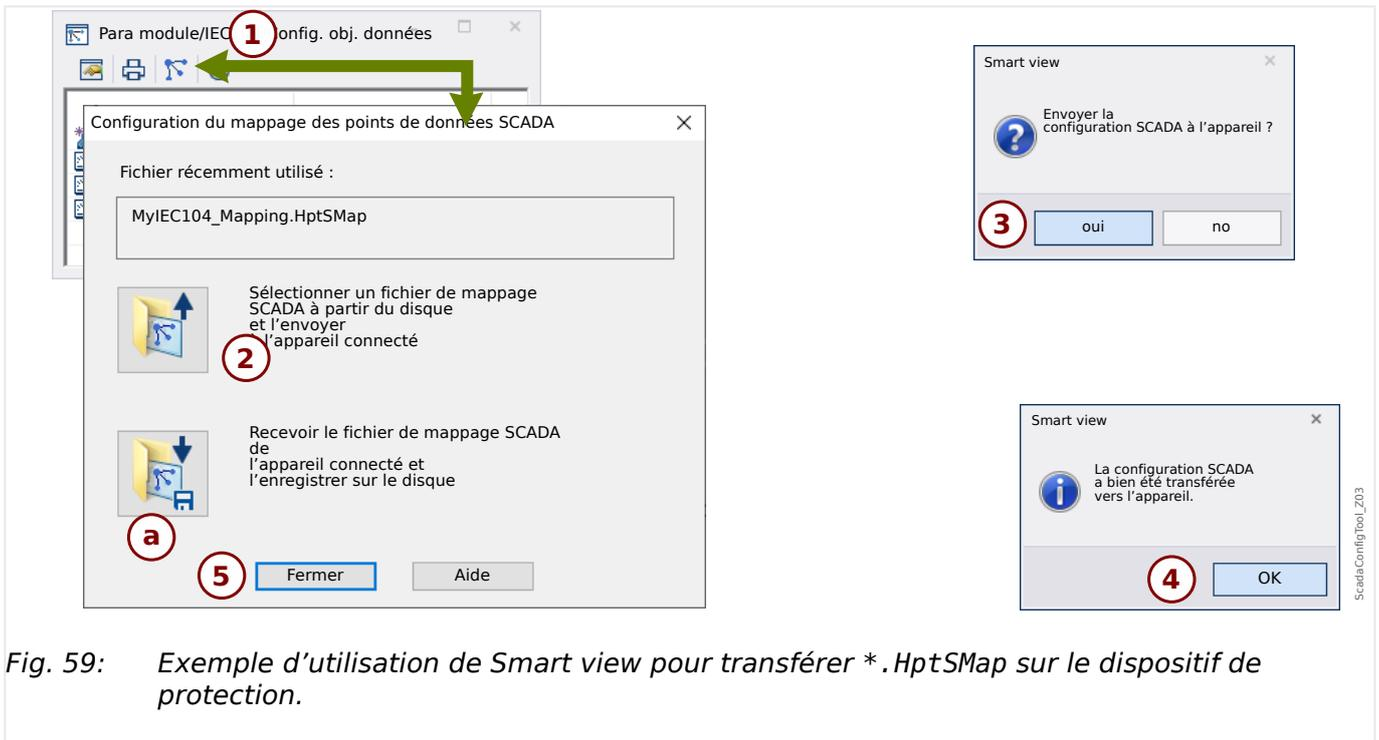
Fig. 59: Exemple d'utilisation de Smart view pour transférer \*.HptSMap sur le dispositif de protection.
