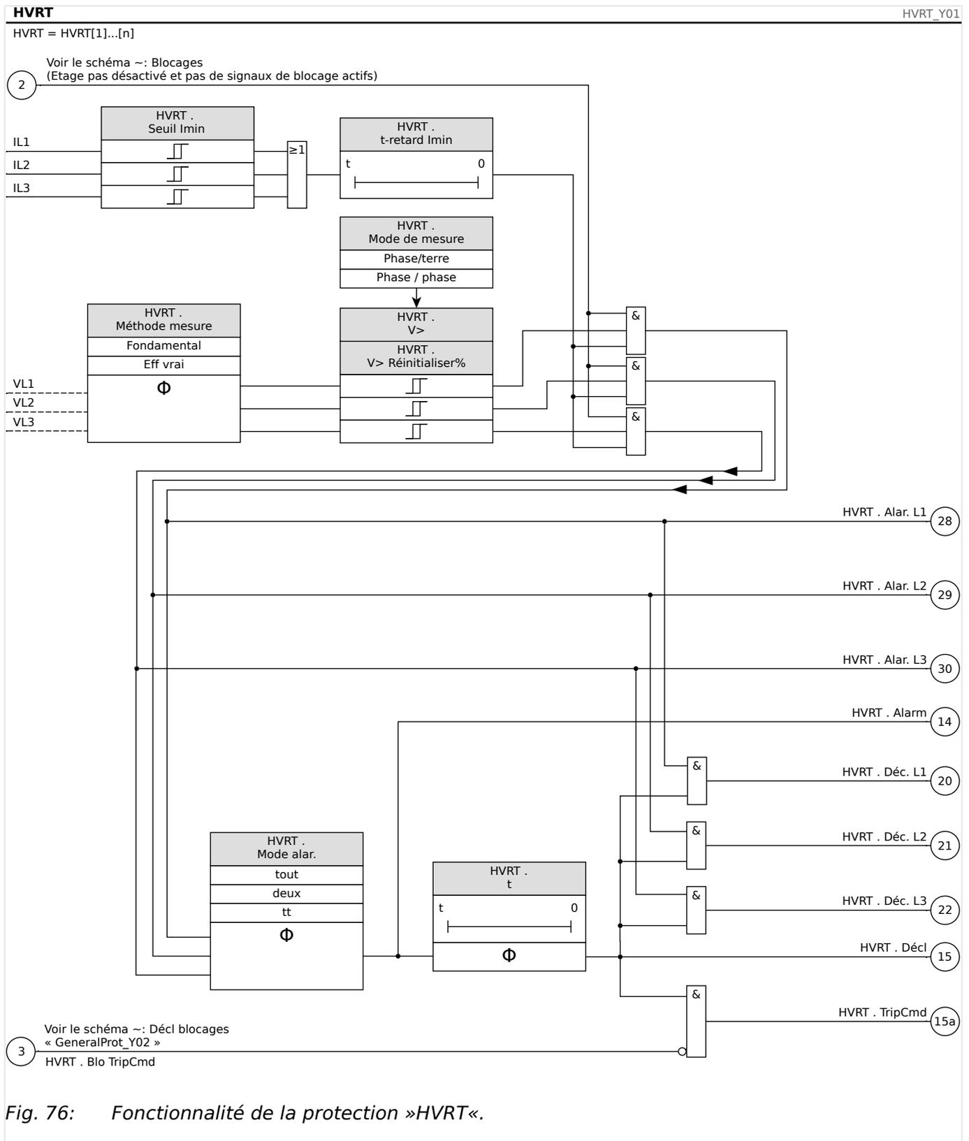
Fig. 76: Fonctionnalité de la protection »HVRT«.
