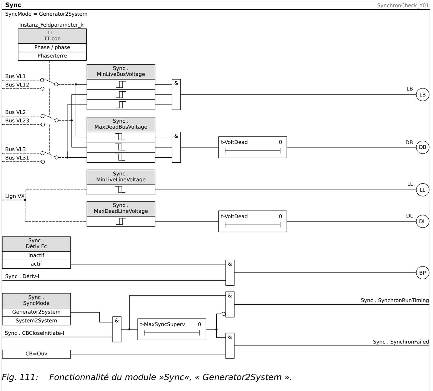
Fig. 111: Fonctionnalité du module «Sync», « Generator2System ».
