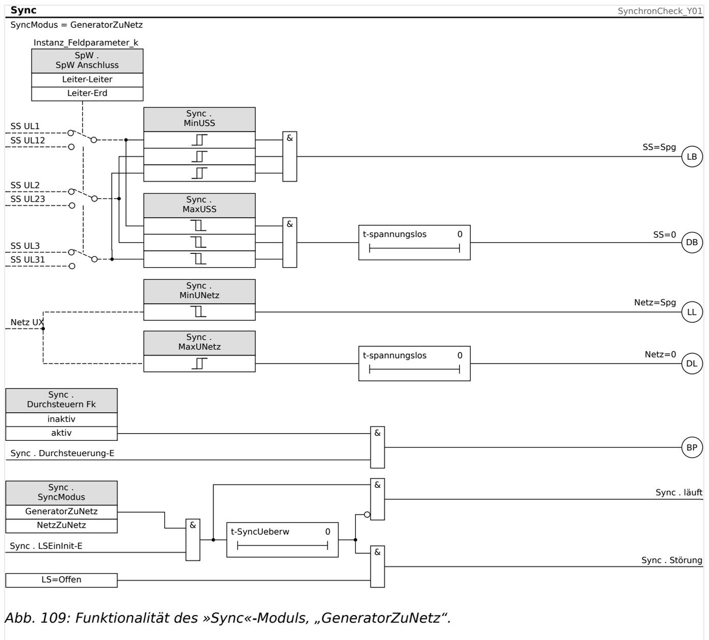
Abb. 109: Funktionalität des »Sync«-Moduls, „GeneratorZuNetz“.
