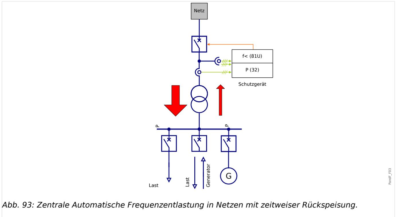
Abb. 93: Zentrale Automatische Frequenzentlastung in Netzen mit zeitweiser Rückspeisung.
