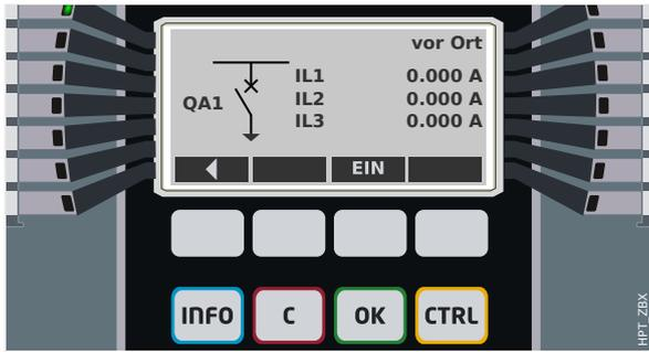
Abb. 119: Beispiel einer Steuer-Seite mit geöffnetem „Leistungsschalter“.
