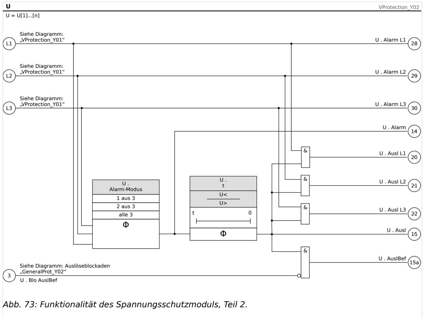
Abb. 73: Funktionalität des Spannungsschutzmoduls, Teil 2.
