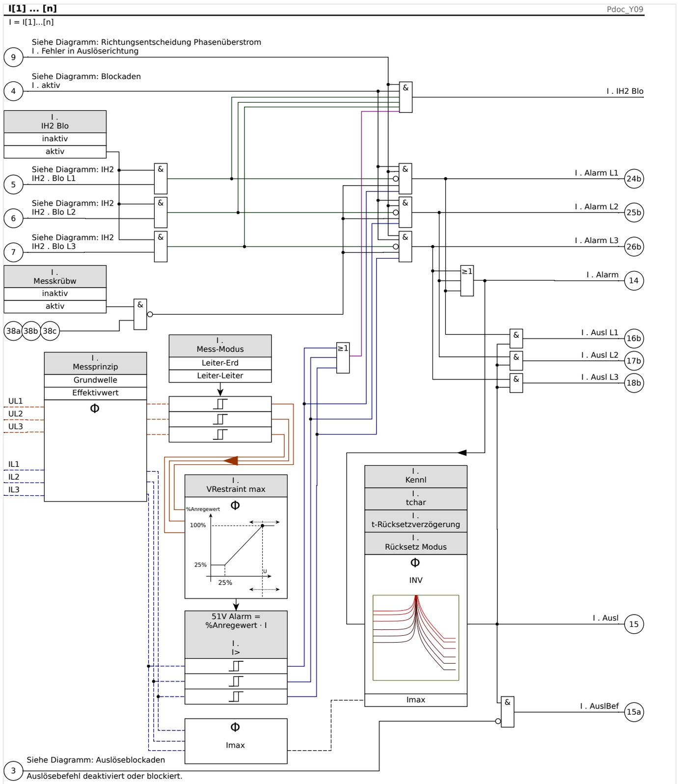
Anmerkung: Um das Diagramm nicht zu sehr zu überladen, ist hierin nicht die Tatsache berücksichtigt, dass für den Fall [Feldparameter / SpW] »SpW Anschluss« = "Leiter-Leiter" der Parameter »I[x]« . Mess-Modus geräteintern auf "Leiter-Leiter" gesetzt wird, unabhängig vom ursprünglich konfigurierten Wert (siehe auch den Hinweis in [Kapitel 4.4.3](#)).
