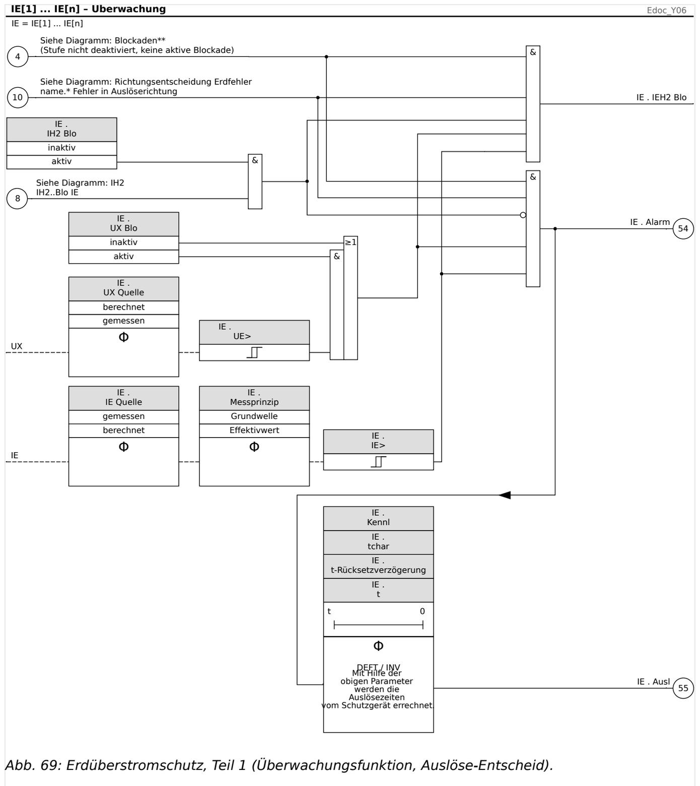
Abb. 69: Erdüberstromschutz, Teil 1 (Überwachungsfunktion, Auslöse-Entscheidung).
