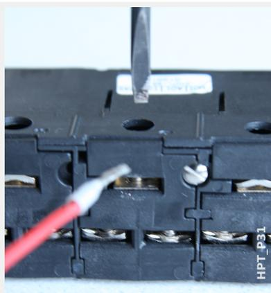
Stiftkabelschuhe können nun in die jeweiligen Anschlussöffnungen eingeführt und verschraubt werden. Die Schrauben zum Befestigen des Kabelschuhs befinden sich seitlich.
