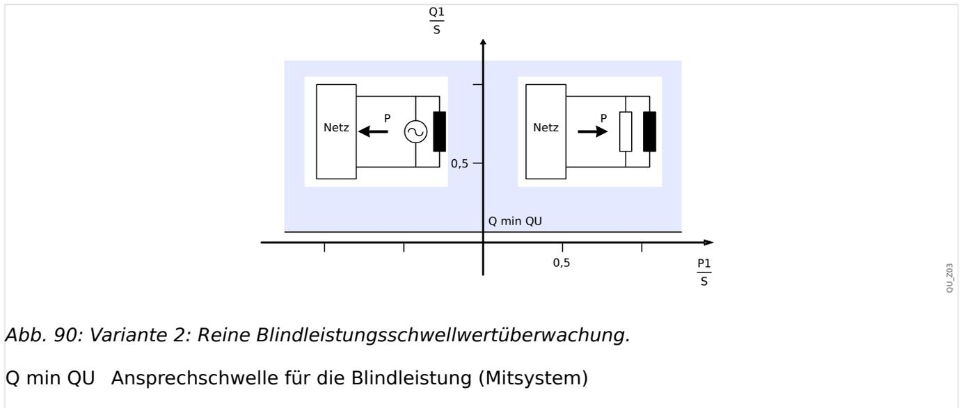
Abb. 90: Variante 2: Reine Blindleistungsschwellwertüberwachung.
