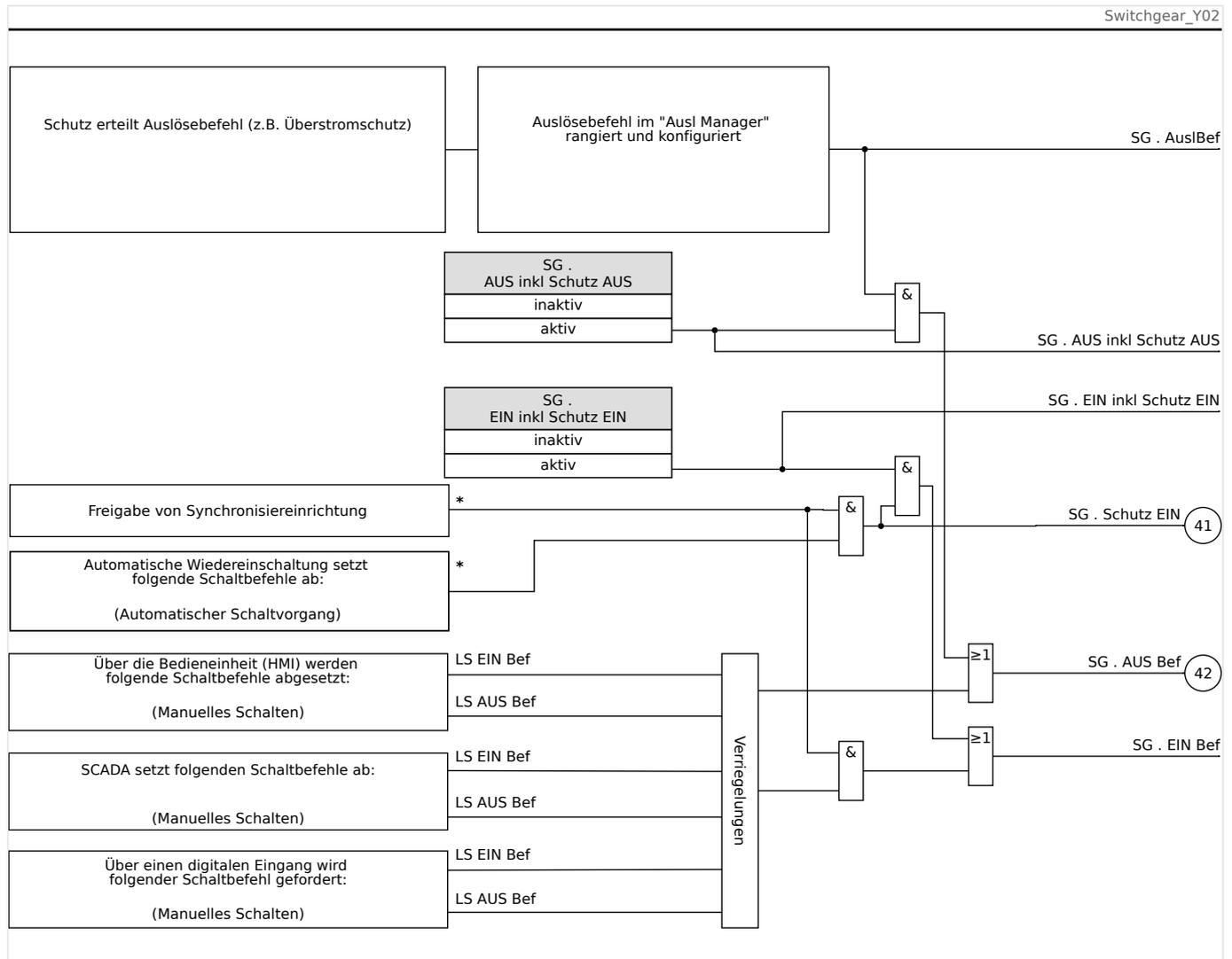
Abb. 120: Verriegelungen. (Für die mit „\*“ markierten Teile gilt: Verfügbarkeit hängt von der bestellten Gerätevariante ab.)
