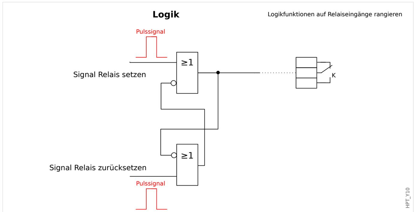
Weil die „Digitalen Ausgangssignale“ des DNP-Protokolls nur in Form von Pulssignalen ausgegeben werden, können diese nicht direkt zum Schalten von Ausgangsrelais verwendet werden (entsprechend der DNP Definition, keine statischen Zustände). Statische Zustände (Steady States) können mit Hilfe der Logikfunktionen realisiert werden. Die entsprechenden Logikfunktionen können dann auf die Eingangsfunktionen eines Ausgangsrelais rangiert werden.
