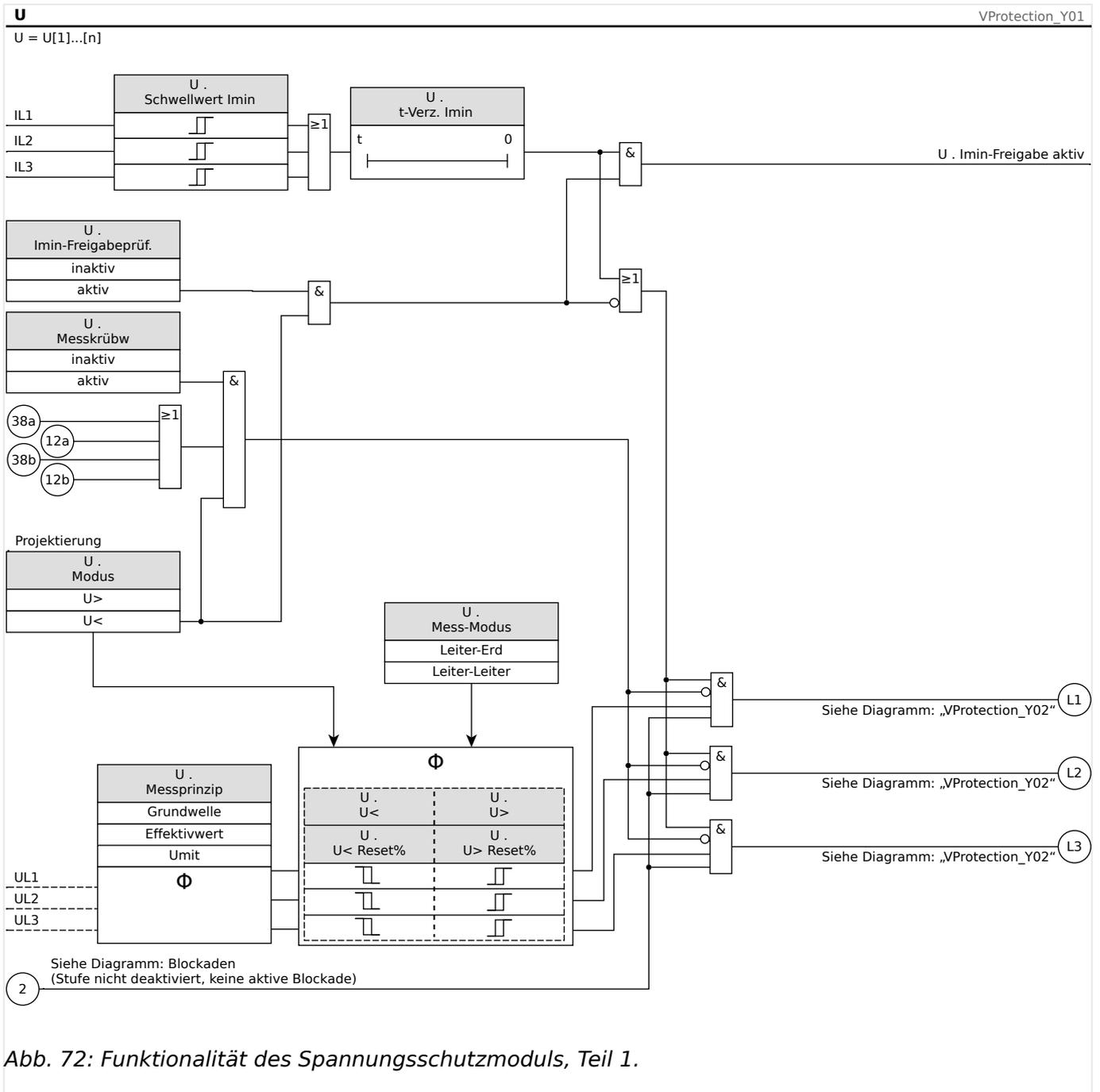
Abb. 72: Funktionalität des Spannungsschutzmoduls, Teil 1.
