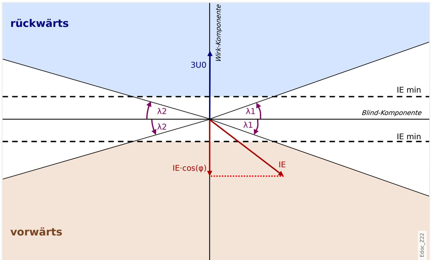
Abb. 64: Richtungserkennung nach der Methode „cos(φ)“.
