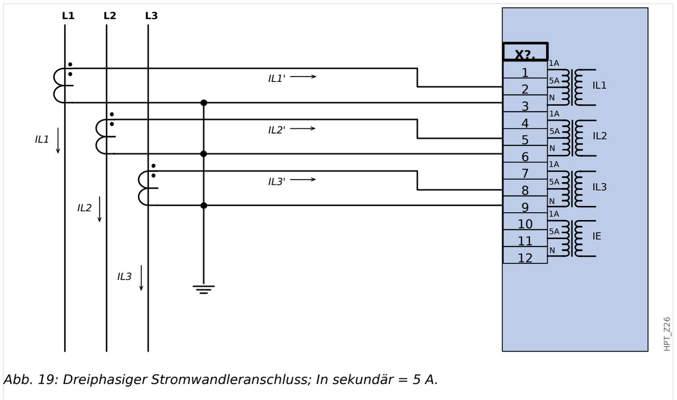
Abb. 19: Dreiphasiger Stromwandleranschluss; In sekundär = 5 A.
