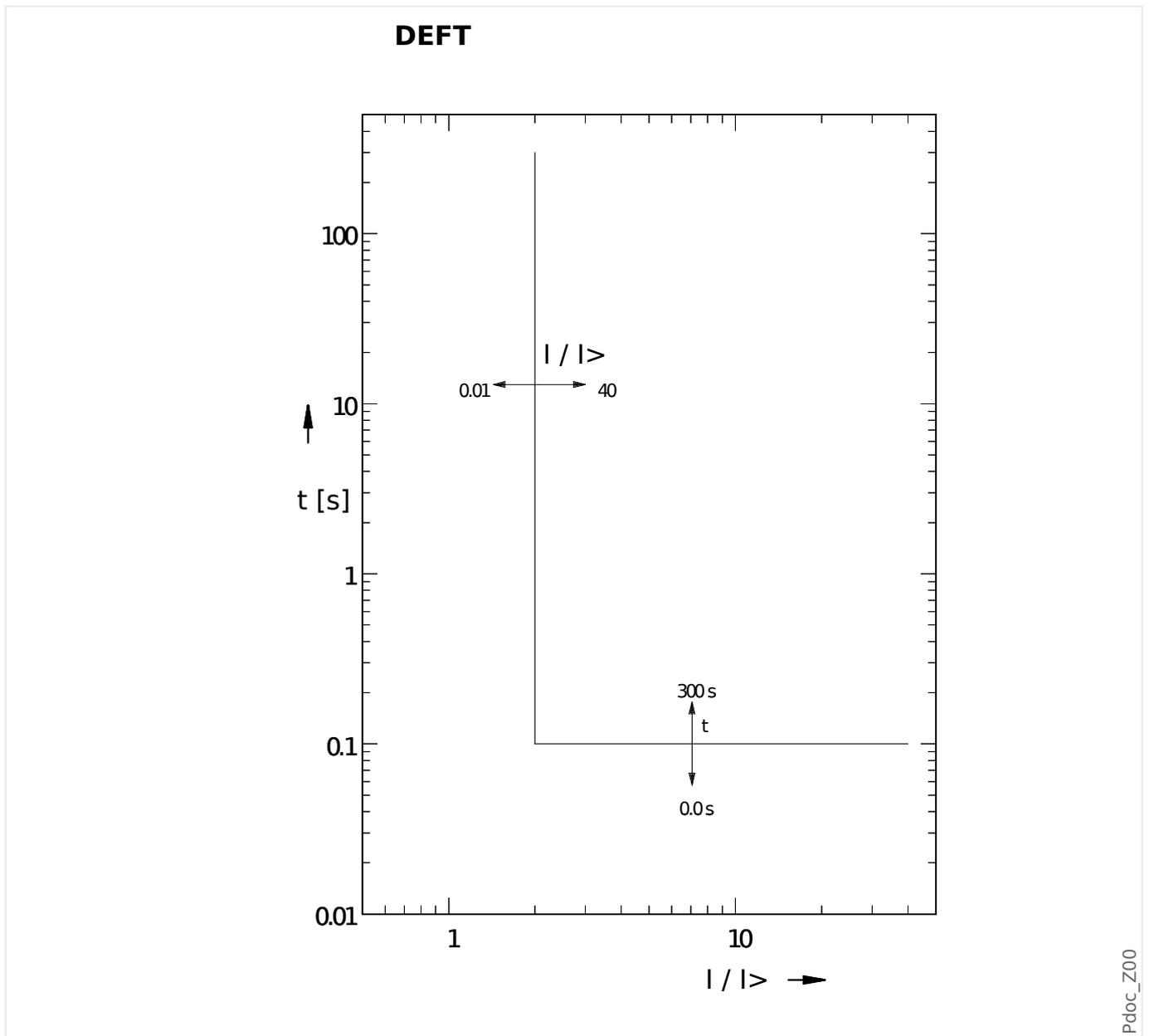
Die Auslöseverzögerung für  $I > I >$  ist einstellbar über [Schutzparameter / Satz 1...4 / I-Schutz / I[x]] »t«.
