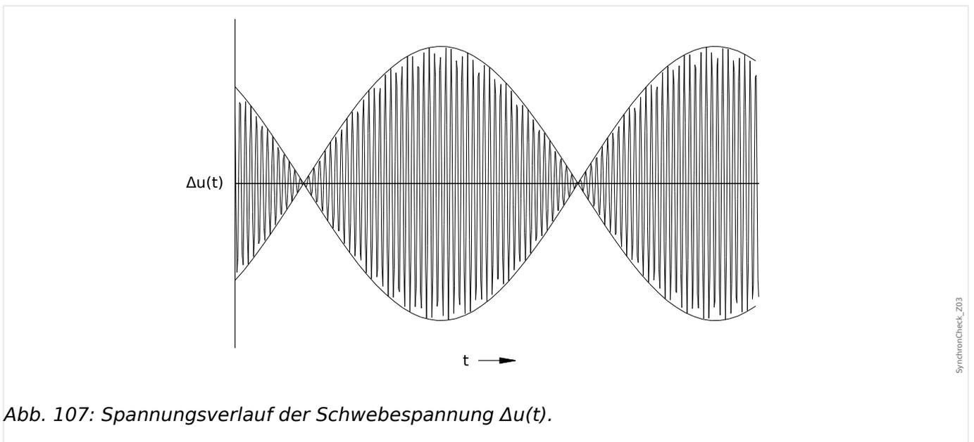
Abb. 107: Spannungsverlauf der Schwebespannung  $\Delta u(t)$ .
