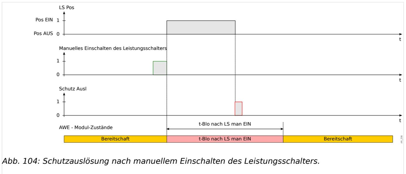
Abb. 104: Schutzauslösung nach manuellem Einschalten des Leistungsschalters.
