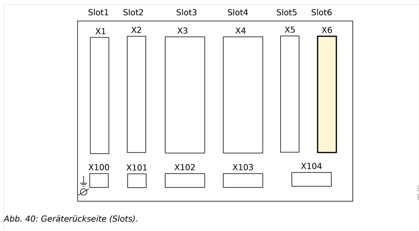
Der genaue Typ der verbauten Netzteilkarte und die Anzahl der darauf befindlichen Digitalen Eingänge ergibt sich aus dem **Bestellschlüssel**. Die unterschiedlichen Varianten haben einen unterschiedlichen Funktionsumfang.
