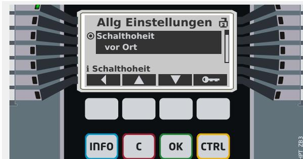
Durch Betätigen des „Modus“-Softkey erreicht man den Menüzweig [Steuerung / Allg Einstellungen].
