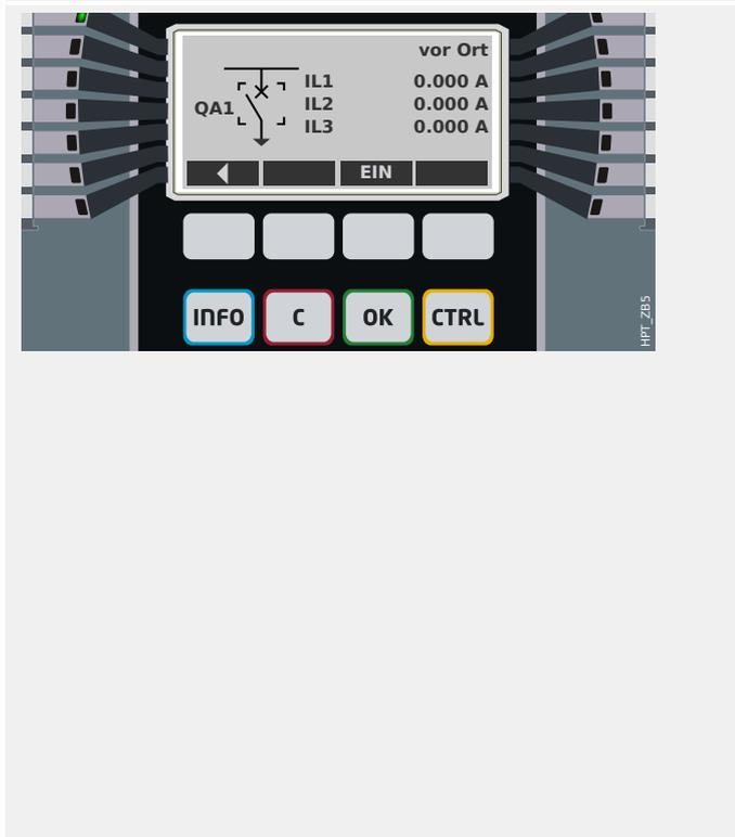
Über den Softkey „►“ (Enter) erreicht man ein erweitertes Abzweigsteuerbild (nachdem das Passwort für den Zugriffsbereich „Strg-Lv1“ eingegeben worden ist); hier ist nun ein Betriebsmittel durch kleine Ecken markiert und dadurch als „ausgewählt“ gekennzeichnet. Falls mehrere Betriebsmittel unterstützt werden, ist außerdem der Softkey „Ausw“ sichtbar, über den (zyklisch durchrotierend) ein anderes Betriebsmittel angewählt werden kann.
