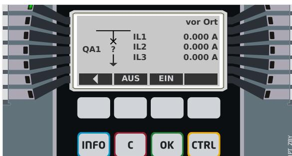
Abb. 118: Beispiel einer Steuer-Seite mit „Leistungsschalter“ in Störstellung (bzw. unplausiblem Zustand).
