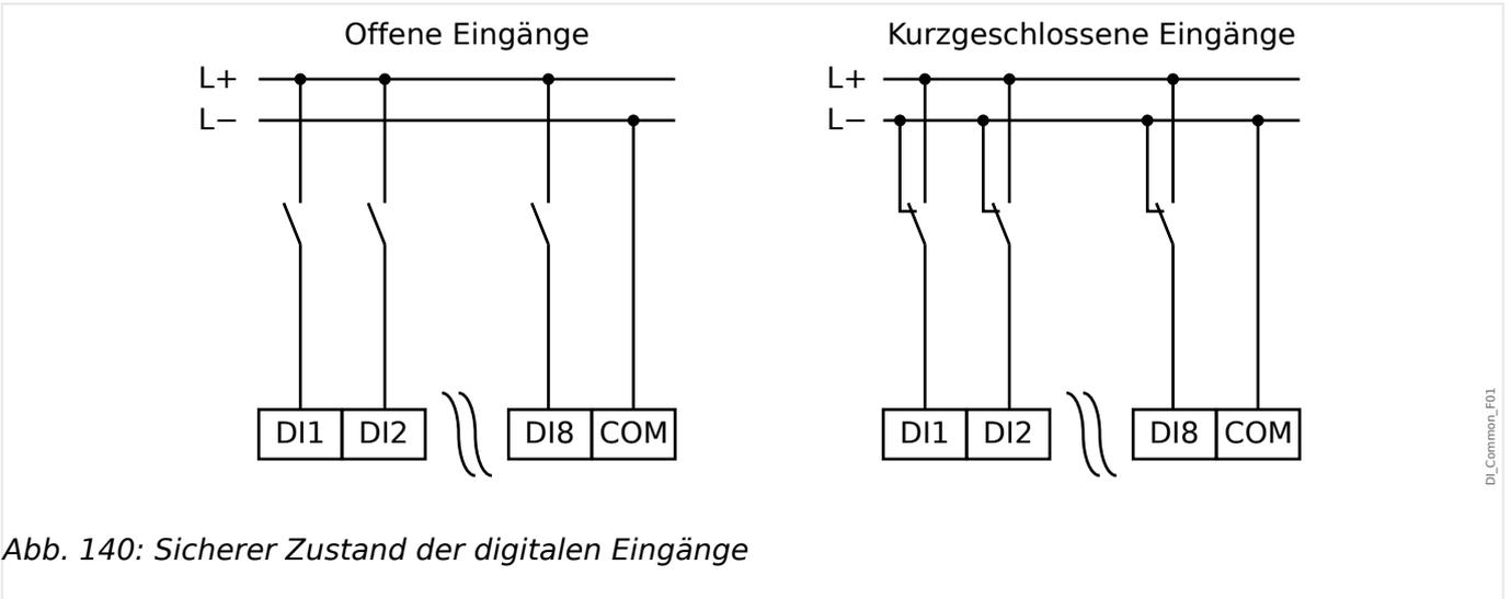
Abb. 140: Sicherer Zustand der digitalen Eingänge
