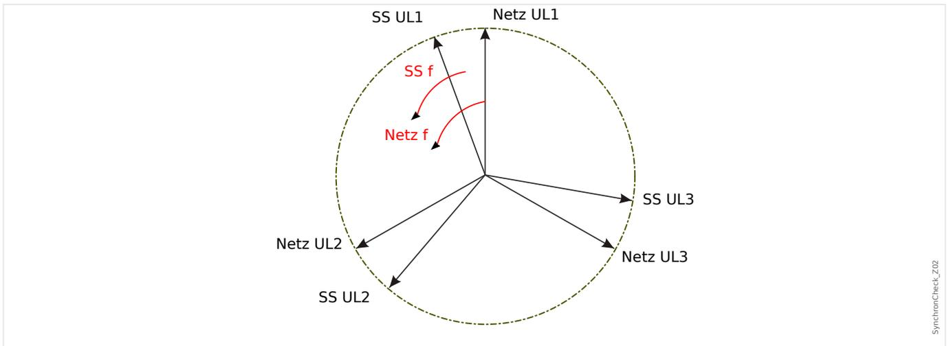
Wenn die Generatorfrequenz  $f_{SS}$  ungleich der Netzfrequenz  $f_{Netz}$  ist, so stellt sich zwischen den beiden Systemen eine Schwebefrequenz ein.  $\Delta F = |f_{SS} - f_{Netz}|$
