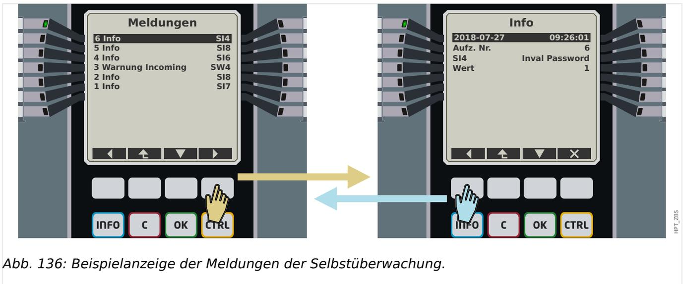
Abb. 136: Beispielanzeige der Meldungen der Selbstüberwachung.
