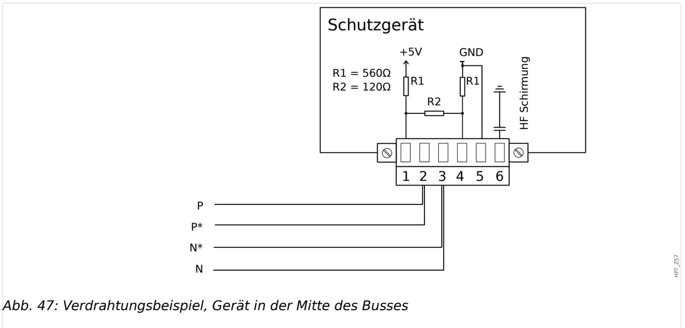
Abb. 47: Verdrahtungsbeispiel, Gerät in der Mitte des Busses
