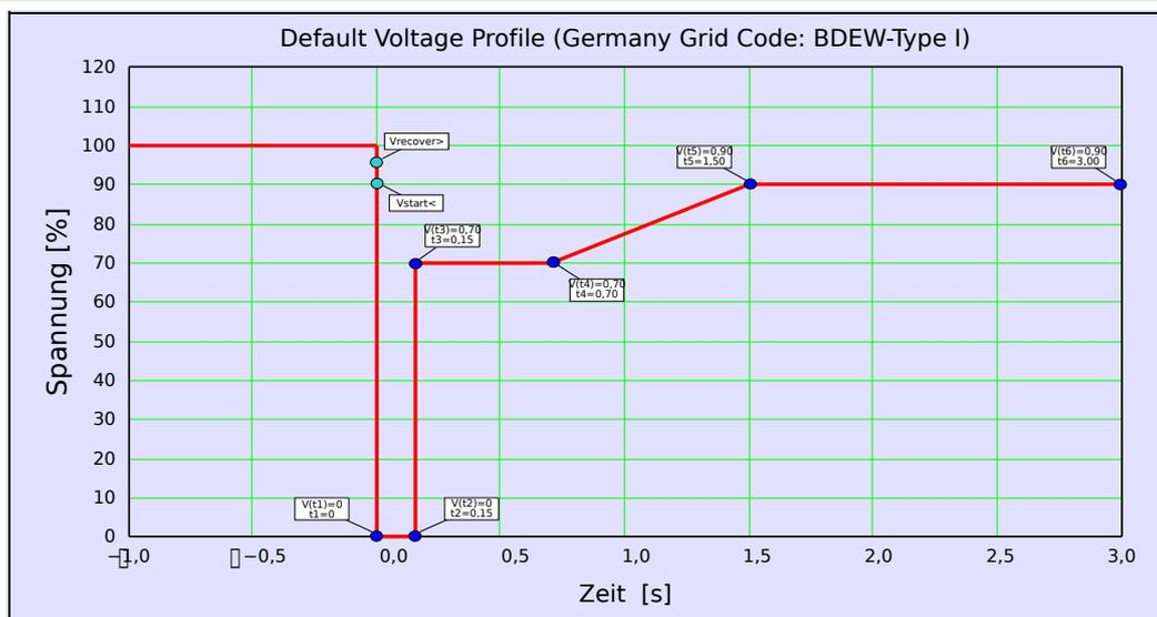
Abb. 78: LVRT-Werkseinstellung (BDEW-Typ-I).
