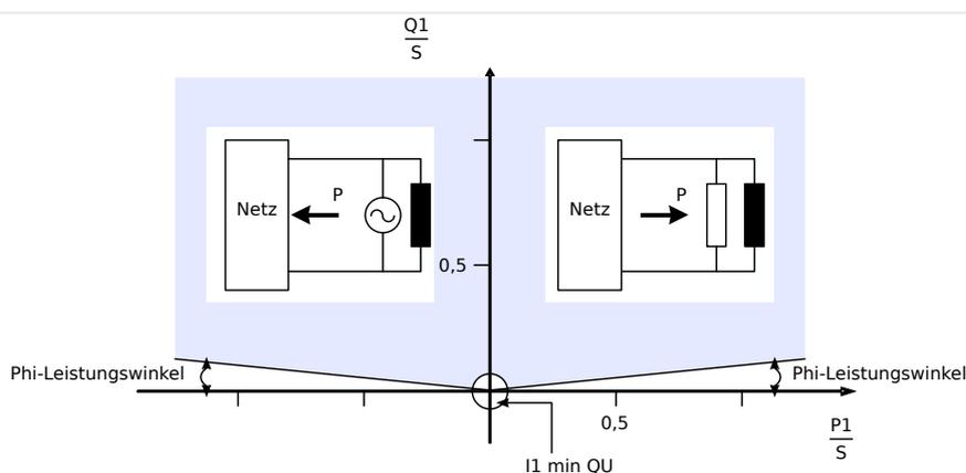
Abb. 89: Variante 1: Leistungswinkelüberwachung.
