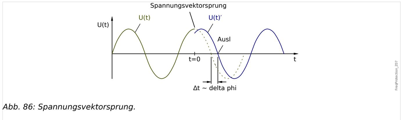
Abb. 86: Spannungsvektorsprung.
