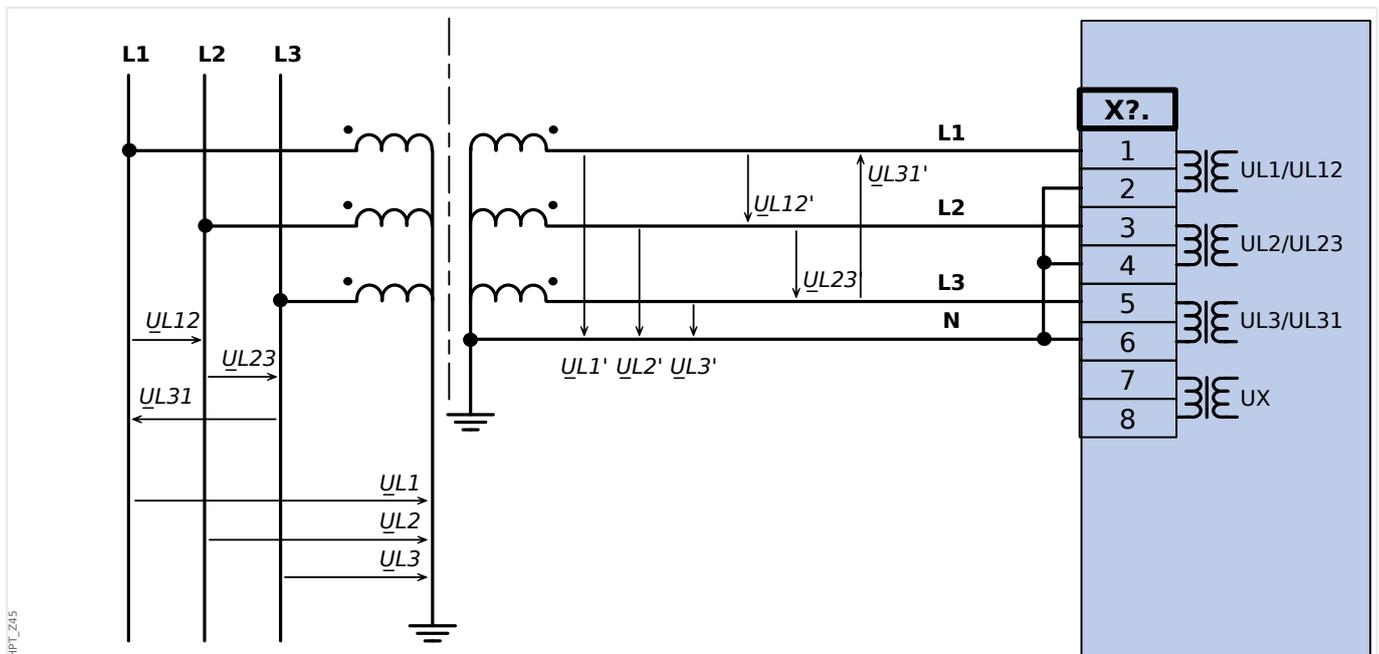
Abb. 30: Drei Spannungswandler mit Geräteanschluss in Sternschaltung
