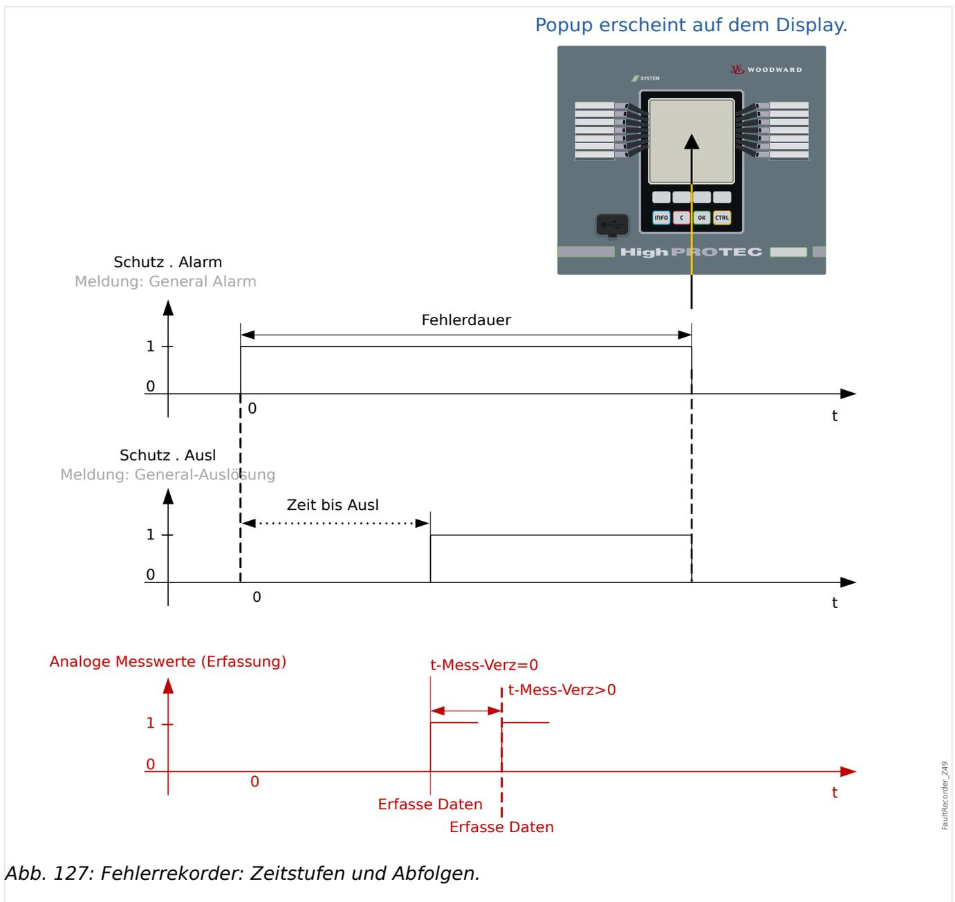
Abb. 127: Fehlerrekorder: Zeitstufen und Abfolgen.
