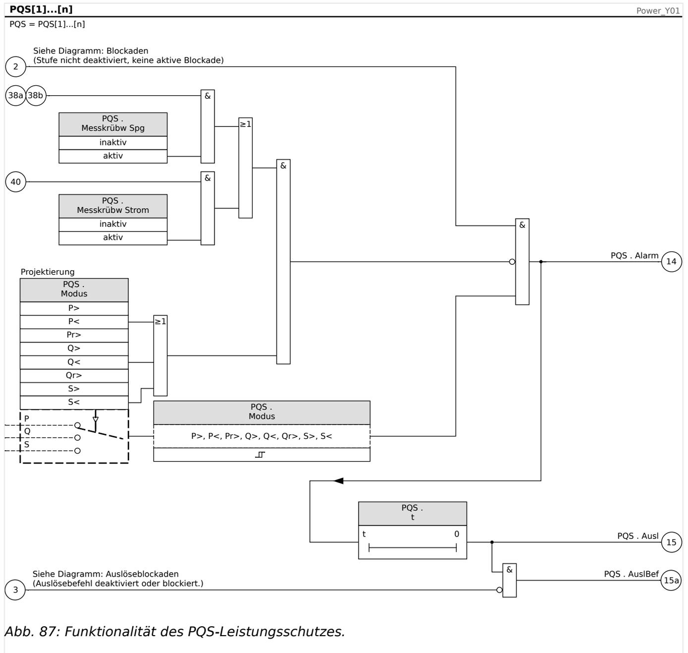
Abb. 87: Funktionalität des PQS-Leistungsschutzes.
