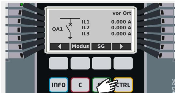
Durch Betätigen des »CTRL«-Softkeys gelangen Sie zu einer Darstellung des Abzweigsteuerbildes. Von hier haben Sie direkten Zugriff auf steuerungsrelevante Daten und Steuerungsfunktionen.
