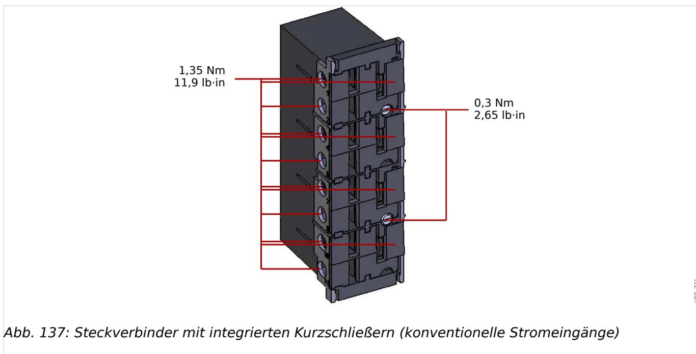
Abb. 137: Steckverbinder mit integrierten Kurzschließern (konventionelle Stromeingänge)
