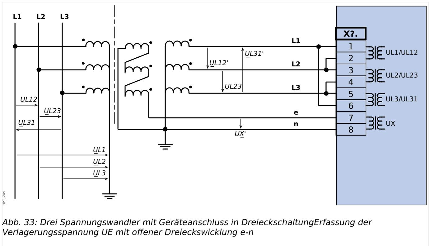
Abb. 33: Drei Spannungswandler mit Geräteanschluss in Dreieckschaltung Erfassung der Verlagerungsspannung UE mit offener Dreieckswicklung e-n
