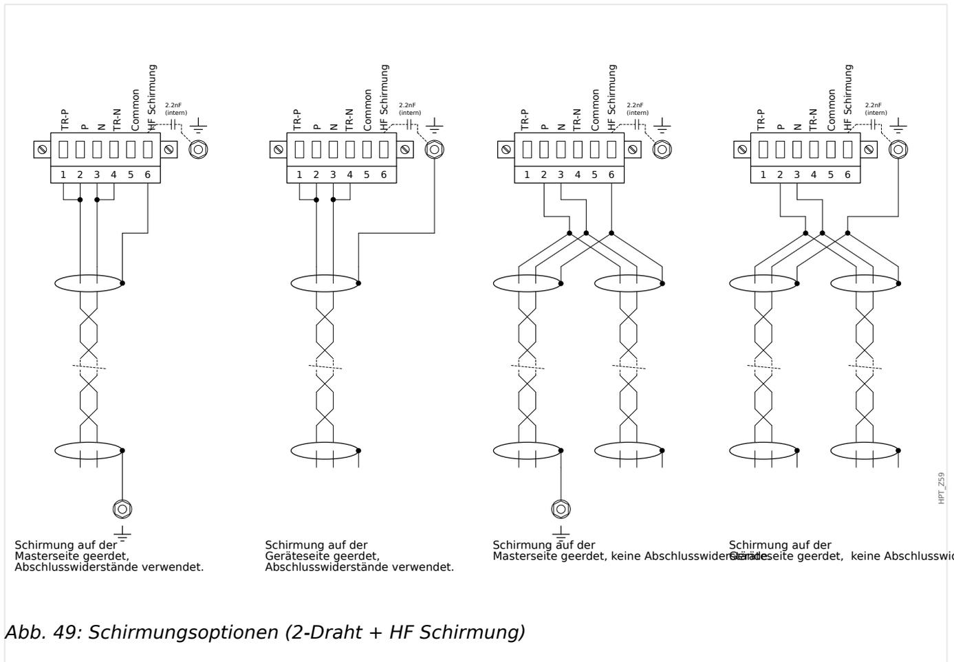
Abb. 49: Schirmungsoptionen (2-Draht + HF Schirmung)
