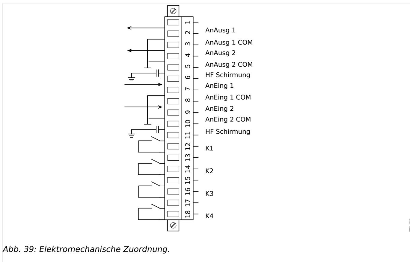
Abb. 39: Elektromechanische Zuordnung.
