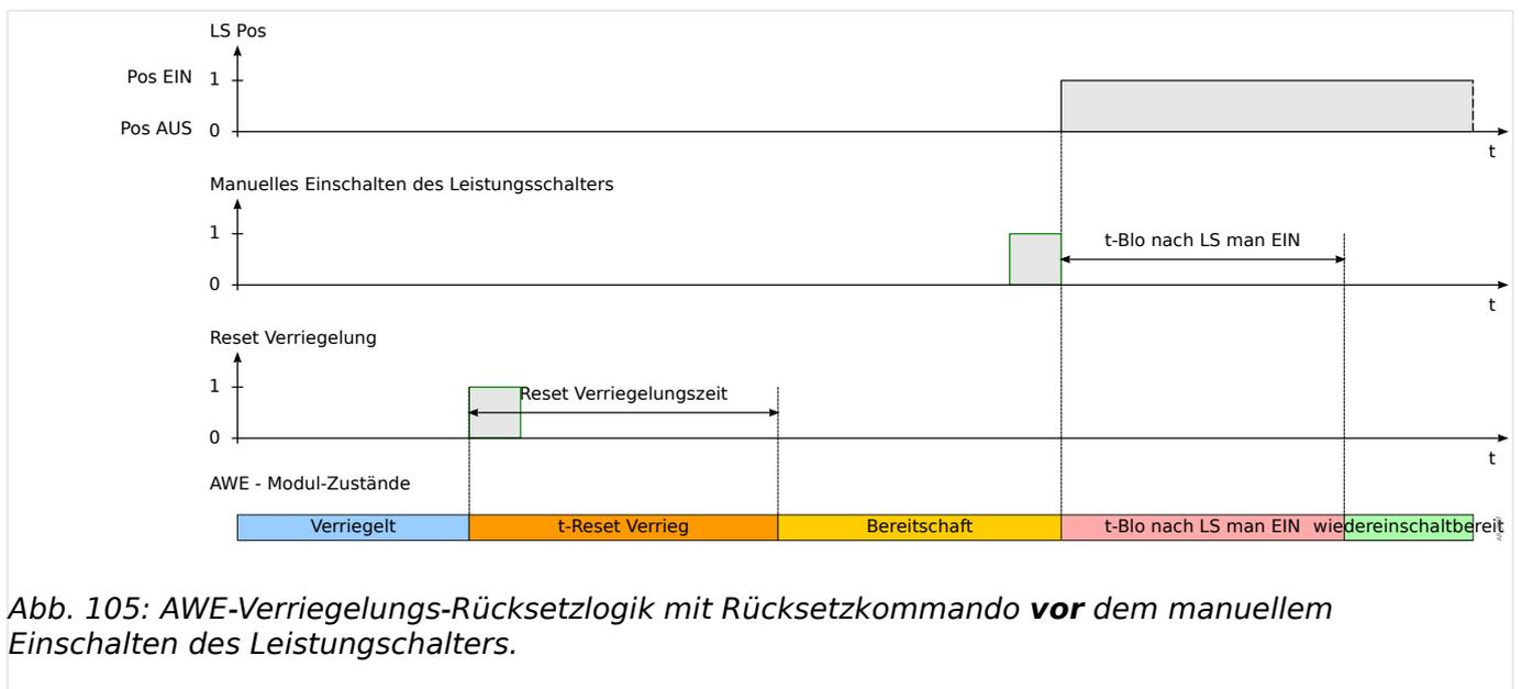
Abb. 105: AWE-Verriegelungs-Rücksetzlogik mit Rücksetzkommando **vor** dem manuellem Einschalten des Leistungsschalters.
