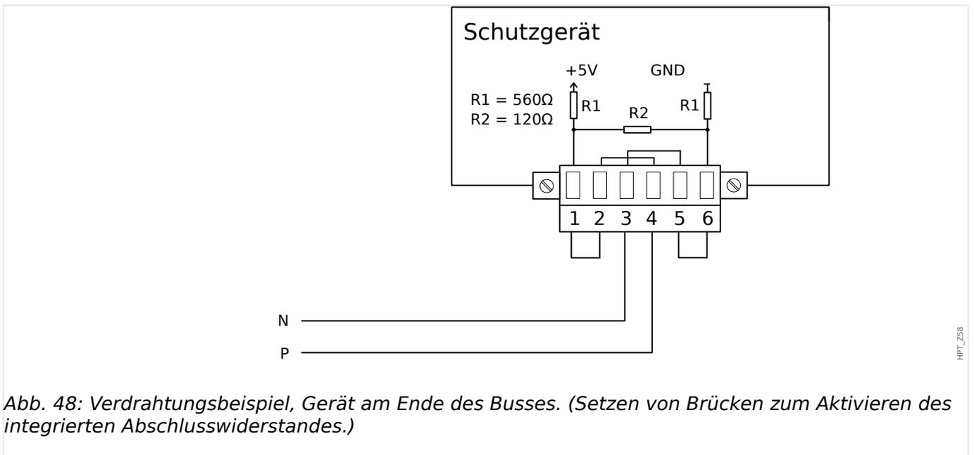
Abb. 48: Verdrahtungsbeispiel, Gerät am Ende des Busses. (Setzen von Brücken zum Aktivieren des integrierten Abschlusswiderstandes.)
