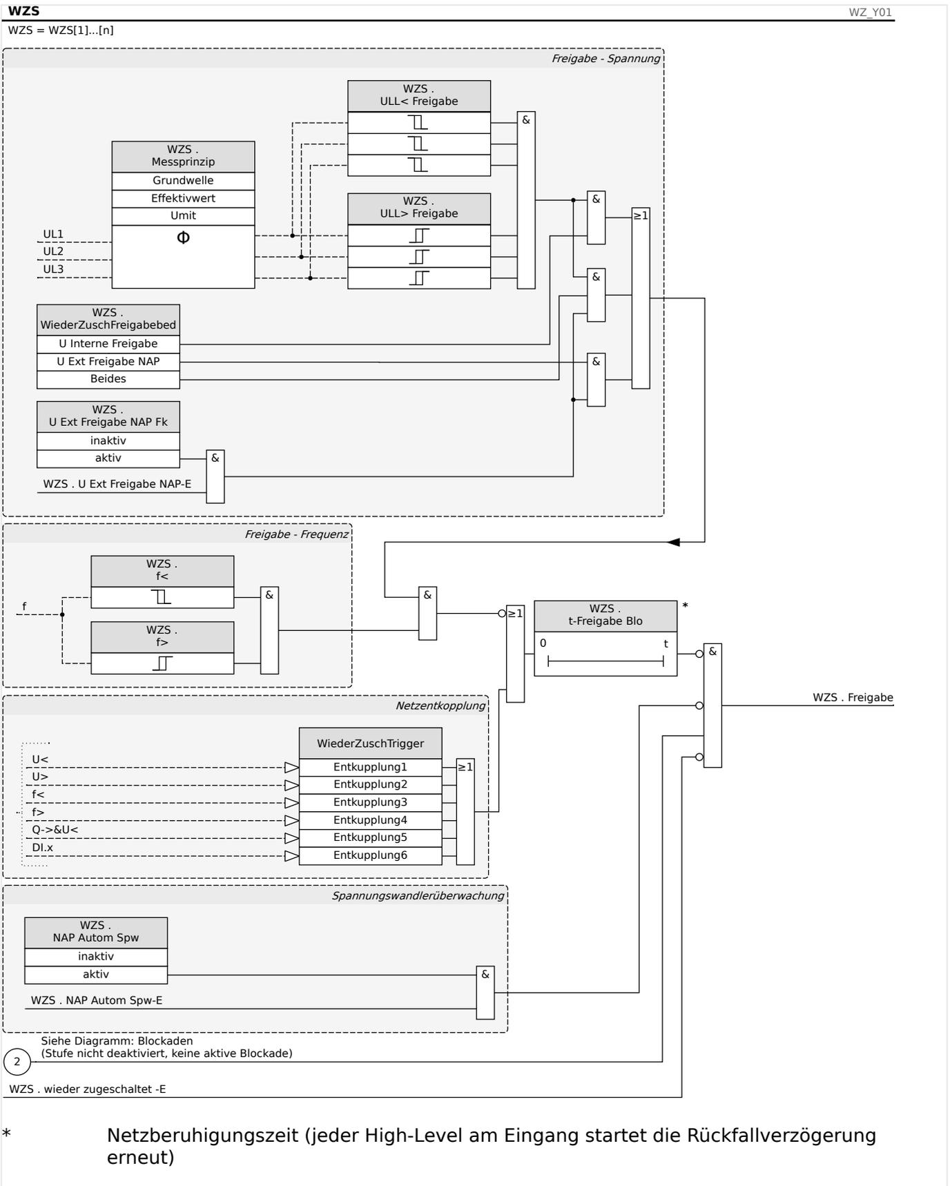
Wenn die Entkopplungseinrichtung am Netzanschlusspunkt ausgelöst hat, hat die Wiederzuschaltung manuell zu erfolgen. Eine spezielle Blockierlogik ist hierzu nicht erforderlich.
