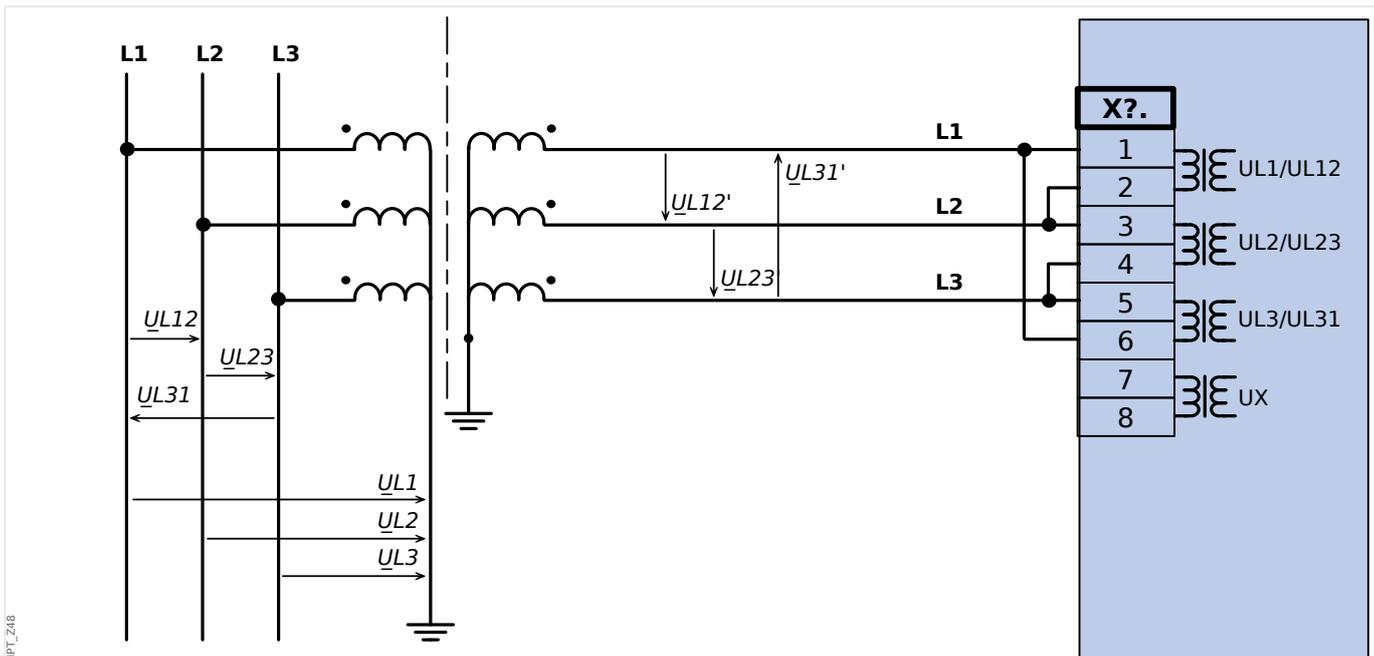
Abb. 32: Drei Spannungswandler mit Geräteanschluss in Dreieckschaltung
