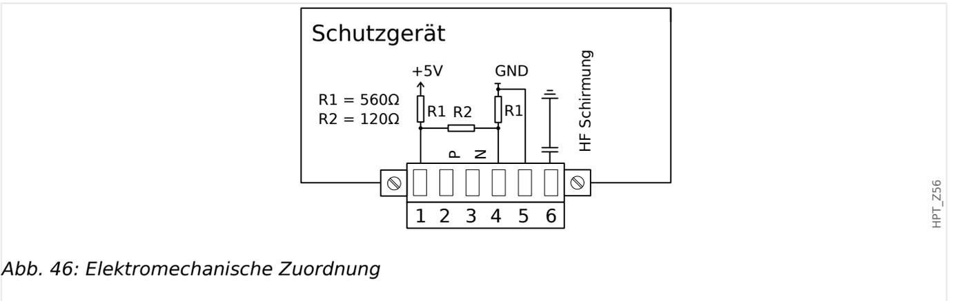
Abb. 46: Elektromechanische Zuordnung
