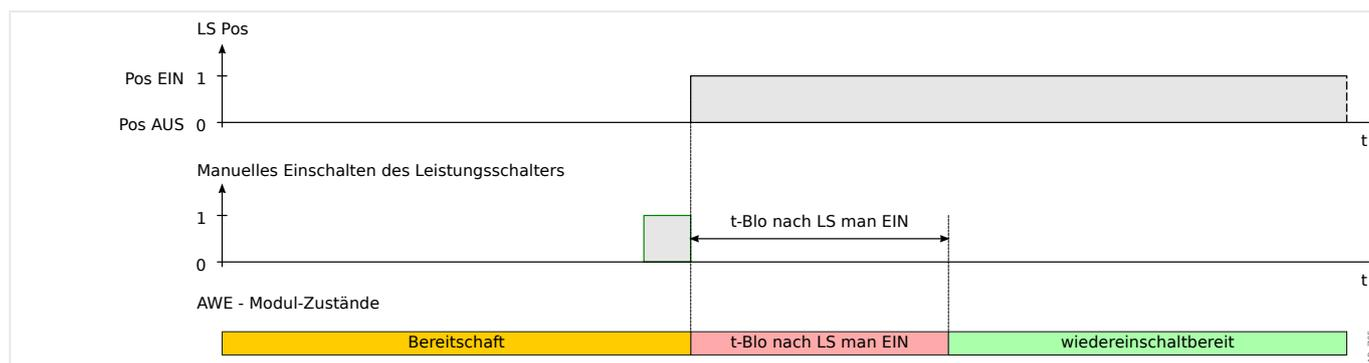
Abb. 103: AWE-Zustände beim manuellen Einschalten des Leistungsschalters.
