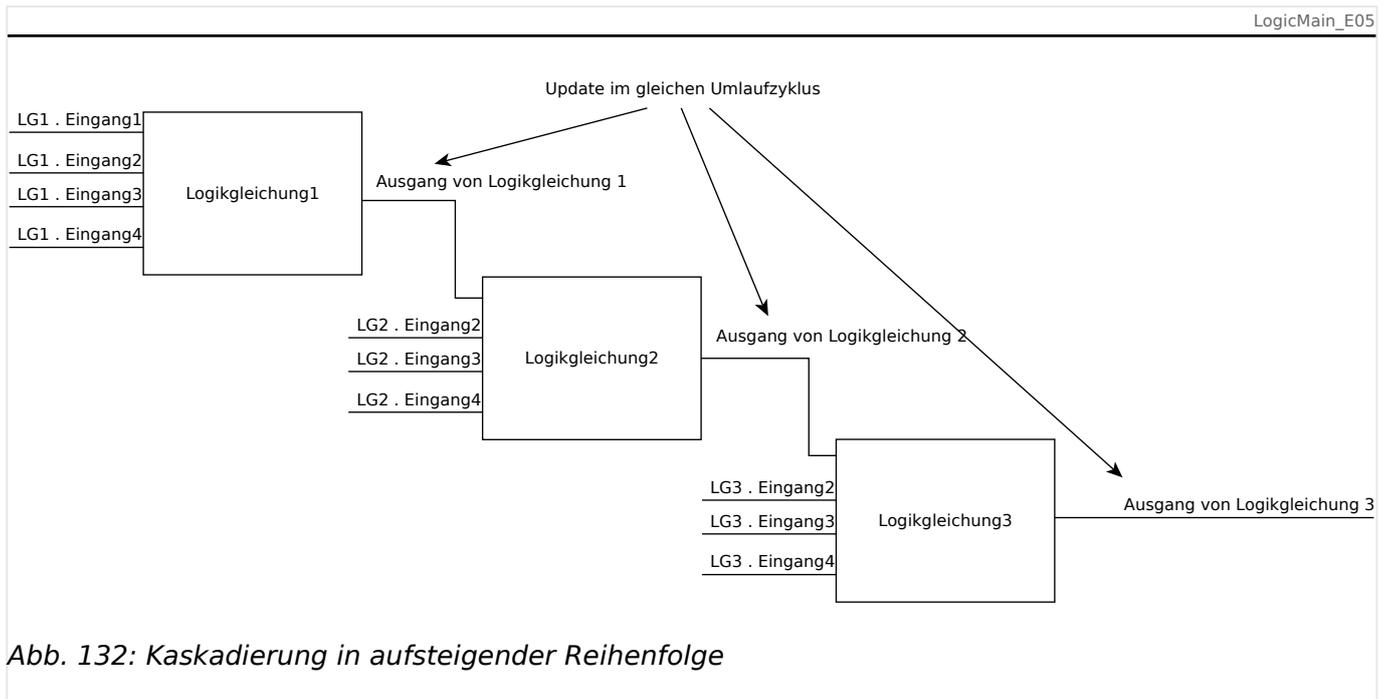
Abb. 132: Kaskadierung in aufsteigender Reihenfolge
