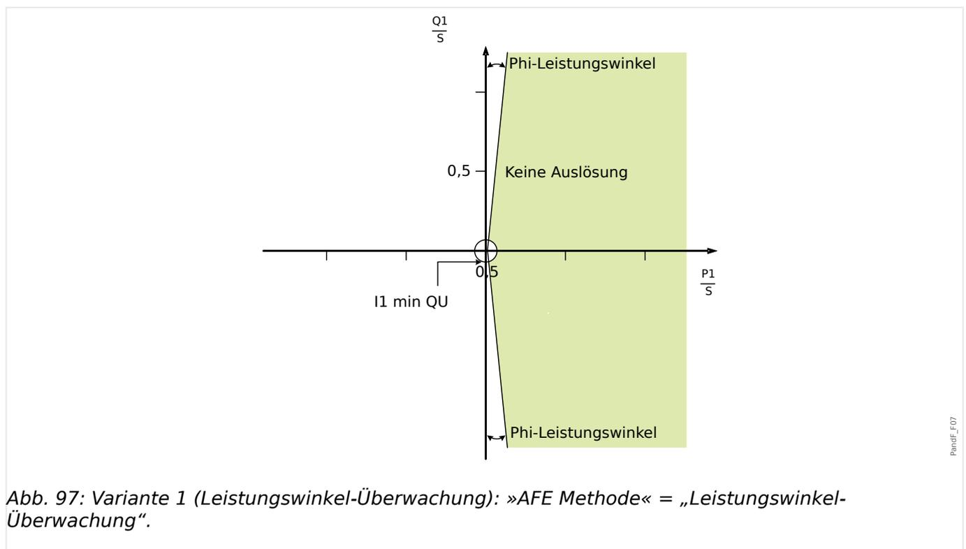
Abb. 97: Variante 1 (Leistungswinkel-Überwachung): »AFE Methode« = „Leistungswinkel-Überwachung“.
