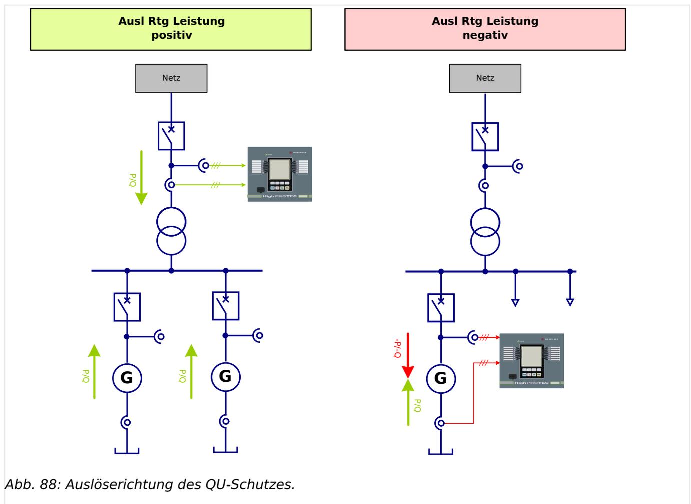
Abb. 88: Auslöserichtung des QU-Schutzes.
