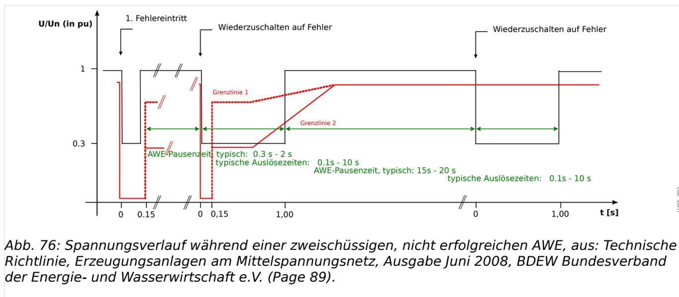
Abb. 76: Spannungsverlauf während einer zweischüssigen, nicht erfolgreichen AWE, aus: Technische Richtlinie, Erzeugungsanlagen am Mittelspannungsnetz, Ausgabe Juni 2008, BDEW Bundesverband der Energie- und Wasserwirtschaft e.V. (Page 89).
