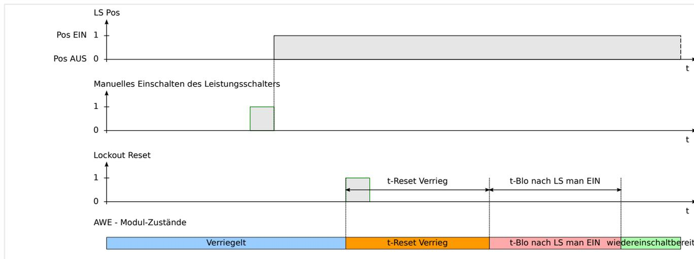
Abb. 106: AWE-Verriegelungs-Rücksetzlogik mit Rücksetzkommando **nach** dem manuellem Einschalten des Leistungsschalters.
