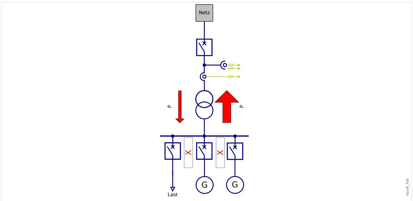
Abb. 96: Dezentraler Einsatz in Teilnetzen mit überwiegender Rückspeisung.
