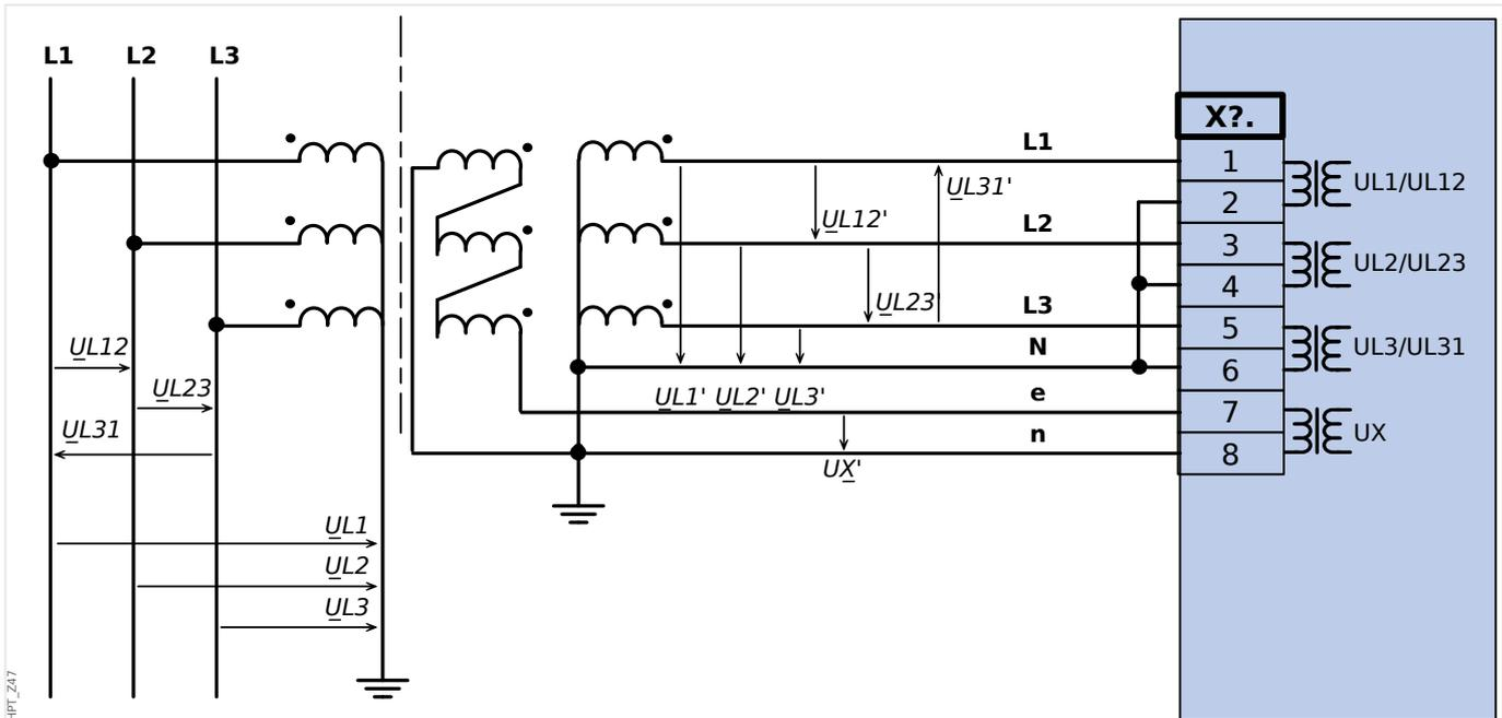
Abb. 31: Spannungswandler mit Geräteanschluss in offener Dreieckschaltung.
