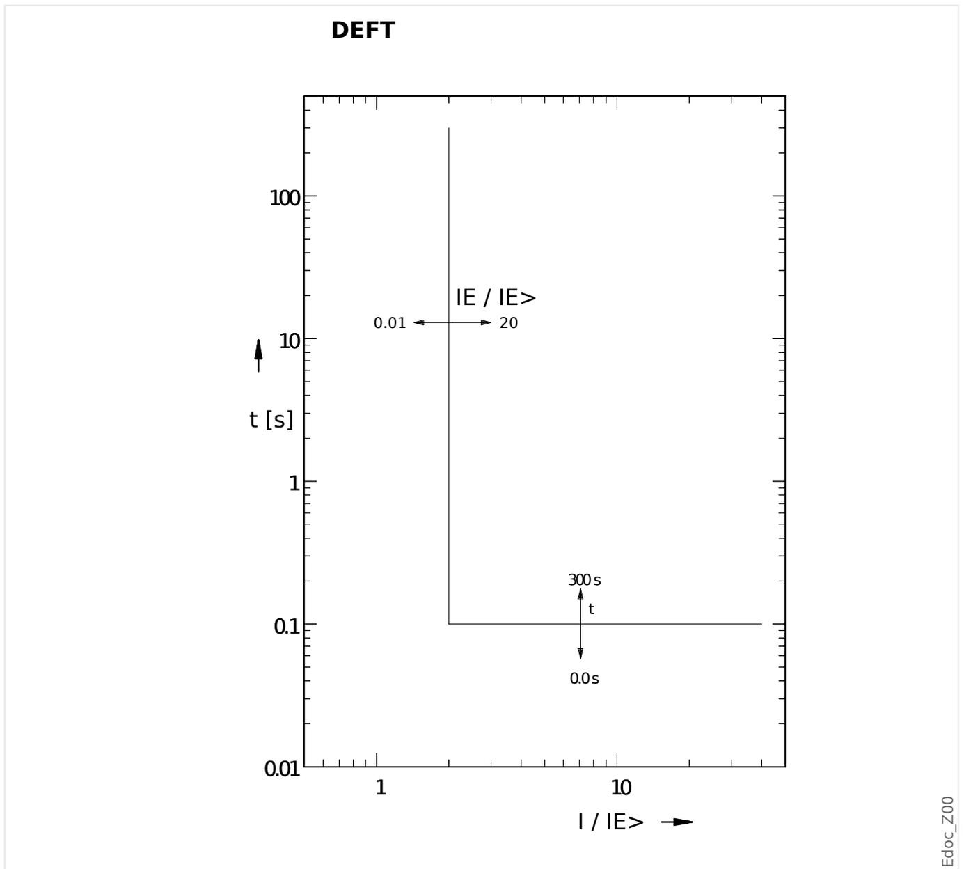
Die Auslöseverzögerung für  $I_E > I_{E>}$  ist einstellbar über [Schutzparameter / Satz 1...4 / I-Schutz /  $I_{E[x]}$ ] »t«.
