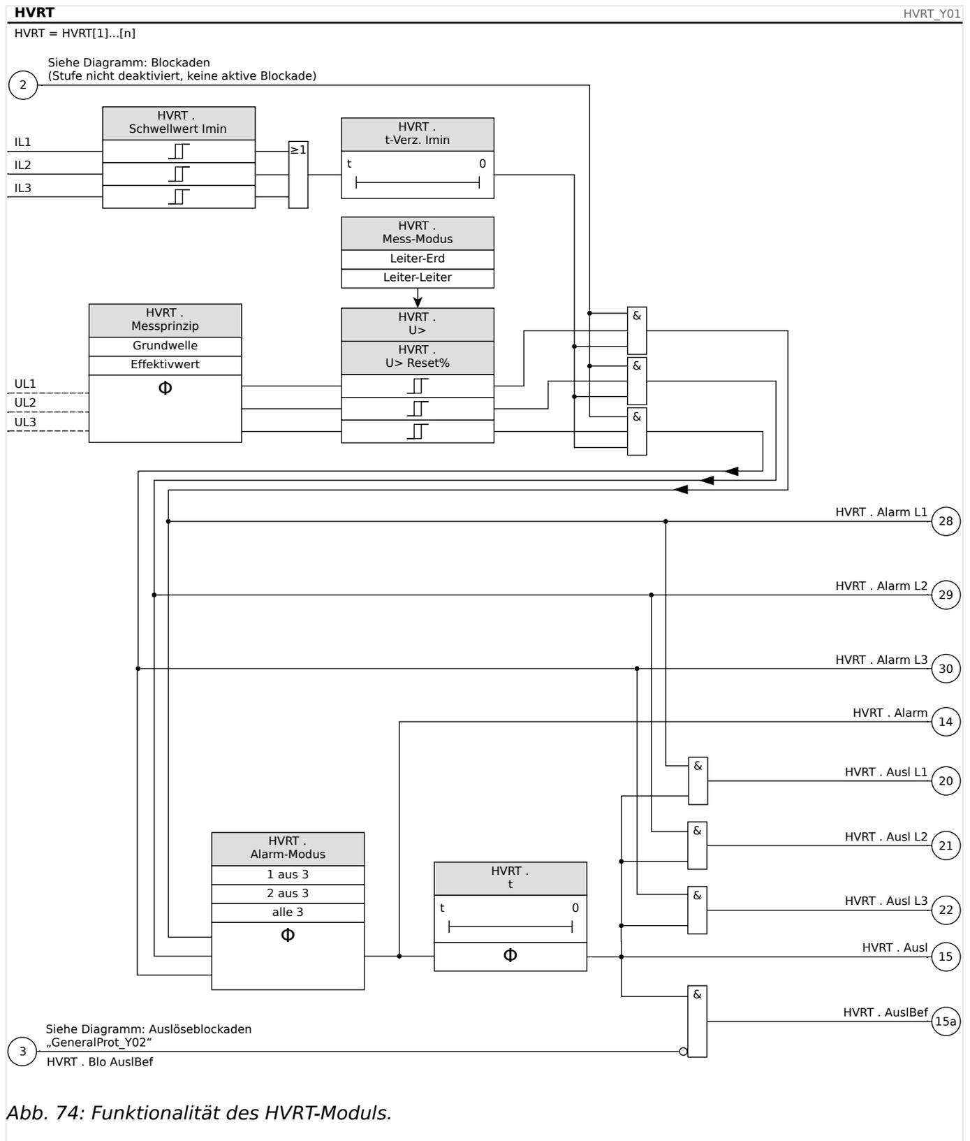
Abb. 74: Funktionalität des HVRT-Moduls.
