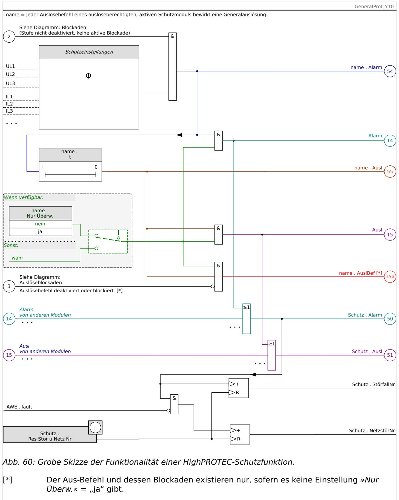
Das Diagramm zeigt das grundlegende Konzept hinter einer Schutzfunktion. (Beachten Sie dennoch, dass es bei den implementierten Schutzfunktionen gerätespezifische und auch schutzspezifische Unterschiede geben kann: Einige Gerätetypen haben keine Spannungsmessung, andere keine Strommessung, einige Schutzfunktionen verfügen über
