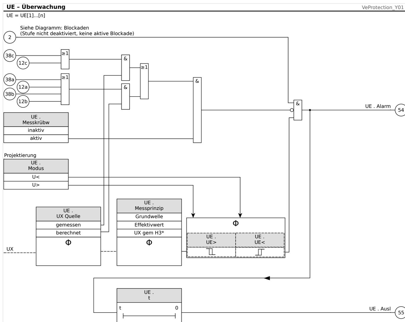
Abb. 79: UE/UX-Spannungsüberwachung, Teil 1 (Überwachungsfunktion, Auslöse-Entscheid).
