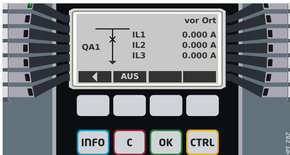
Abb. 117: Beispiel einer Steuer-Seite mit geschlossenem „Leistungsschalter“.
