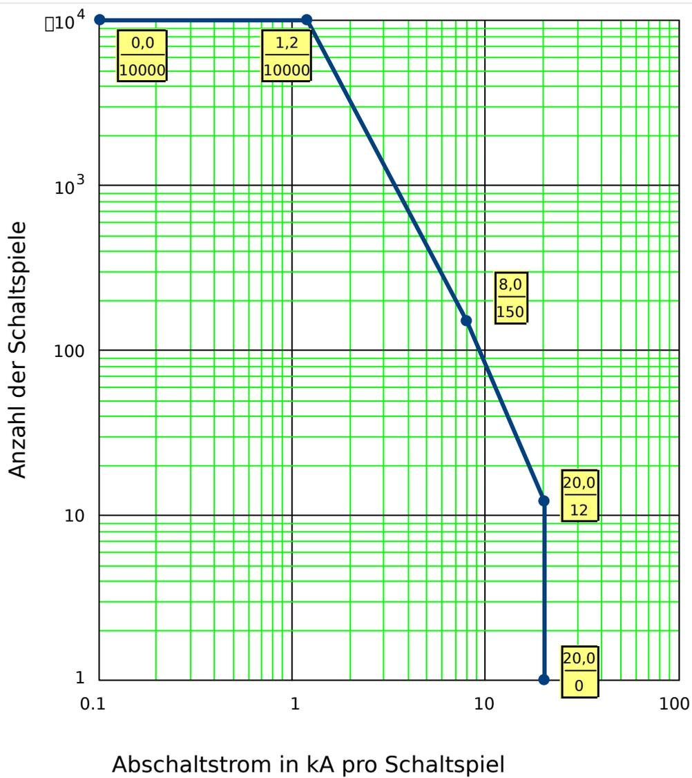
Abb. 122: Wartungskurve für einen typischen 25 kV Leistungsschalter
