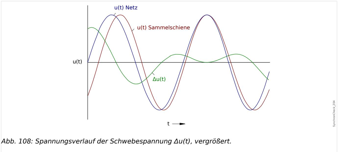
Abb. 108: Spannungsverlauf der Schwebespannung  $\Delta u(t)$ , vergrößert.
