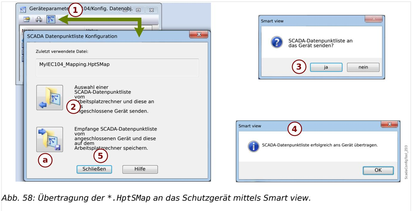
Abb. 58: Übertragung der \*.HptSMap an das Schutzgerät mittels Smart view.
