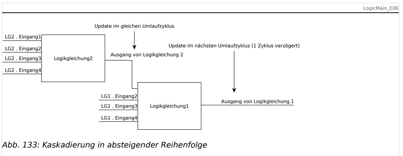
Abb. 133: Kaskadierung in absteigender Reihenfolge
