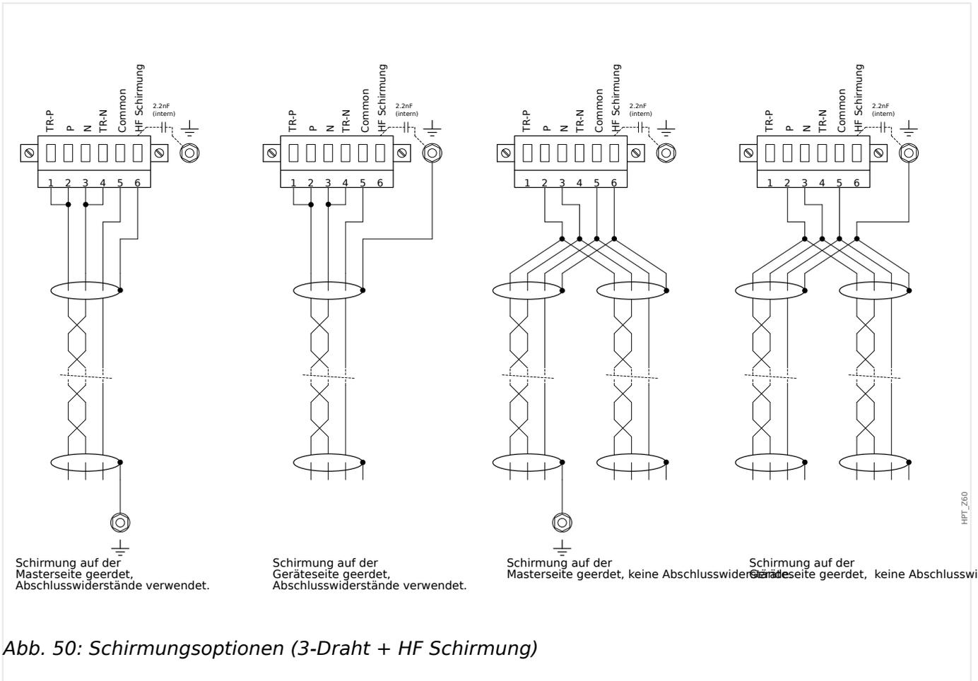
Abb. 50: Schirmungsoptionen (3-Draht + HF Schirmung)
