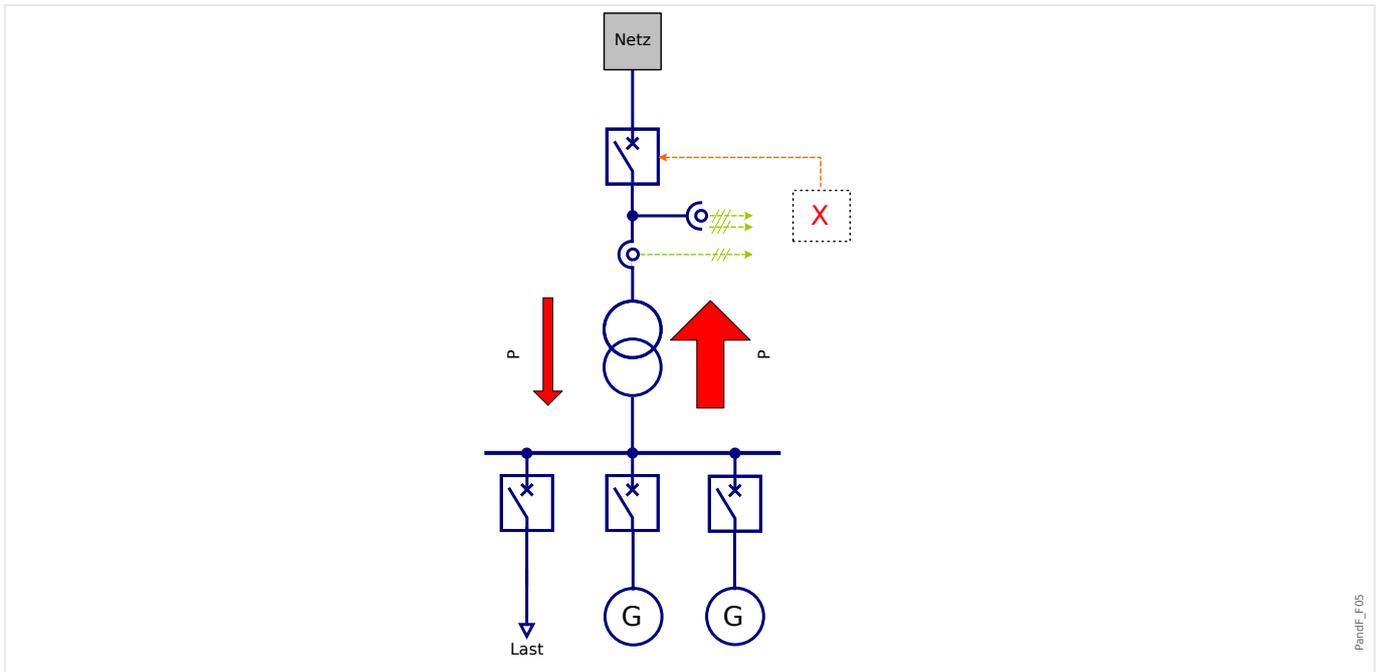
Abb. 95: Zentraler Einsatz in Teilnetzen mit überwiegender Rückspeisung.
