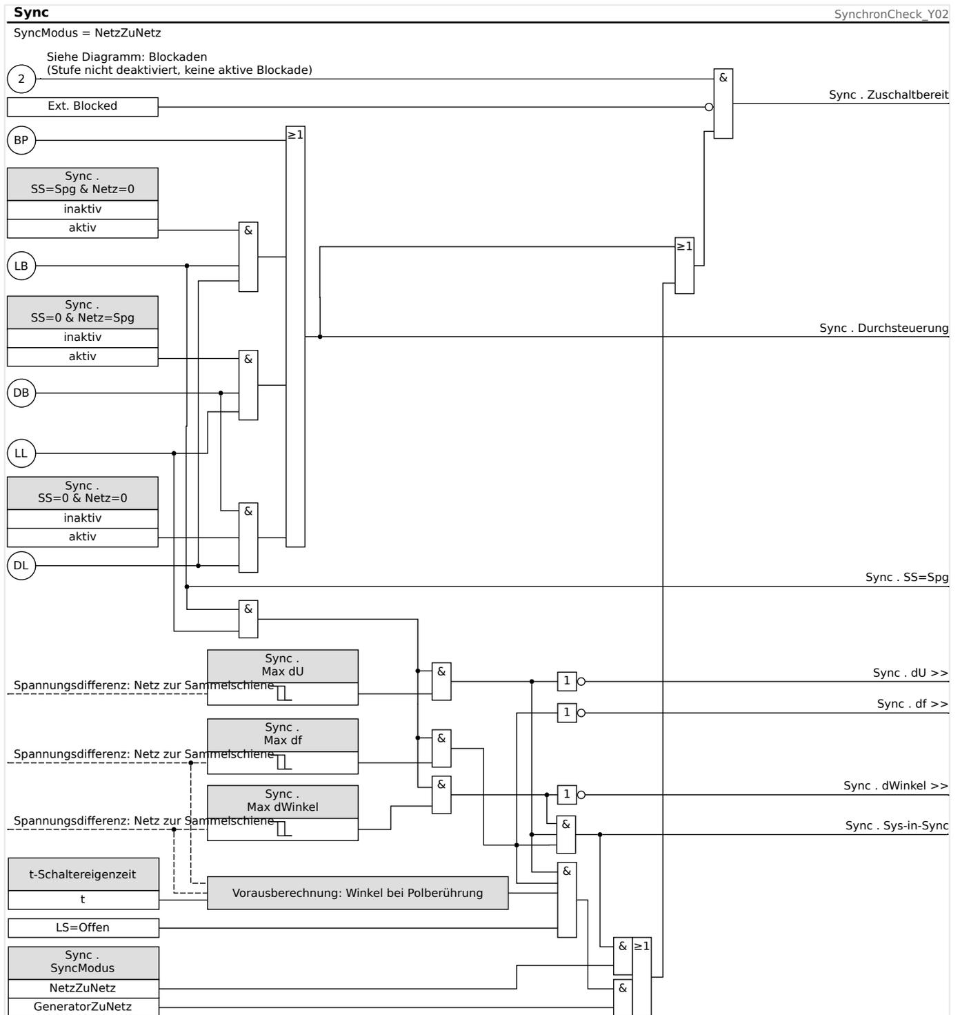
Abb. 110: Funktionalität des »Sync«-Moduls, „NetzZuNetz“.
