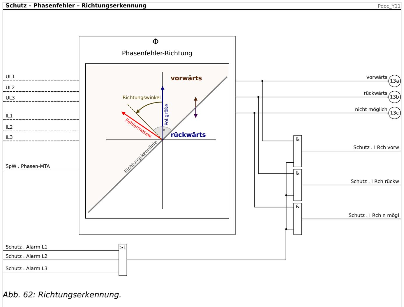
Das MRA4 ermittelt den Winkel zwischen dem Phasenstrom mit der größten Stromstärke (*Fehlermesswert*) und der Leiter-Leiter-Spannung der anderen Phasen (*Polarisationsgröße*). Im Falle eines dreiphasigen Fehlers, bei dem die Leiter-Leiter-Spannung zu klein für eine Richtungserkennung ist, wird ein Spannungsspeicher verwendet.
