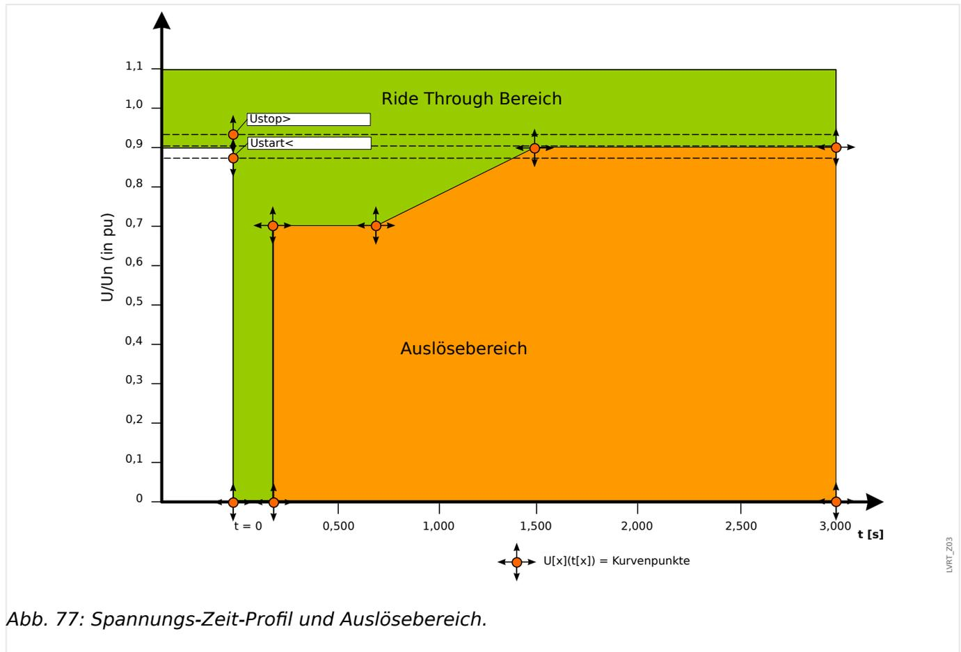
Abb. 77: Spannungs-Zeit-Profil und Auslösebereich.
