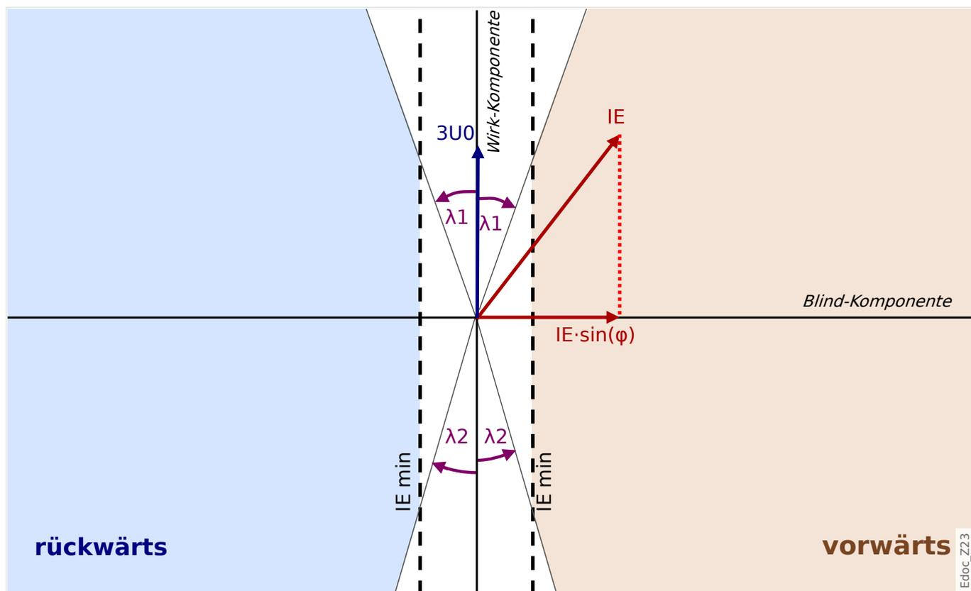
Abb. 65: Richtungserkennung nach der Methode „sin( $\phi$ )“.
