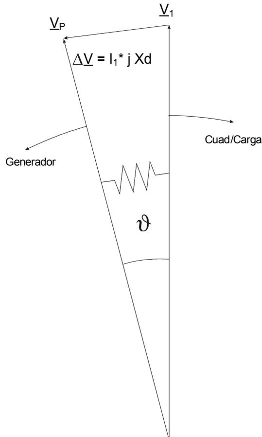
El ángulo de desplazamiento del rotor entre el estator y el rotor dependen del par de movimiento mecánico del generador. La potencia del eje mecánico con la alimentación de la red eléctrica y, por lo tanto, la velocidad sincrónica se mantiene constante.
