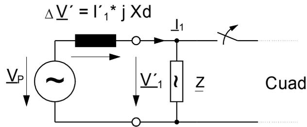
En caso de fallo de la red de suministro eléctrico o del reconector automático, el generador alimentará bruscamente un carga de consumo muy alta. El ángulo de desplazamiento del rotor disminuye repetidamente y el vector de tensión  $V_1$  modifica su dirección ( $V_1'$ ).
