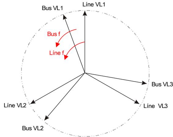
Si la frecuencia del generador  $f_{\text{Bus}}$  no es igual a la frecuencia de la red  $f_{\text{Line}}$ , provoca una frecuencia de deslizamiento
