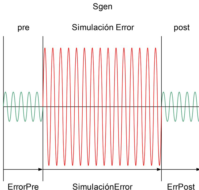
Los contadores de energía se detendrán mientras el simulador de errores esté funcionando.
