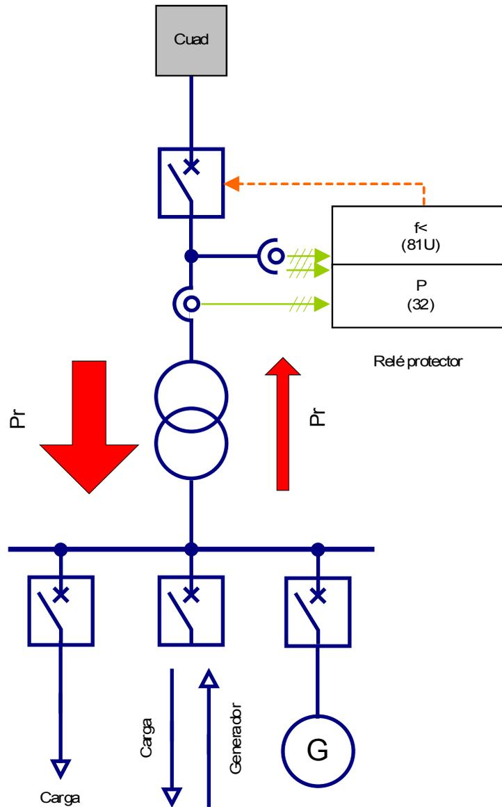
*Reducción de carga descentralizada por subfrecuencia en redes eléctricas con alimentación temporal*
