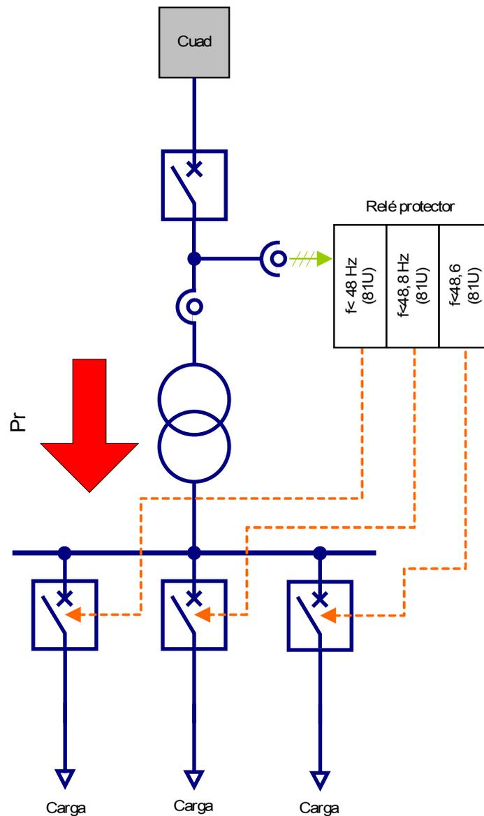
*Reducción de carga centralizada por subfrecuencia en redes eléctricas con alimentación temporal*
