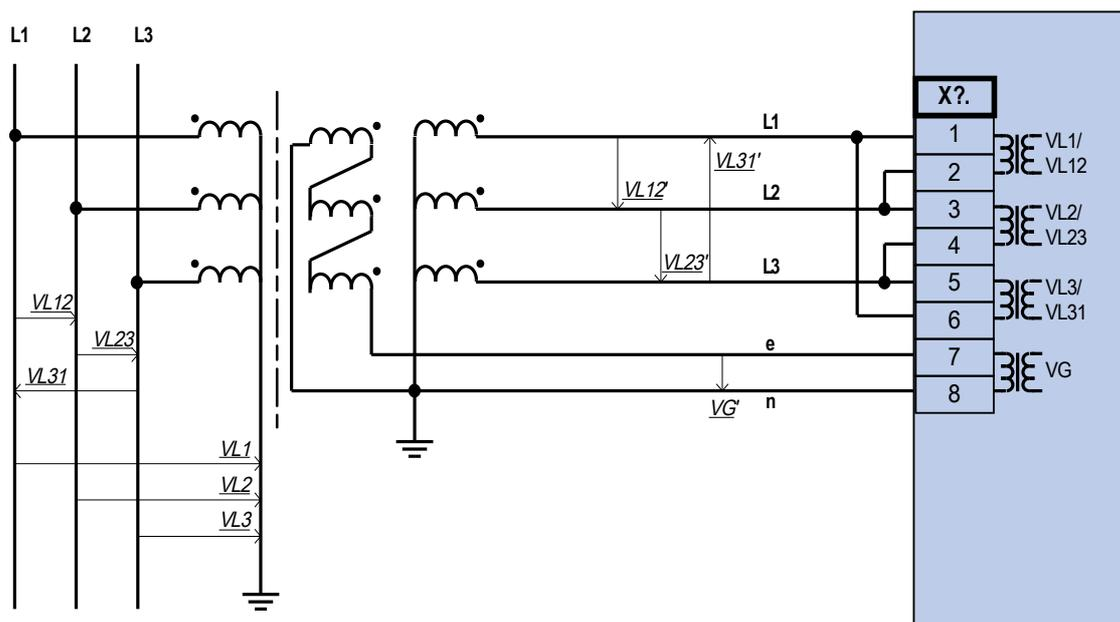
Medida de voltaje trifásico: cableado de las entradas de medida: "abr. delta"
