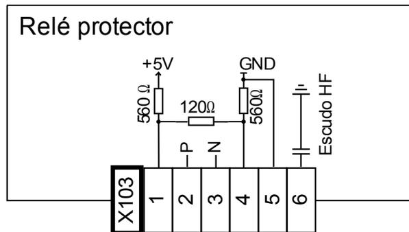
*Asignación electromecánica Tipo 2 (véase diagrama de cableado)*
