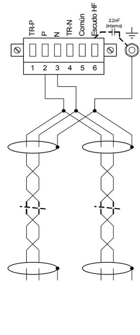
Blind. en lado disp. bus conectado a resistores terminac. tierra no usados
