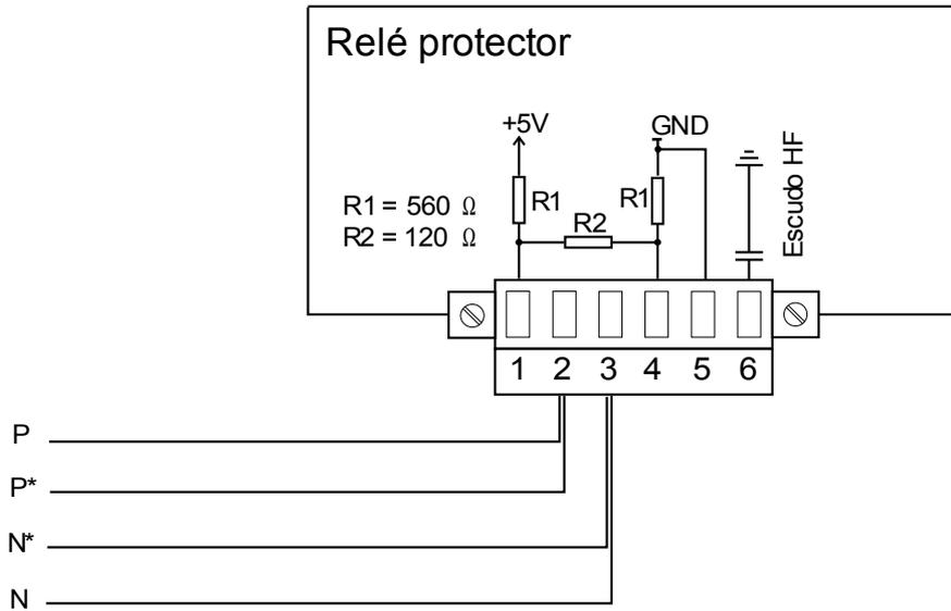
Ejemplo de cableado de tipo 2, Dispositivo al final de BUS (con el resistor de terminal integrado)
