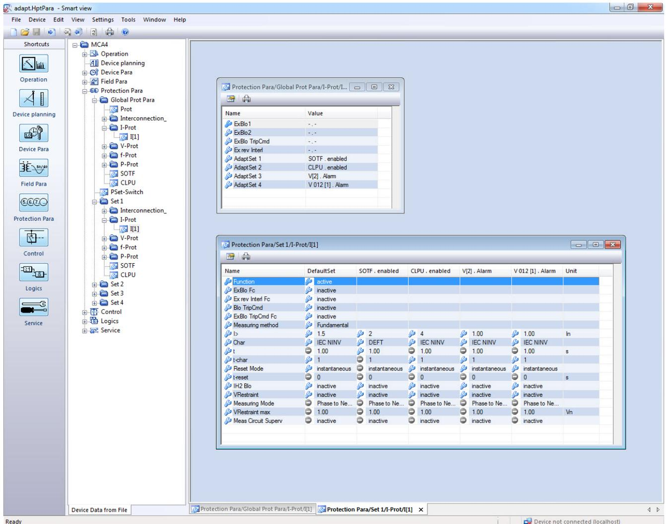
La captura anterior muestra las configuraciones de ajuste adaptativo tras las aplicaciones basadas solo en un elemento de protección de sobrecorriente simple:
