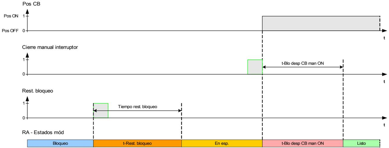
*Lógica de reinicio de bloqueo de RA en caso de que el reinicio de bloqueo llegue después de que se cierre el interruptor manual*
