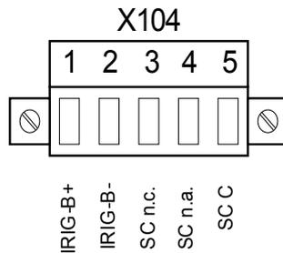
El contacto "Sistema OK" (relé SC) no puede configurarse. El contacto de sistema es un contacto de conmutación que arranca cuando el dispositivo está libre de fallos internos. Mientras el dispositivo se está iniciando, el relé Sistema OK (SC) permanece desactivado. Tan pronto como el sistema se inicia (y la protección está activa), arranca el contacto de sistema y el LED asignado se activa (consulte el capítulo Supervisión automática).
