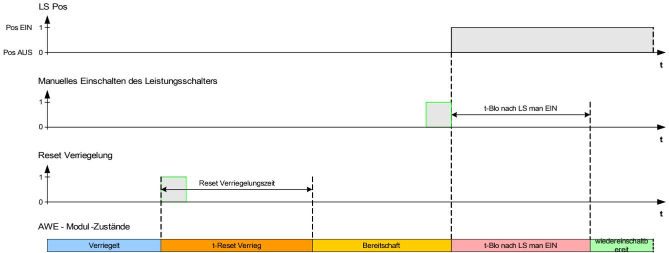
*AWE Verriegelungs-Rücksetzlogik mit Rücksetzkommando nach dem manuellem Einschalten des Leistungsschalters*
