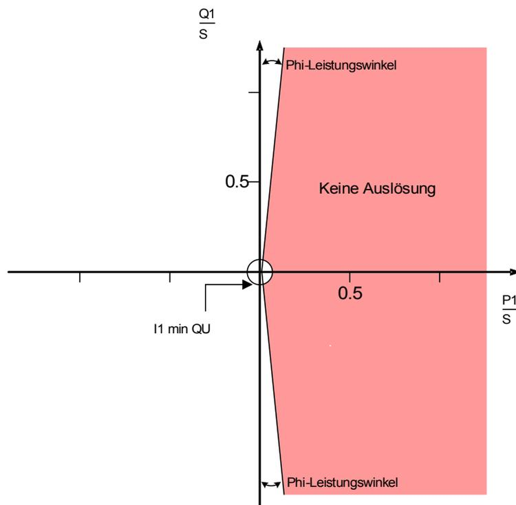
AFE-Variante = Leistungswinkelüberwachung
