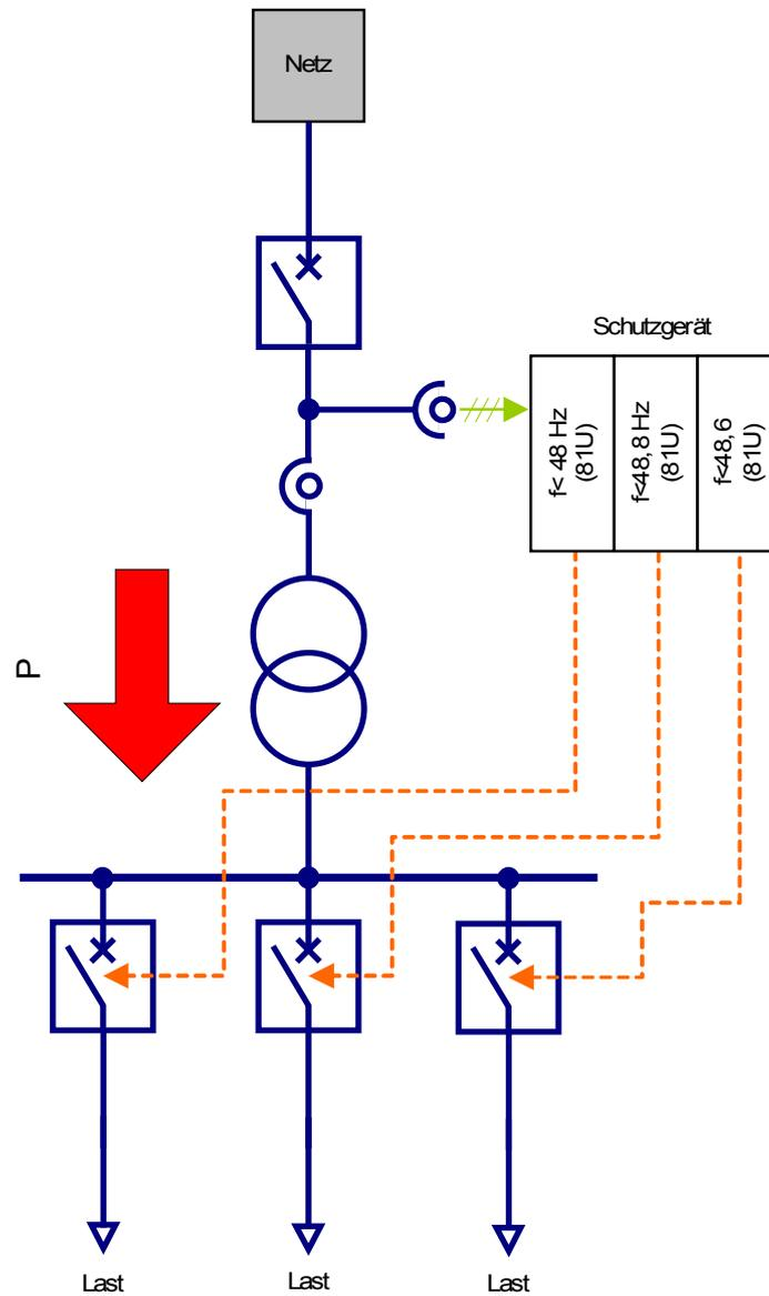
*Zentrale Automatische Frequenzentlastung in Netzen mit zeitweiser Rückspeisung*
