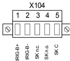
Der *Selbstüberwachungskontakt (SK)* kann nicht konfiguriert werden. Der Selbstüberwachungskontakt ist ein Wechselkontakt, der abfällt, wenn das Gerät einen internen Fehler erkennt. Nach Umschalten der Versorgungsspannung zieht der Kontakt nach Abschluss des Bootvorgangs (wenn der Schutz aktiv ist) an. Mit dem Anziehen des Selbstüberwachungskontakts wird auch die entsprechende LED aktiviert (siehe auch Kapitel Selbstüberwachung).
