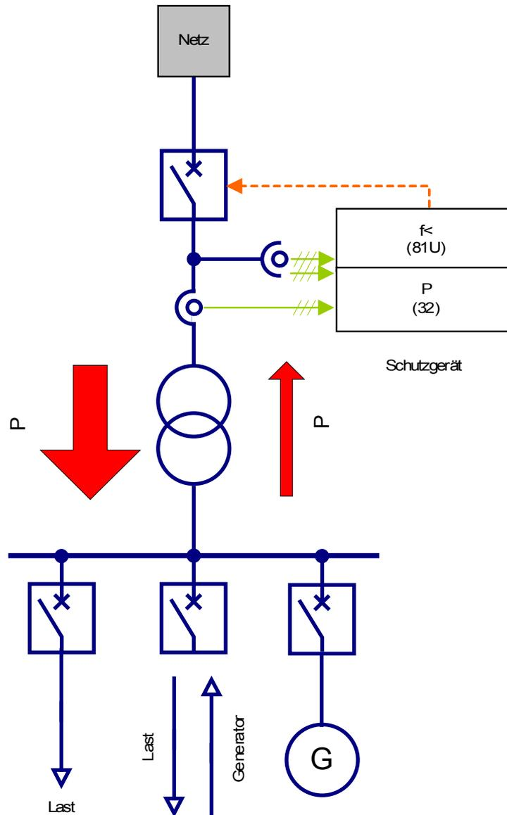
*Dezentrale Automatische Frequenzentlastung in Netzen mit zeitweiser Rückspeisung*
