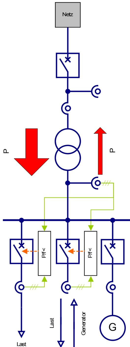
*Zentraler Einsatz in Teilnetzen mit überwiegender Rückspeisung*
