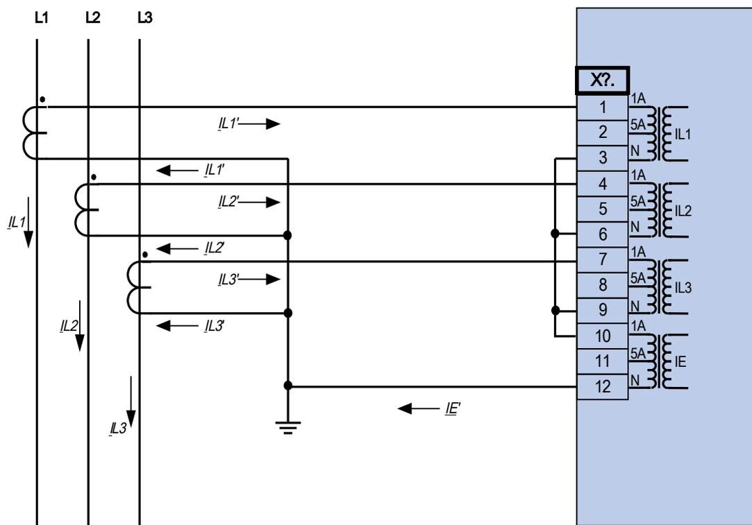
Dreiphasiger Stromwandleranschluss; In sekundär = 1 A.
