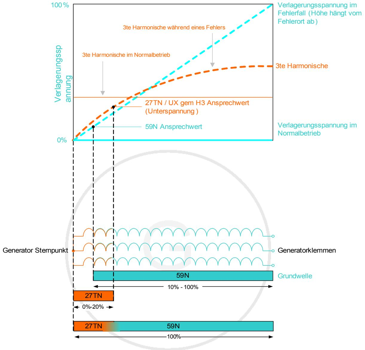
verhindert Fehlauflösung bei Spannungslosigkeit / Generatorstillstand
