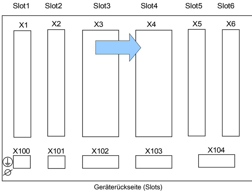
In diesem Slot befinden sich die Spannungswandler-Messeingänge.
