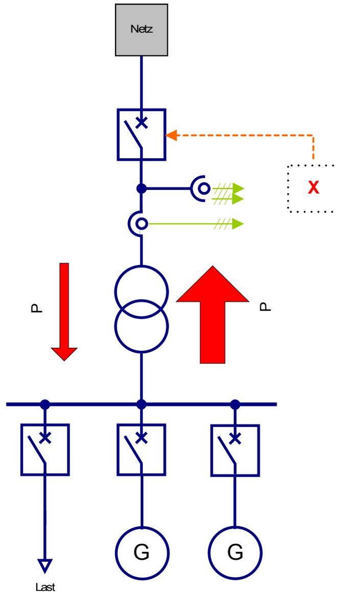
*Dezentraler Einsatz in Teilnetzen mit überwiegender Rückspeisung*
