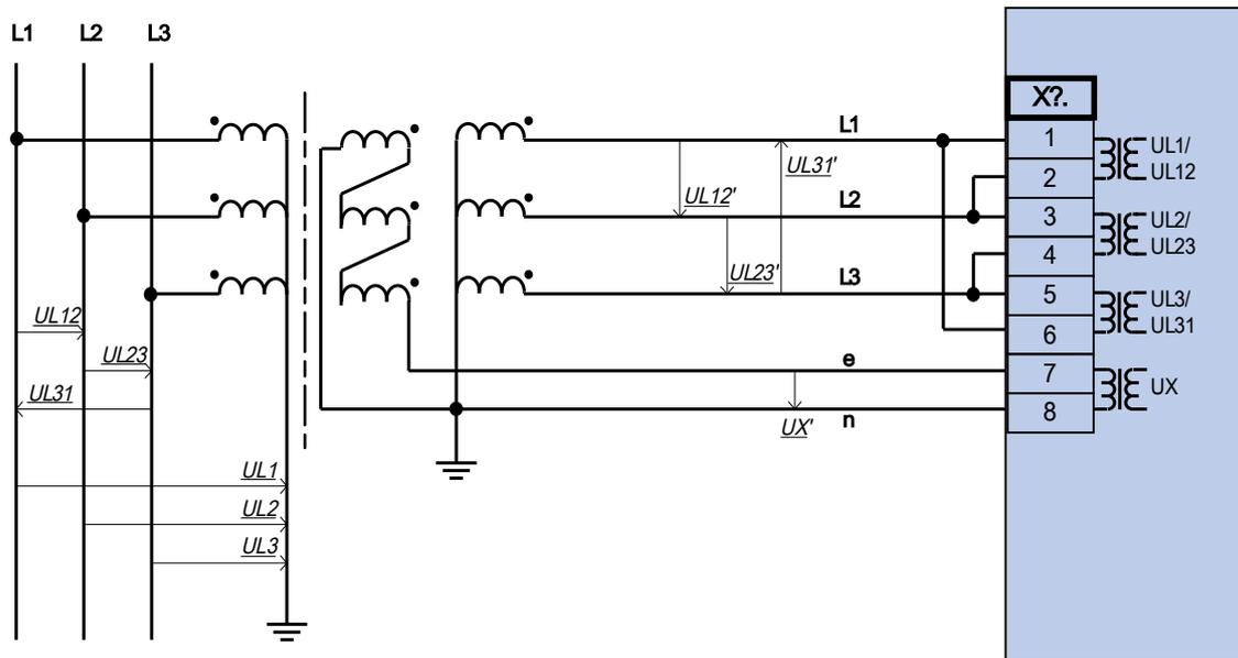
Drei Spannungswandler mit Geräteanschluss in Dreieckschaltung
