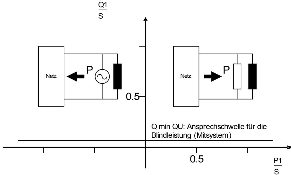
Durch die Mindeststromüberwachung (I1) im Mitsystem kann eine mögliche Überfunktion der Blindleistungsüberwachung im unteren Leistungsbereich verhindert werden.
