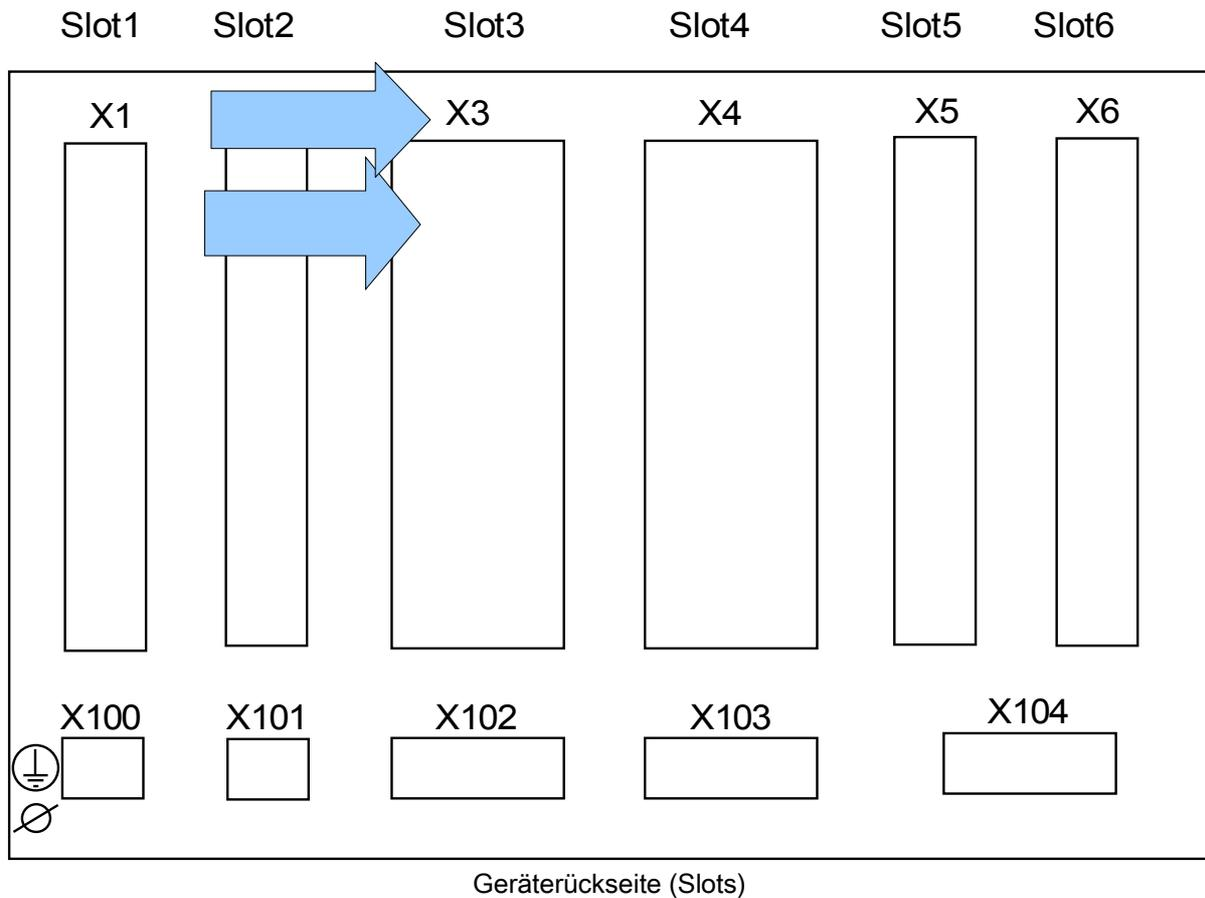
In diesem Slot befinden sich die Strommesseingänge.
