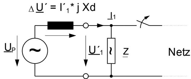
Bei einem Netzausfall oder bei einer KU speist der Generator plötzlich eine sehr große Verbraucherlast. Der Polradwinkel vergrößert sich sprunghaft und der Spannungsvektor  $\underline{U}_1$  ändert seine Richtung ( $\underline{U}'_1$ ).
