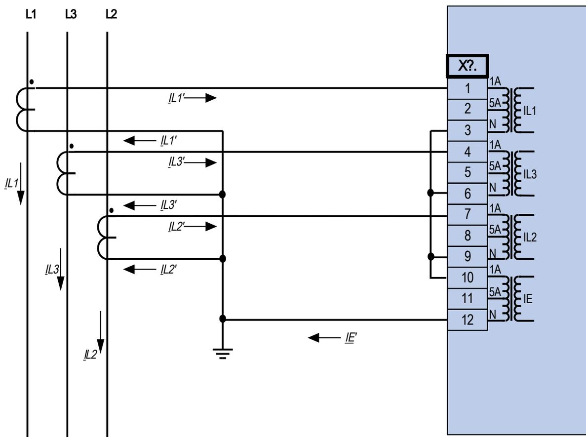
Dreiphasiger Stromwandleranschluss;  $I_n$  sekundär = 1 A.
