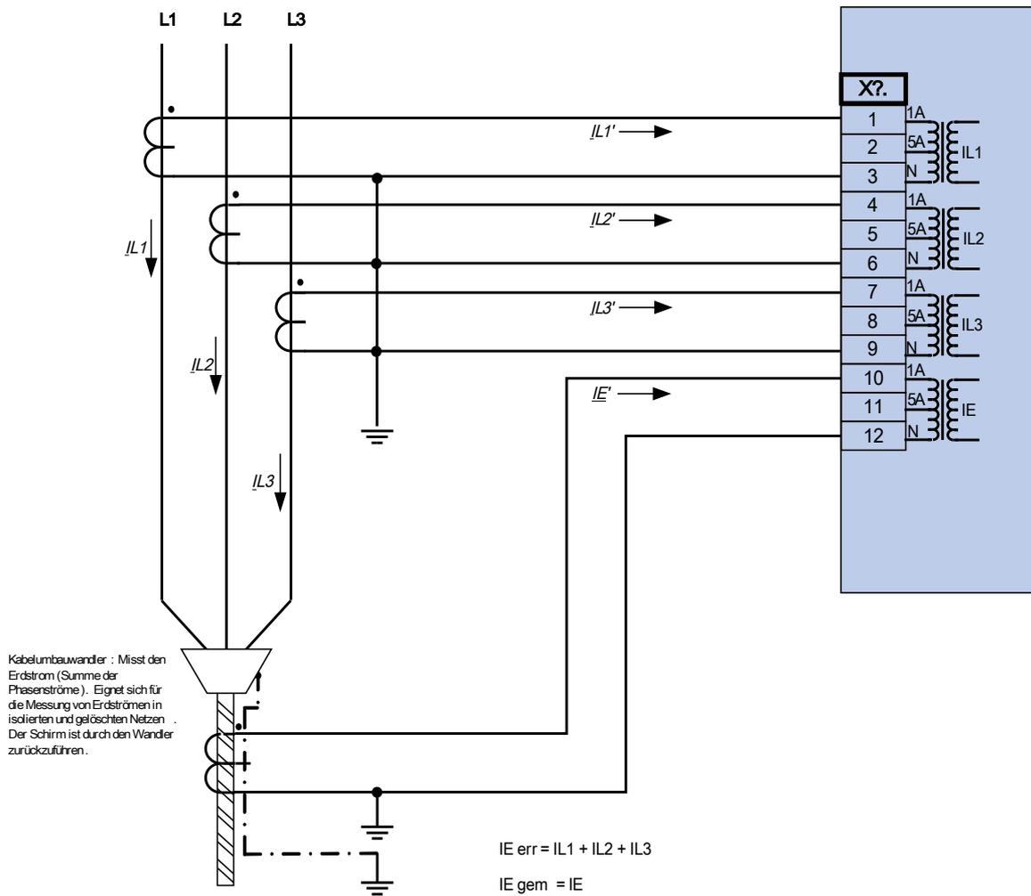
Dreiphasiger Stromwandleranschluss;  $I_n$  sekundär = 1 A.
