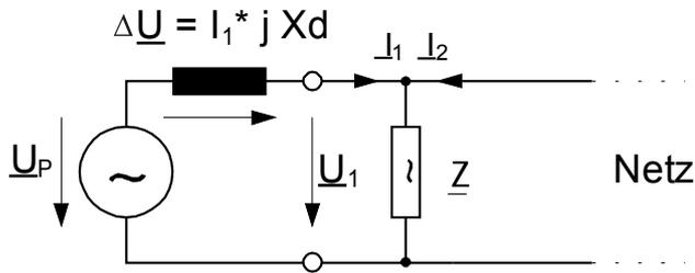
Polradwinkel bei konstanter Belastung des Generators
