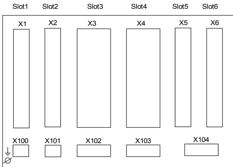
B2 Gehäuse prinzipielle Rückansicht
