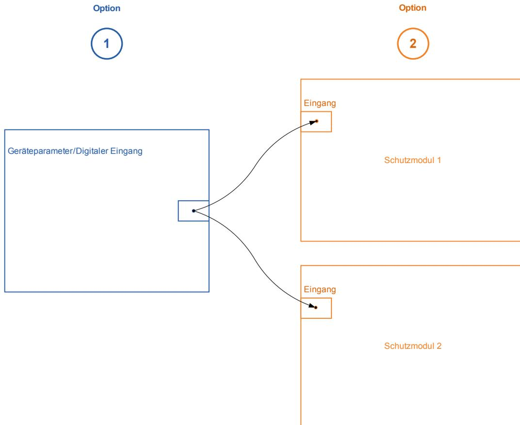
**Option 1** - Einen Digitalen Eingang (einem/mehreren) Modulen zuweisen.
