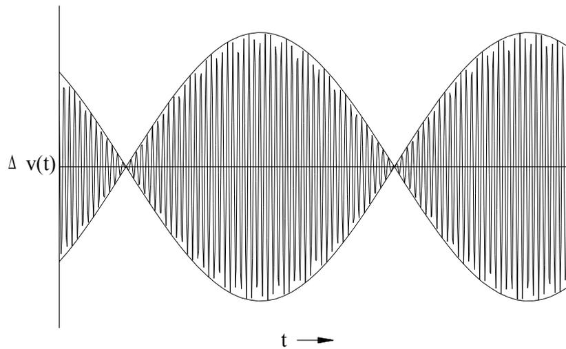
*Spannungsverlauf der Schwebespannung  $\Delta u(t)$ .*
