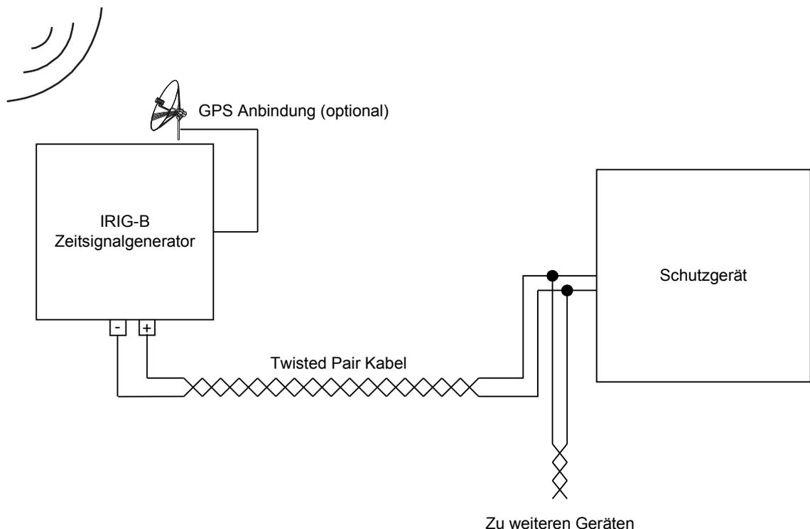
Der Einbauort der IRIG-B Schnittstelle hängt vom bestellten Gerätetyp ab. Nähere Informationen zur Einbaulage sind dem Anschlussbild oben auf dem Schutzgerät zu entnehmen.
