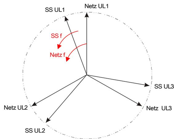
Wenn die Generatorfrequenz  $f_{SS}$  ungleich der Netzfrequenz  $f_{Netz}$  ist, so stellt sich zwischen den beiden Systemen eine Schwebefrequenz ein.
