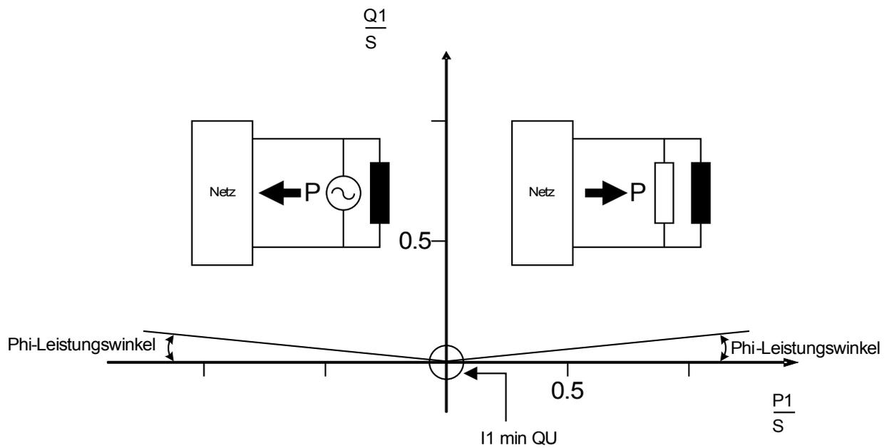
Variante 2: Reine Blindleistungsschwellwertüberwachung
