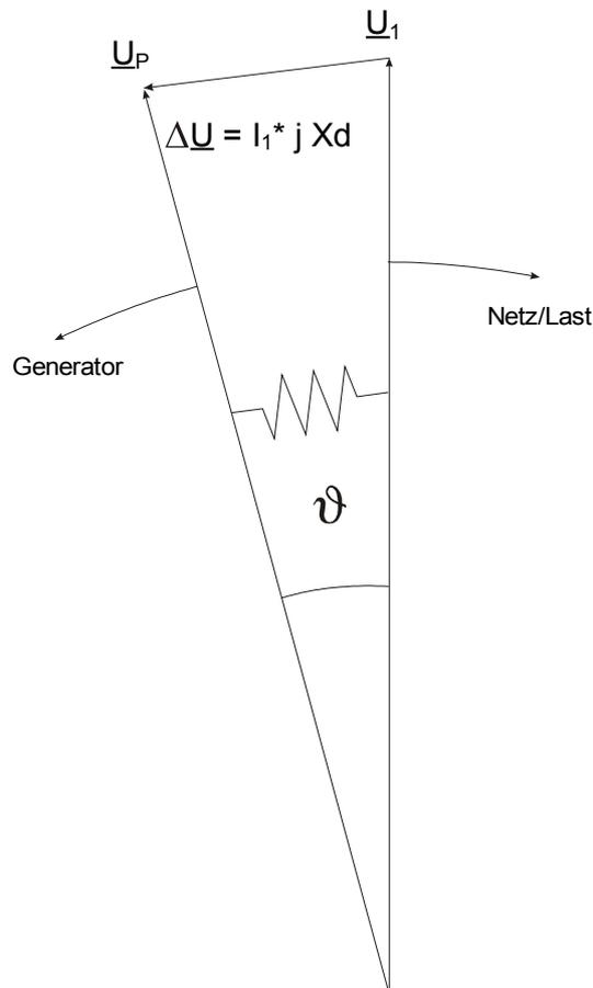
Der Polradwinkel zwischen Ständerdrehfeld und Polrad ist abhängig vom mechanischen Antriebsmoment der Generatorwelle. Es bildet sich ein Gleichgewicht zwischen der zugeführten mechanischen Wellenleistung und der elektrischen abgegebenen Netzleistung, wobei die synchrone Drehzahl erhalten bleibt
