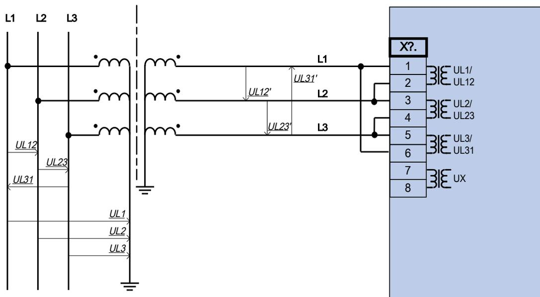
Drei Spannungswandler mit Geräteanschluss in Dreieckschaltung
