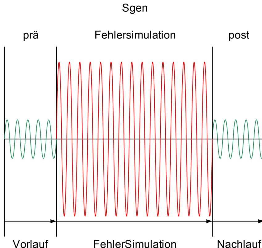
Während einer Fehlersimulation werden alle Energiezähler angehalten.
