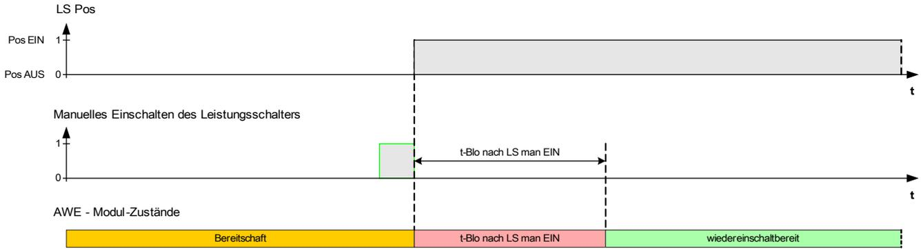
Schutzauslösung nach manuellem Einschalten des Leistungsschalters
