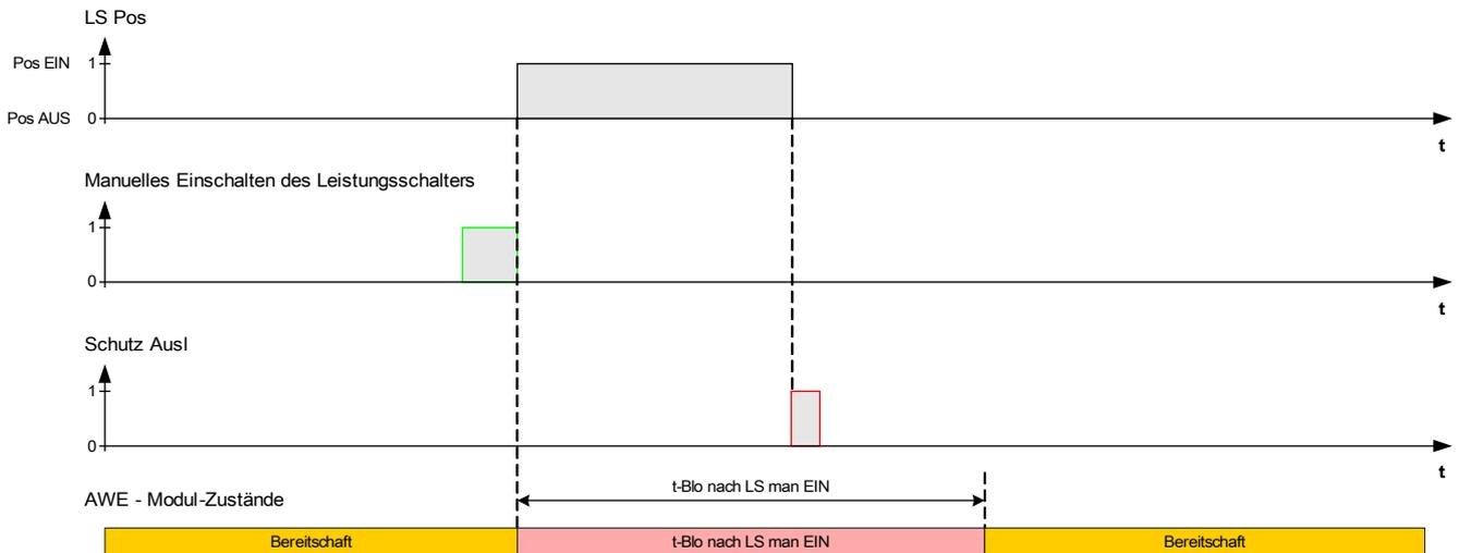
*AWE Verriegelungs-Rücksetzlogik mit Rücksetzkommando vor dem manuellem Einschalten des Leistungsschalters*
