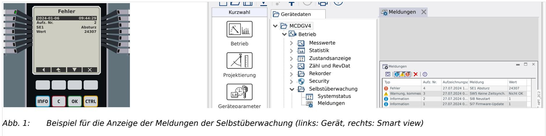
Abb. 1: Beispiel für die Anzeige der Meldungen der Selbstüberwachung (links: Gerät, rechts: Smart view)
