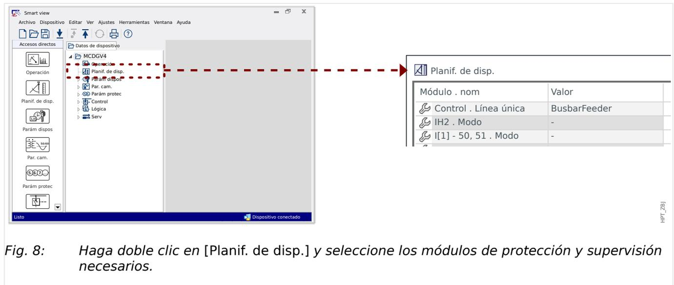
Fig. 8: Haga doble clic en [Planif. de disp.] y seleccione los módulos de protección y supervisión necesarios.
