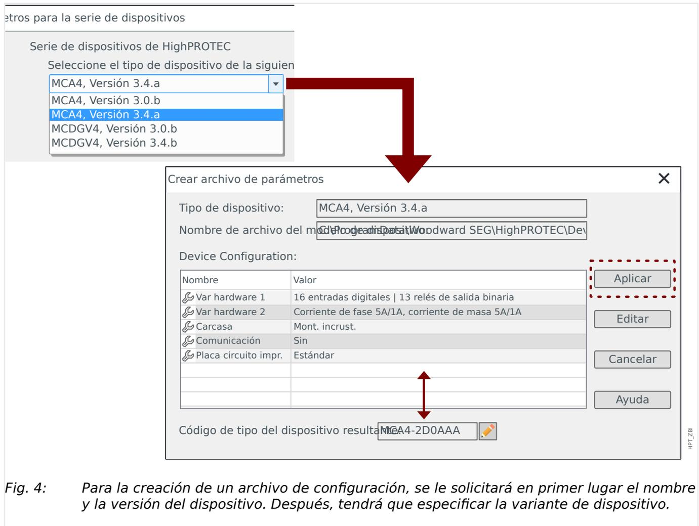
Fig. 4: Para la creación de un archivo de configuración, se le solicitará en primer lugar el nombre y la versión del dispositivo. Después, tendrá que especificar la variante de dispositivo.
