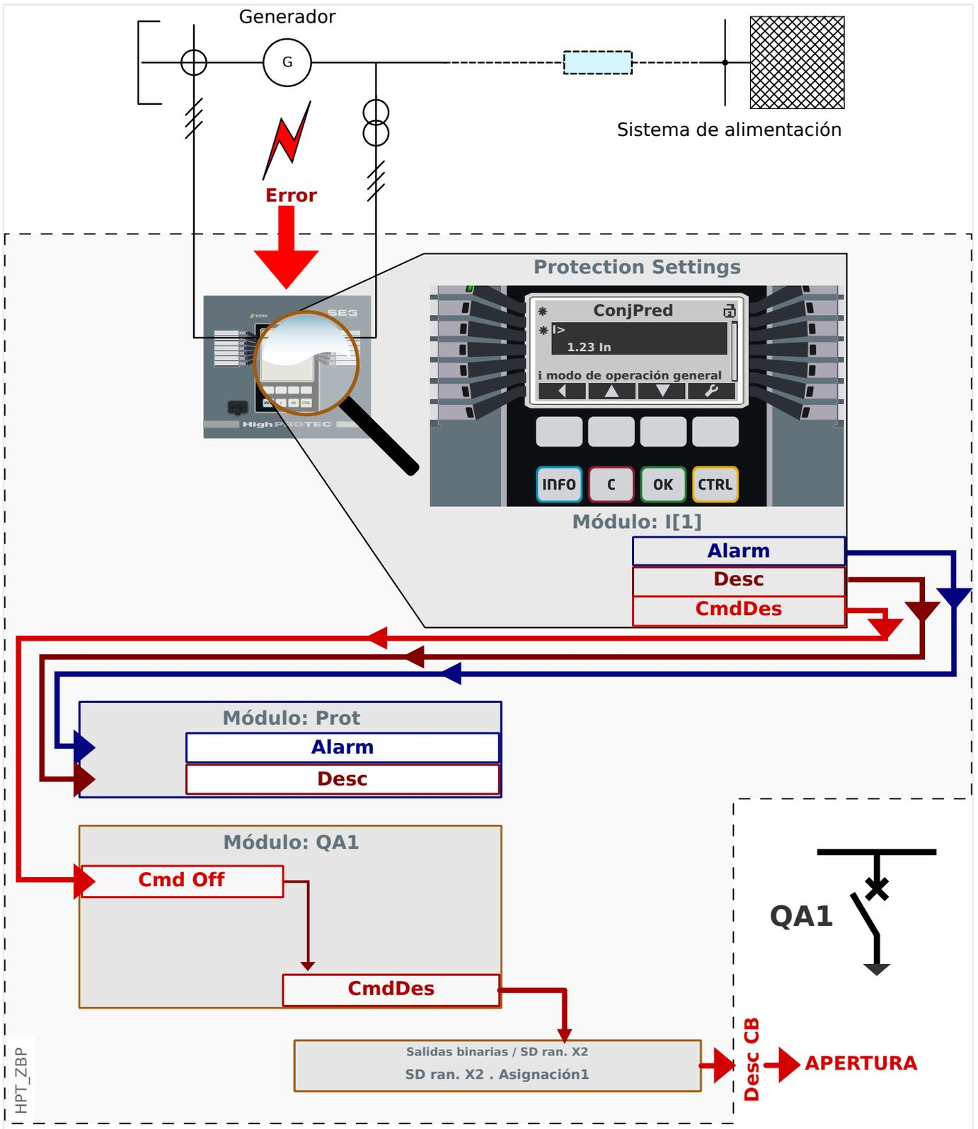
Pongamos como ejemplo una sencilla protección contra sobrecorriente de fase no direccional (véase el diagrama de arriba); p. ej., el módulo I[1].
