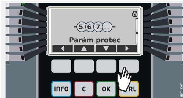
Un segundo ejemplo: Supongamos que hemos activado la función de protección »I[2]«, p. ej., configurando »I[2] . Modo« = "no direccional", tal como se describe en el ejemplo anterior.
