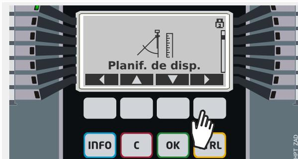
Puede encontrar este ajuste en el menú Planif. de disp. (puede verlo, por ejemplo, en el manual de referencia). El propósito del parámetro es activar (o desactivar) la función de protección »I[2]« (p. ej., la 2ª etapa de la protección contra sobrecarga).
