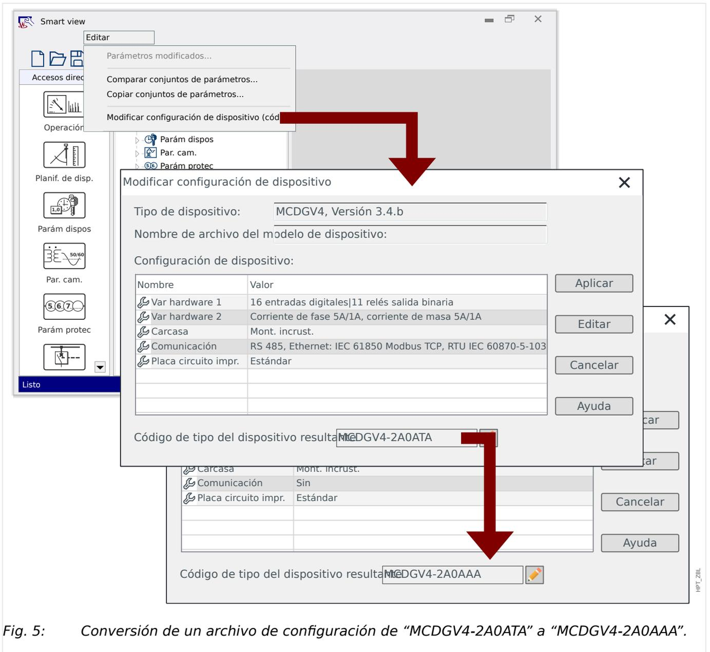
Fig. 5: Conversión de un archivo de configuración de "MCDGV4-2A0ATA" a "MCDGV4-2A0AAA".
