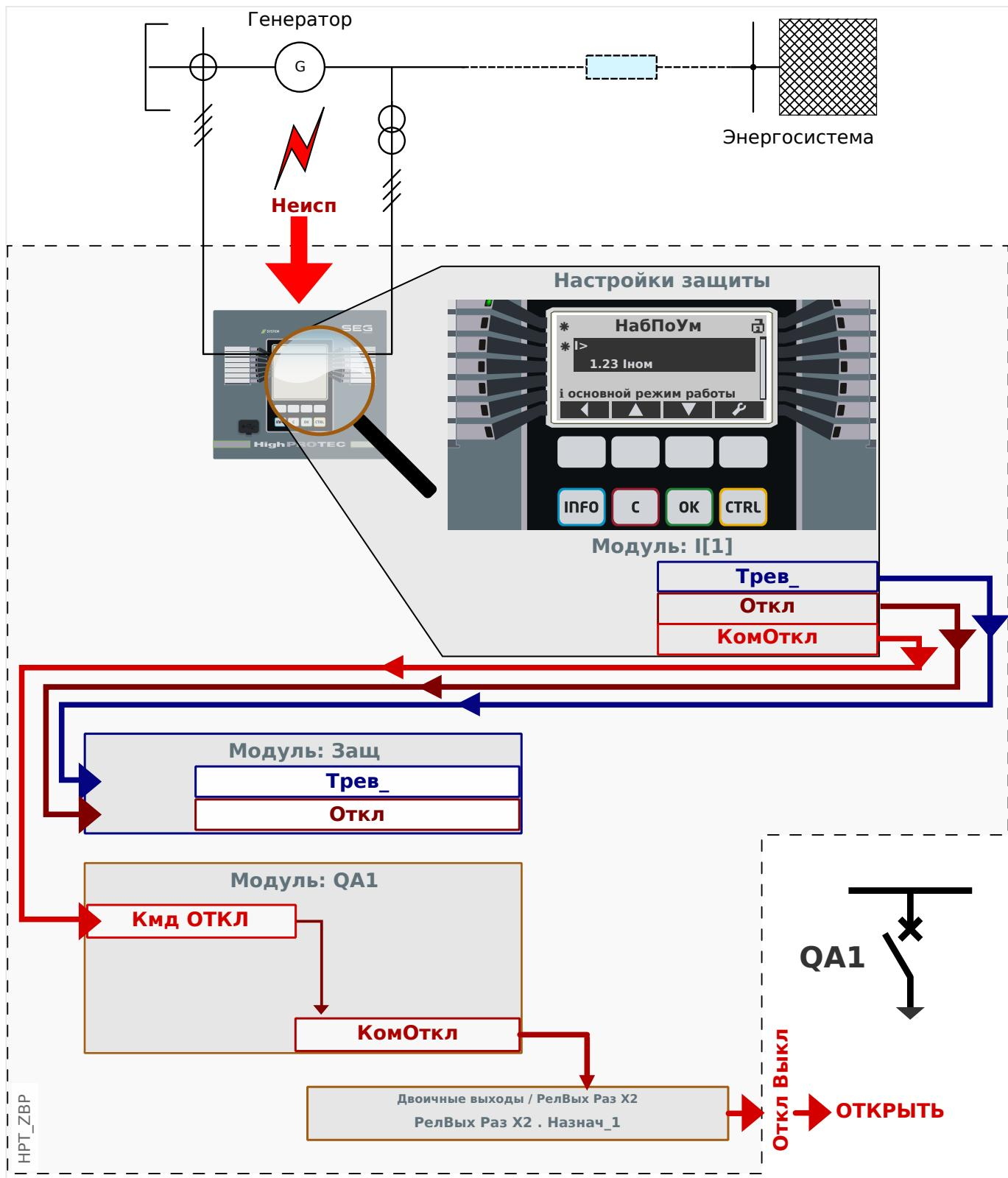
Рассмотрим в качестве примера простой модуль ненаправленной защиты от максимального фазового тока (см. рисунок выше). Например, модуль I[1].
