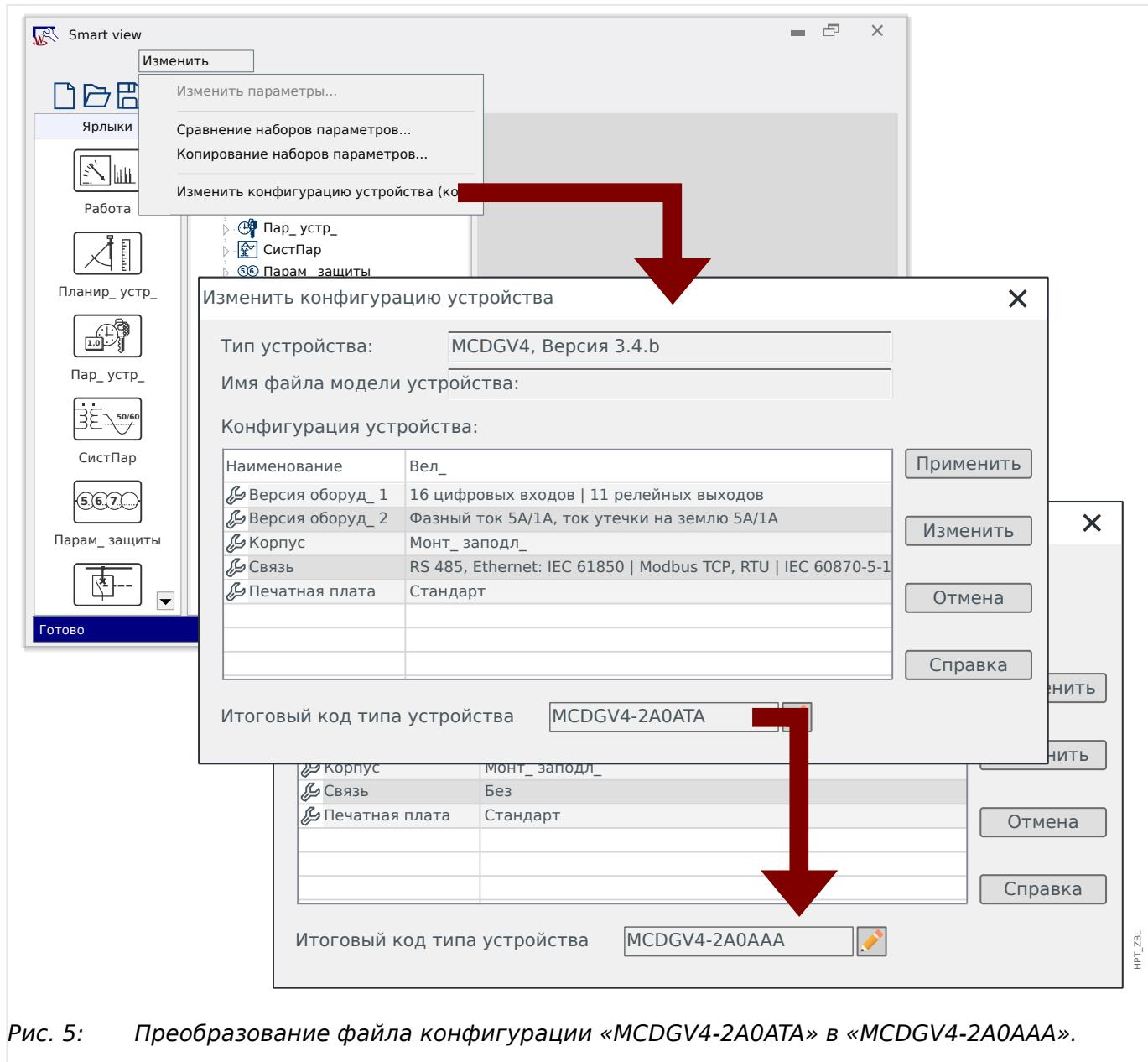
Рис. 5: Преобразование файла конфигурации «MCDGV4-2A0ATA» в «MCDGV4-2A0AAA».
