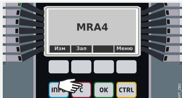
В меню [Подтвердить] можно подтверждать (то есть, сбрасывать) сигналы замкнутого состояния, выходных реле и/или команд отключения. Доступ к этой ветви меню осуществляется обычным образом или с помощью горячей клавиши: при нажатии клавиши «С» сразу откроется это меню.
