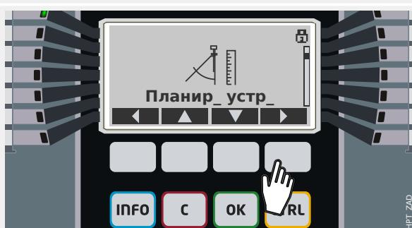
Эта настройка находится в ветви меню Планир\_устр\_ (см., к примеру, справочное руководство). Данный параметр включает (или отключает) защитную функцию «I[2]» (то есть вторую стадию защиты от перегрузки по току).
