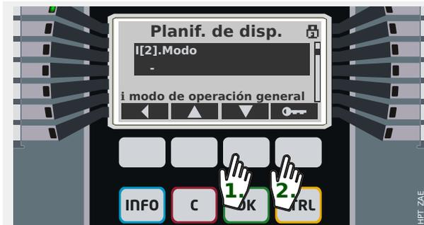
A continuación, presione la tecla "▼" (Abajo) varias veces hasta visualizar el ajuste deseado en la pantalla.
