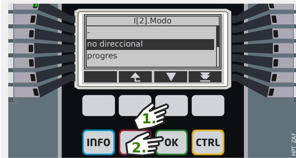
De nuevo, presione "▼" (Abajo) varias veces hasta visualizar el valor deseado, por ejemplo: "no direccional" está resaltado.
