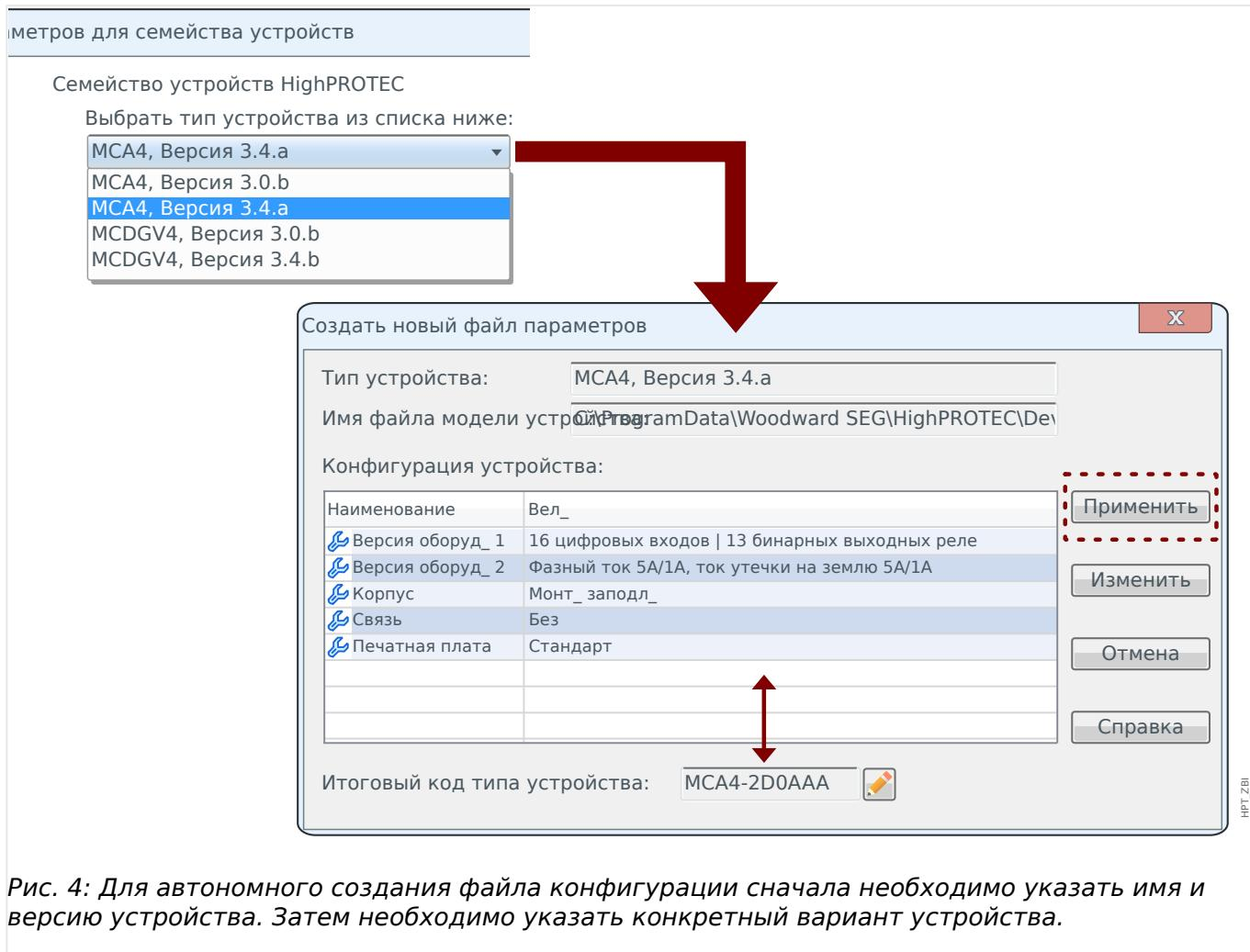
Рис. 4: Для автономного создания файла конфигурации сначала необходимо указать имя и версию устройства. Затем необходимо указать конкретный вариант устройства.
