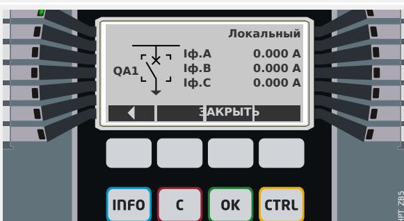
Когда отображается одна строка, при нажатии программной кнопки «▶» (Ввод) отображается расширенная одна строка (после ввода пароля для уровня доступа «Control-Lv1»). Коммутационное устройство выделяется с помощью небольших маркеров (а при наличии нескольких коммутационных устройств отображается программа «Выбрать», которая позволяет выбрать другое устройство).
