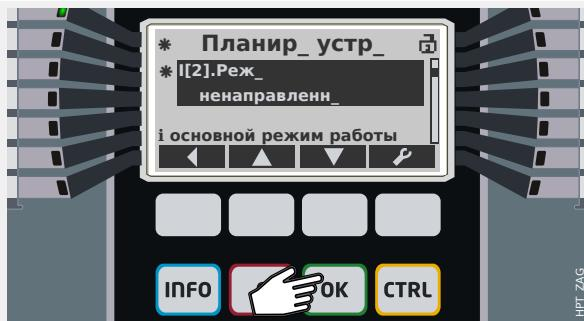
После первого нажатия кнопки «OK» пользователь перейдет обратно к экрану с выбранным параметром «I[2] . Реж\_».
