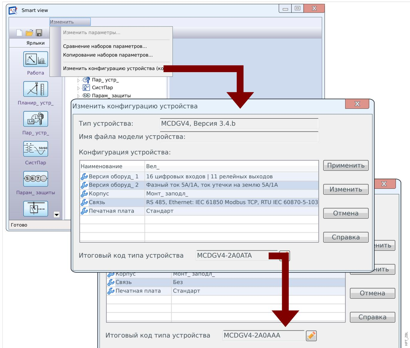
Рис. 5: Преобразование файла конфигурации «MCDGV4-2A0ATA» в «MCDGV4-2A0AAA».
