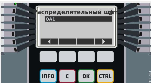
Когда отображается одна строка, при нажатии программной кнопки «Распределительный щит» отображается экран со списком всех подключенных коммутационных устройств.
