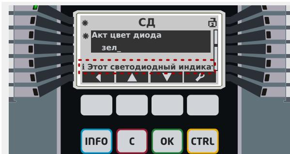
**Информационный токен «i»** уже упоминался в разделе [«Изменение параметров — кнопка «OK»](#). Он отображается в диалоговом окне настройки (на дисплее устройства в выделенной текстовой строке, непосредственно над назначениями программных кнопок, или в текстовой рамке в диалоговом окне настройки *Smart view*). Он указывает на подробное описание соответствующего параметра.
