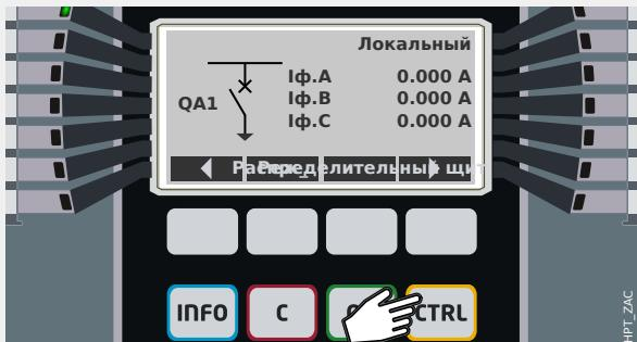
При нажатии клавиши «CTRL» отображается на экран с одной строкой, кроме того, вы получаете прямой доступ к связанным функциям управления.
