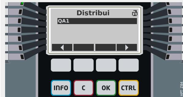
Quando a linha única está sendo exibida, a tecla de função "Distribui" leva você a uma tela que lista todos os dispositivos de comutação conectados.
