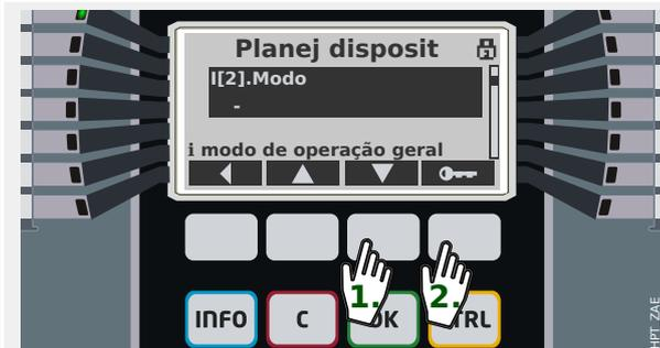
Em seguida, pressione a tecla de função "▼" (para baixo) repetidamente até que a configuração desejada possa ser vista na tela.
