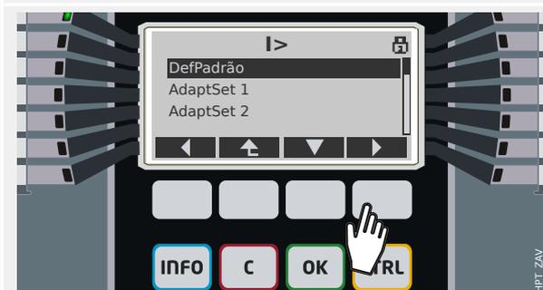
Esse parâmetro específico suporta conjuntos adaptáveis. (Consulte [4 Conjunto de Parâmetros de Adaptação](#) para obter informações e o Manual Técnico para ver uma descrição detalhada.)
