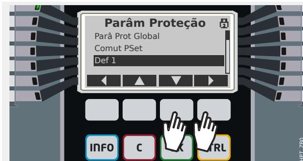
Entre no submenu [Def 1] da mesma maneira: Pressione "▲" (para cima) ou "▼" (para baixo) repetidamente, até que "Def 1" apareça na tela e, em seguida, pressione "►" (Enter).
