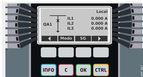
La nueva posición del conmutador se muestra en la pantalla (en cuanto se haya alcanzado, según la indicación de posición, o una vez transcurrido el tiempo que se haya configurado para la conmutación).
