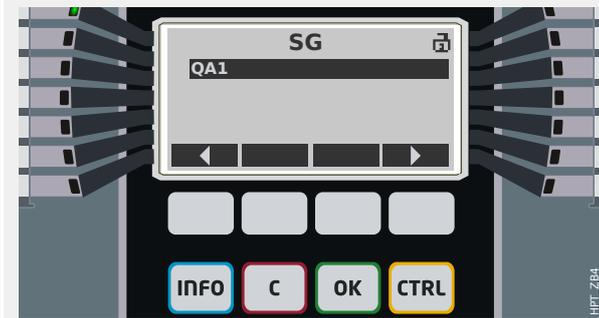
Cuando se muestra la línea única, la tecla "SG" le lleva a una pantalla en la que se indican todos los conmutadores conectados.
