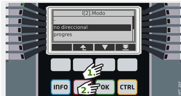
De nuevo, presione "▼" (Abajo) varias veces hasta visualizar el valor deseado, por ejemplo: "no direccional" está resaltado.
