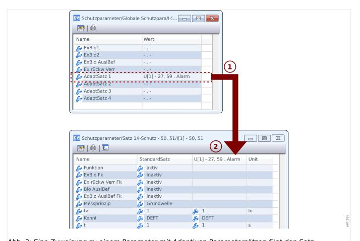
Abb. 3: Eine Zuweisung zu einem Parameter mit Adaptiven Parametersätzen fügt den Satz-Parametern alternative Werte hinzu.
