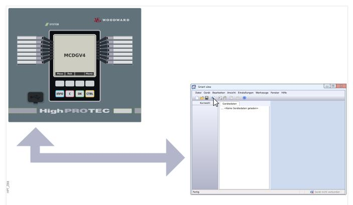
Abb. 1: Man verbindet PC und Schutzgerät und stellt in Smart view, die Verbindungseigenschaften ein.
