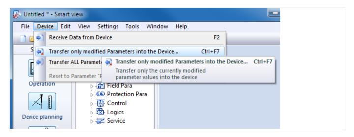
• Es erfolgt nun eine Abfrage des Geräte-Passwortes. Nachdem dieses korrekt eingegeben wurde, werden die Änderungen an das Schutzgerät übertragen (und von diesem aktiviert).
