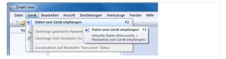
• Smart view baut eine Verbindung zum Schutzgerät auf, liest die Daten vom Schutzgerät und zeigt diese Daten als Menü-Baum an.
