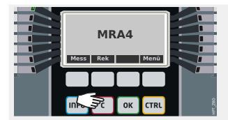
Über den Menüzweig [Quittierung] lassen sich Signale in Selbsthaltung, Ausgangsrelais und/ oder Aus-Befehle "quittieren" (d. h. rücksetzen). Man erreicht diesen Menüzweig auf die übliche Weise, aber es ist alternativ auch möglich, einfach nur die "C"-Taste zu betätigen, d.h. die Taste bewirkt einen Direktsprung in diesen Menüzweig.
