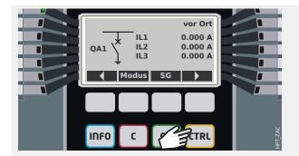
Durch Betätigen der »CTRL«-Taste gelangt man zu einer Anzeige des sogenannten Abzweigsteuerbildes (englisch: *single-line*). In dieser Darstellung hat man einen Überblick über die angeschlossenen Schaltgeräte, und man hat (über die Softkeys) Zugriff auf Schaltkommandos.
