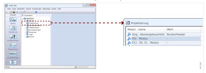
Abb. 8: Nach einem Doppelklick auf [Projektierung] können die benötigten (z.B. Schutz- und Überwachungs-)Module definiert werden.
