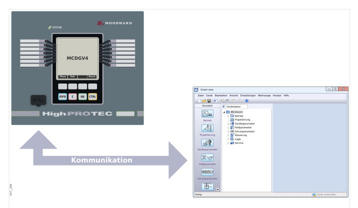
Abb. 2: Nachdem "Daten vom Gerät empfangen" aktiviert wurde, zeigt Smart view den Menübaum an.
