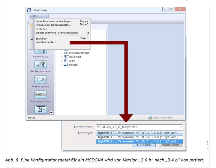
Es öffnet sich zunächst ein Bestätigungsdialog, der auf die Konvertierung zwischen unterschiedlichen Versionen hinweist, und abschließend erhält man ein Fenster mit einer Zusammenfassung über die erfolgreich konvertierten, hinzugefügten und entfernten Einstellungen.
