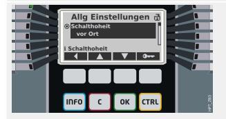
Wir wollen nun zum Beispiel einen Schaltbefehl über die Bedieneinheit absetzen. Wir kümmern uns zunächst um die Schalthoheit und gehen also (z. B. über den Softkey "Modus") zum Menüzweig [Steuerung / Allg Einstellungen].
