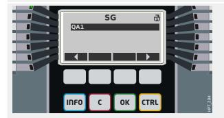
Betätigt man, wenn das Abzweigsteuerbild angezeigt wird, den Softkey "SG", erreicht man dann eine Liste aller angeschlossenen Schaltgeräte.
