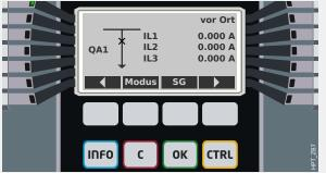
Die neue Stellung des Schaltgerätes wird (nach Ablauf der jeweiligen Schaltzeit bzw. nach entsprechender Rückmeldung durch die Stellungsmeldekontakte) auf dem Display angezeigt.
