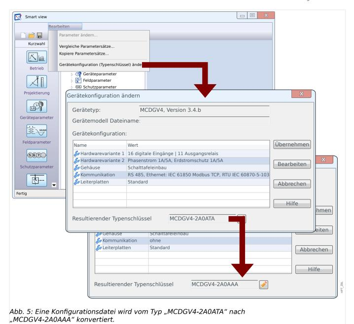
Nach dem Betätigen der Schaltfläche »Anwenden« benötigt Smart view eine gewisse Zeit, um die Daten mehreren Plausibilitätsprüfungen zu unterziehen. Bei einer relativ einfachen Konvertierung, wie im Beispiel oben gezeigt, dürften diese Prüfungen keinerlei Beanstandungen ergeben, sodass anschließend die Daten an das verbundene Schutzgerät übertragen werden können, so wie in  $\Longrightarrow$  "Bedienung über Smart view" beschrieben.
