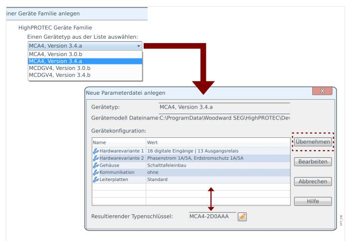
Abb. 4: Beim "Offline"-Anlegen einer Konfigurationsdatei wird man zunächst nach dem Gerätenamen und der Version gefragt, danach muss der genaue Gerätetyp spezifiziert werden.
