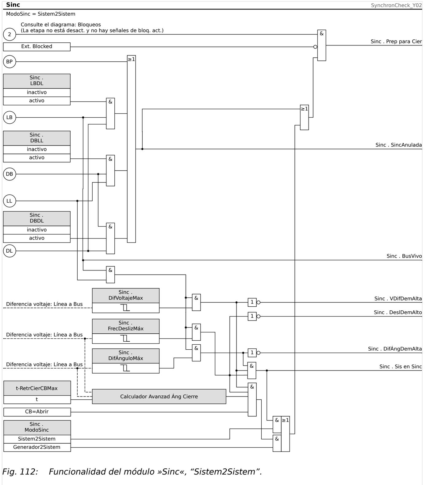
Fig. 112: Funcionalidad del módulo »Sinc«, "Sistem2Sistem".
