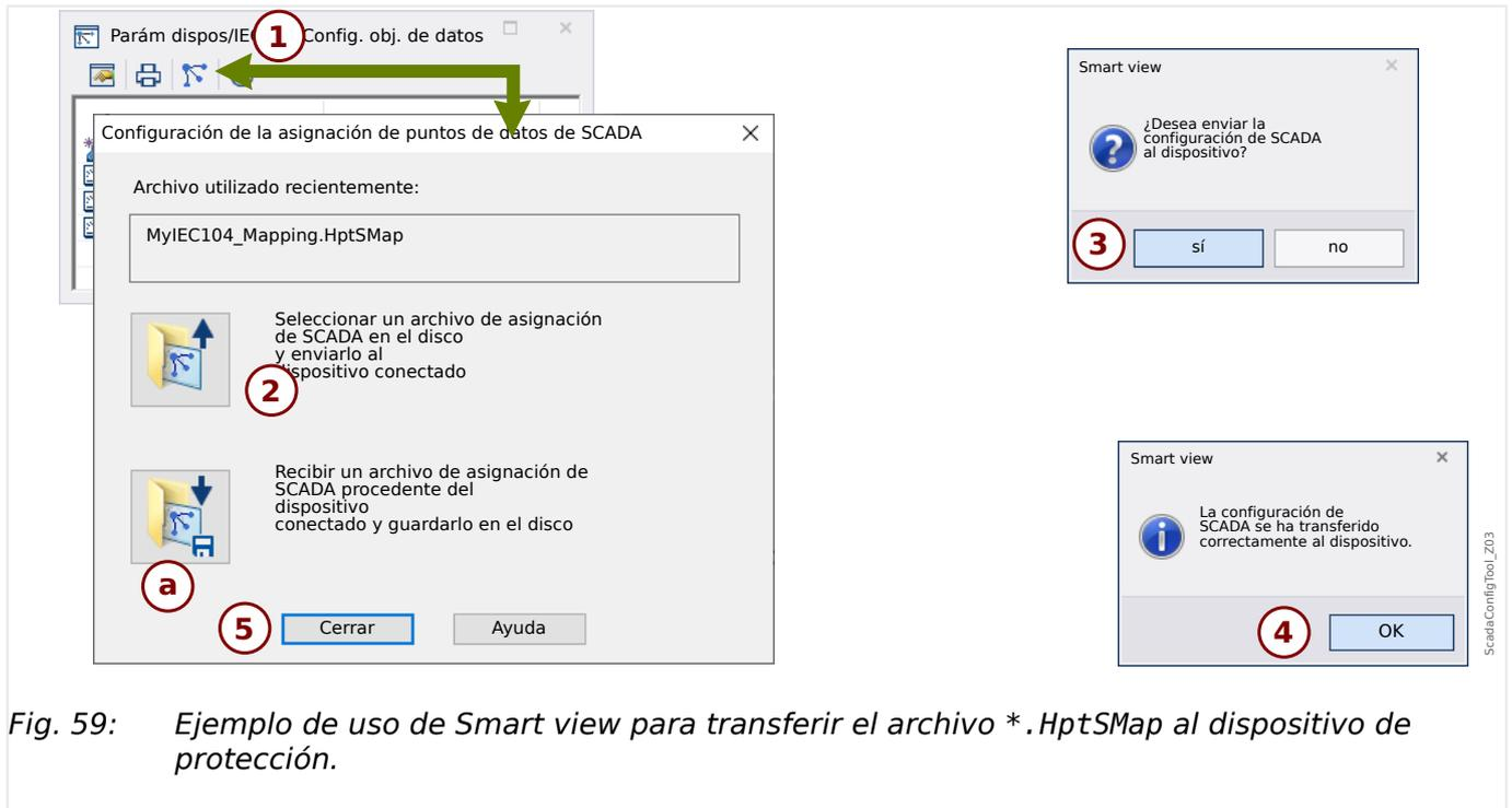
Fig. 59: Ejemplo de uso de Smart view para transferir el archivo \*.HptSMap al dispositivo de protección.
