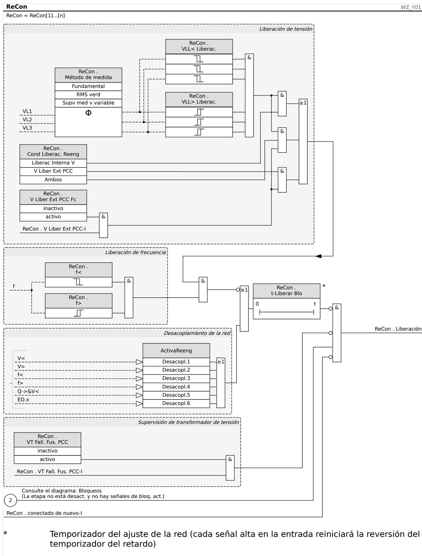
Si el interruptor del PCC se ha desconectado, la reconexión tiene que hacerse manualmente. No se necesita una lógica de bloqueo especial.
