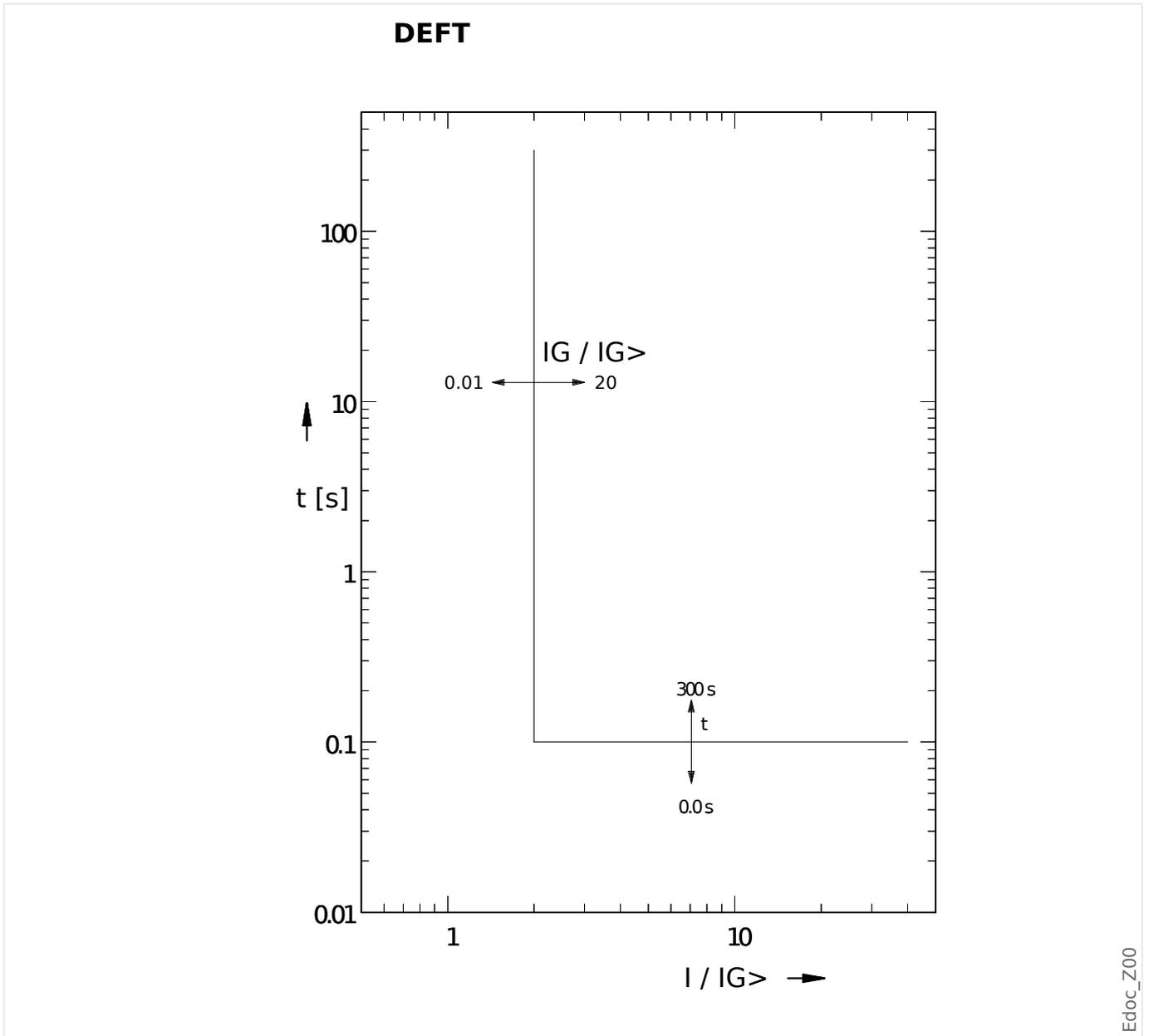
Retraso de desconexión de  $I > I_{G>}$ , configurable mediante [Parám protec / Def 1...4 / I-Prot / IG[x]] »t«.
