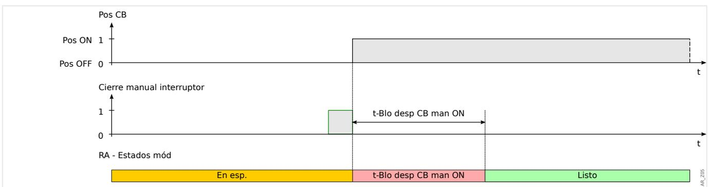
Fig. 105: Estados de reconexión automática durante el cierre manual del interruptor.
