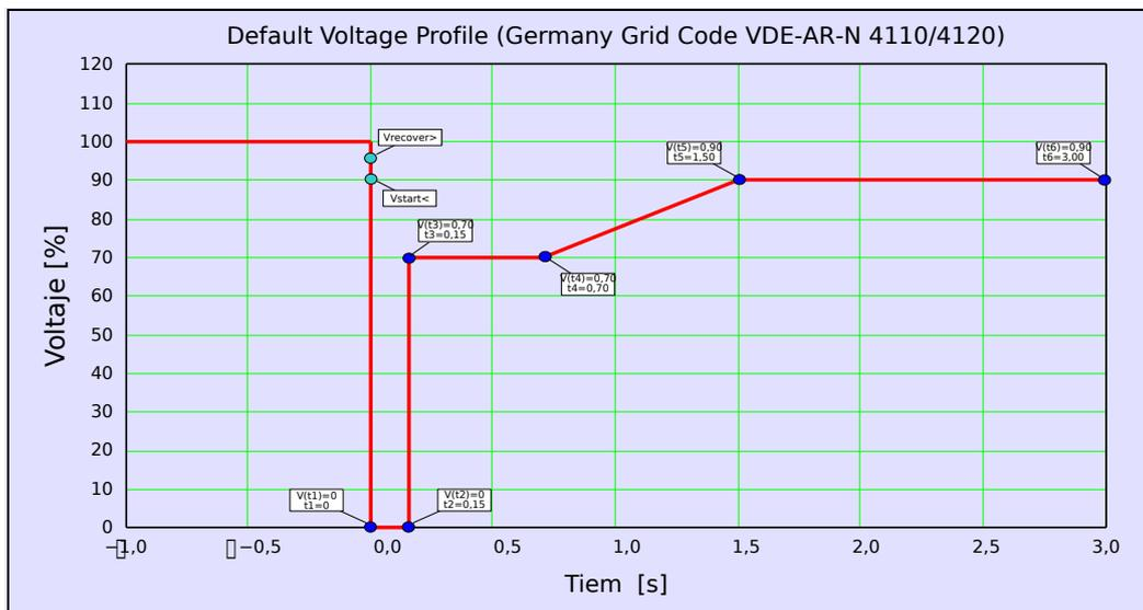
Fig. 80: Perfil de LVRT predeterminado (Tipo I).
