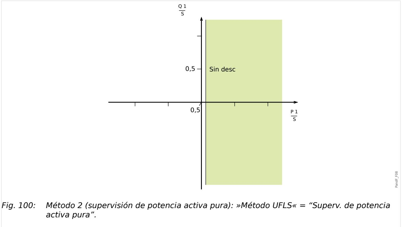
Fig. 100: Método 2 (supervisión de potencia activa pura): *»Método UFLS«* = “Superv. de potencia activa pura”.
