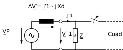
Fig. 86: Circuito equivalente en fallo de red eléctrica.
