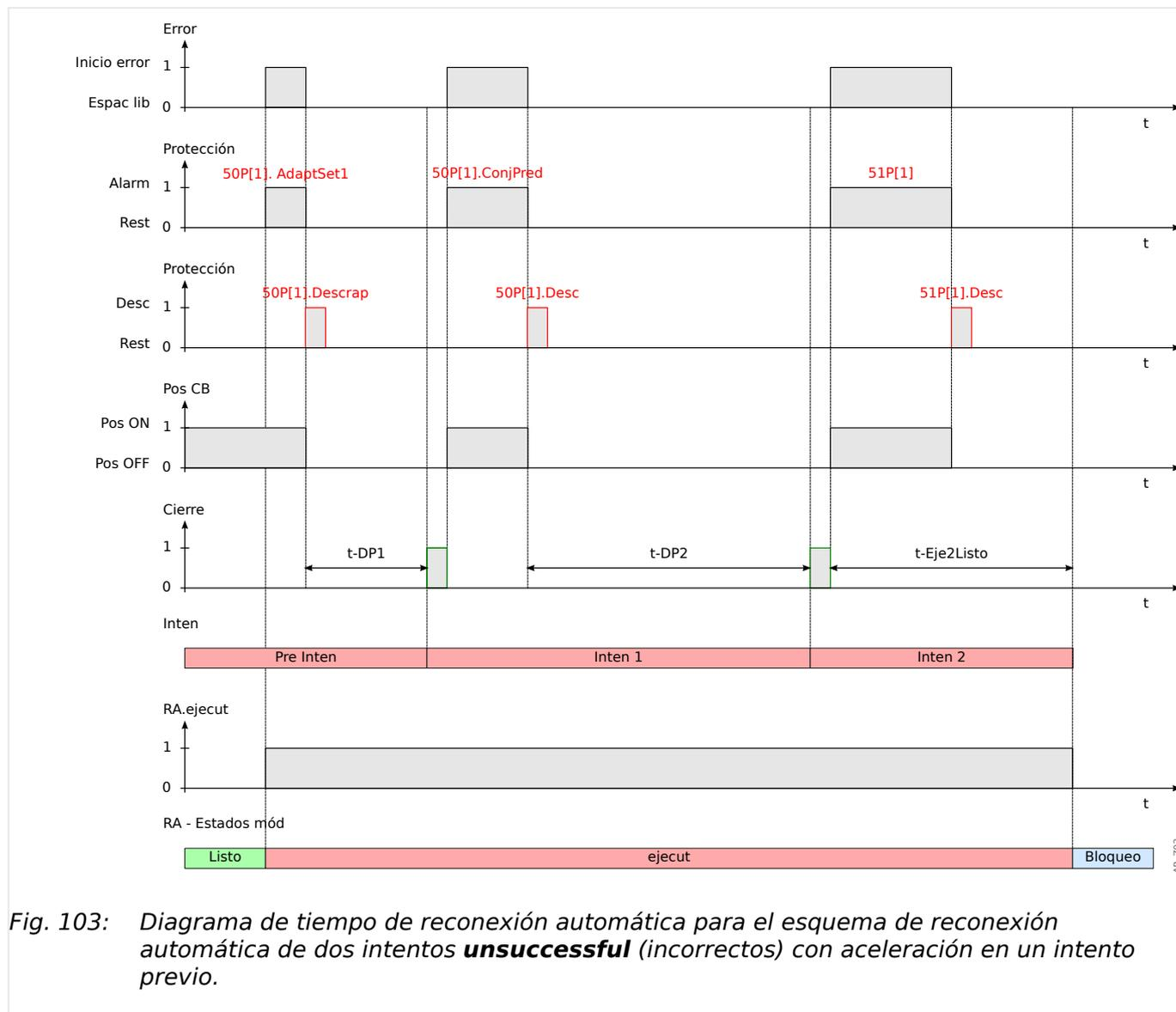
Fig. 103: Diagrama de tiempo de reconexión automática para el esquema de reconexión automática de dos intentos **unsuccessful** (incorrectos) con aceleración en un intento previo.
