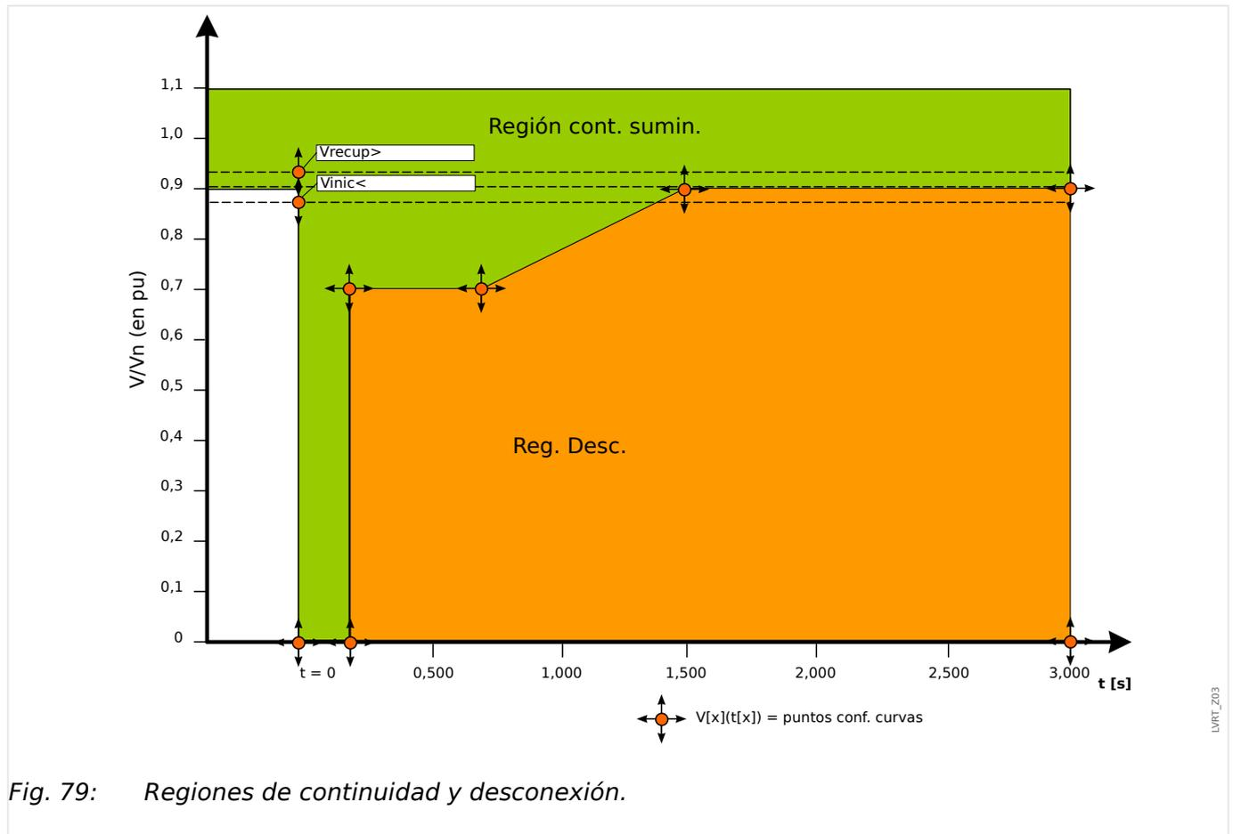
El módulo de «LVRT» pasará a modo de reposo de nuevo tan pronto como se recupere la tensión de sistema: Esto significa que la tensión ha superado la tensión de recuperación predefinida « $V_{recup}$ ».
