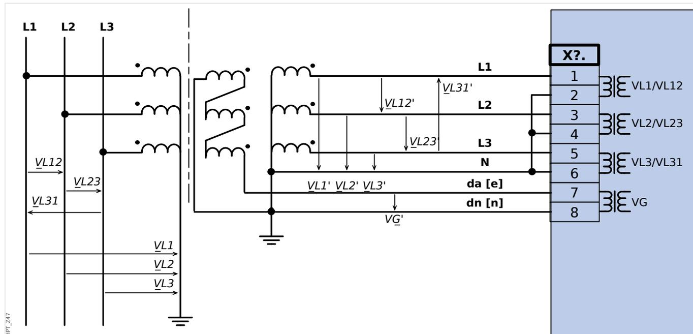
Fig. 31: VT Wye con conexión delta interrumpida.
