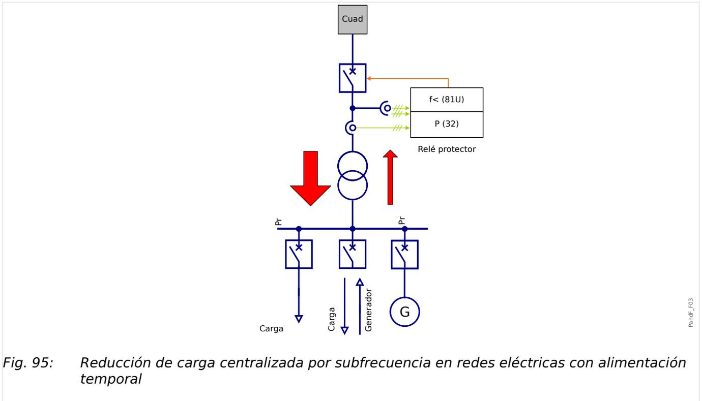
Fig. 95: Reducción de carga centralizada por subfrecuencia en redes eléctricas con alimentación temporal
