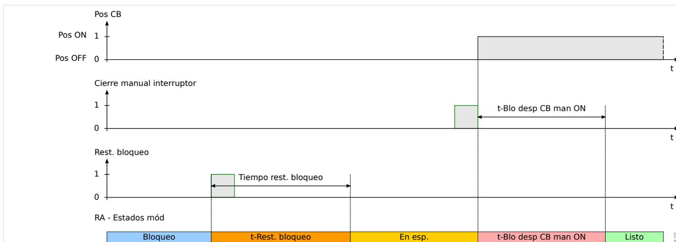
Fig. 107: Lógica de reinicio de bloqueo de AR en caso de que el reinicio de bloqueo llegue antes de que se cierre el interruptor manualmente.
