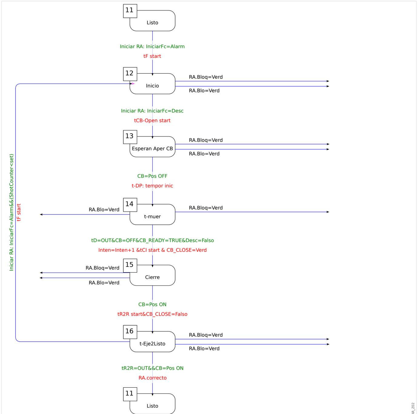
Fig. 102: Ciclo de ejecución de RA (estado 4).
