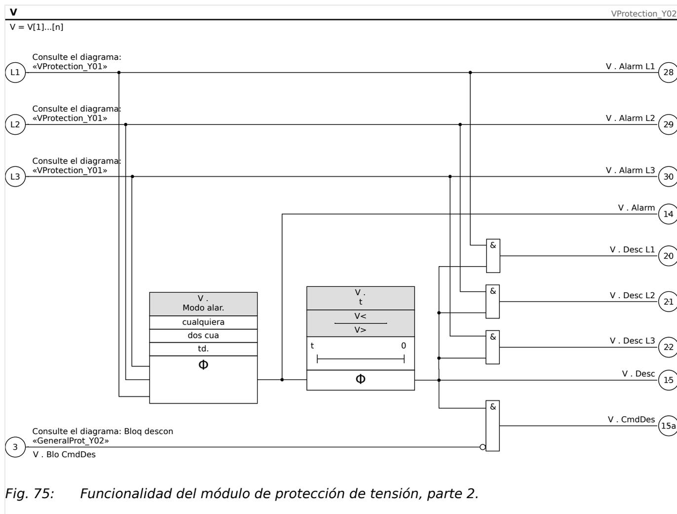
Fig. 75: Funcionalidad del módulo de protección de tensión, parte 2.
