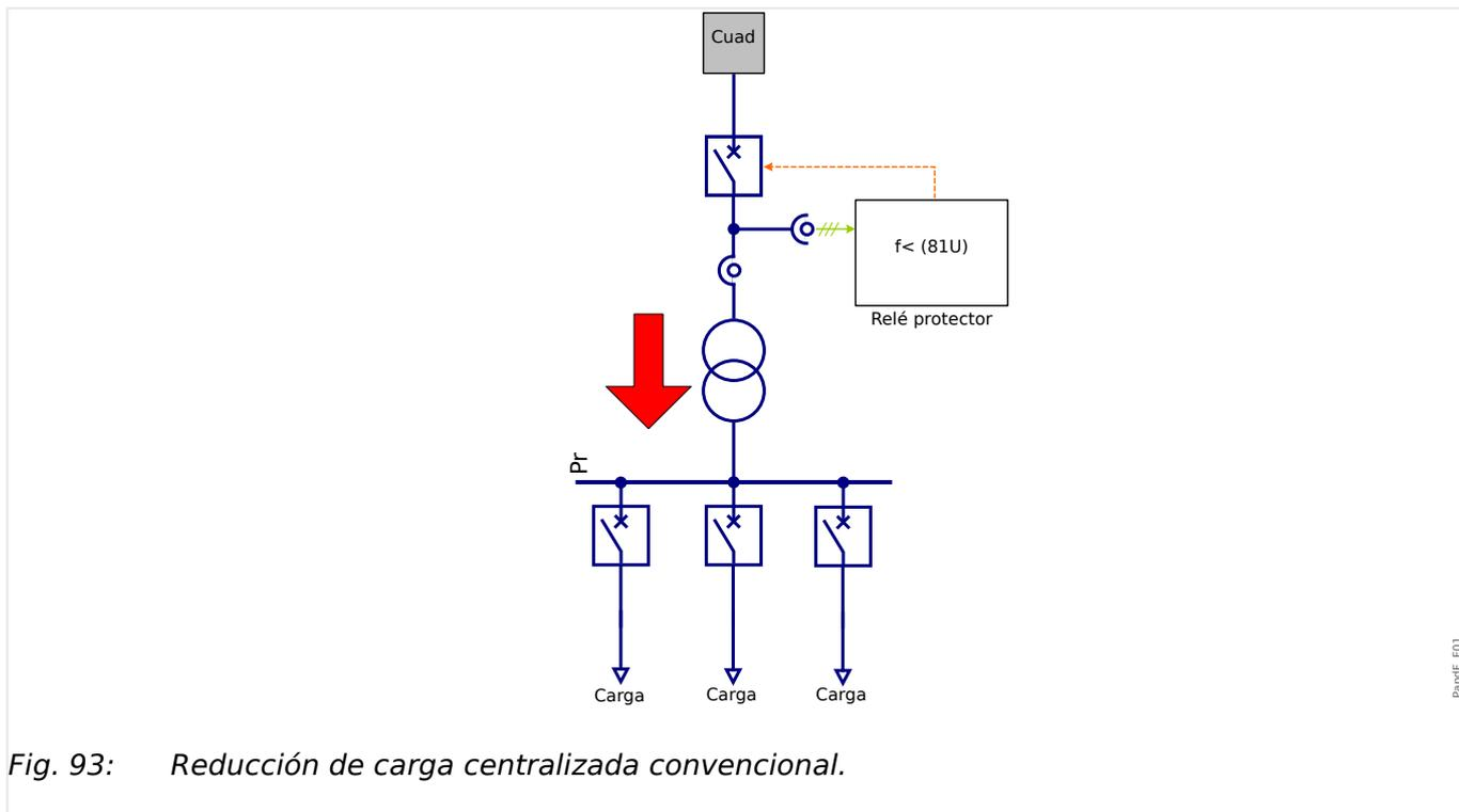
Reducción de carga convencional de una subred desde un punto de conexión central. La reducción de carga se iniciará mediante subfrecuencia.
