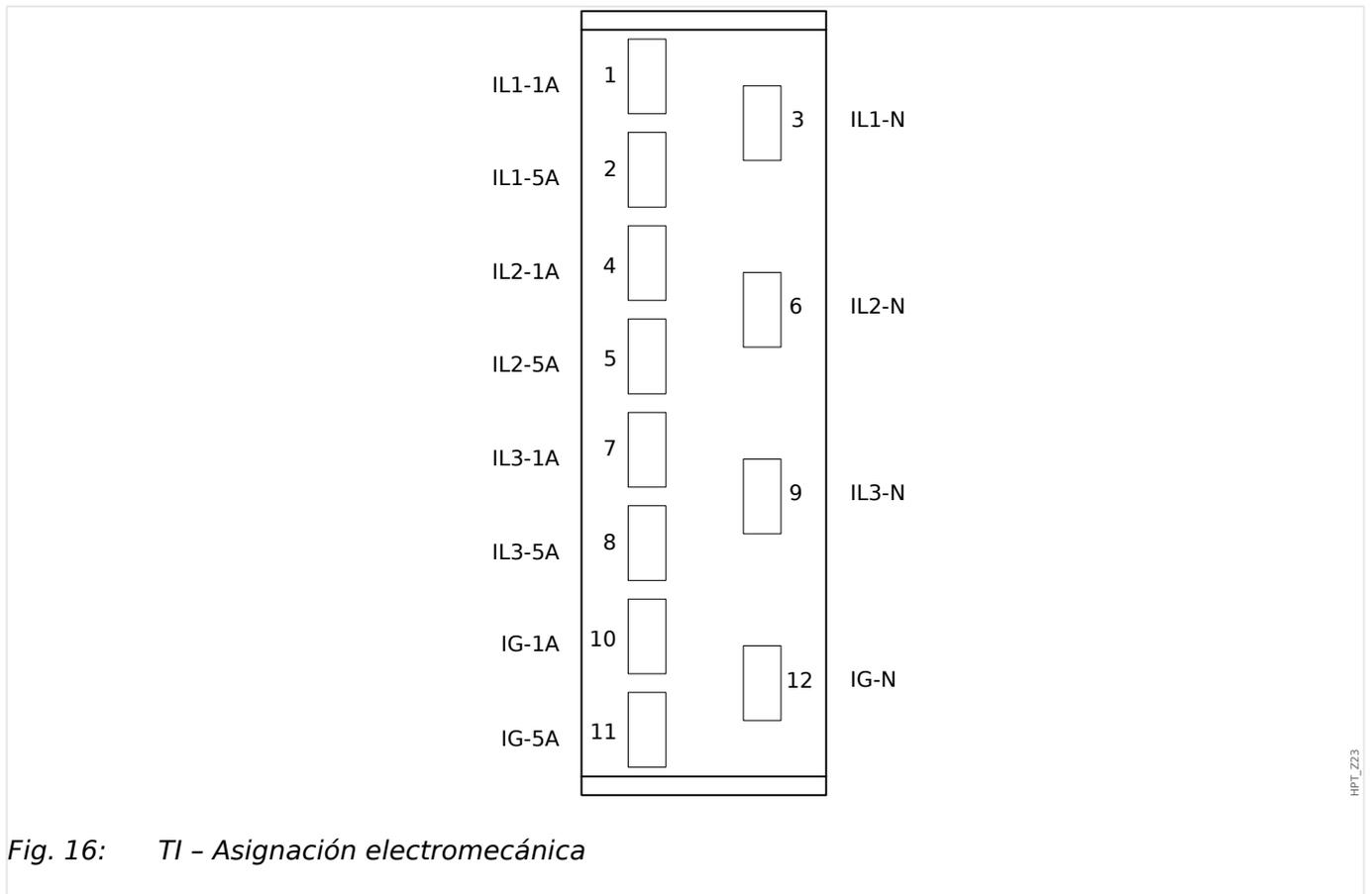
Fig. 16: TI - Asignación electromecánica
