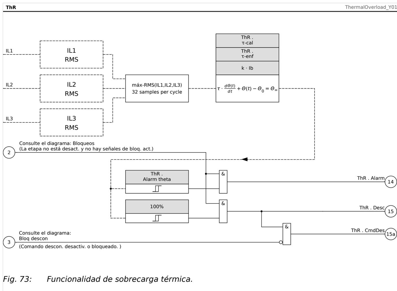
Fig. 73: Funcionalidad de sobrecarga térmica.
