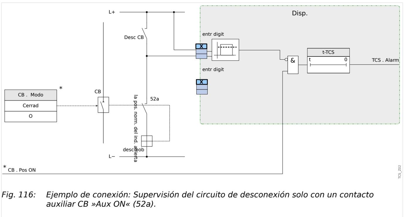
Fig. 116: Ejemplo de conexión: Supervisión del circuito de desconexión solo con un contacto auxiliar CB »Aux ON« (52a).
