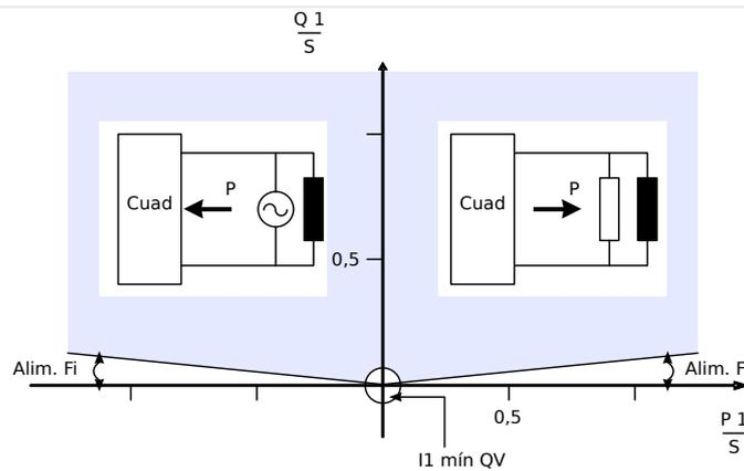
Fig. 91: Método 1: Supervisión de ángulo de potencia
