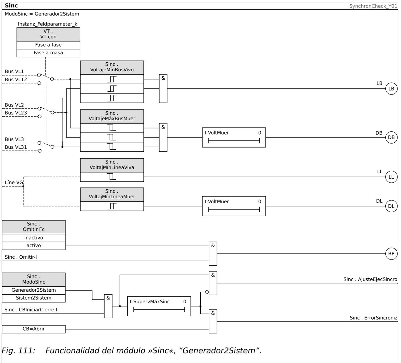
Fig. 111: Funcionalidad del módulo »Sinc«, «Generador2Sistem».
