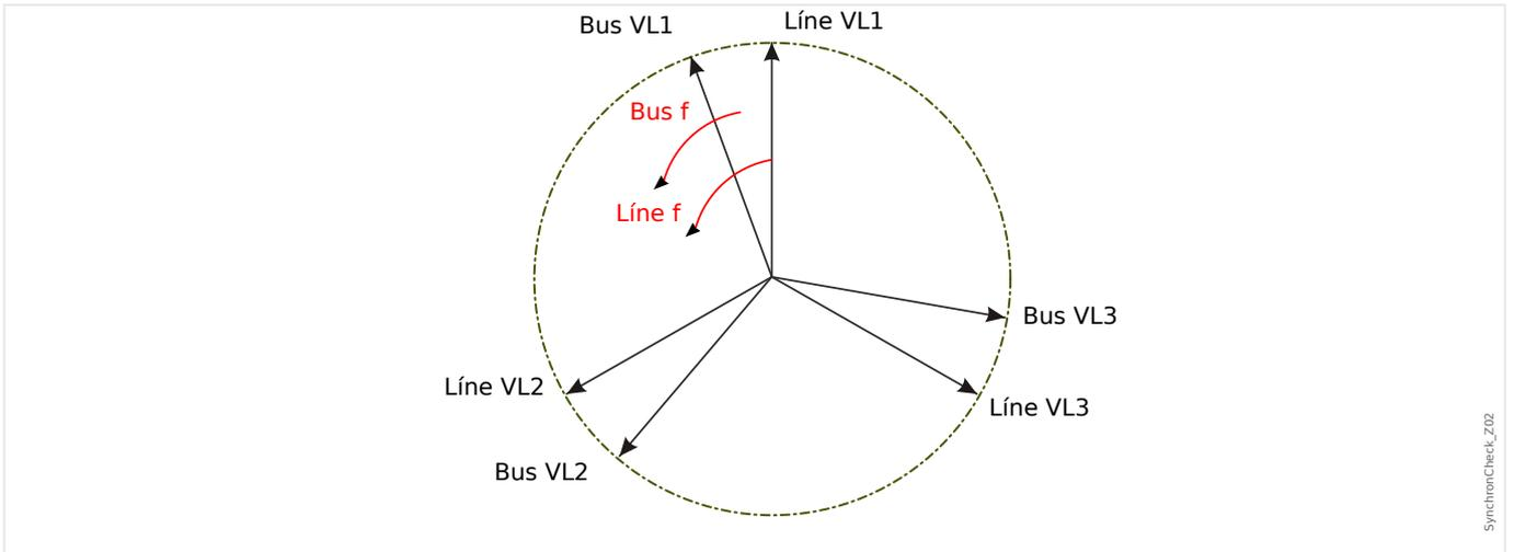
Si la frecuencia del generador  $f_{Bus}$  no es igual a la frecuencia de la red  $f_{Line}$ , provoca una frecuencia de deslizamiento  $\Delta f = |f_{Bus} - f_{Line}|$  entre las dos frecuencias del sistema.
