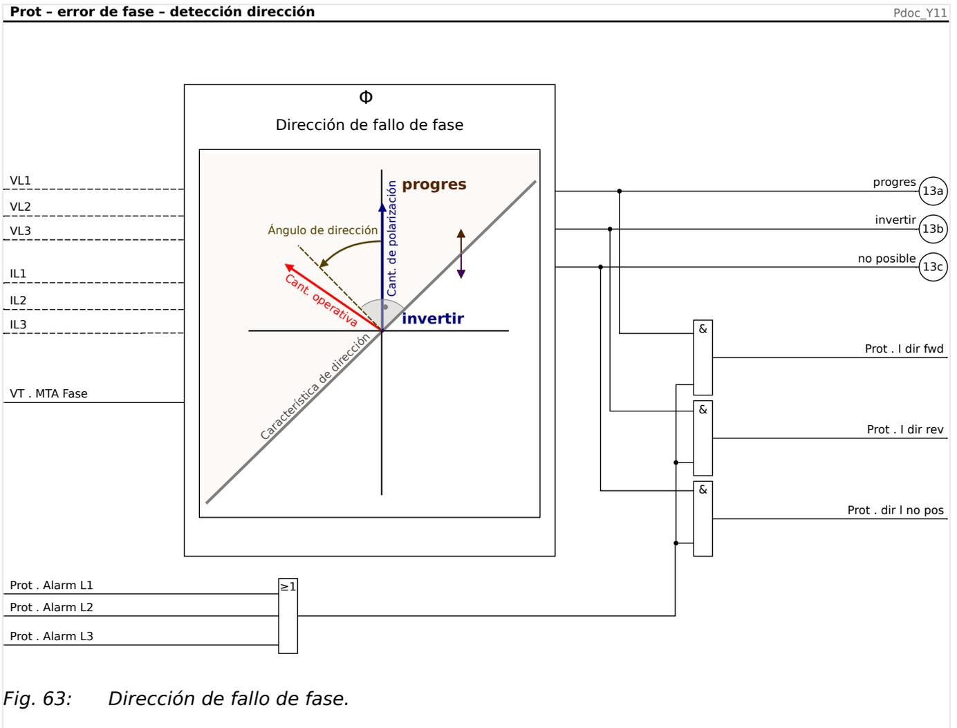
MCA4 evalúa el ángulo entre la corriente de la fase con la corriente más alta (*Cantidad operativa*) y la tensión de fase a fase de las otras fases (*Cantidad de polarización*). En fallos de tres fases en los que la tensión de fase a fase es demasiado baja se utiliza una memoria de tensión.
