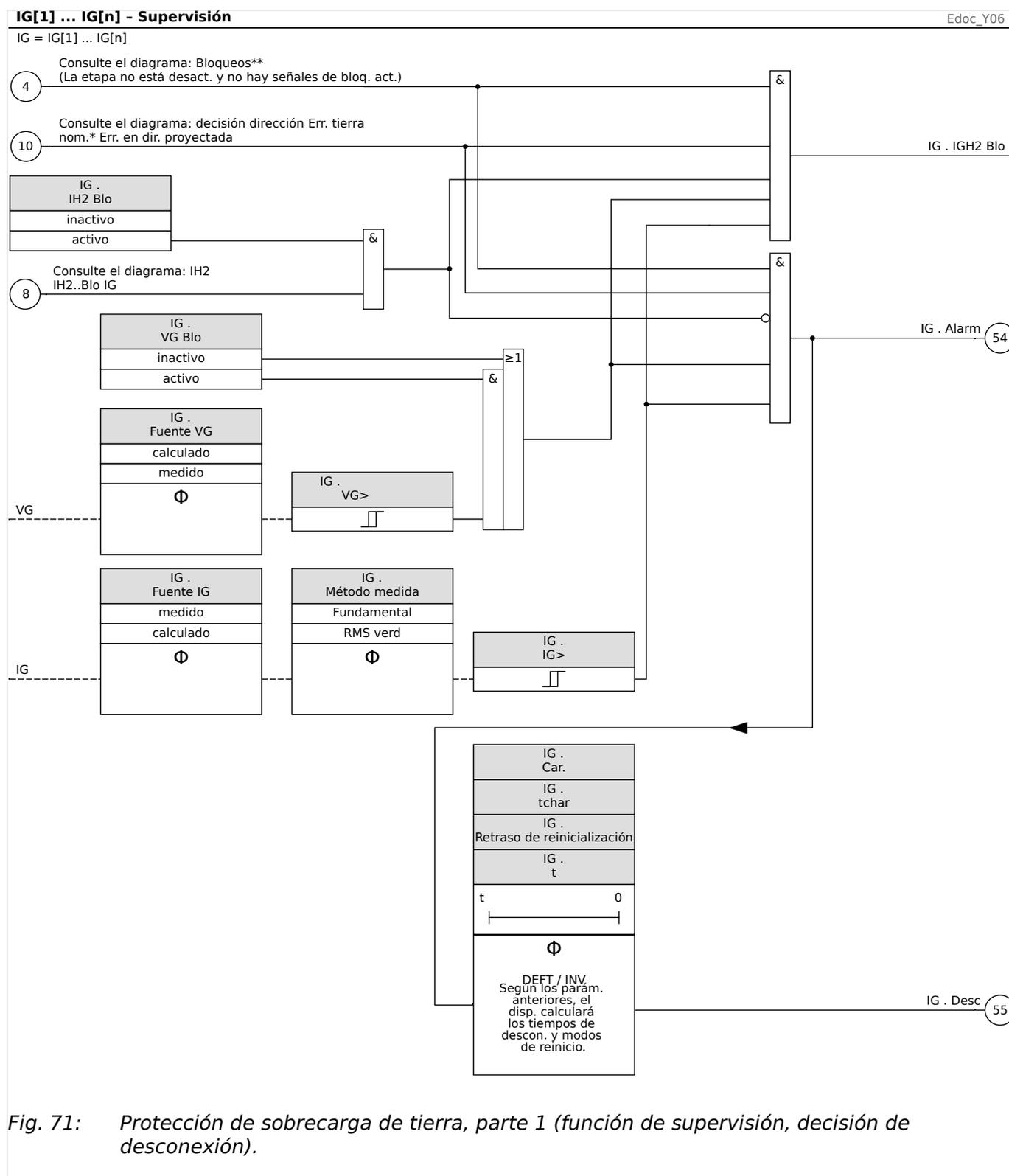
Fig. 71: Protección de sobrecarga de tierra, parte 1 (función de supervisión, decisión de desconexión).
