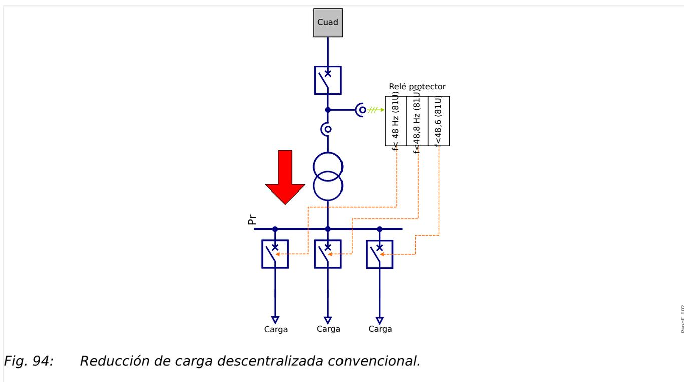
Se puede realizar la reducción de carga descentralizada convencional desactivando la detección de dirección del flujo de energía.
