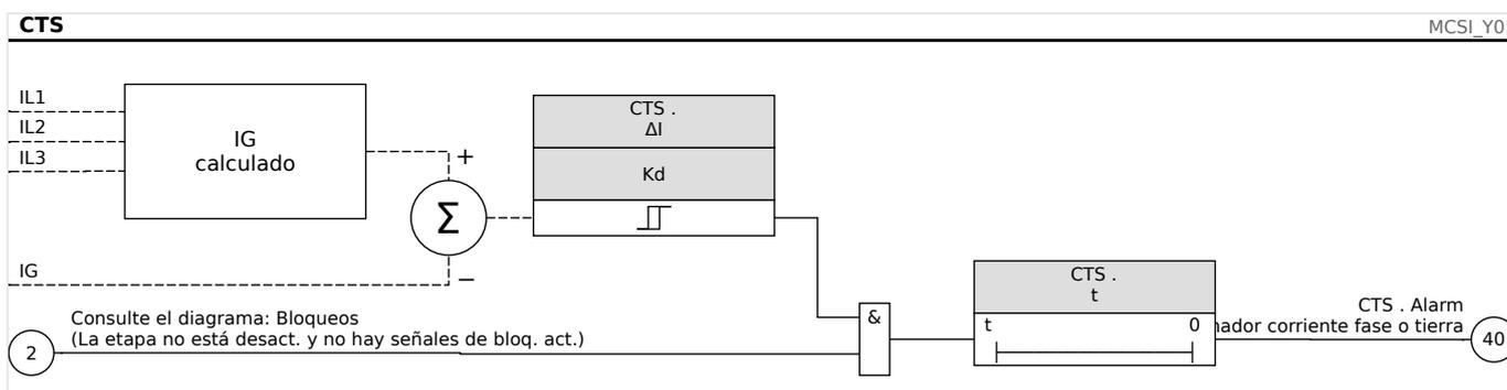
**4.25.3.1 Puesta en servicio: Supervisión de fallos de transformador de corriente**
