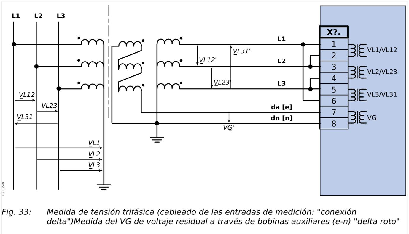
Fig. 33: Medida de tensión trifásica (cableado de las entradas de medición: "conexión delta") Medida del VG de voltaje residual a través de bobinas auxiliares (e-n) "delta roto"
