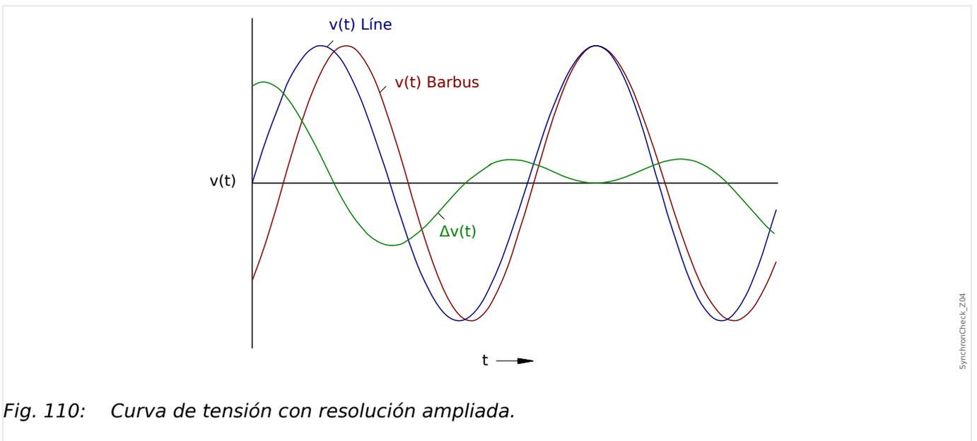
Fig. 110: Curva de tensión con resolución ampliada.
