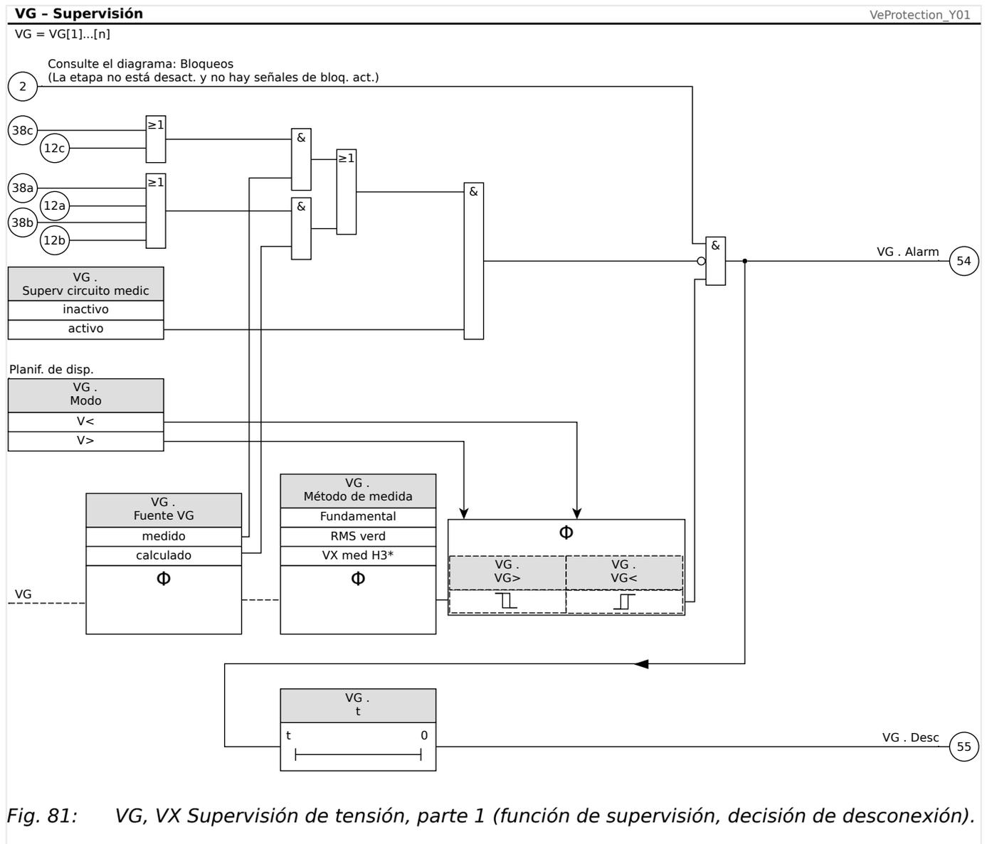
Fig. 81: VG, VX Supervisión de tensión, parte 1 (función de supervisión, decisión de desconexión).
