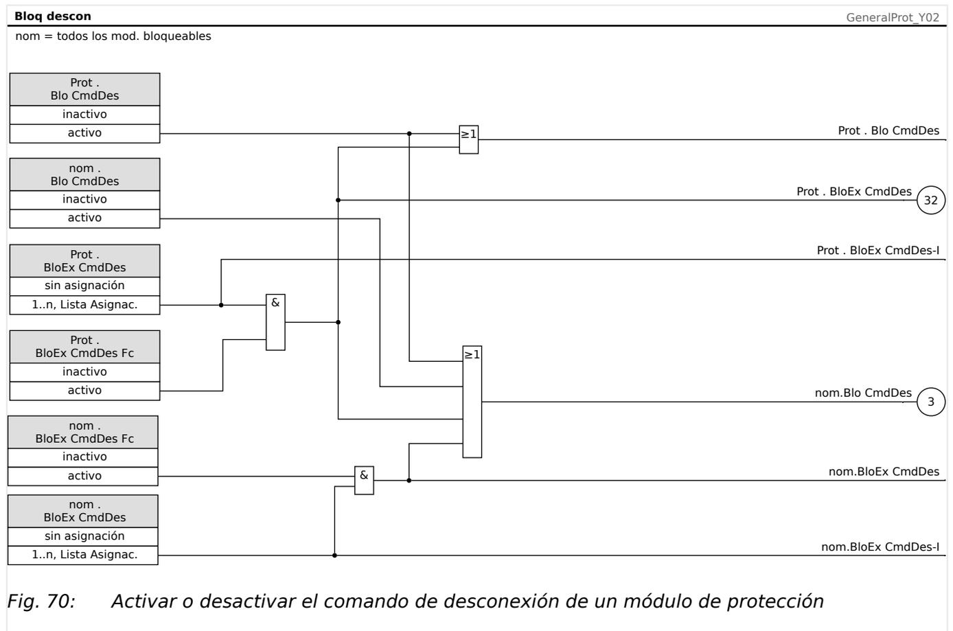
Fig. 70: Activar o desactivar el comando de desconexión de un módulo de protección
