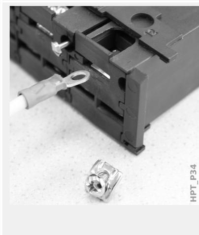
Cada terminal consta de un tornillo con una pieza de metal de contacto diseñada para que no se extravíe. El tornillo, así como a pieza de contacto, se puede desatornillar completamente.
