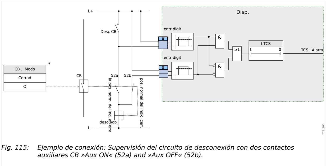
Fig. 115: Ejemplo de conexión: Supervisión del circuito de desconexión con dos contactos auxiliares CB »Aux ON« (52a) and »Aux OFF« (52b).
