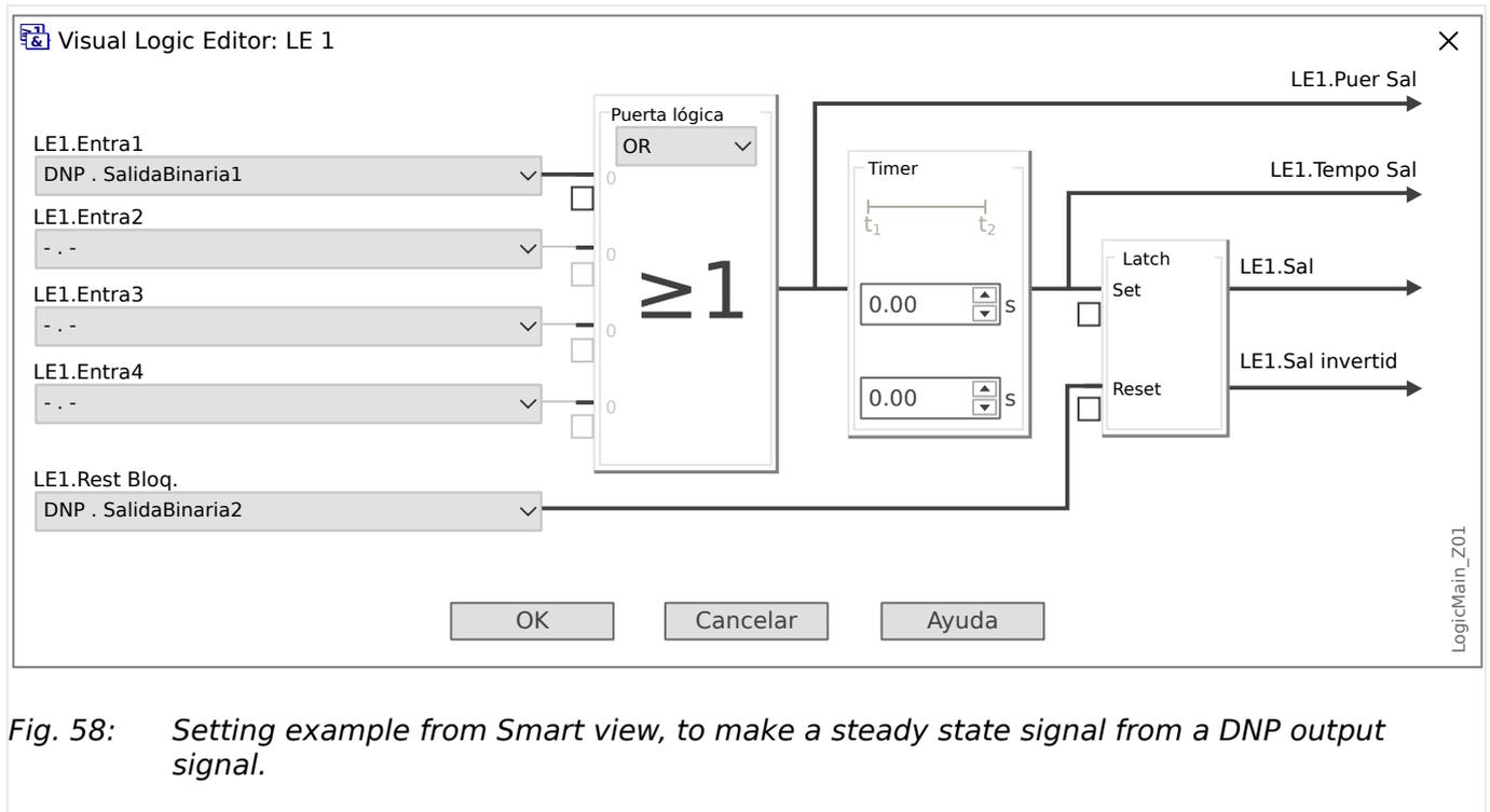
Las señales de las salidas binarias de DNP no pueden usarse directamente para cambiar de un relé a otro, ya que las salidas binarias DNP son señales de impulsos (según DNP, sin estado estacionario). Los estados estacionarios pueden crearse con funciones lógicas. Las funciones lógicas se pueden asignar a las entradas del relé.
