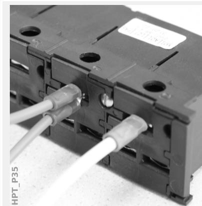
Observación: Siempre que las secciones cruzadas del cable estén dentro de los límites especificados en el capítulo de datos técnicos (↪ «12 Datos técnicos», ↪ Tabla ), también es posible insertar dos anillos en un terminal, tal como aquí se indica. Esto resulta útil para establecer la conexión de punto neutro.
