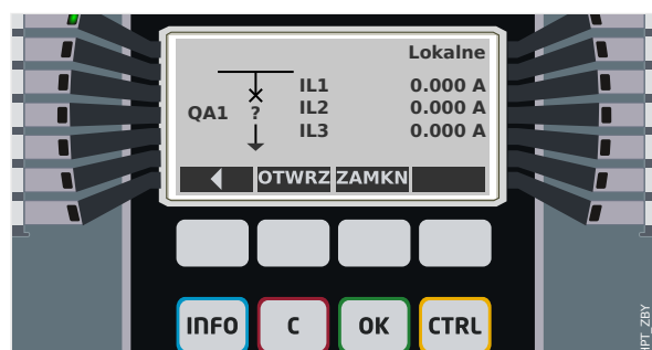
Rys. 64: Przykład strony sterowania z wyłącznikiem w pozycji zakłóconej (lub nieprawidłowej).
