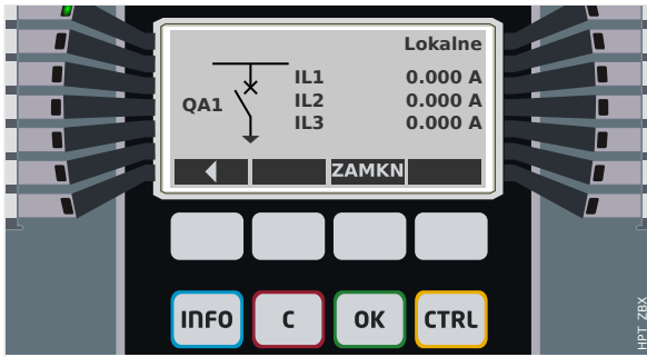
Rys. 66: Przykład strony sterowania z wyłącznikiem w pozycji otwartej.
