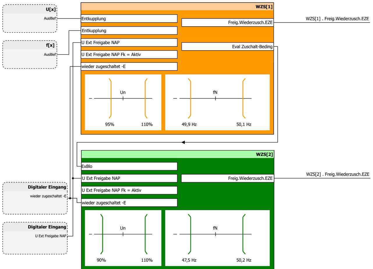
Abb. 58: Applikationsbeispiel für ein (Wieder-)Zuschalten in Abhängigkeit von einer vorherigen Auslösung des Entkupplungsschutzes.
