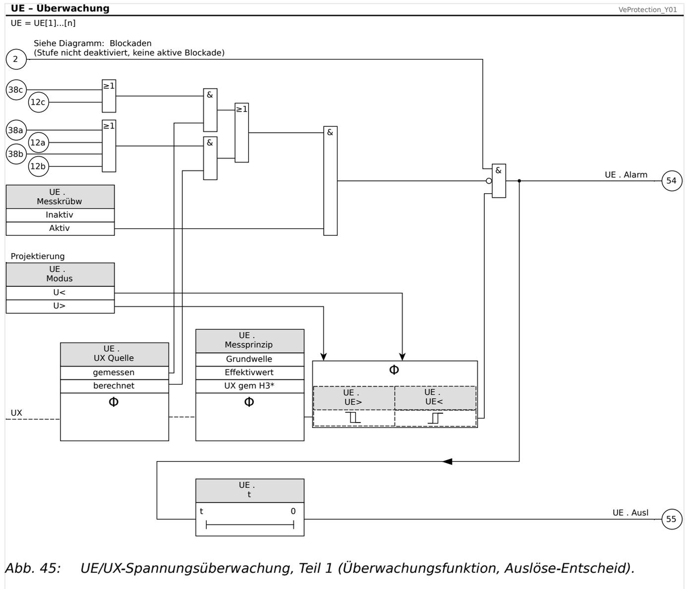
Abb. 45: UE/UX-Spannungsüberwachung, Teil 1 (Überwachungsfunktion, Auslöse-Entscheidung).
