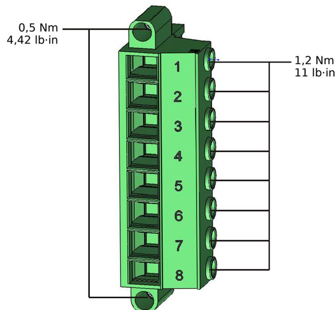
Abb. 85: Spannungsmessstecker der Spannungsmesskarte „TU“ ([↔3.5.1 TU - Spannungsmesseingänge](#)).
