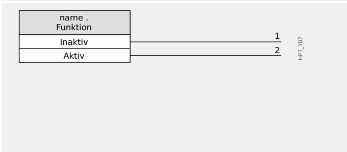
Wenn der Einstellwert des Parameters »name . Funktion« auf „Inaktiv“ eingestellt ist, wird Ausgang 1 aktiv, Ausgang 2 ist inaktiv.
