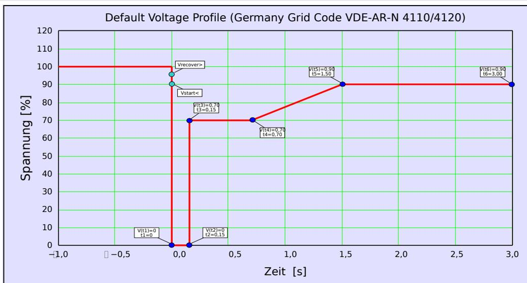
Abb. 62: LVRT-Werkseinstellung (Typ I).
