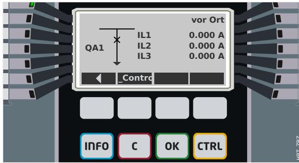
Abb. 68: Beispiel einer Steuer-Seite mit geschlossenem „Leistungsschalter“.
