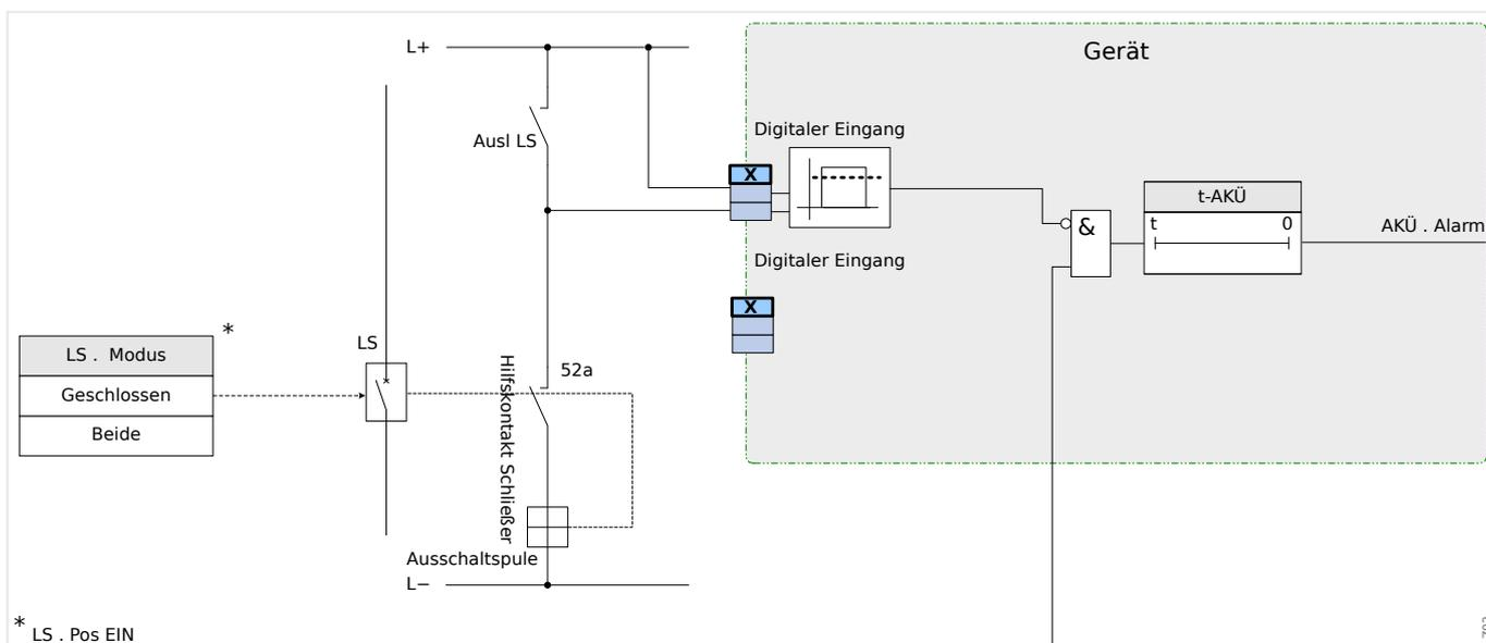
Abb. 65: Anschlussbeispiel: Auslösekreisüberwachung mit einem Hilfskontakt »Hiko EIN« (52a).
