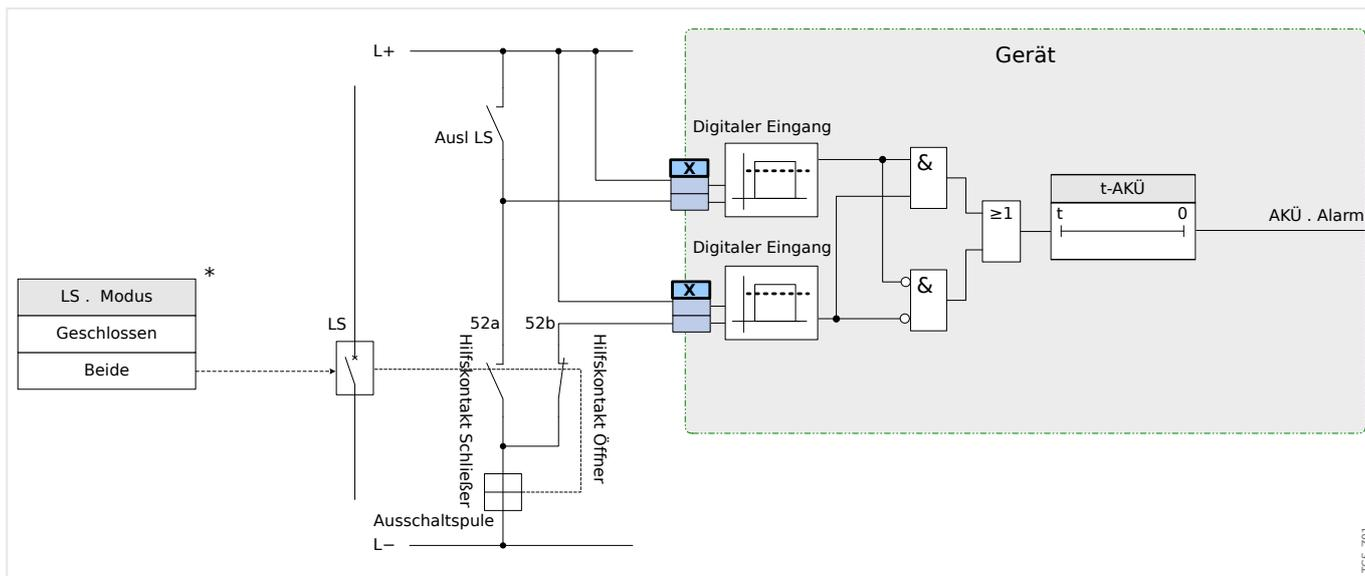
Abb. 64: Anschlussbeispiel (Empfehlung): Auslösekreisüberwachung mit zwei Hilfskontakten »Hiko EIN« (52a) und »Hiko AUS« (52b).
