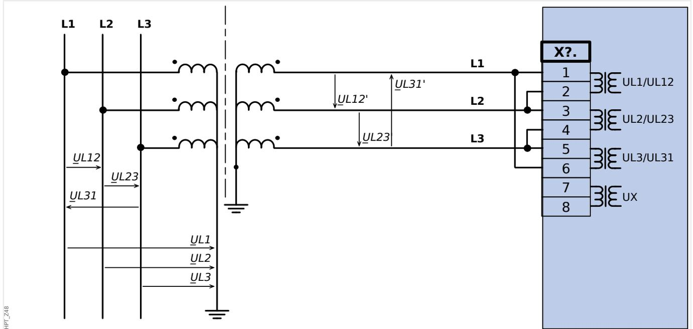
Abb. 19: Drei Spannungswandler mit Geräteanschluss in Dreieckschaltung
