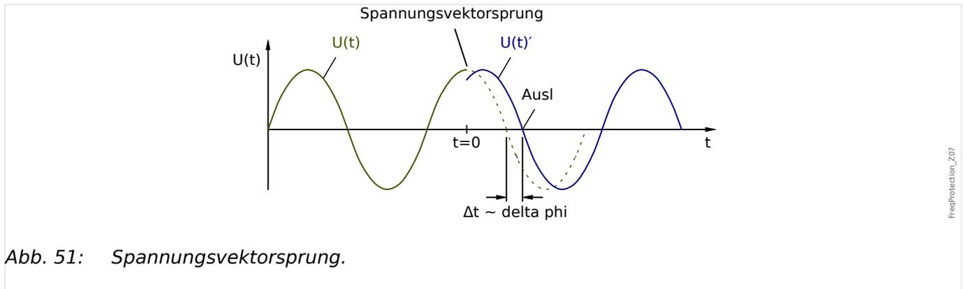
Abb. 51: Spannungsvektorsprung.
