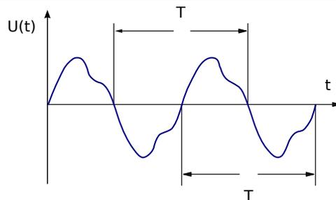
Frequenzmessung und alle Frequenz-Schutzfunktionen werden blockiert, sobald die Spannung unter den Wert fällt, der hier einstellbar ist: [Feldparameter / Frequenz] »U Block f« - Dies verhindert falsche Anregungen des Frequenzschutzes, falls ein Netzfehler die Spannungsmessung stört. Wenn zum Beispiel ein Lichtbogen durch einen Netzfehler entsteht, werden große Anteile von Harmonischen bei der Spannung gemessen. Solche Störungen verhindern eine präzise Ermittlung der Frequenz.
