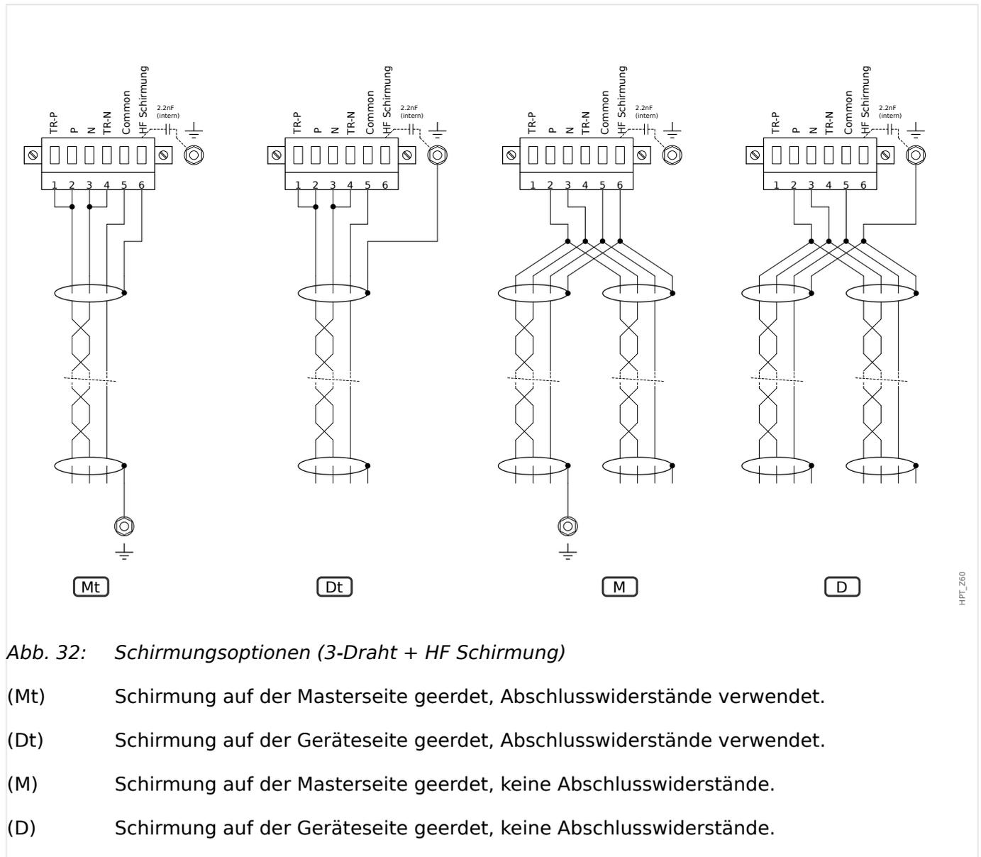
Abb. 32: Schirmungsoptionen (3-Draht + HF Schirmung)
