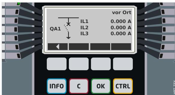
Abb. 67: Beispiel einer Steuer-Seite mit „Leistungsschalter“ in Zwischenposition).
