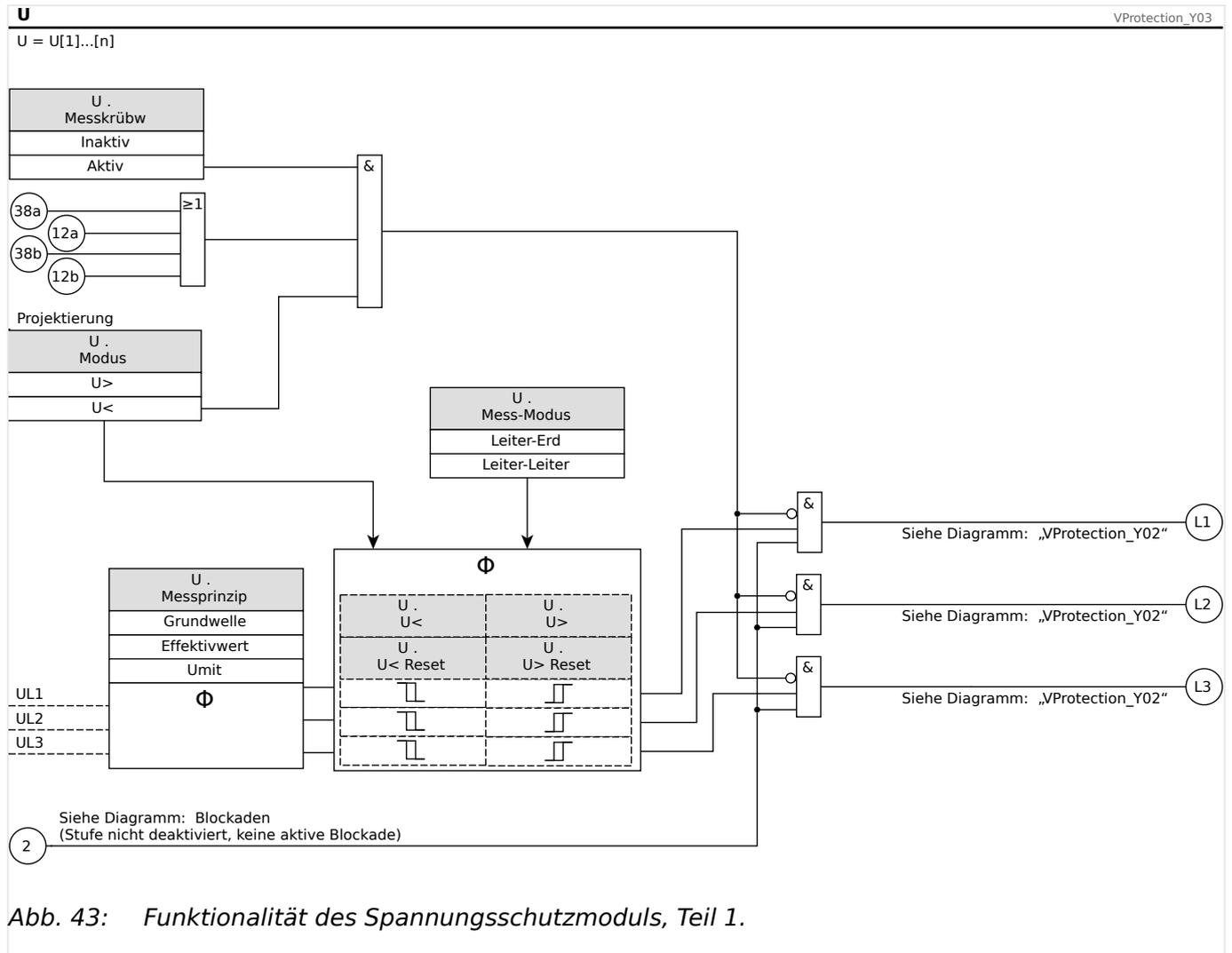
Abb. 43: Funktionalität des Spannungsschutzmoduls, Teil 1.
