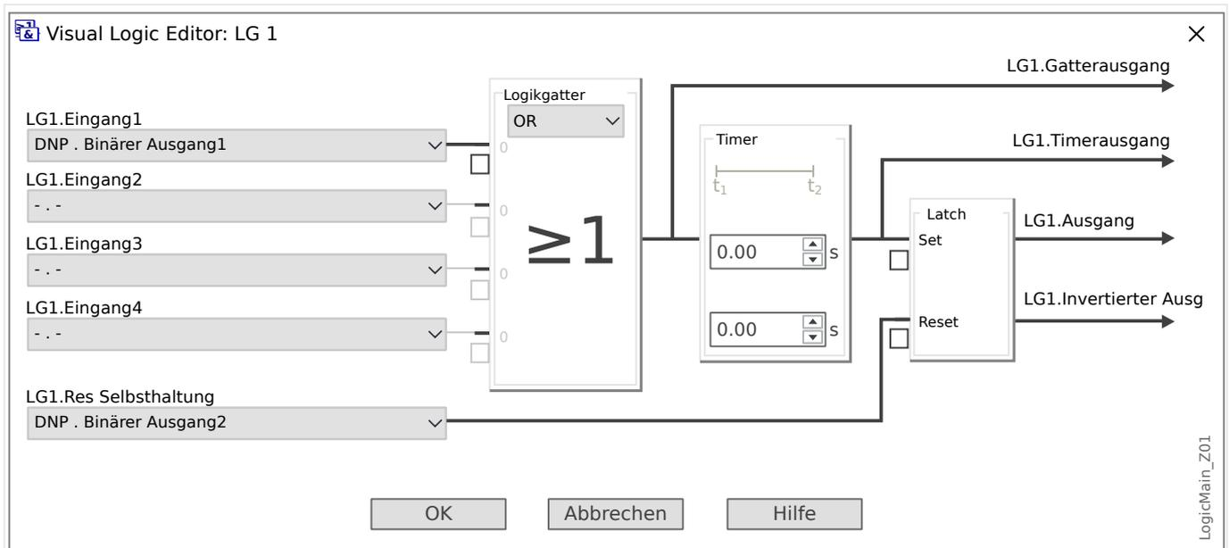
Abb. 38: Einstellbeispiel aus Smart view, um einen statischen Zustand aus einem DNP-Ausgangssignal zu erhalten.
