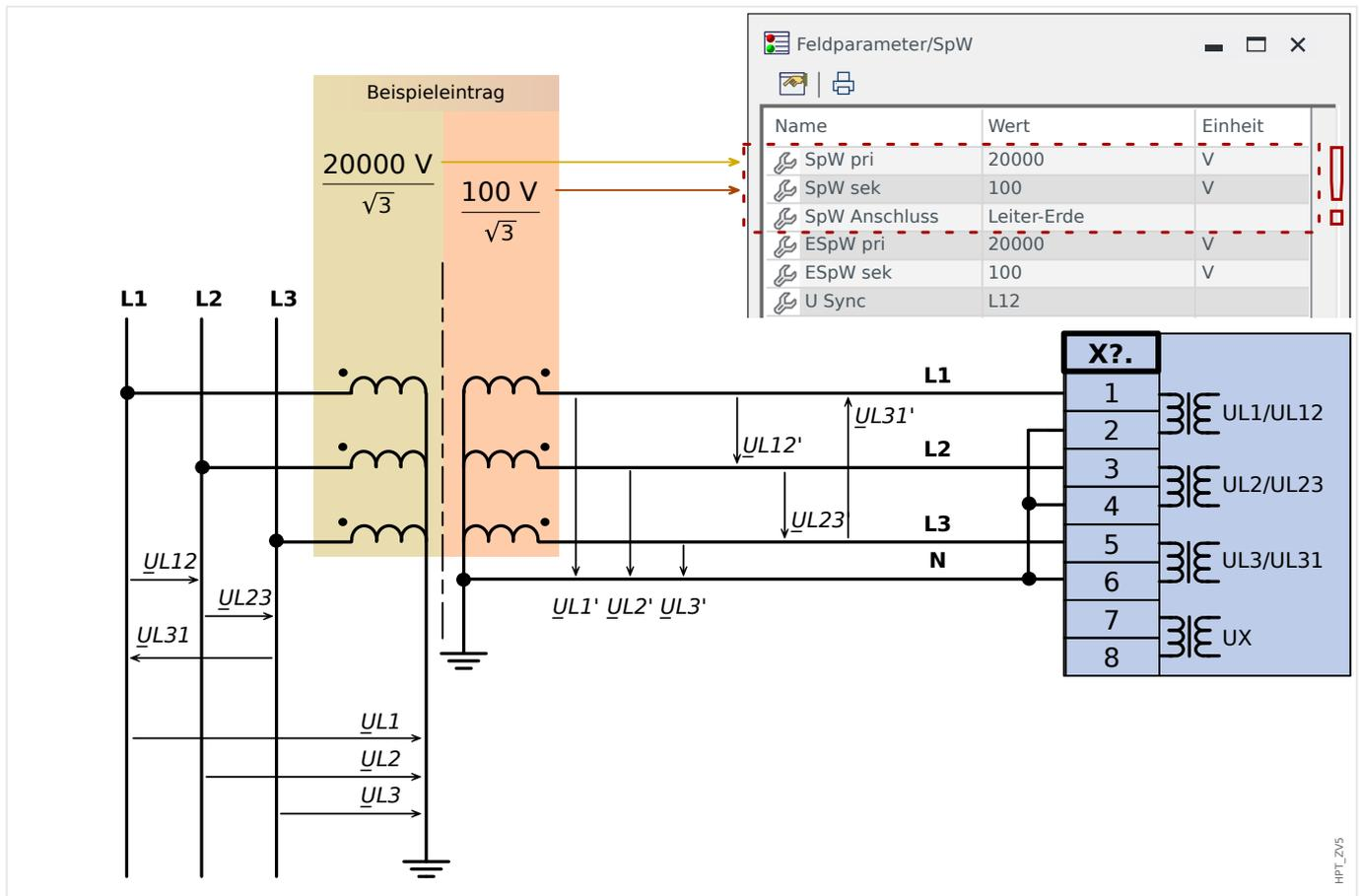
Die Verlagerungsspannung wird bei folgender Einstellung aus den drei Leiter-Erde-Spannungen errechnet:
