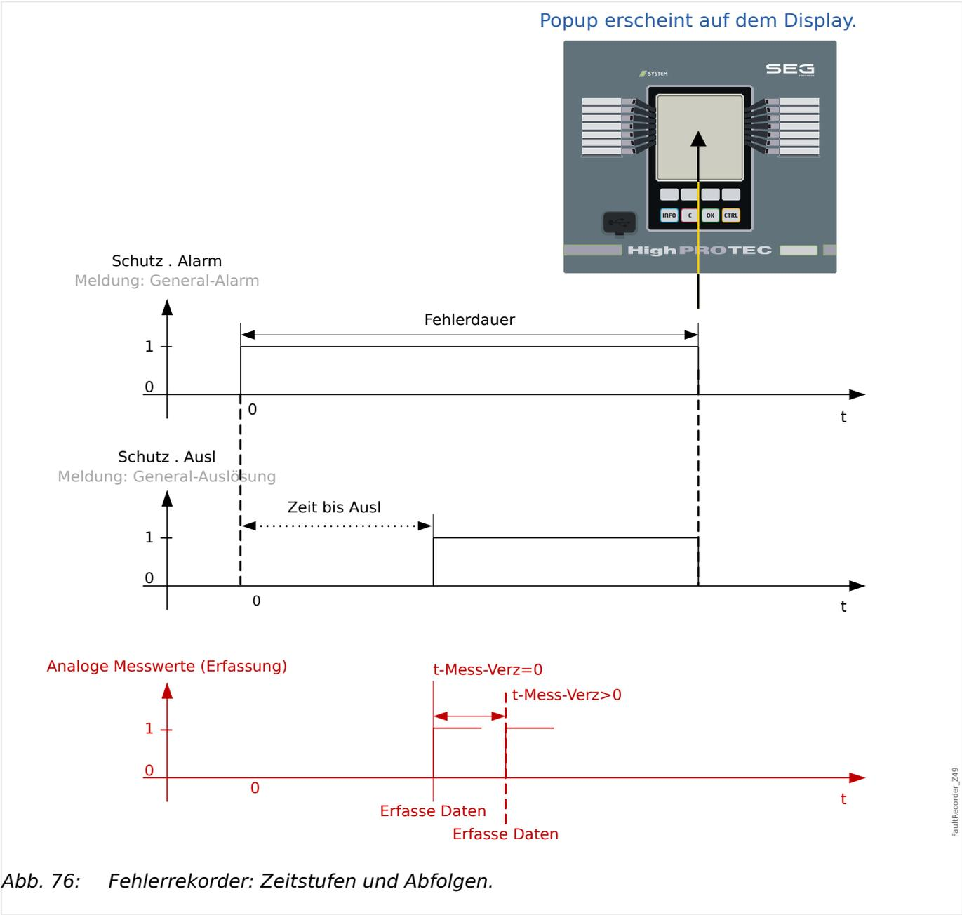
Abb. 76: Fehlerrekorder: Zeitstufen und Abfolgen.
