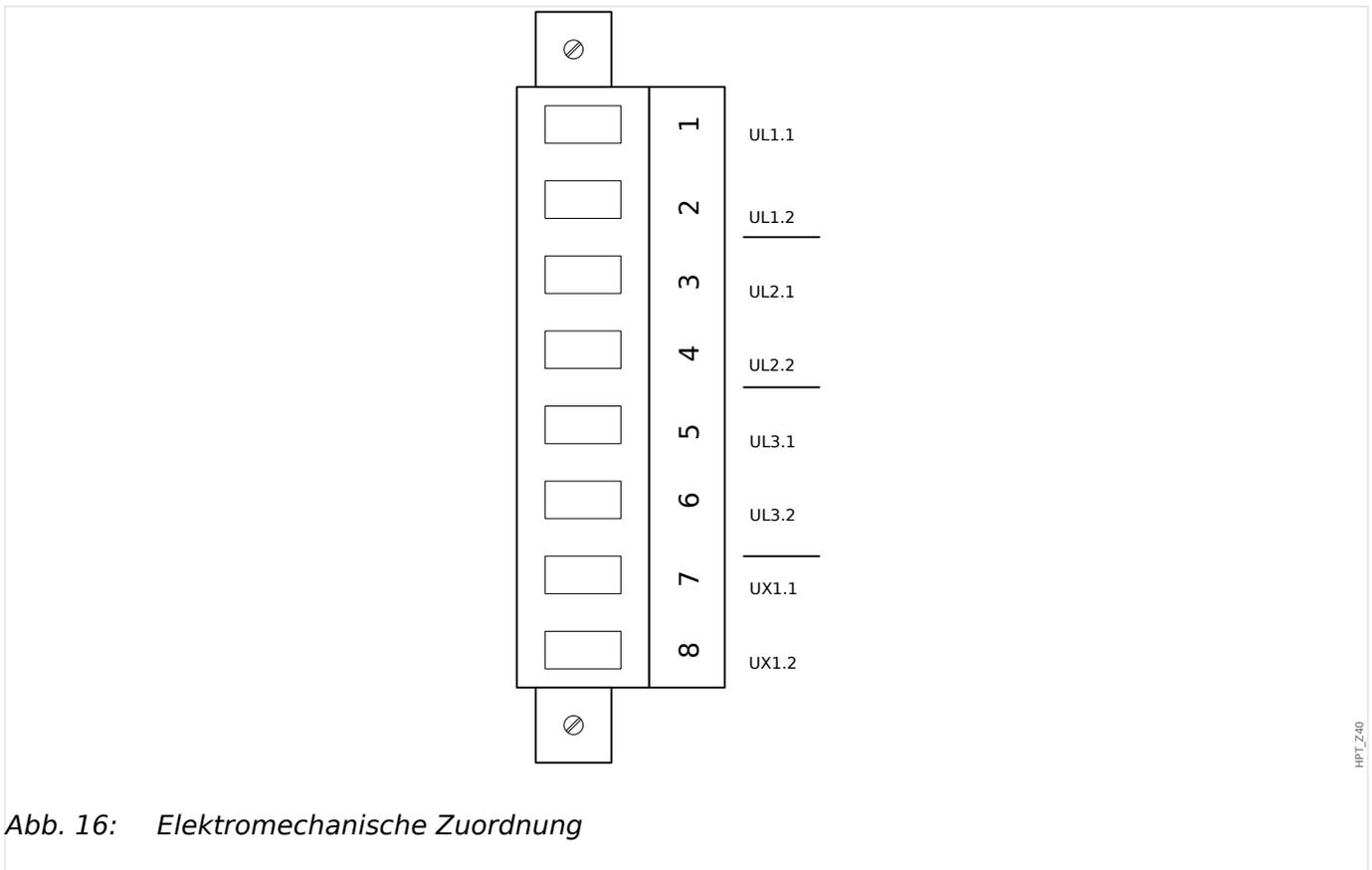
Abb. 16: Elektromechanische Zuordnung
