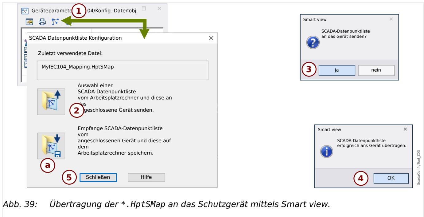
Abb. 39: Übertragung der \*.HptSMap an das Schutzgerät mittels Smart view.
