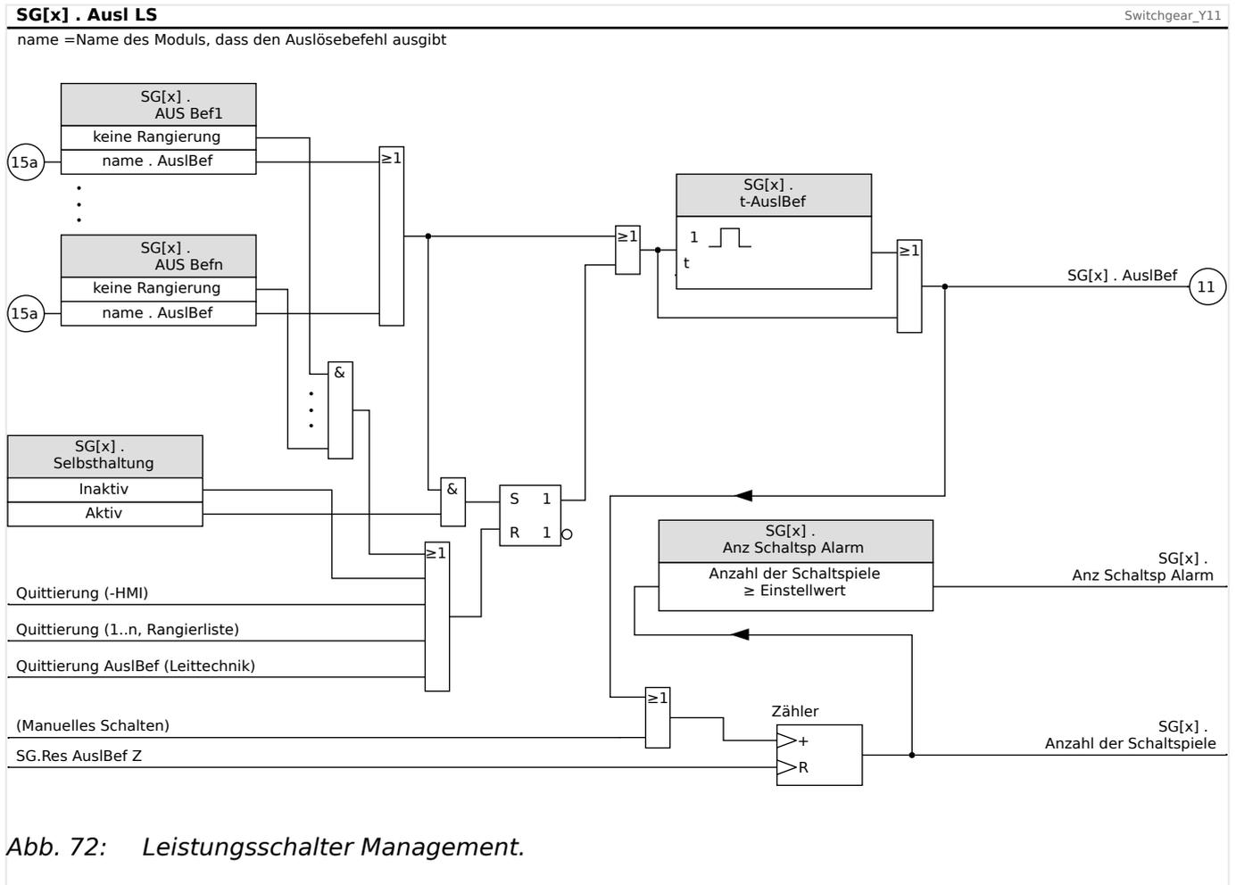
Anmerkung: In diesem Logikdiagramm steht „SG[x]“ für „Schaltgerät Nummer x“; die genaue Schaltgerätebezeichnung wird allerdings über das Abzweigsteuerbild (Single-Line-Diagramm) festgelegt. (Siehe auch [↔ „Abzweigsteuerbild \(Single Line\)“](#).)
