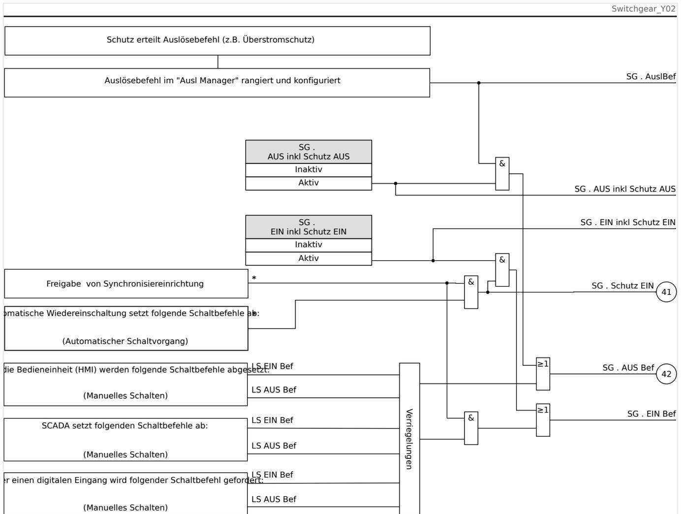
Abb. 71: Verriegelungen. (Für die mit „\*“ markierten Teile gilt: Verfügbarkeit hängt von der bestellten Gerätevariante ab.)
