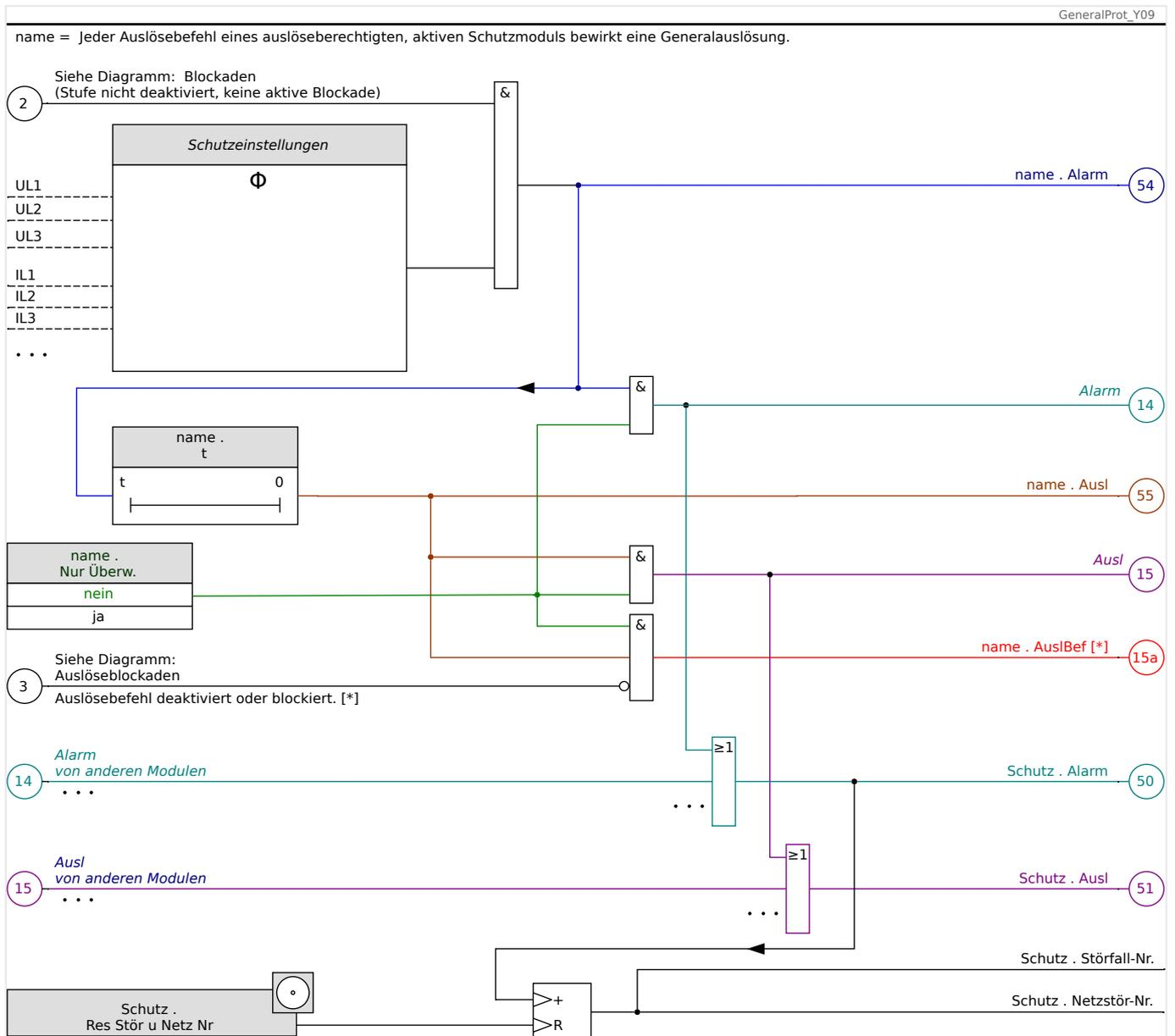
Abb. 41: Grobe Skizze der Funktionalität einer HighPROTEC-Schutzfunktion.
