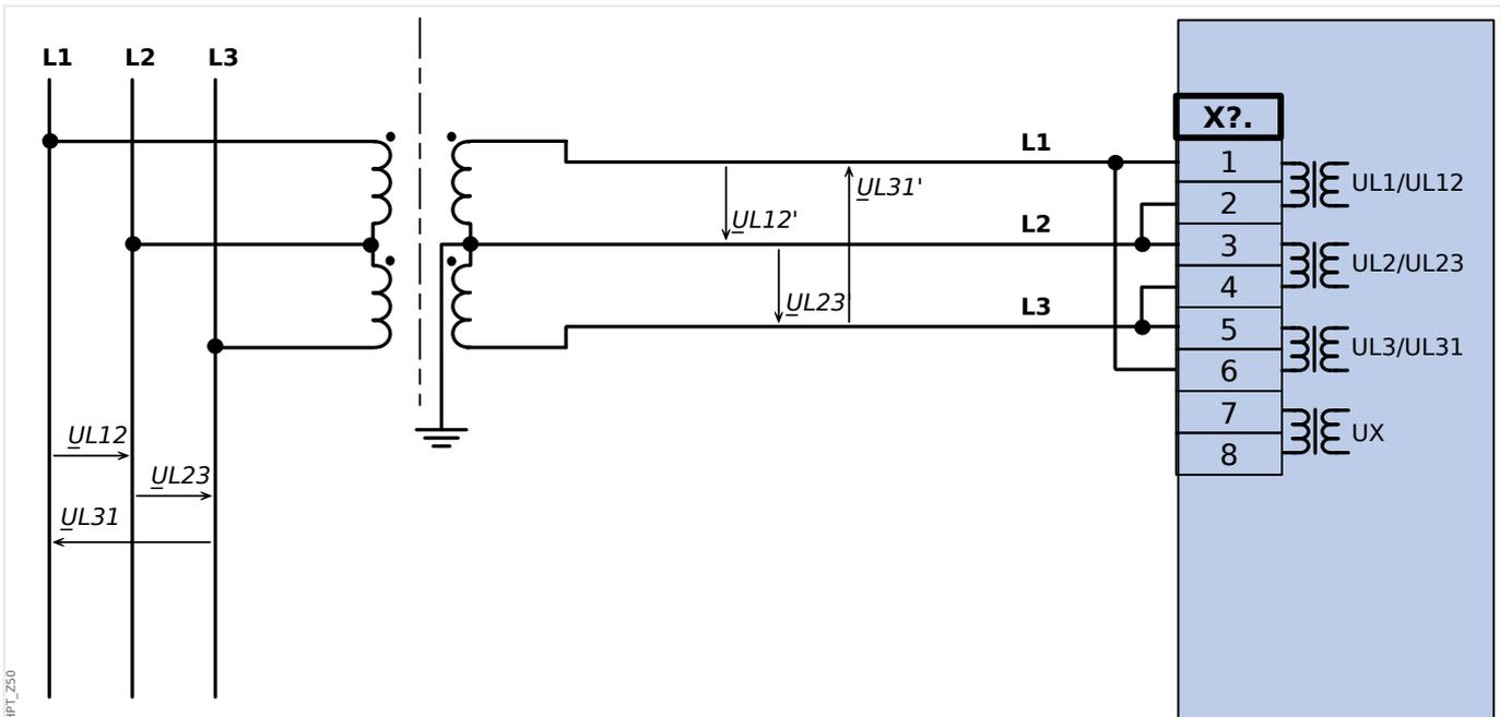
Abb. 21: Zwei Spannungswandler mit Geräteanschluss in V-Schaltung
