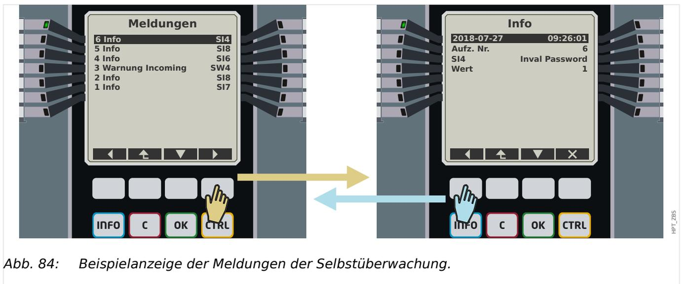
Abb. 84: Beispielanzeige der Meldungen der Selbstüberwachung.
