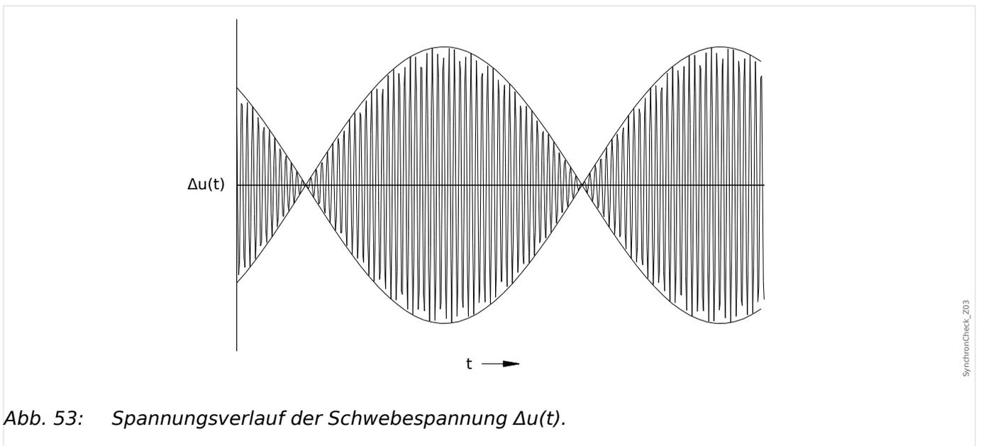
Abb. 53: Spannungsverlauf der Schwebespannung  $\Delta u(t)$ .
