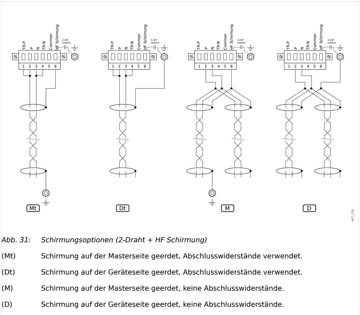
Abb. 31: Schirmungsoptionen (2-Draht + HF Schirmung)
