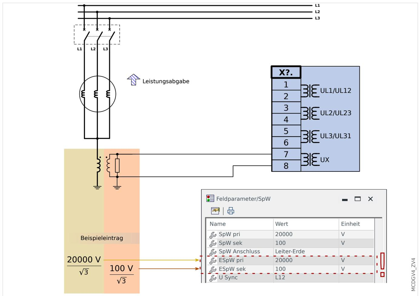
Nach korrektem Anschluss der Spannungsmesseingänge wird die Verlagerungsspannung bei folgender Einstellung gemessen:
