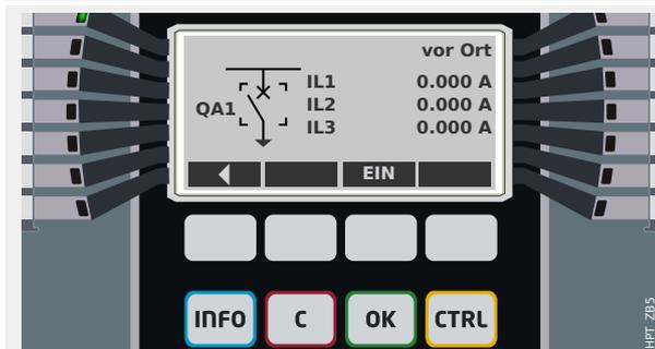
Über den Softkey „►“ (Enter) erreicht man ein erweitertes Abzweigsteuerbild (nachdem das Passwort für den Zugriffsbereich „Strg-Lv1“ eingegeben worden ist); hier ist nun ein Betriebsmittel durch kleine Ecken markiert und dadurch als „ausgewählt“ gekennzeichnet. Falls mehrere Betriebsmittel unterstützt werden, ist außerdem der Softkey „Ausw“ sichtbar, über den (zyklisch durchrotierend) ein anderes Betriebsmittel angewählt werden kann.
