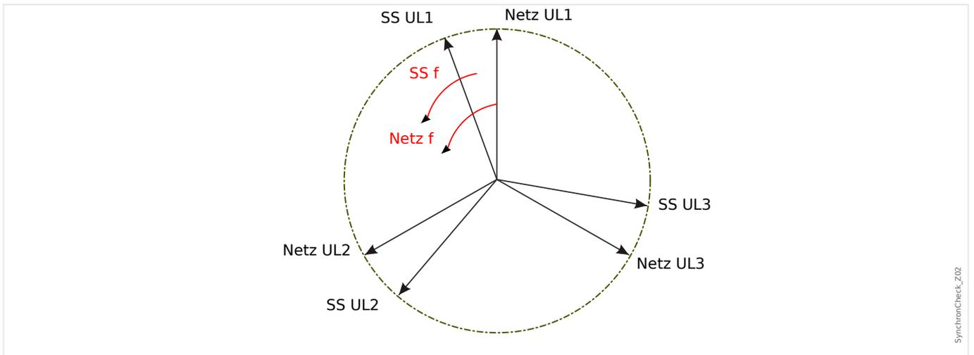
Wenn die Generatorfrequenz  $f_{SS}$  ungleich der Netzfrequenz  $f_{Netz}$  ist, so stellt sich zwischen den beiden Systemen eine Schwebefrequenz ein.  $\Delta f = |f_{SS} - f_{Netz}|$  Schwebefrequenz zwischen den beiden Systemen.
