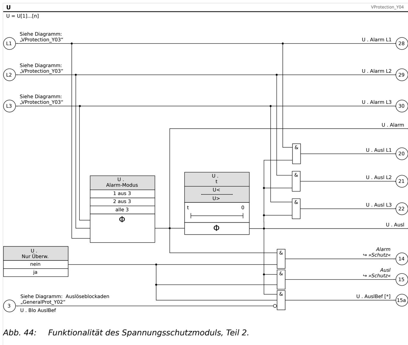
Abb. 44: Funktionalität des Spannungsschutzmoduls, Teil 2.
