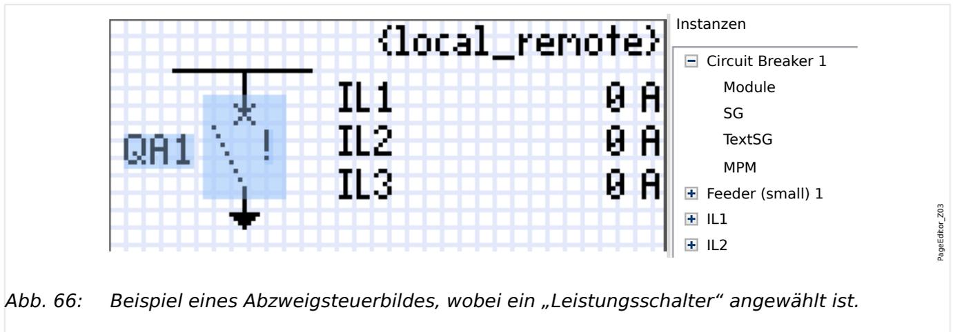
Abb. 66: Beispiel eines Abzweigsteuerbildes, wobei ein „Leistungsschalter“ angewählt ist.
