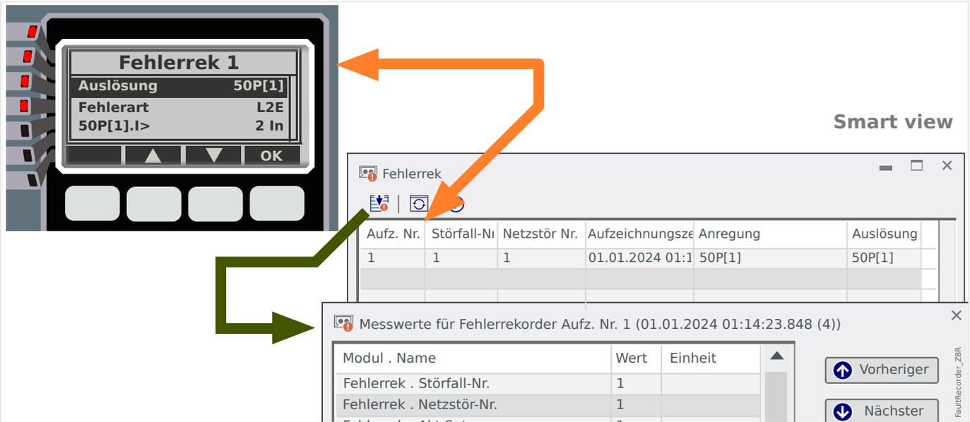
Abb. 77: Fehlerursachen-Anzeige auf dem Display und Anzeige des Fehlerrekorders in Smart view.
