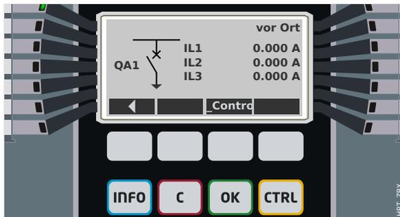
Abb. 70: Beispiel einer Steuer-Seite mit geöffnetem „Leistungsschalter“.
