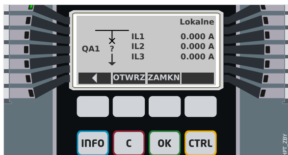
Rys. 65: Przykład strony sterowania z wyłącznikiem w pozycji zakłóconej (lub nieprawidłowej).
