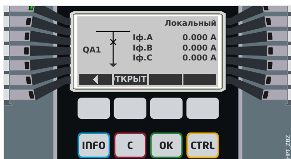
Рис. 63: Пример страницы управления, выключатель в замкнутом положении.
