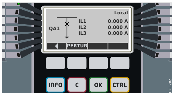
Fig. 63: Ejemplo de página de control, con el circuito en posición cerrada.
