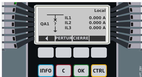
Fig. 64: Ejemplo de página de control, con el circuito en posición de fallo (o improbable).
