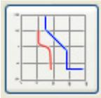
Ver datos de arranque de motor superpuestos con curvas de protección de motor (diagrama de perfil de arranque frente a límites de protección). El usuario puede ver la corriente media registrada durante el arranque de motor frente a elementos de protección como 50DP o el modelo térmico. El usuario tiene la opción de modificar los grupos de parámetros que se visualizan.
