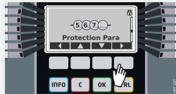
もう 1 つ例を示します。保護機能「I[2]」を有効にしたとします。たとえば、前の例で説明したとおり、「I[2] .Mode」 = “non directional”を設定します。
