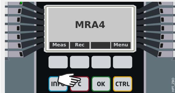
[Acknowledge]メニューを使用すると、ラッチされた信号、出力リレー、トリップ コマンドを「確認応答」(リセット)できます。このメニュー ブランチには、通常の方法でアクセスすることができますが、ショートカット操作もあります。「C」キーを押すと、直接目的の場所に移動します
