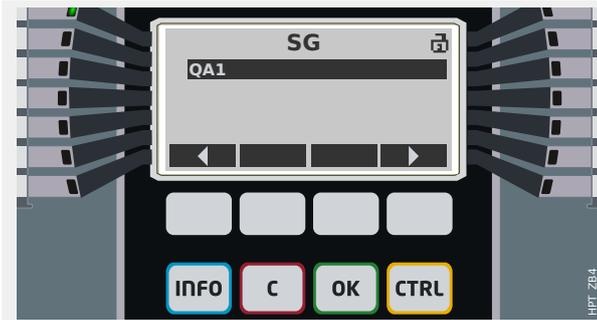
単線が表示されていると、ソフトキー「SG」によって、接続しているすべてのスイッチギヤ装置を一覧する画面に移動します
