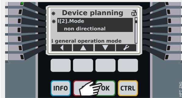
**[OK]**を1回押すと、選択したパラメーター - **»I[2].Mode«**を表示する画面に戻ります。
