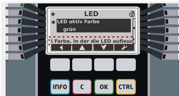
Die Markierung für **Information** „i“ wurde schon in [3.7 Einstellparameter - „OK“ key](#) erwähnt. Sie erscheint als Teil des Einstell-Dialogs (auf dem Display in einer eigenen Textzeile direkt über den Softkey-Funktionen, bzw. als Textfeld innerhalb eines *Smart view*-Einstell-Dialogfensters). Das „i“ markiert eine ausführliche Beschreibung des ausgewählten Parameters.
