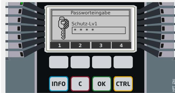
Genauso wie bei einer Parameteränderung (siehe [↪](#) „3.7 Einstellparameter - „OK“ key“) erfolgt eine Passwortabfrage (dieses Mal für den Zugriffsbereich „Schutz-Lv1“).
