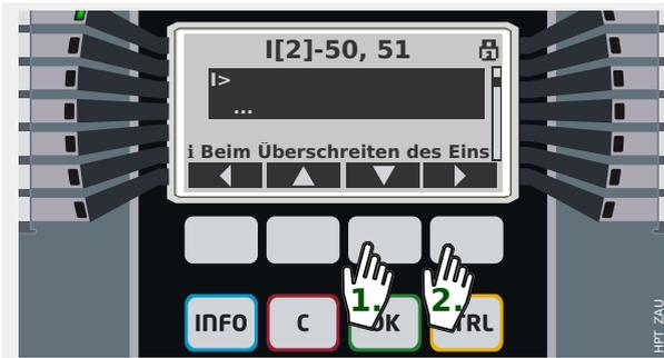
Nun wählen wir durch mehrfaches Betätigen von „▲“ bzw. „▼“ (mit abschließendem „▶“, wie üblich) den Parameter »I[2] . I>« aus.
