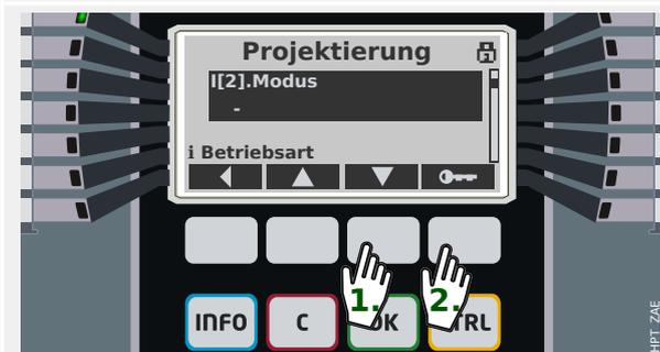
Anschließend betätigen wir den Softkey „▼“ (Ab) so oft, bis der gewünschte Parameter im Display markiert erscheint.
