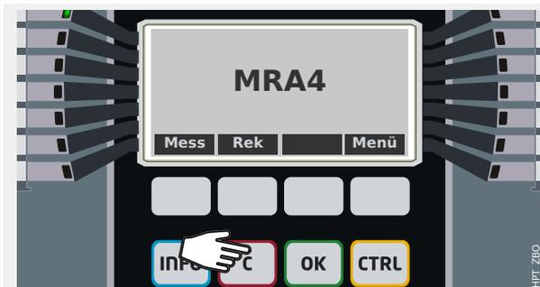
Über den Menüweig [Quittierung] lassen sich Signale in Selbsthaltung, Ausgangsrelais und/ oder Aus-Befehle „quittieren“ (d. h. rücksetzen). Man erreicht diesen Menüweig auf die übliche Weise, aber es ist alternativ auch möglich, einfach nur die „C“-Taste zu betätigen, d.h. die Taste bewirkt einen Direktsprung in diesen Menüweig.
