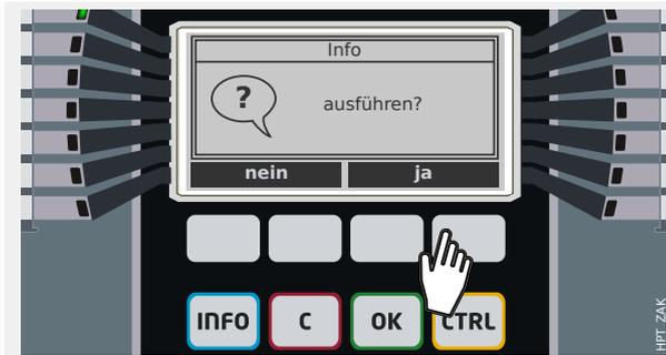
Nach korrekter Passwort-Eingabe (zur Erinnerung, diese wird immer mit der [OK]-Taste abgeschlossen) erfolgt ein Bestätigungsdialog.
