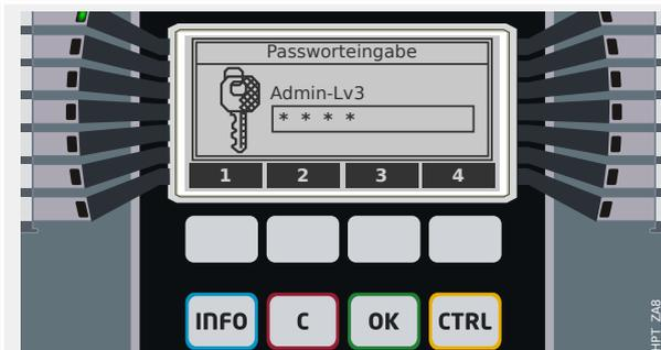
Allerdings werden wir zunächst nach dem Passwort gefragt, das für den gewählten Parameter erforderlich ist. Alle Einstellungen im Menü Projektierung verändern die Funktionsweise des Gerätes und verlangen daher nach dem Zugriffsbereich „Administrator“.
