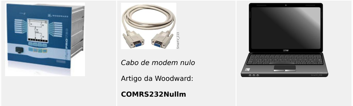
Após a instalação do *Smart view*, a »Conexão PC/notebook com o dispositivo« tem que ser configurada uma vez para que você possa ler dados do dispositivo ou regravá-los dentro do dispositivo por meio do *Smart view*.
