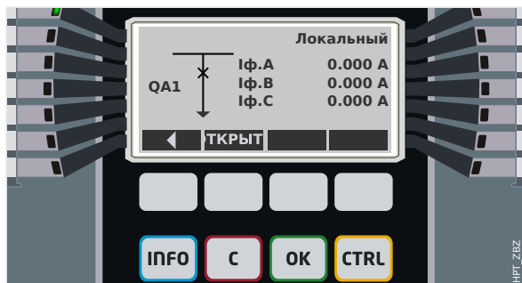
Рис. 77: Пример страницы управления, выключатель в замкнутом положении.
