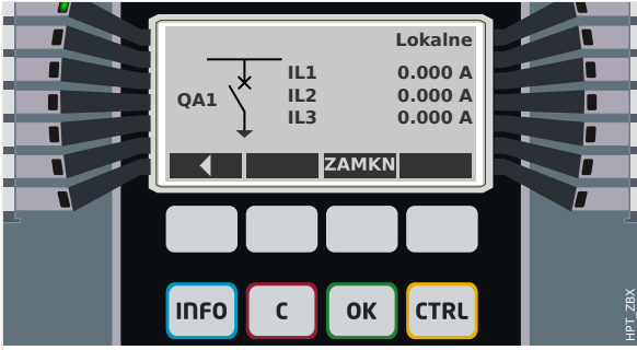
Rys. 79: Przykład strony sterowania z wyłącznikiem w pozycji otwartej.
