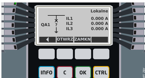
Rys. 78: Przykład strony sterowania z wyłącznikiem w pozycji zakłóconej (lub nieprawidłowej).
