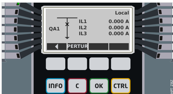
Fig. 77: Ejemplo de página de control, con el circuito en posición cerrada.
