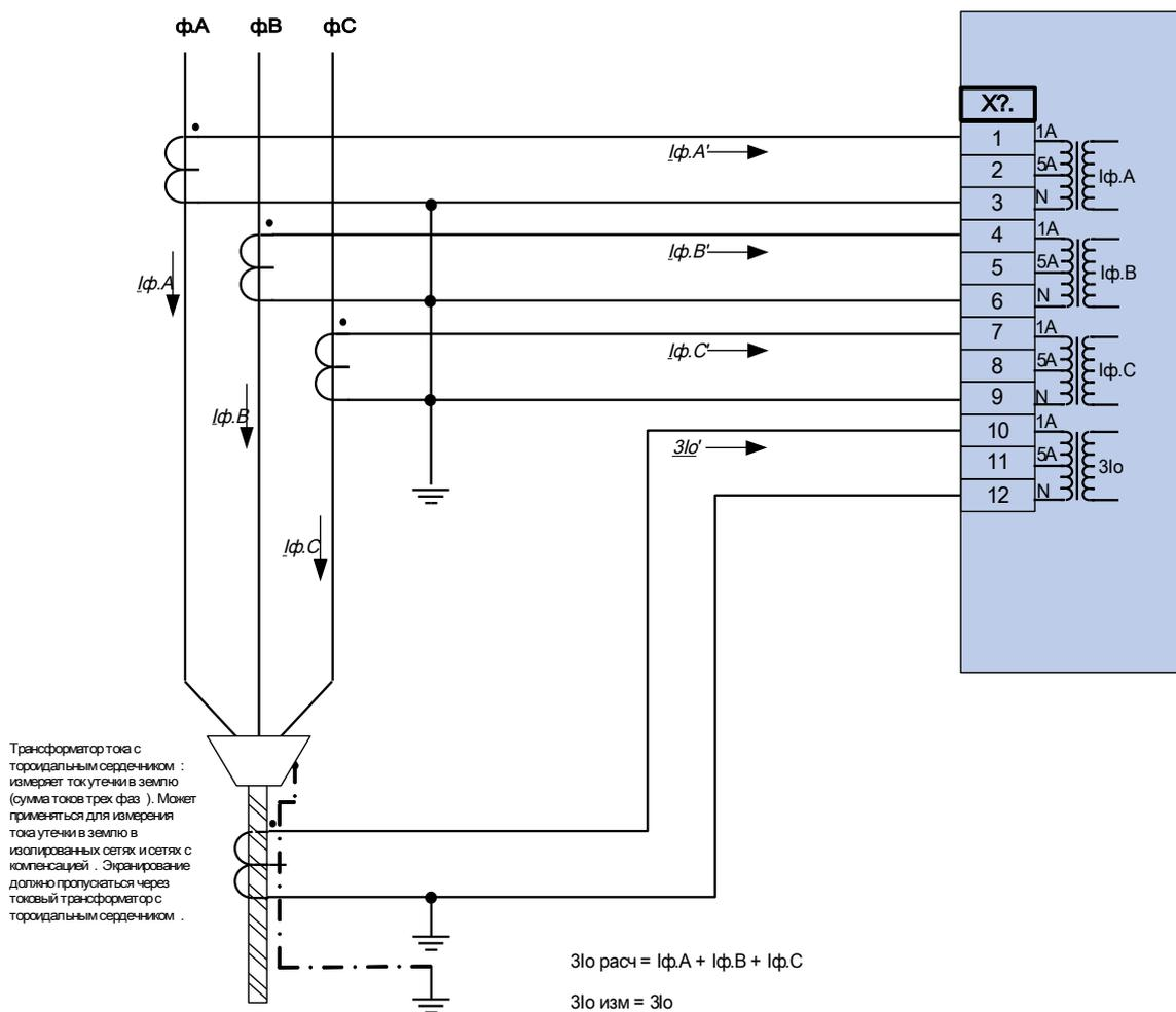
Измерение фазных токов по схеме «полной» звезды;  $I_n$  вторичн. = 1 А.
