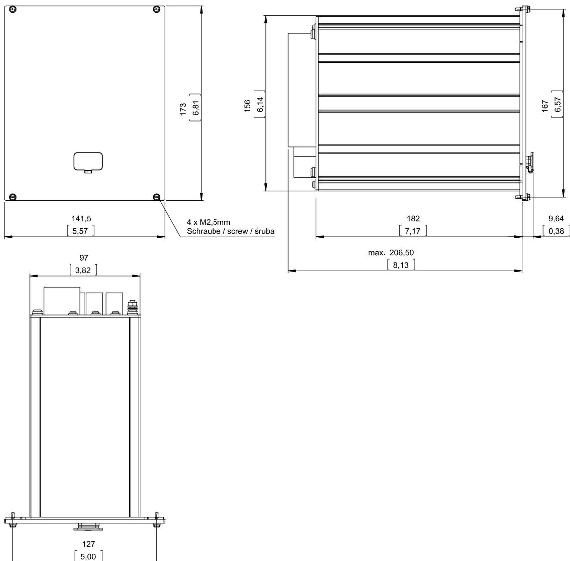
Корпус В1: внешний вид (устройства 19 дюймов). (Все размеры указаны в миллиметрах, за исключением размеров в квадратных скобках — [дюймы].)
