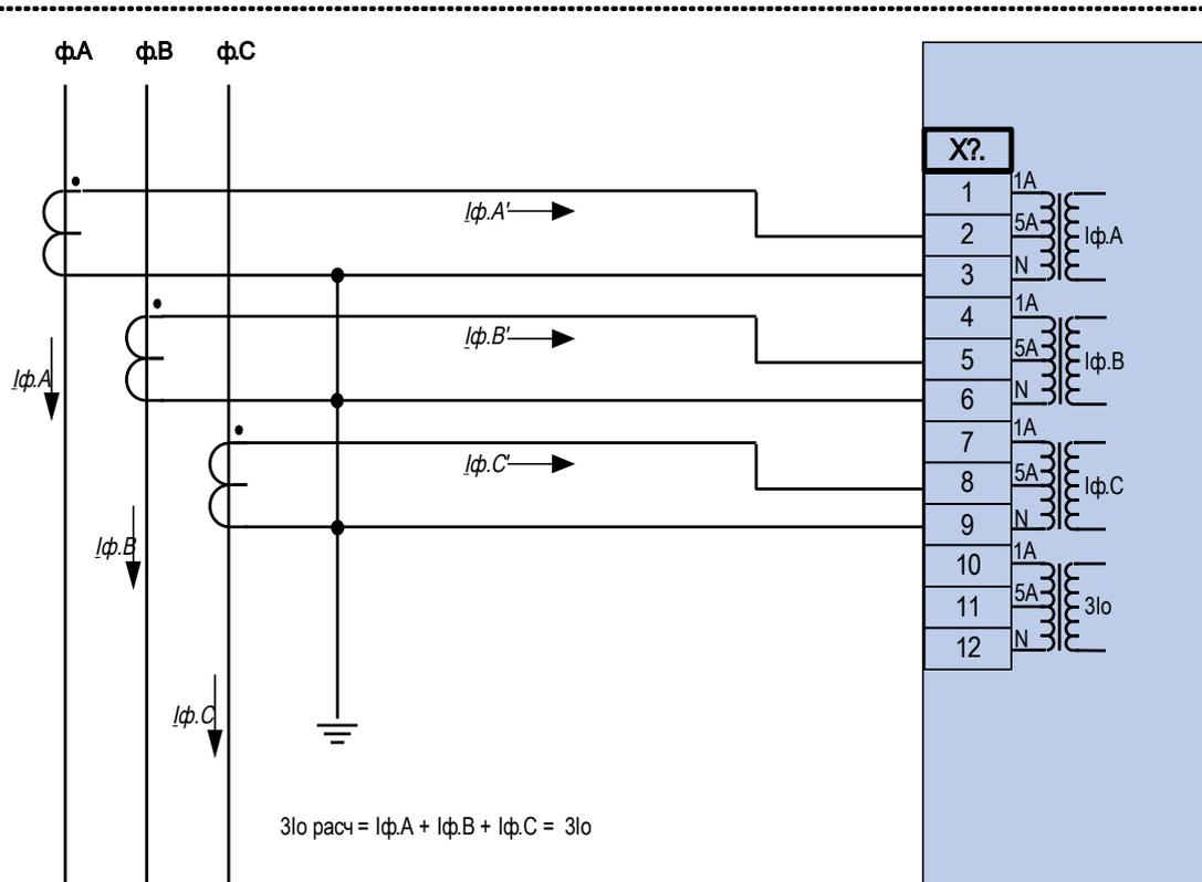
Измерение фазных токов по схеме «полной» звезды;  $I_n$  вторичн. = 5 А.
