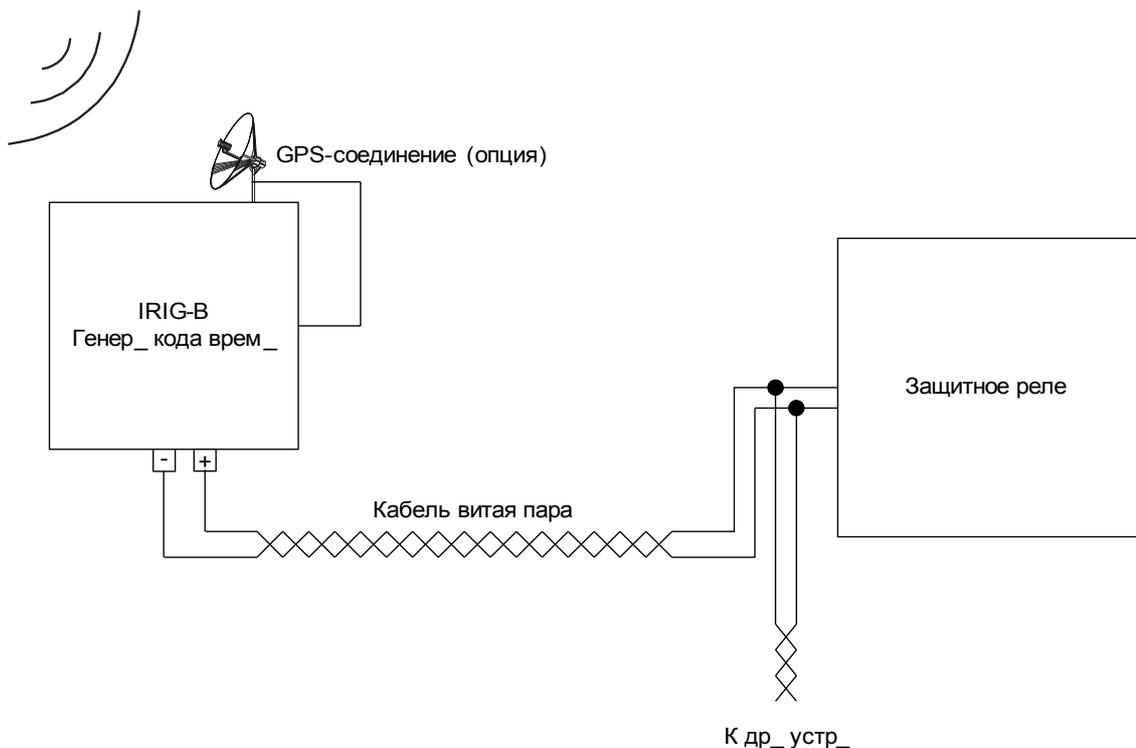
Расположение интерфейса IRIG-B зависит от типа устройства. См. электрическую схему, предоставляемую с защитным устройством.
