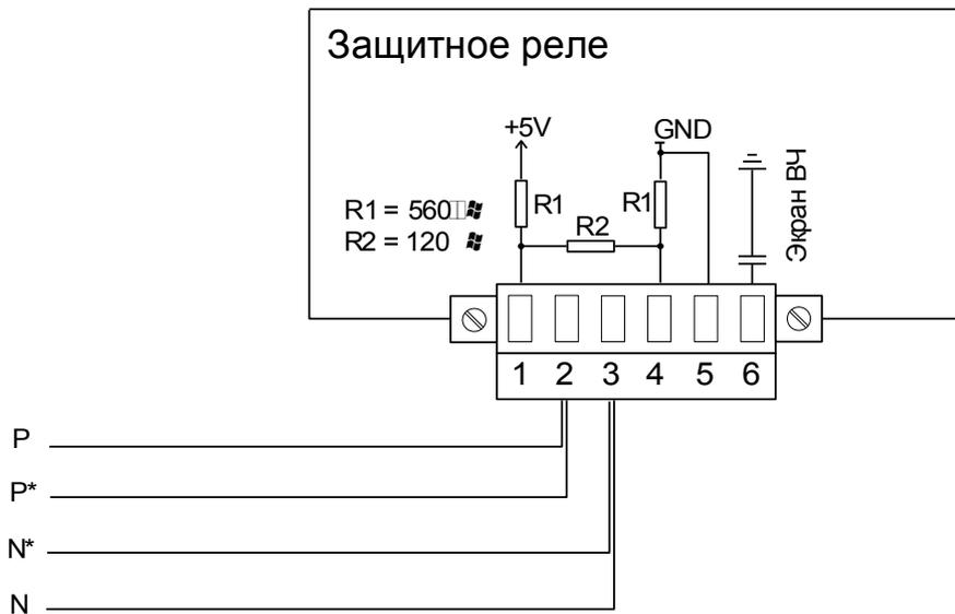
Пример соединения: устройство находится в **конце** системы шин (устанавливаются проволочные перемычки для активации встроенного оконечного резистора)
