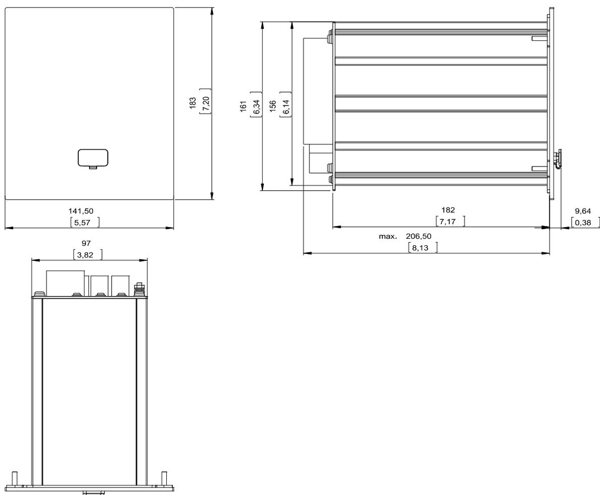
Корпус В1: внешний вид (устройства с 8 кнопками). (Все размеры указаны в миллиметрах, за исключением размеров в квадратных скобках — [дюймы].)
