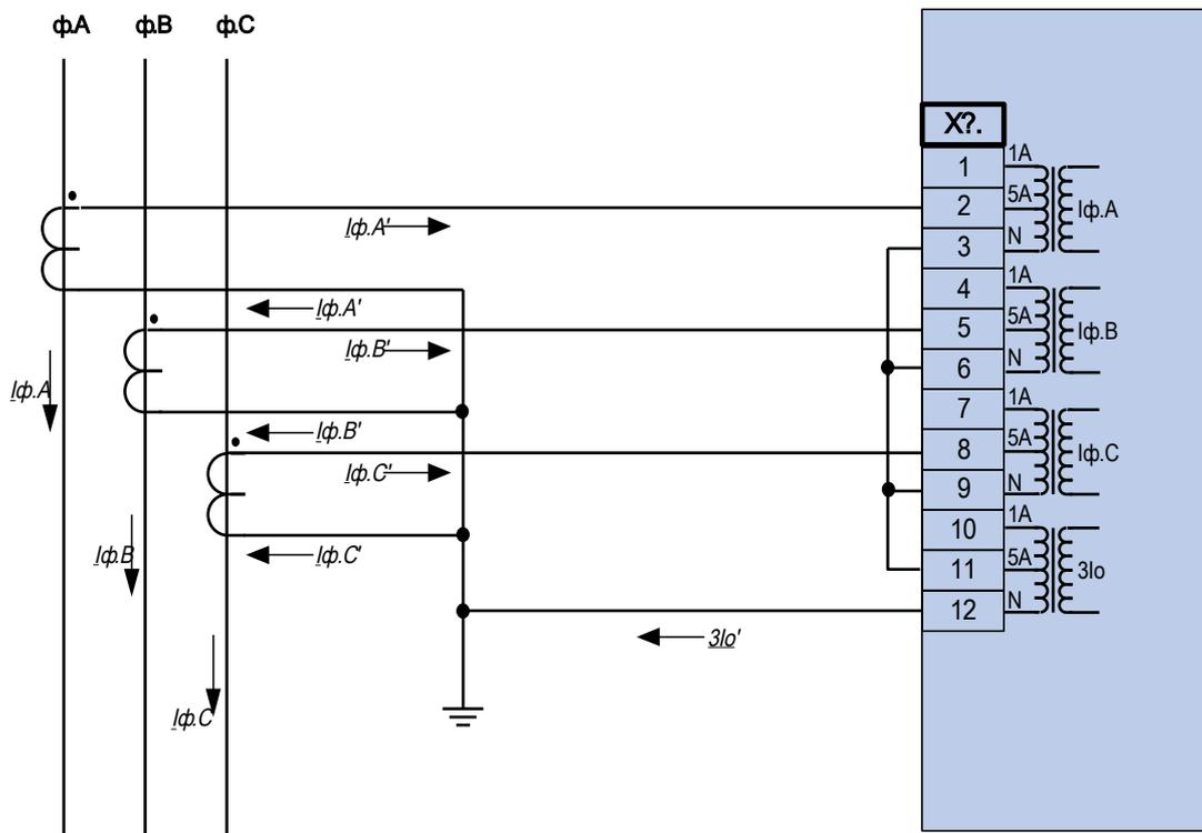
Измерение фазных токов по схеме «полной» звезды;  $I_n$  вторичн. = 5 А.
