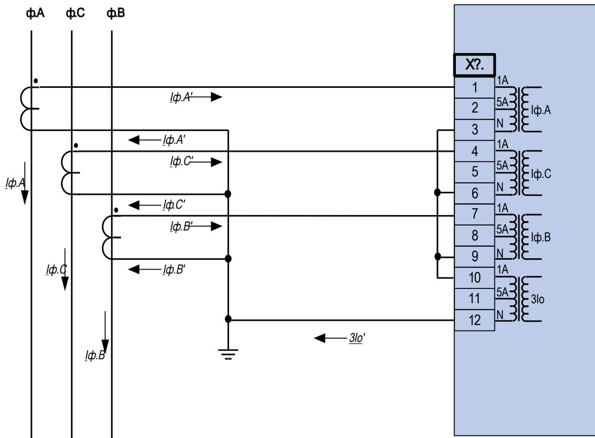
Измерение фазных токов по схеме «полной» звезды;  $I_n$  вторичн. = 1 А.
