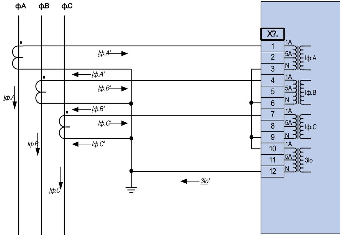
Измерение фазных токов по схеме «полной» звезды;  $I_n$  вторичн. = 1 А.
