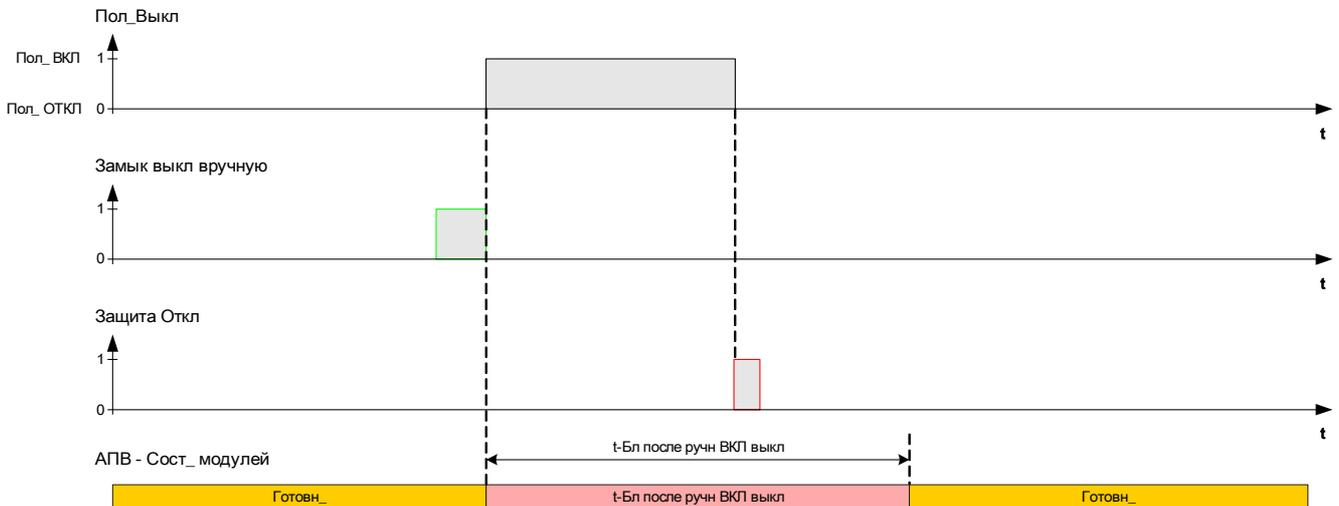
*Логика сброса блокировки АПВ при получении команды сброса блокировки перед ручным замыканием выключателя*
