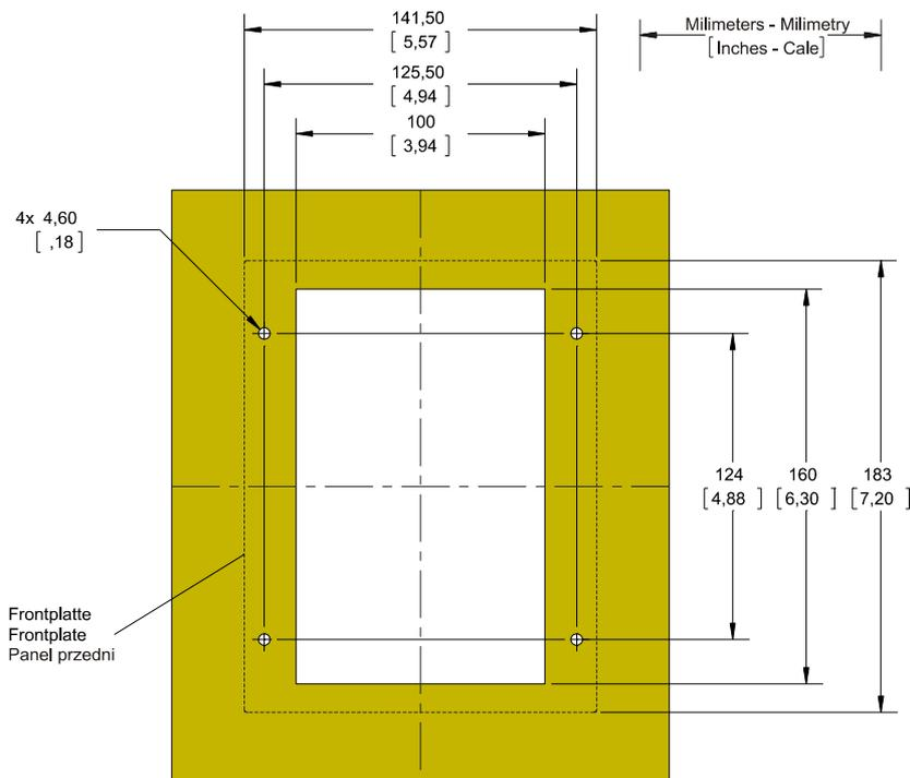
Автоматический выключатель дверцы корпуса В1 (версия с 8 кнопками). (Все размеры указаны в миллиметрах, за исключением размеров в квадратных скобках — [дюймы].)
