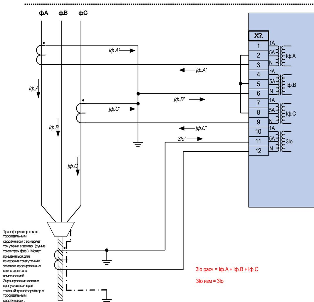
Измерение двухфазного тока («соединение открытым треугольником»);  $I_n \text{ вторичн.} = 5 \text{ A}$ .
