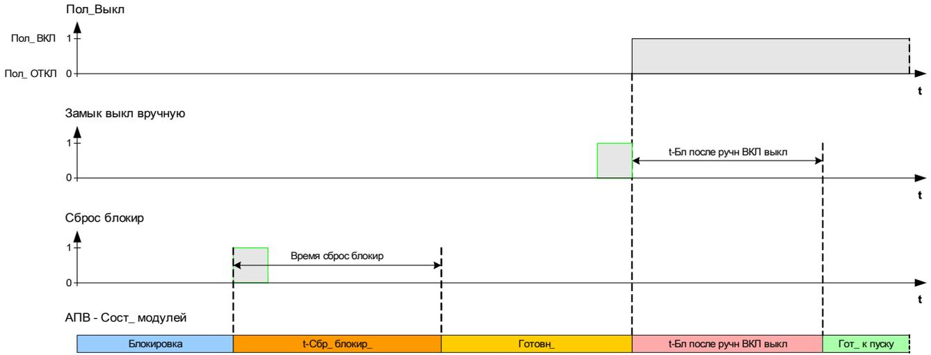
*Логика сброса блокировки АПВ в случае получения команды сброса блокировки после ручного замыкания выключателя*
