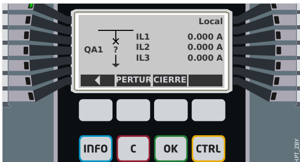
Fig. 61: Ejemplo de página de control, con el circuito en posición de fallo (o improbable).
