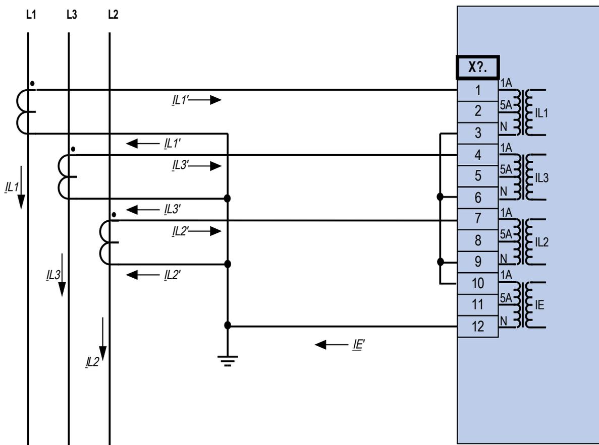
Dreiphasiger Stromwandleranschluss; In sekundär = 1 A.
