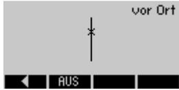
Nachdem der Schalter die neue Schaltstellung erreicht hat wird diese am Display angezeigt.
