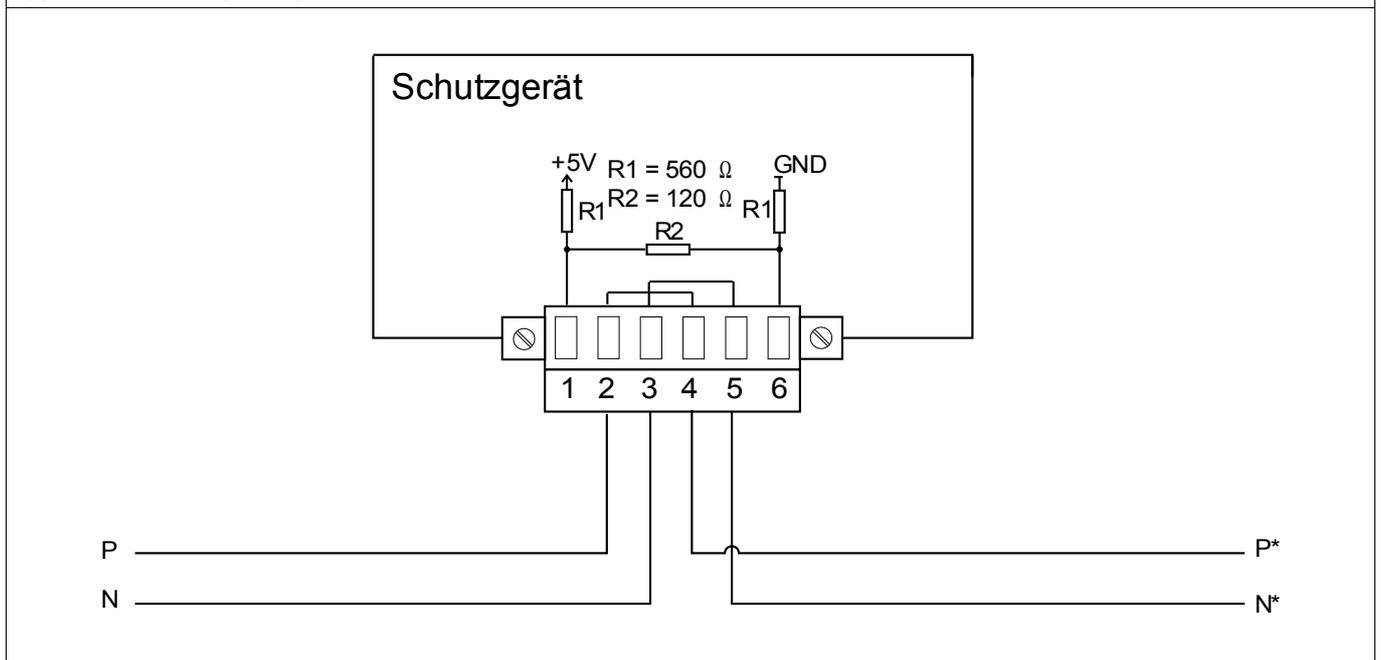
Typ 1 Verdrahtungsbeispiel, Gerät am Ende des Busses (Benutzen des integrierten Abschlusswiderstands)
