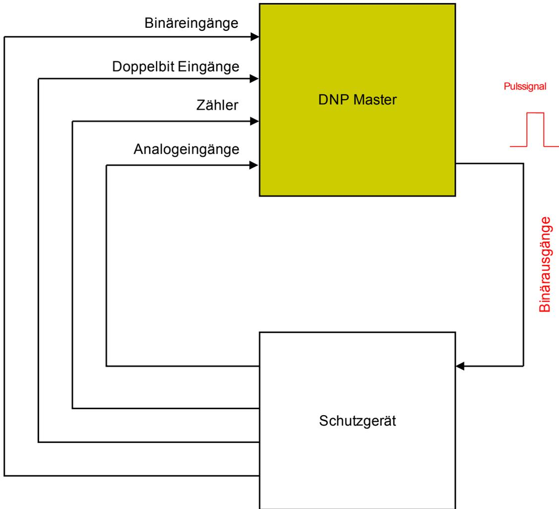
Vermeiden Sie Lücken (Gaps) in der Konfiguration/Rangierung des DNP Protokolls um die Übertragungsgeschwindigkeit zu optimieren. Das bedeutet, lassen Sie in der Konfiguration zwischen verwendeten Ein- und Ausgängen keine unverwendeten Ein-oder Ausgänge (Beispiel: Verwenden Sie nicht den Binärausgang 1 und 3, während 2 nicht verwendet wird.).
