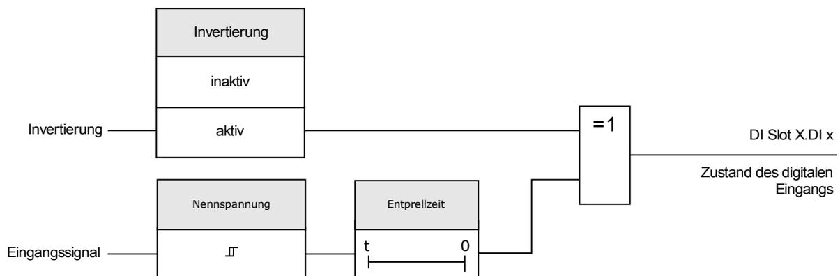
**VORSICHT** Mit jedem Zustandswechsel des Eingangssignals wird die Entprellzeit neu gestartet.
