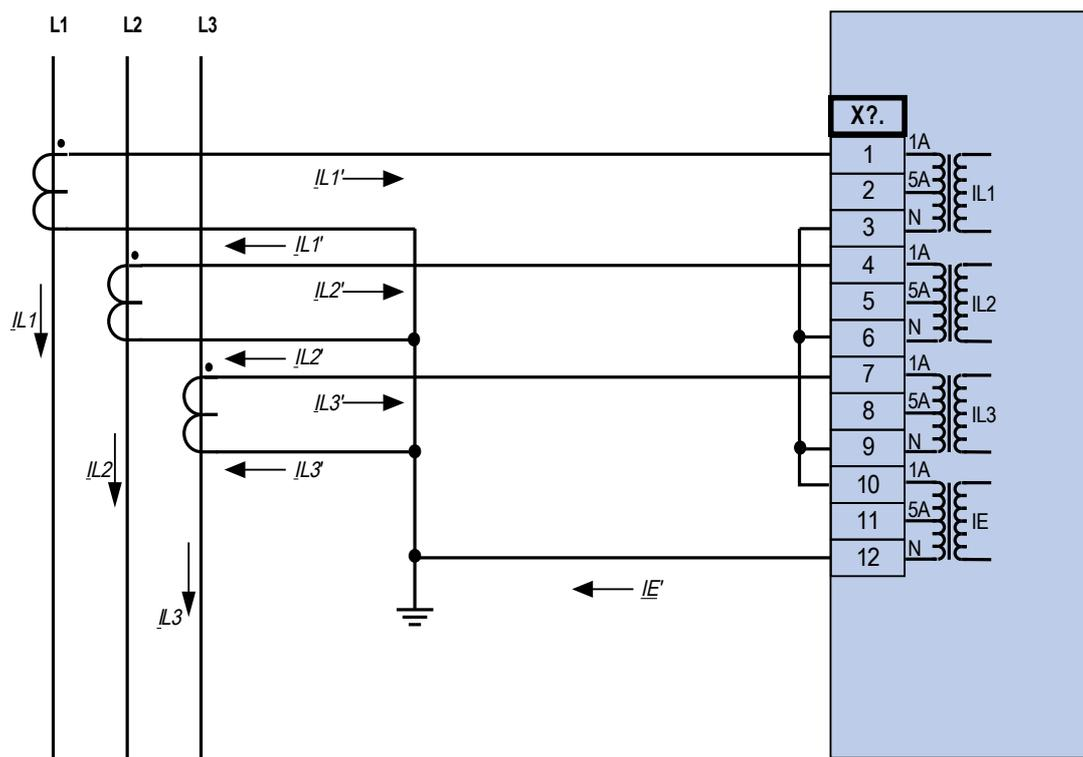
Dreiphasiger Stromwandleranschluss; In sekundär = 1 A.
