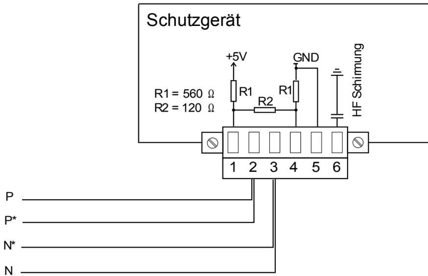
Typ 2 Verdrahtungsbeispiel, Gerät am Ende des Busses (Benutzen des integrierten Abschlusswiderstands)
