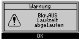
Hinweis: Sollte die neue Schaltposition eines Schaltgeräts nicht innerhalb der vorgegebenen Überwachungszeit erreicht werden, dann würde auf dem Display die folgende Meldung erscheinen.
