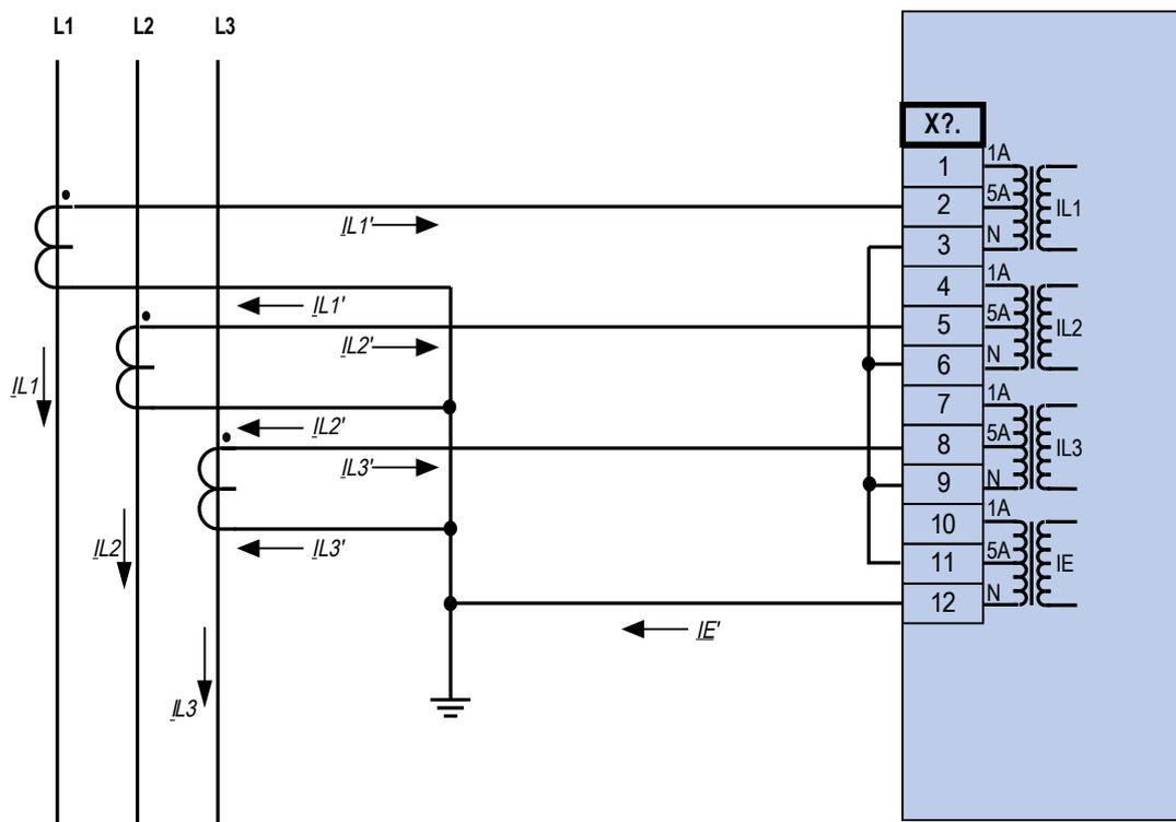
Dreiphasiger Stromwandleranschluss;  $I_n$  sekundär = 5 A.
