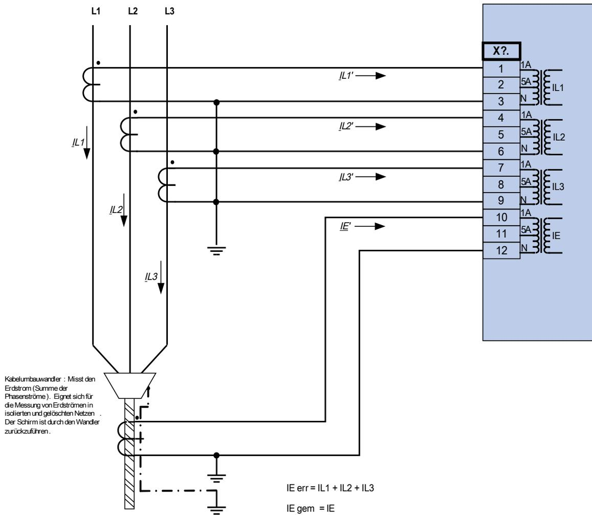
Dreiphasiger Stromwandleranschluss;  $I_n$  sekundär = 1 A.
