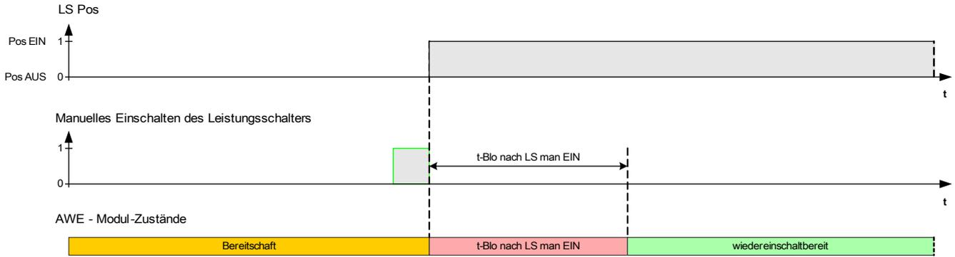
Schutzauslösung nach manuellem Einschalten des Leistungsschalters
