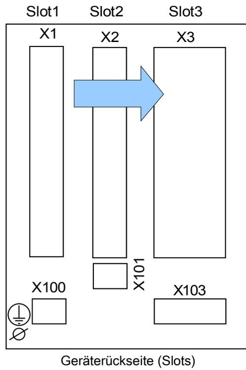
In diesem Slot befinden sich die Strommesseingänge.
