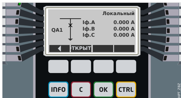
Рис. 60: Пример страницы управления, выключатель в замкнутом положении.
