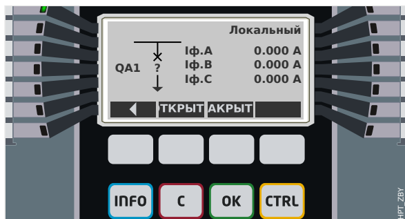
Рис. 61: Пример страницы управления, выключатель в аварийном (недопустимое состояние) положении.
