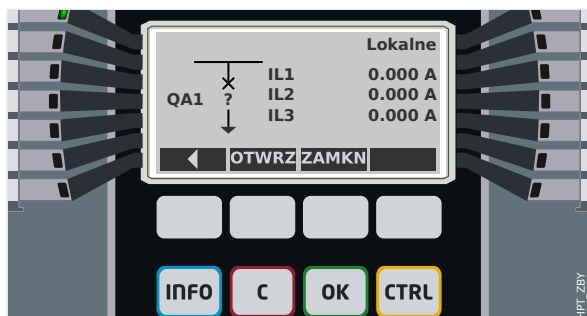
Rys. 61: Przykład strony sterowania z wyłącznikiem w pozycji zakłóconej (lub nieprawidłowej).
