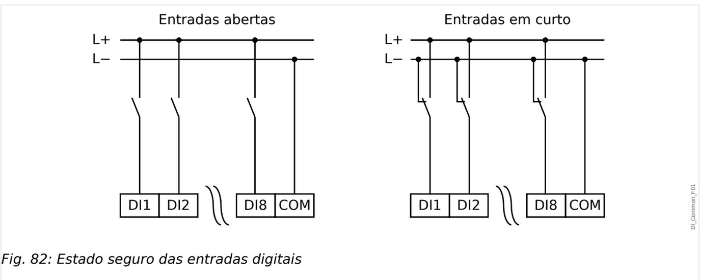
Fig. 82: Estado seguro das entradas digitais
