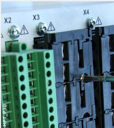
Para qualquer tipo de conexão, o primeiro passo é retirar os terminais do dispositivo, abrindo os parafusos.
