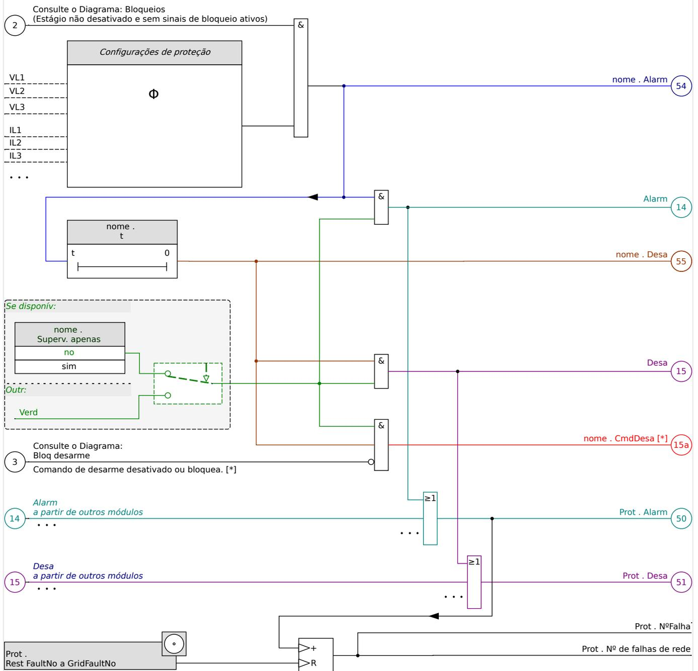
Fig. 44: Esboço rápido da funcionalidade de qualquer HighPROTEC elemento de proteção.
