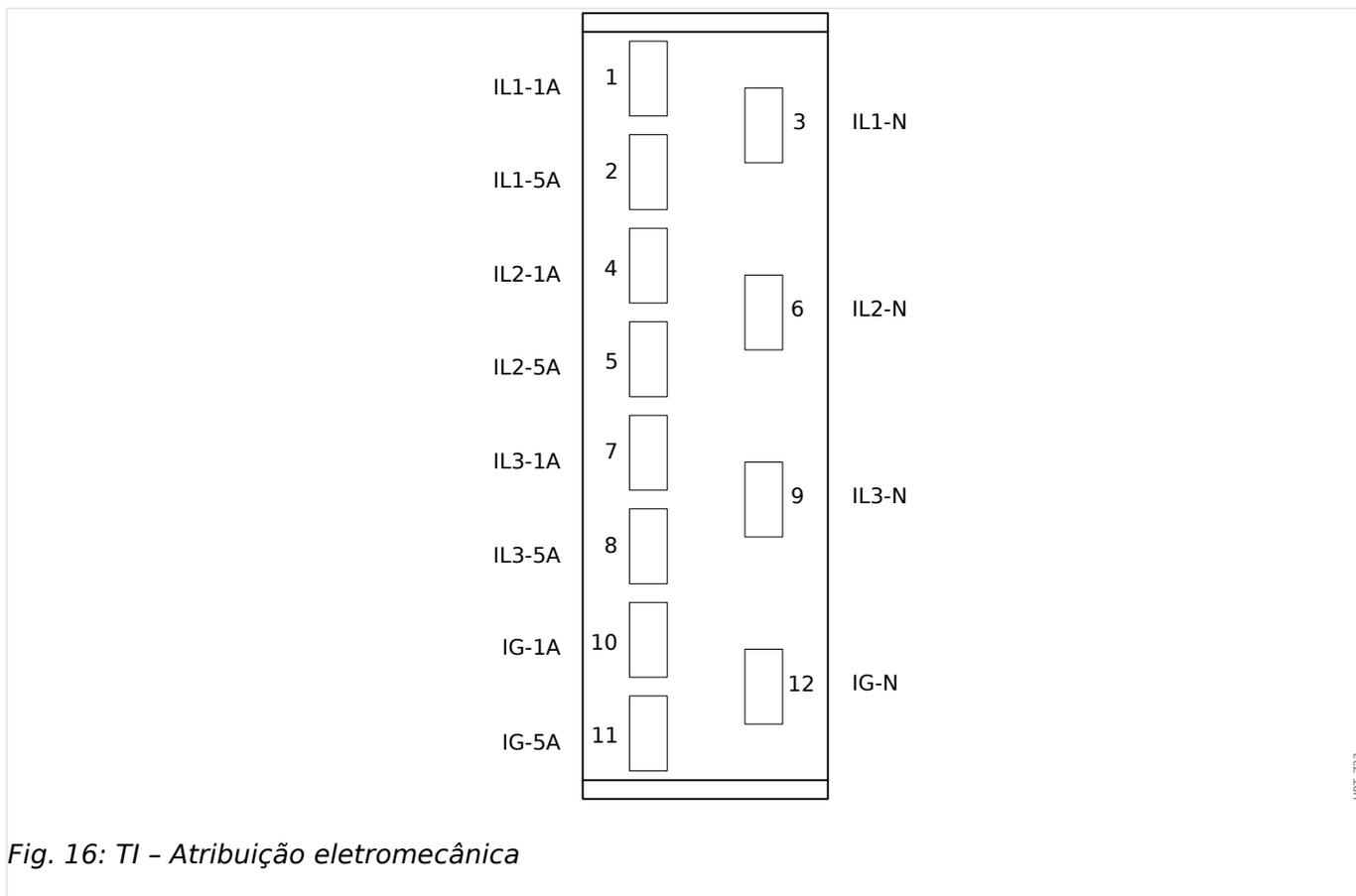
Fig. 16: TI - Atribuição eletromecânica
