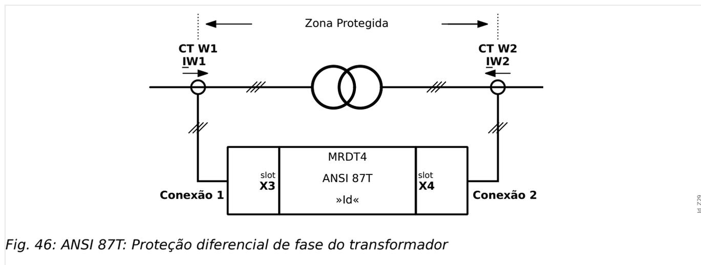
Fig. 46: ANSI 87T: Protecção diferencial de fase do transformador
