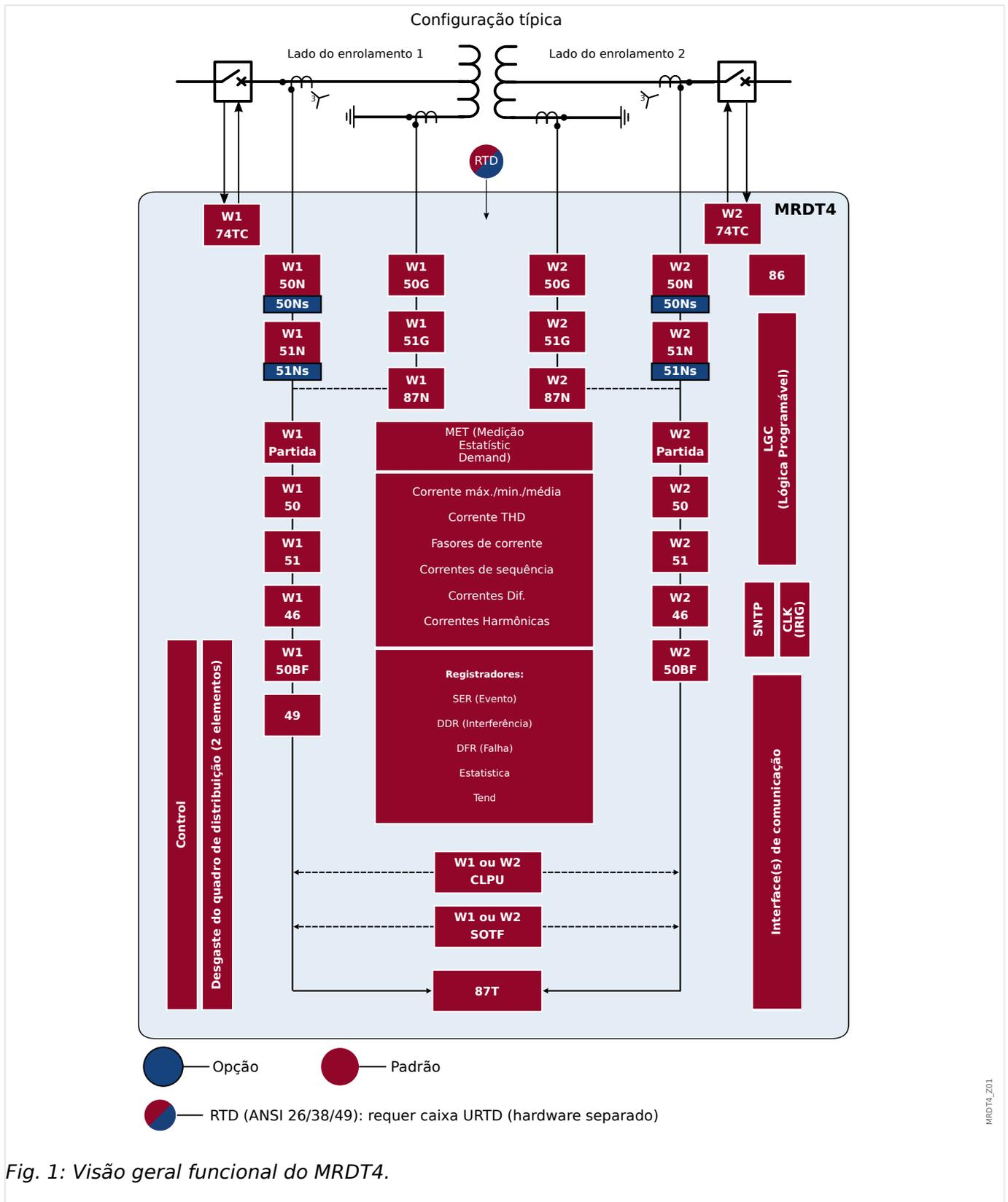
Fig. 1: Visão geral funcional do MRDT4.
