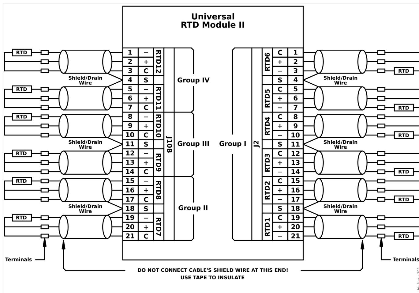
Ver as figuras acima para a fiação dos RTDs às entradas URTD. Use um cabo triplo condutor isolado. Observe as regras de conexão na figura. Ao fazer conexões com um RTD duplo, conecte dois dos condutores de cabo a uma das saídas RTD como mostrado. Faça essa conexão o mais próximo possível do objeto protegido. Conecte o terceiro condutor de cabos à saída RTD restante.
