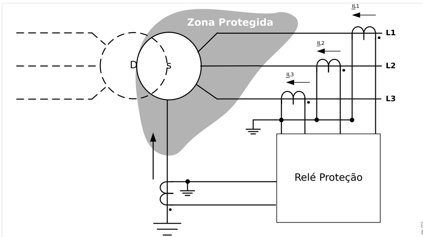
Fig. 50: Princípio de Proteção da Proteção Diferencial de Corrente de Aterramento no enrolamento lateral wye do transformador.
