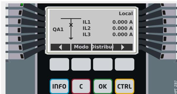
A nova posição do dispositivo comutador é mostrada na tela (assim que é alcançada de acordo com o feedback da indicação de posição, ou após o tempo de troca configurado ter passado).
