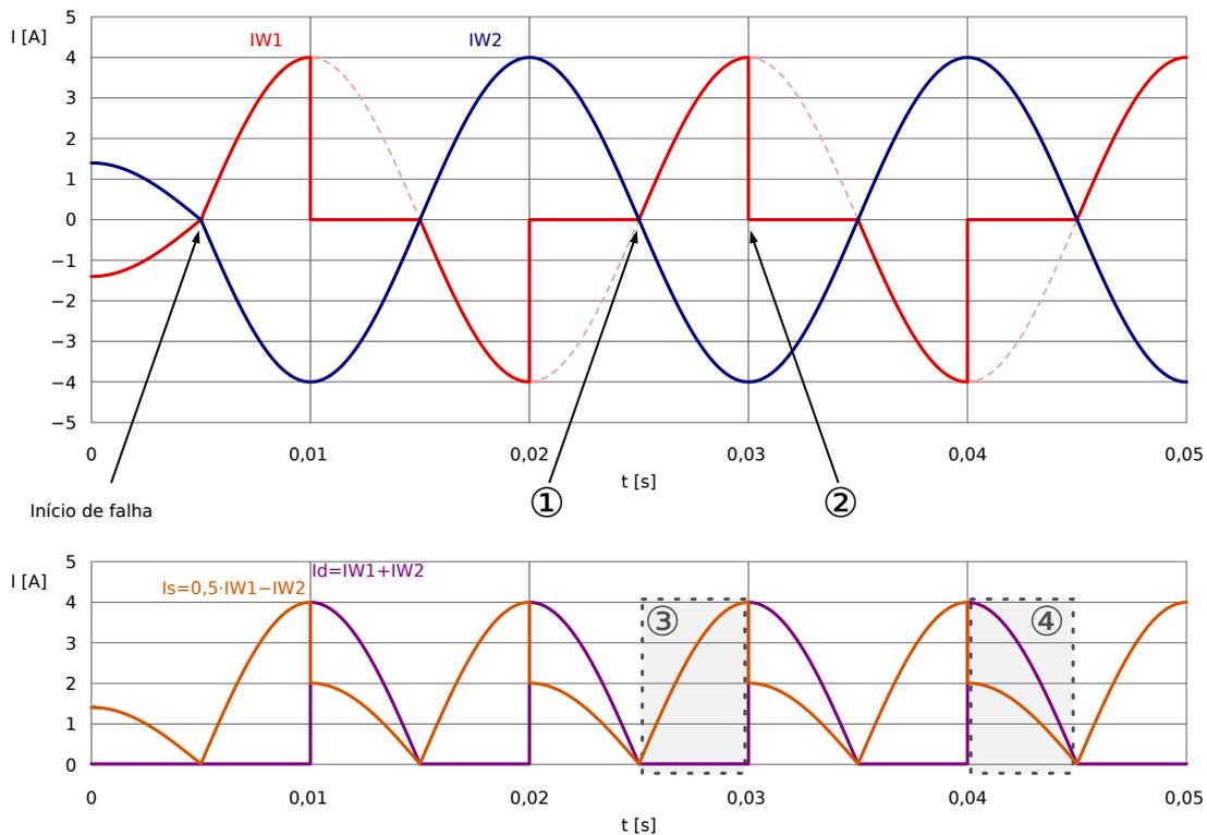
Fig. 48: Característica de  $I_d$  e  $I_s$  com a saturação no lado  $W1$  para uma falha externa.
