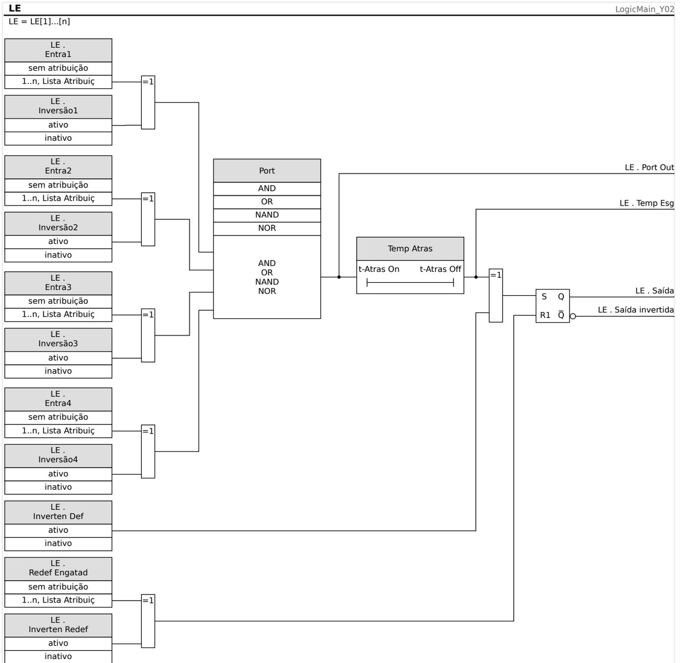
Fig. 73: Visão Geral Detalhada - Diagrama Lógico Geral.
