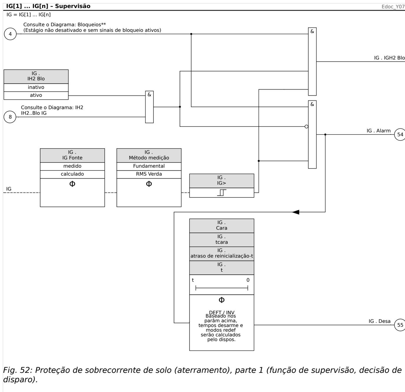
Fig. 52: Proteção de sobrecorrente de solo (aterramento), parte 1 (função de supervisão, decisão de disparo).
