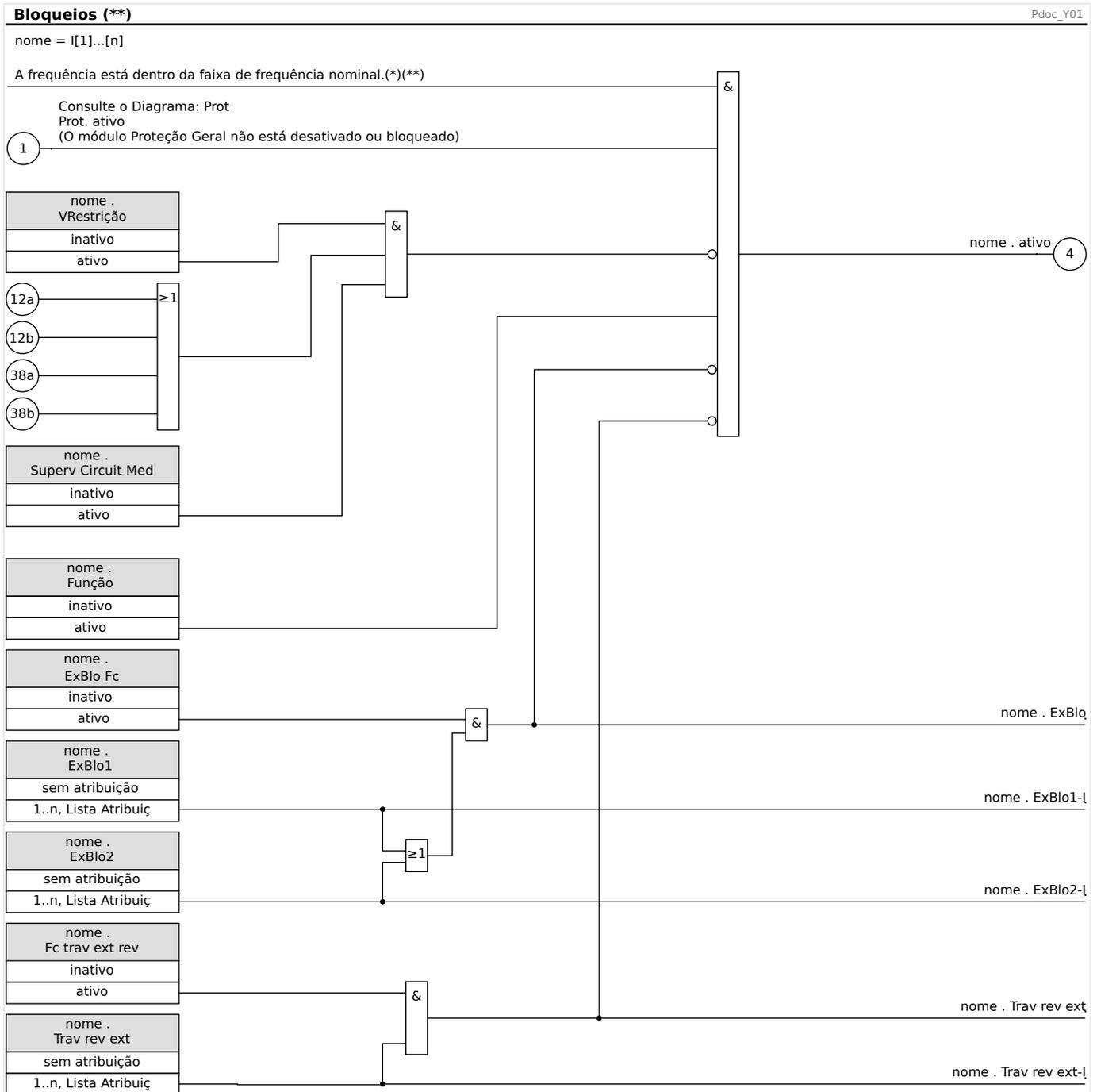
(\*) Todos os elementos de proteção que estiverem usando os valores medidos fundamentais ou de harmônicas serão bloqueados, caso a frequência saia da faixa de frequência nominal. Os elementos de proteção que estiverem usando os valores RMS permaneceram ativos. Consulte o capítulo Faixa ampla de frequência.
