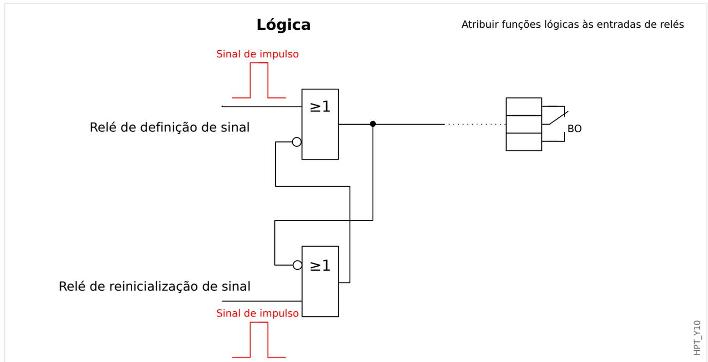
Os sinais de saída binária de DNP não podem ser usados diretamente para trocar relés, pois as saídas digitais de DNP são sinais de impulso (por definição DNP, estado não constante). Estados constantes podem ser criados por meio de funções lógicas. As funções lógicas podem ser atribuídas às entradas do relé.
