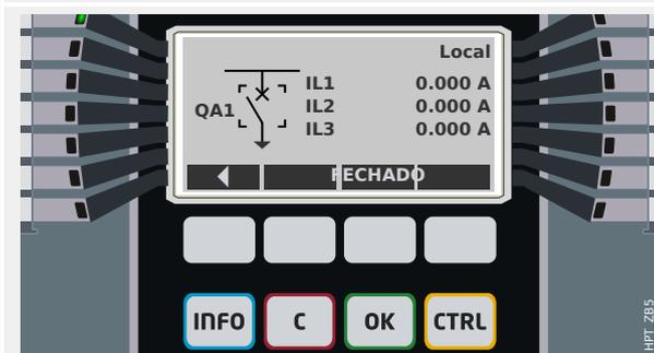
A tecla de função “►” (Enter) leva você a uma linha única aprimorada (depois de digitar a senha do nível de acesso “Control-Lv1”). O dispositivo de comutação é realçado por pequenos marcadores (e, no caso de vários dispositivos de comutação implementados, a tecla de função “Selecionar” fica visível, o que permite que você selecione outro).
