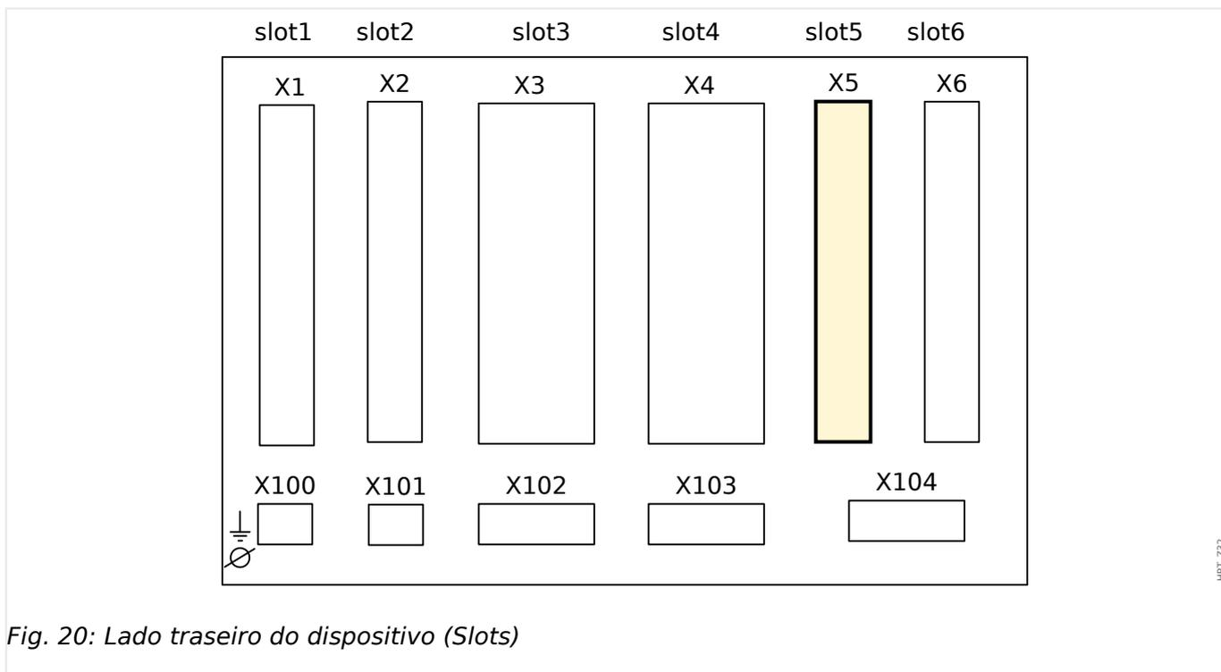
Fig. 20: Lado traseiro do dispositivo (Slots)
