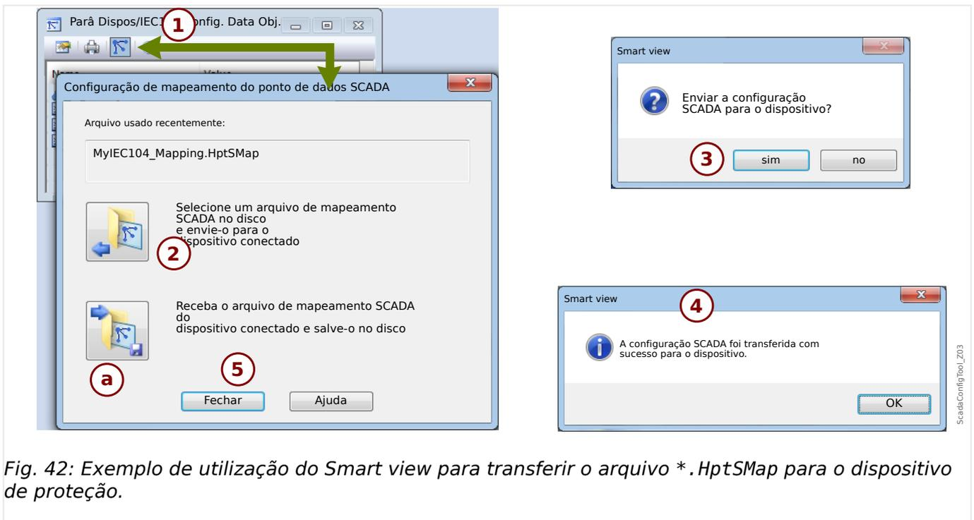
Fig. 42: Exemplo de utilização do Smart view para transferir o arquivo \*.HptSMap para o dispositivo de proteção.
