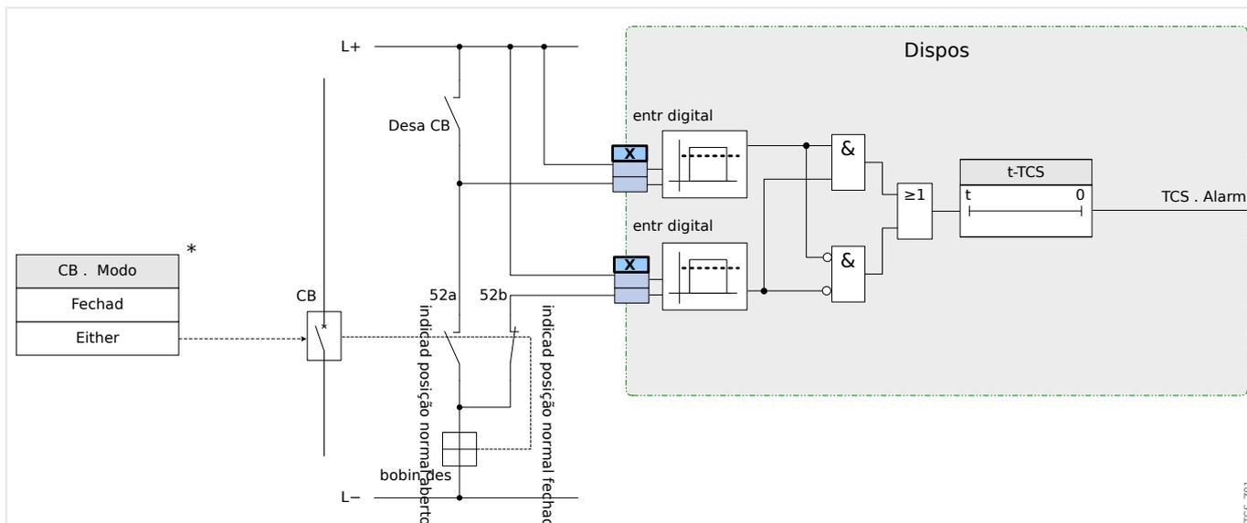
Fig. 58: Exemplo de conexão: Supervisão do circuito de disparo com dois contatos CB auxiliares »Aux ON« (52a) e »Aux OFF« (52b).
