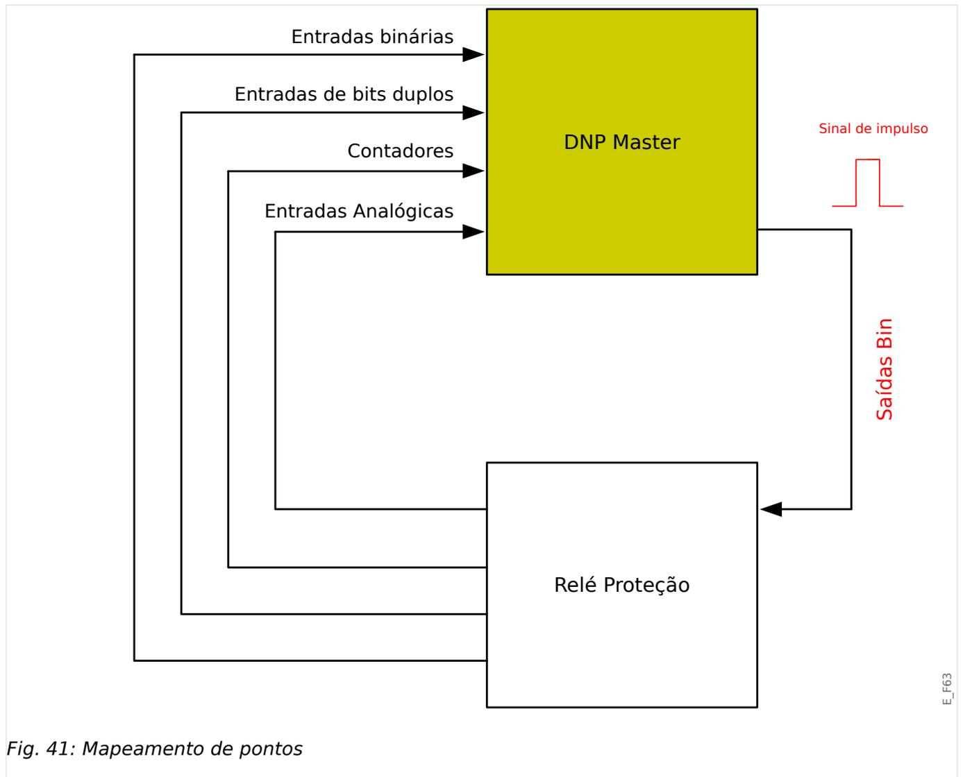
Fig. 41: Mapeamento de pontos
