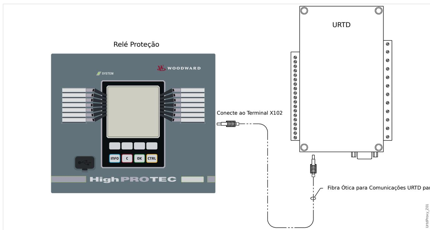
A figura acima mostra as conexões de fibra ótica entre o Módulo URTDII e o dispositivo de proteção. O dispositivo de proteção suporta a conexão de fibra ótica.
