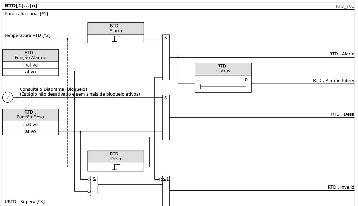
Fig. 57: O princípio geral de funcionamento (alarme atrasado, disparo sem atraso).
