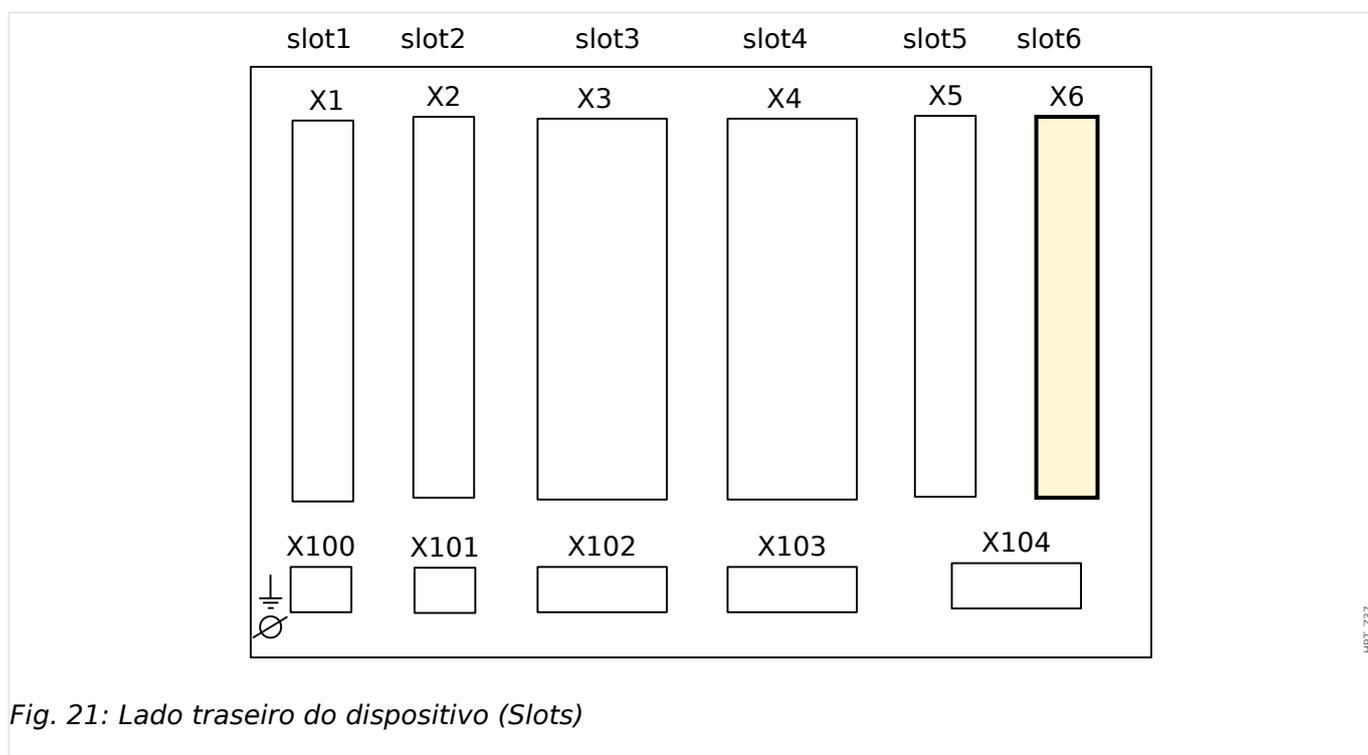
Fig. 21: Lado traseiro do dispositivo (Slots)
