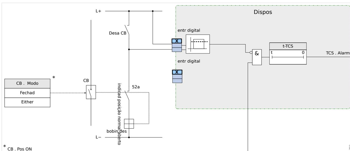
Fig. 59: Exemplo de conexão: Supervisão do circuito de disparo com apenas um contato CB auxiliar »Aux ON« (52a).
