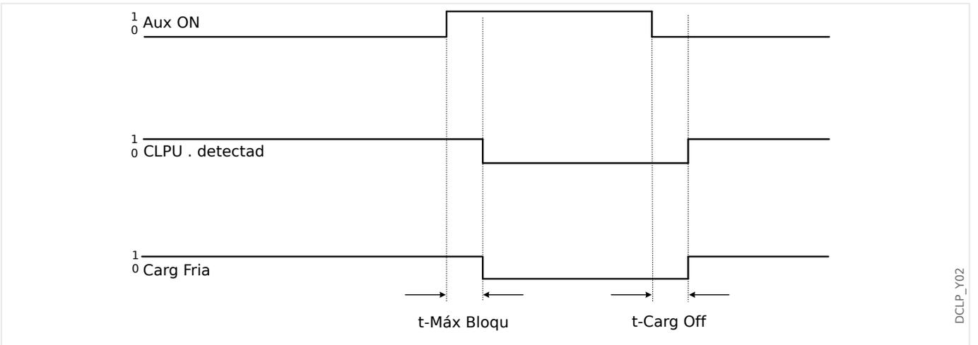
Fig. 55: Exemplo: Posição do disjuntor
