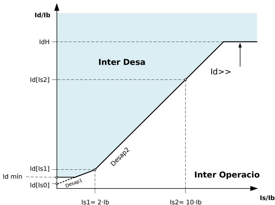
Fig. 49: Etapa da Proteção Diferencial Irrestrita de Alta Definição IdH.
