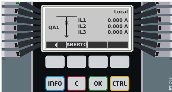
Fig. 61: Exemplo de página de controle, com o "Disjuntor" na posição fechada.
