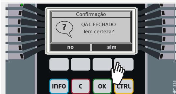
Depois de pressionar a tecla de função “FECHADO”, você terá uma caixa de diálogo de confirmação, que impede operações de comutação não intencionais.
