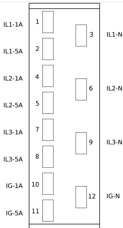
Fig. 18: TIs - Atribuição eletromecânica
