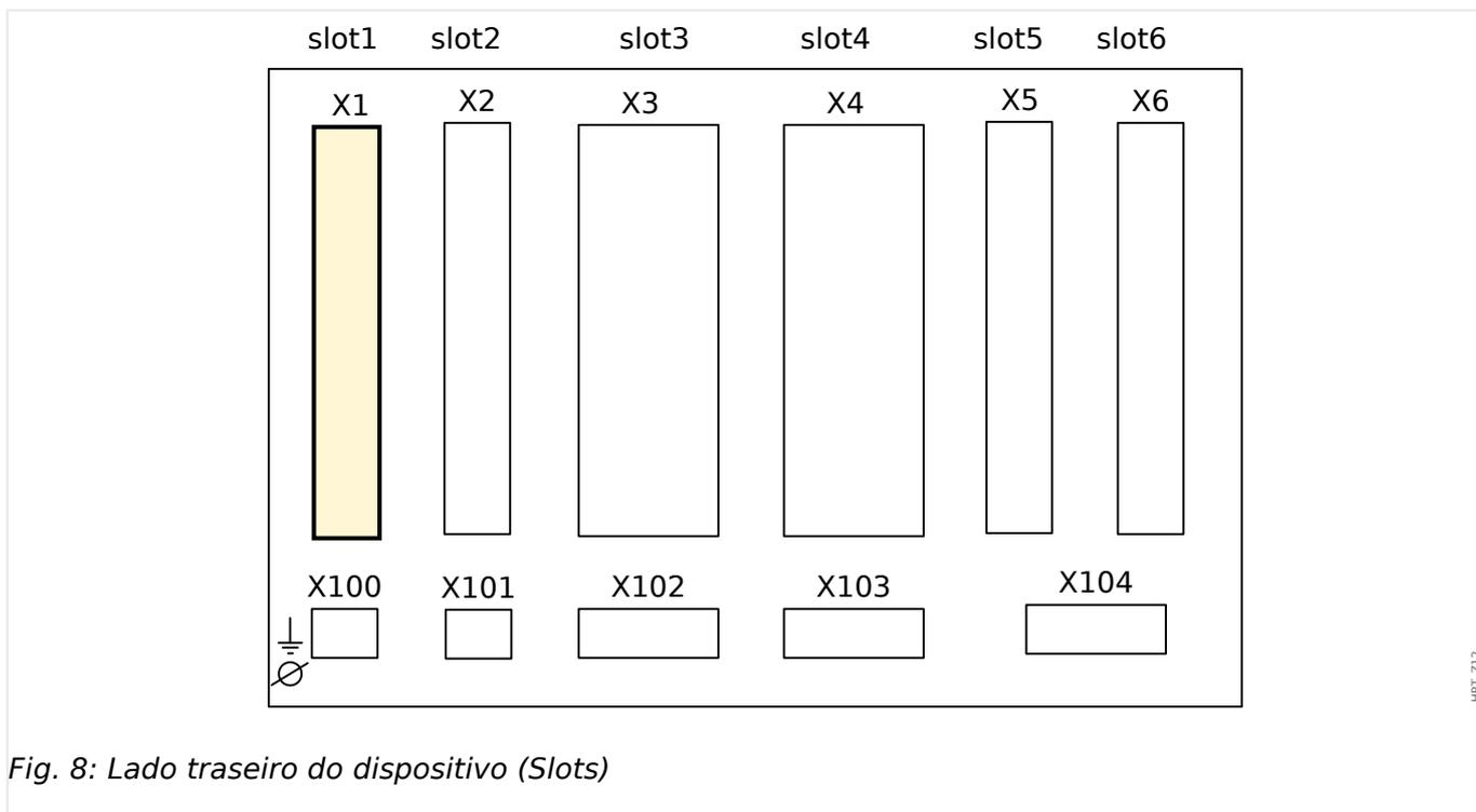
Fig. 8: Lado traseiro do dispositivo (Slots)
