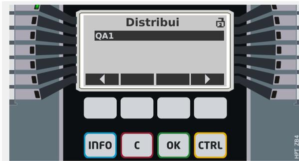
A tecla de função “Distribui” leva você a uma tela que lista todos os dispositivos de comutação conectados.
