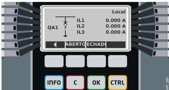
Fig. 62: Exemplo de página de controle, com o "Disjuntor" na posição de falha (ou implausível).
