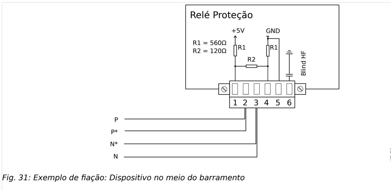
Fig. 31: Exemplo de fiação: Dispositivo no meio do barramento
