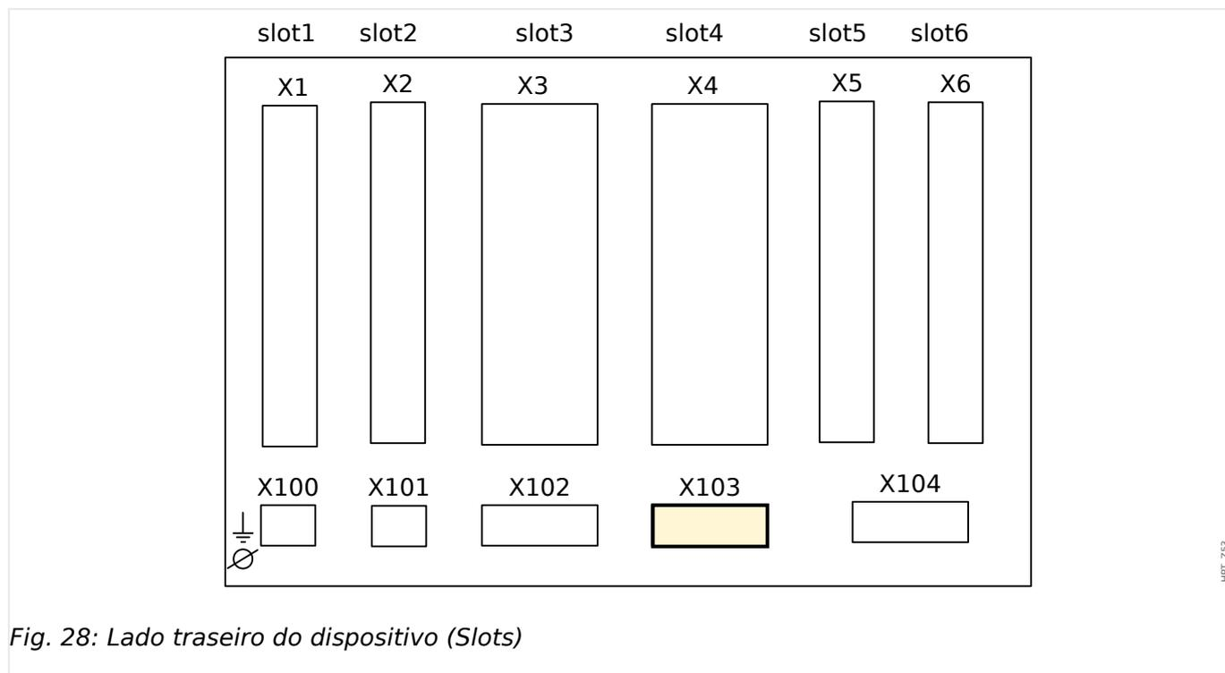
Fig. 28: Lado traseiro do dispositivo (Slots)
