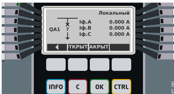
Рис. 72: Пример страницы управления, выключатель в аварийном (недопустимое состояние) положении.
