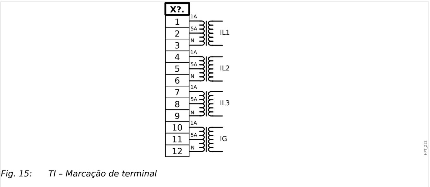
Fig. 15: TI - Marcação de terminal
