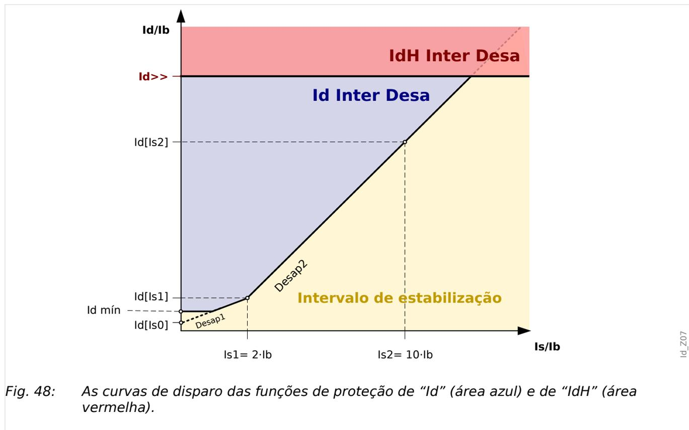
Fig. 48: As curvas de disparo das funções de proteção de “Id” (área azul) e de “IdH” (área vermelha).
