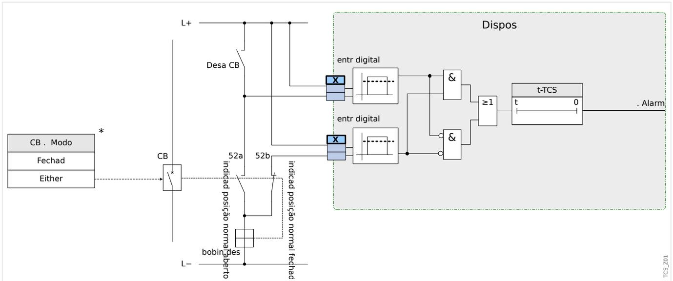
Fig. 68: Exemplo de conexão: Supervisão do circuito de disparo com dois contatos CB auxiliares »Aux ON« (52a) e »Aux OFF« (52b).
