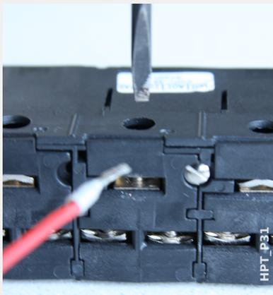
Para o tipo de conexão de terminais com pinos, insira os cabos e prenda-os pelos parafusos localizados na lateral da placa de entrada.
