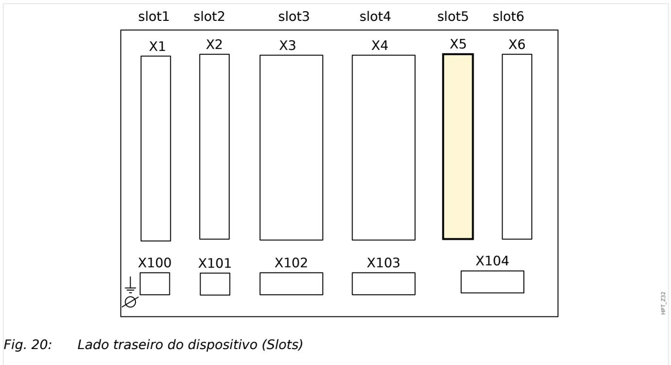
Fig. 20: Lado traseiro do dispositivo (Slots)
