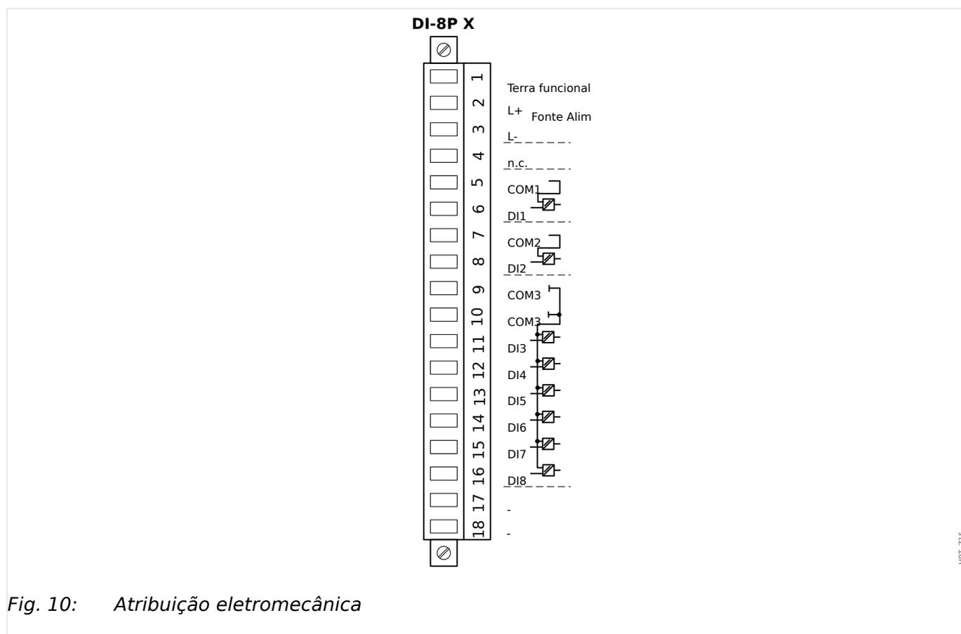
Fig. 10: Atribuição eletromecânica
