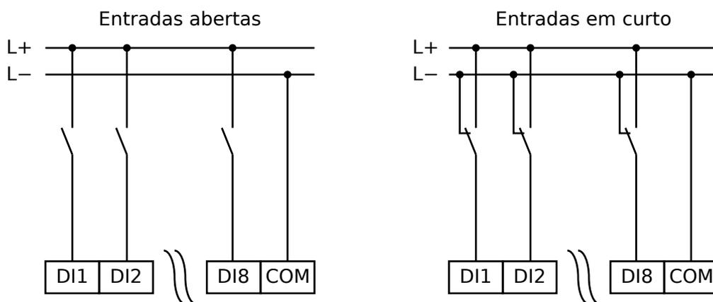
Fig. 90: Estado seguro das entradas digitais
