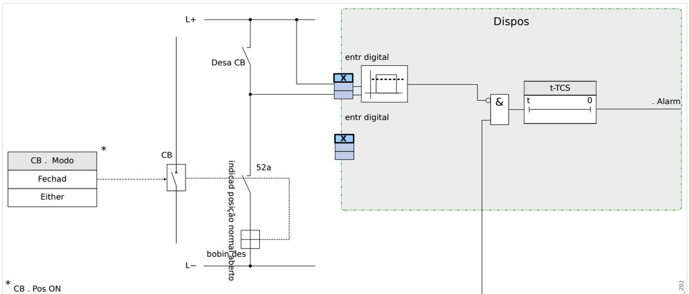
Fig. 69: Exemplo de conexão: Supervisão do circuito de disparo com apenas um contato CB auxiliar »Aux ON« (52a).
