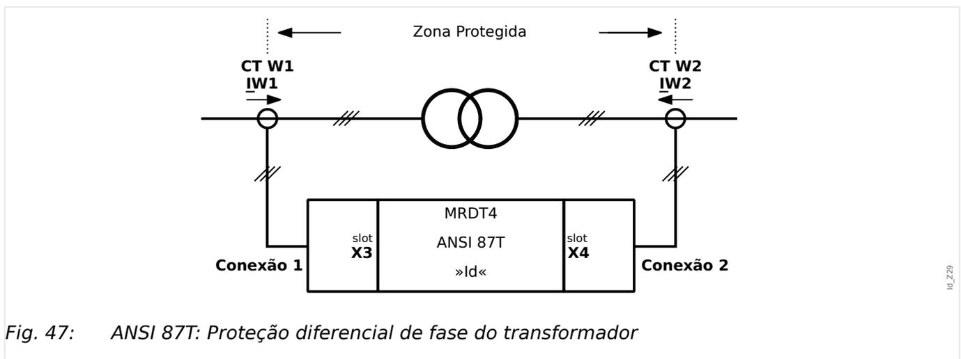
Fig. 47: ANSI 87T: Proteção diferencial de fase do transformador
