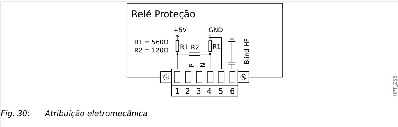
Fig. 30: Atribuição eletromecânica
