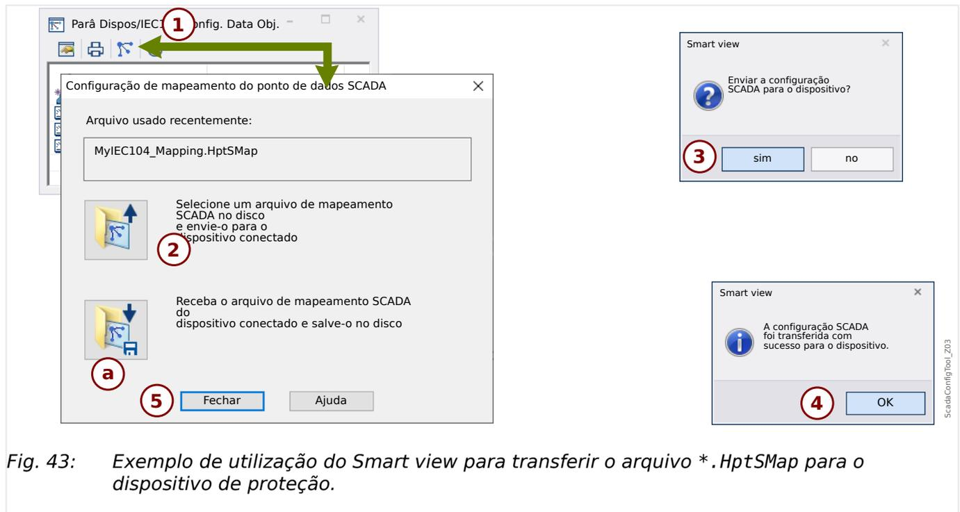
Fig. 43: Exemplo de utilização do Smart view para transferir o arquivo \*.HptSMap para o dispositivo de proteção.
