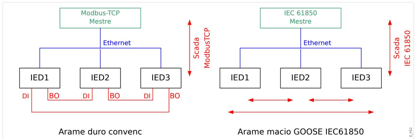
Etapas de comissionamento para uma subestação convencional com o ambiente TCP de Modbus:
