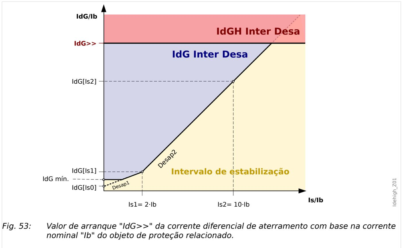
Fig. 53: Valor de arranque "IdG>>" da corrente diferencial de aterramento com base na corrente nominal "lb" do objeto de proteção relacionado.
