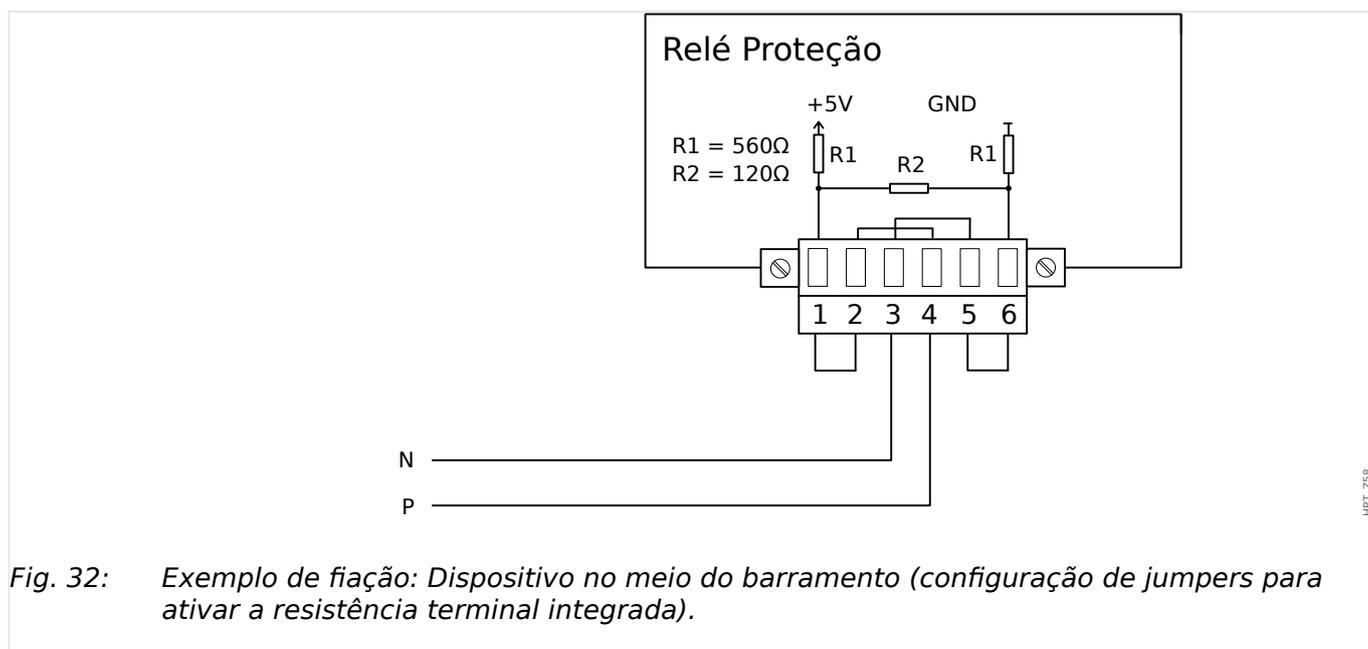
Fig. 32: Exemplo de fiação: Dispositivo no meio do barramento (configuração de jumpers para ativar a resistência terminal integrada).
