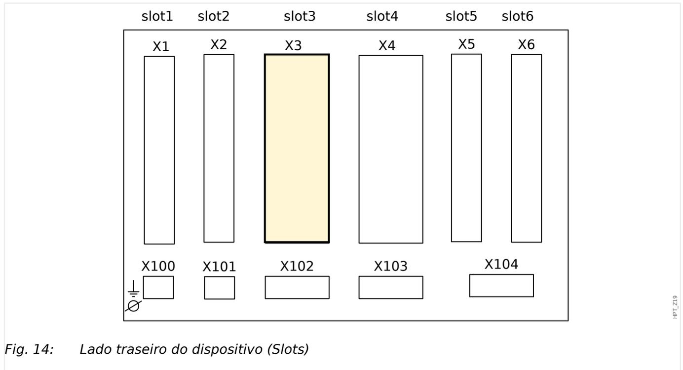
Fig. 14: Lado traseiro do dispositivo (Slots)
