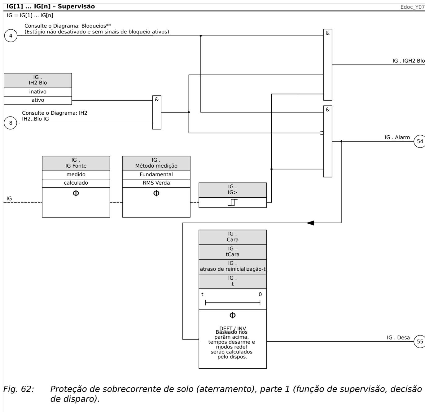
Fig. 62: Proteção de sobrecorrente de solo (aterramento), parte 1 (função de supervisão, decisão de disparo).
