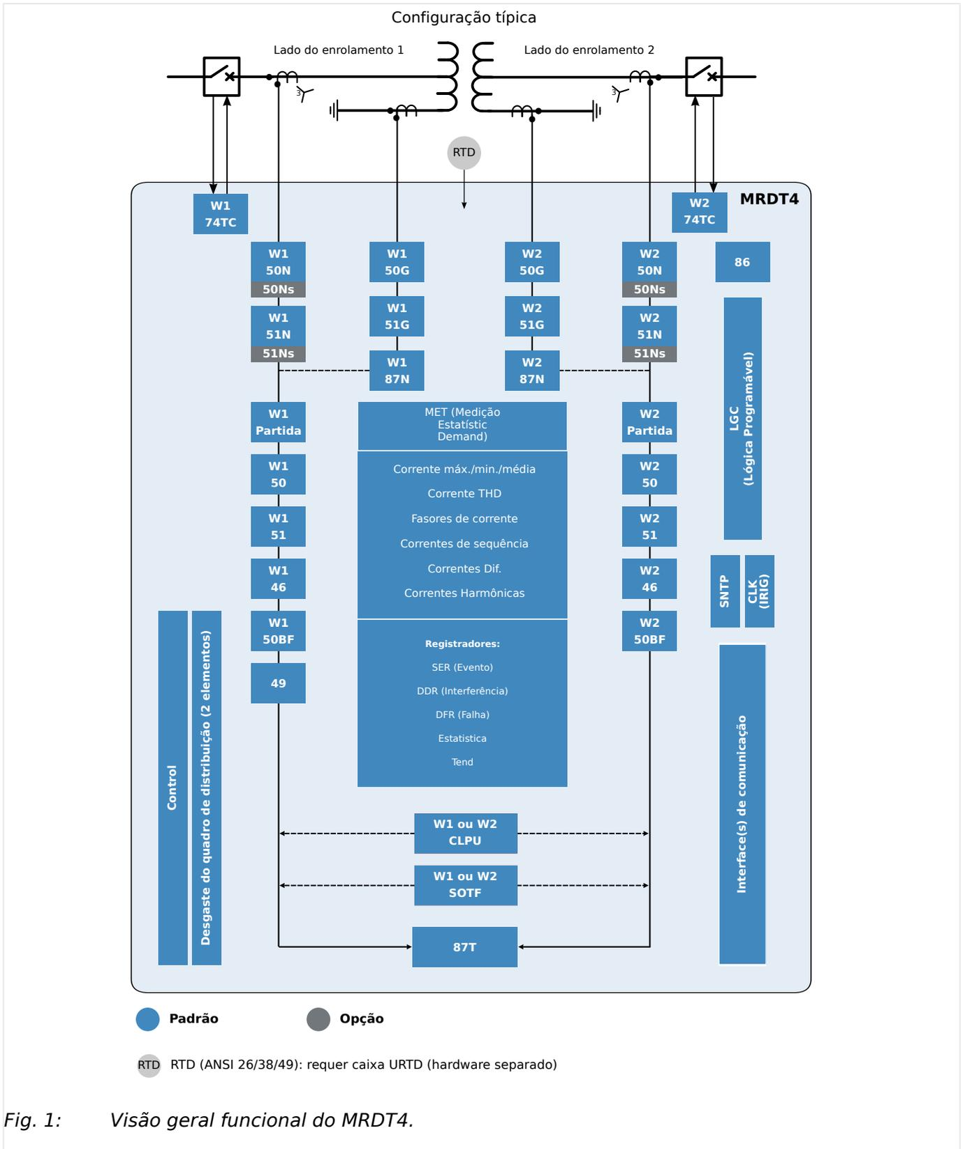
Fig. 1: Visão geral funcional do MRDT4.
