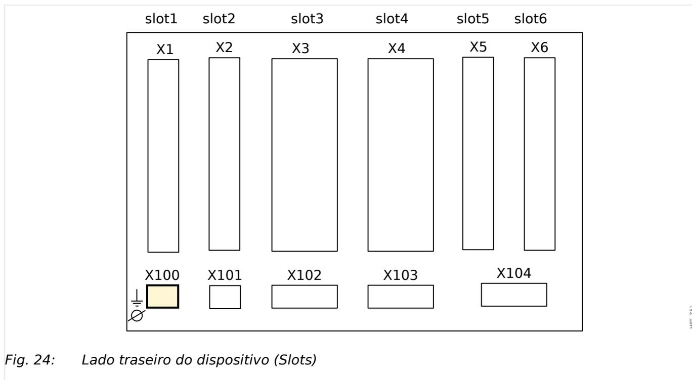
Fig. 24: Lado traseiro do dispositivo (Slots)
