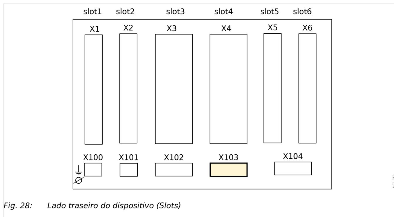
Fig. 28: Lado traseiro do dispositivo (Slots)
