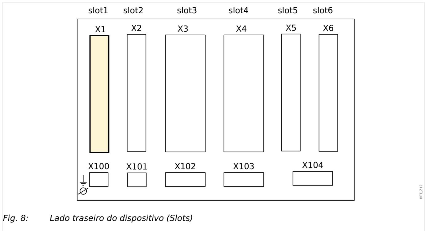
Fig. 8: Lado traseiro do dispositivo (Slots)
