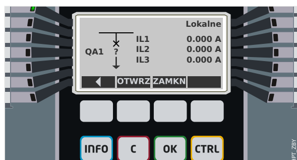
Rys. 72: Przykład strony sterowania z wyłącznikiem w pozycji zakłóconej (lub nieprawidłowej).
