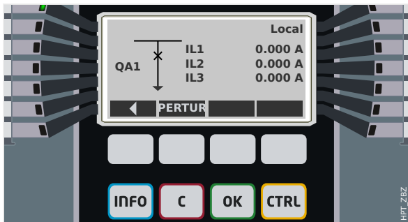
Fig. 71: Ejemplo de página de control, con el circuito en posición cerrada.
