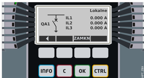
Rys. 65: Przykład strony sterowania z wyłącznikiem w pozycji otwartej.
