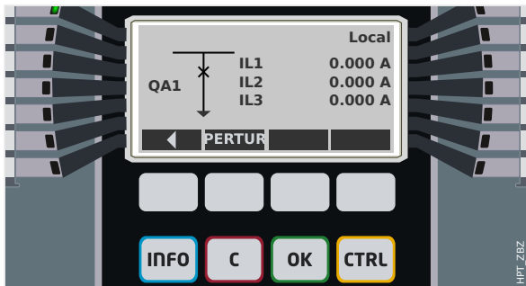
Fig. 61: Ejemplo de página de control, con el circuito en posición cerrada.
