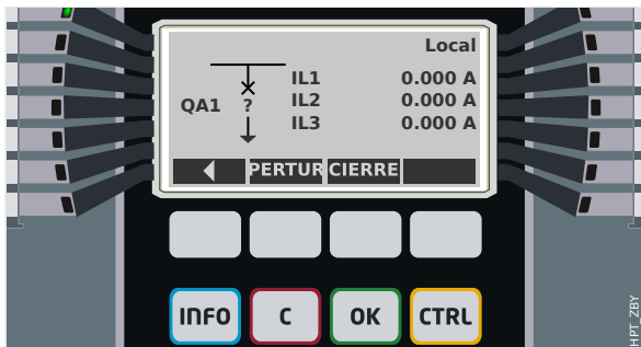
Fig. 62: Ejemplo de página de control, con el circuito en posición de fallo (o improbable).
