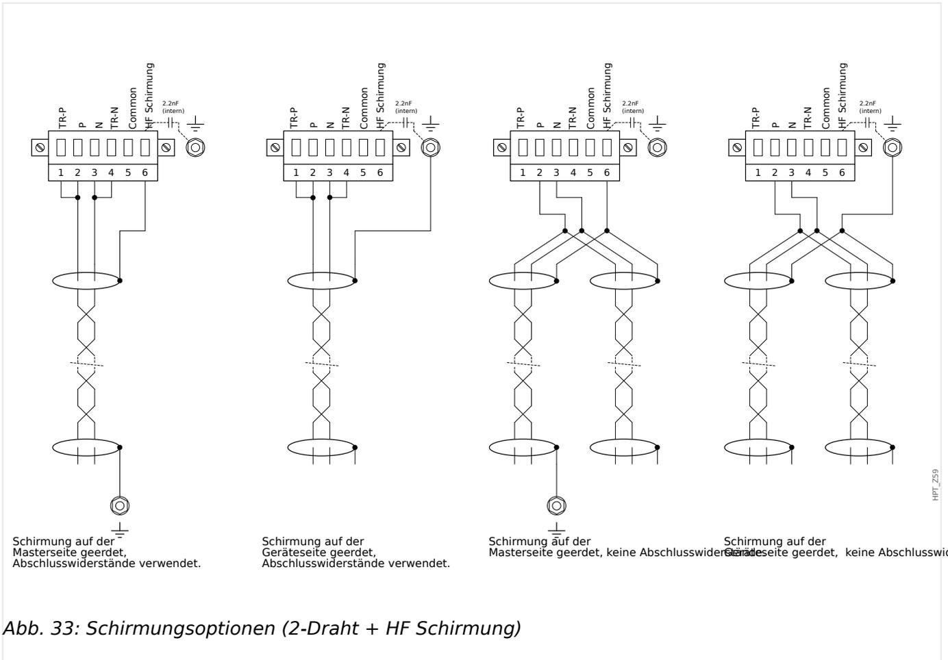
Abb. 33: Schirmungsoptionen (2-Draht + HF Schirmung)
