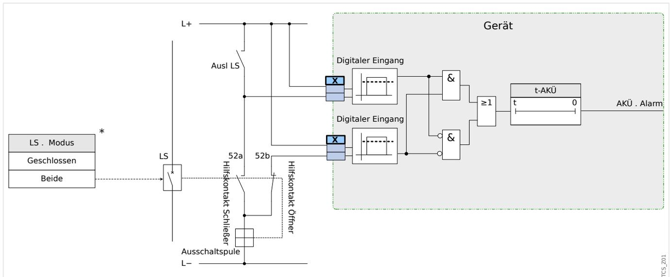
Abb. 58: Anschlussbeispiel (Empfehlung): Auslösekreisüberwachung mit zwei Hilfskontakten »Hiko EIN« (52a) und »Hiko AUS« (52b).
