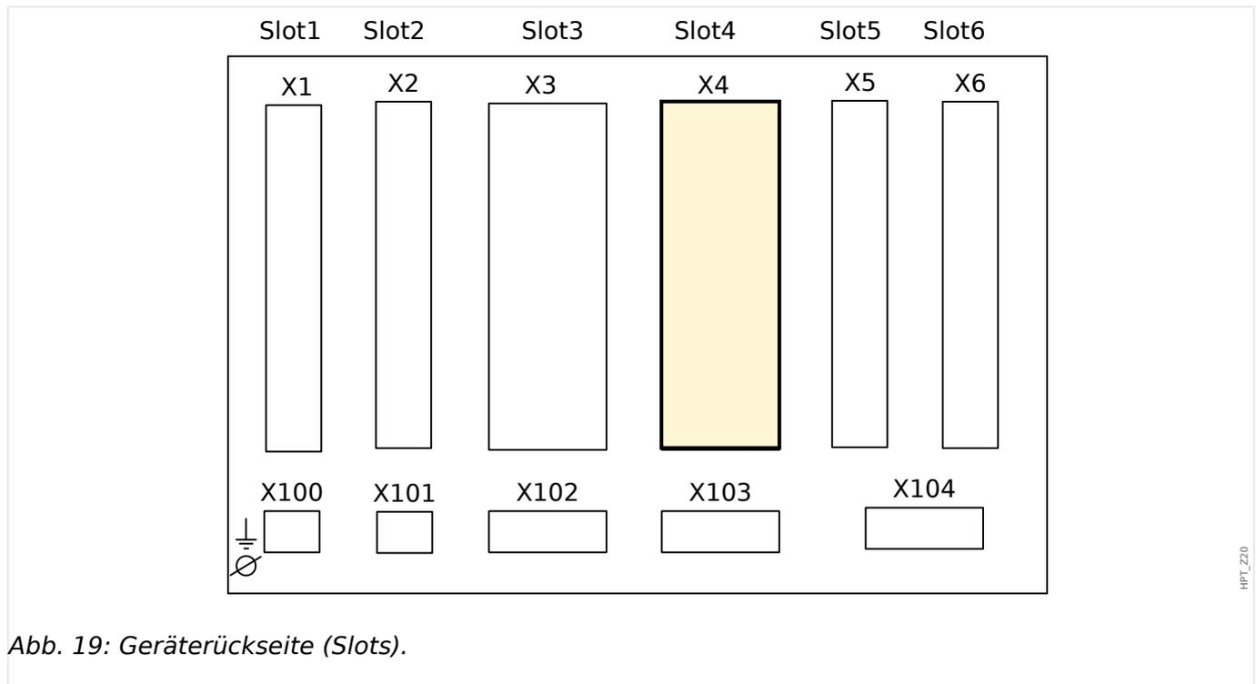
In diesem Slot befinden sich die Strommesseingänge für die W2-Seite. In Abhängigkeit der bestellten Gerätevariante ist dies eine Standardstrommesskarte oder eine Messkarte für empfindlichen Erdstrom.
