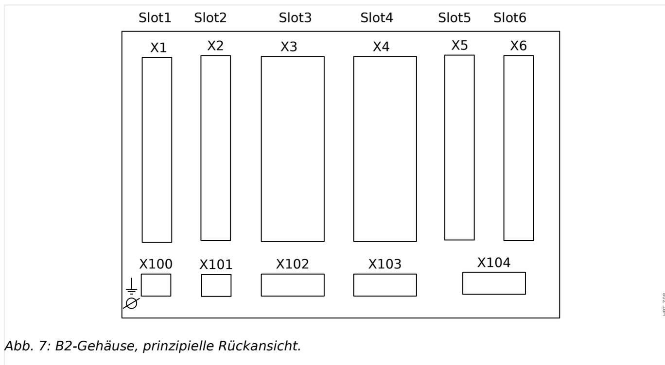
Abb. 7: B2-Gehäuse, prinzipielle Rückansicht.
