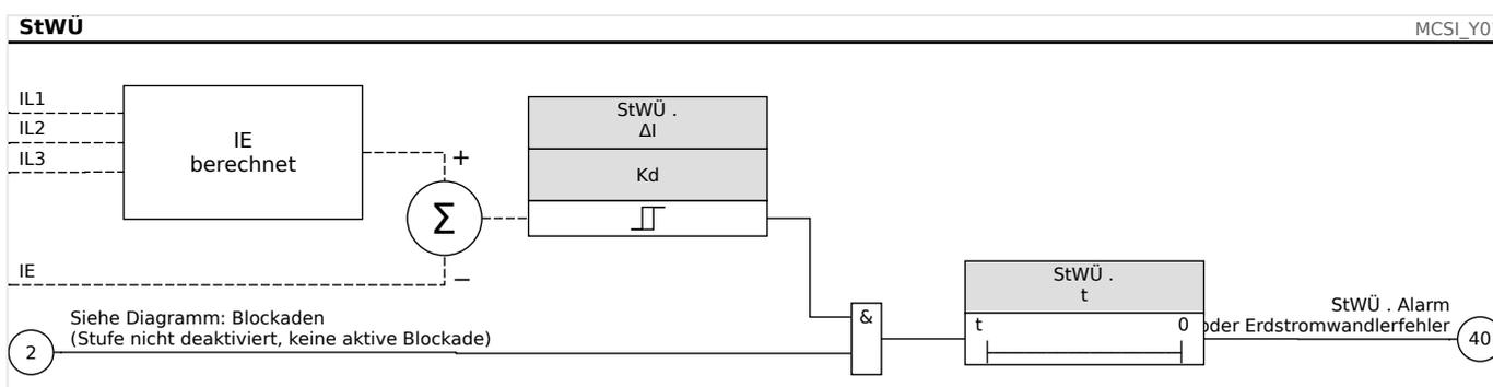
**4.19.3.1 Inbetriebnahme: Stromwandlerfehlerüberwachung**
