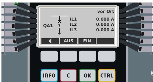
Abb. 62: Beispiel einer Steuer-Seite mit „Leistungsschalter“ in Störstellung (bzw. unplausiblem Zustand).
