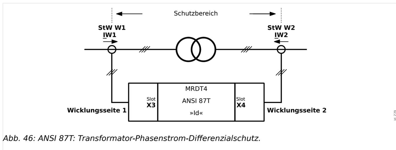
Abb. 46: ANSI 87T: Transformator-Phasenstrom-Differenzialschutz.
