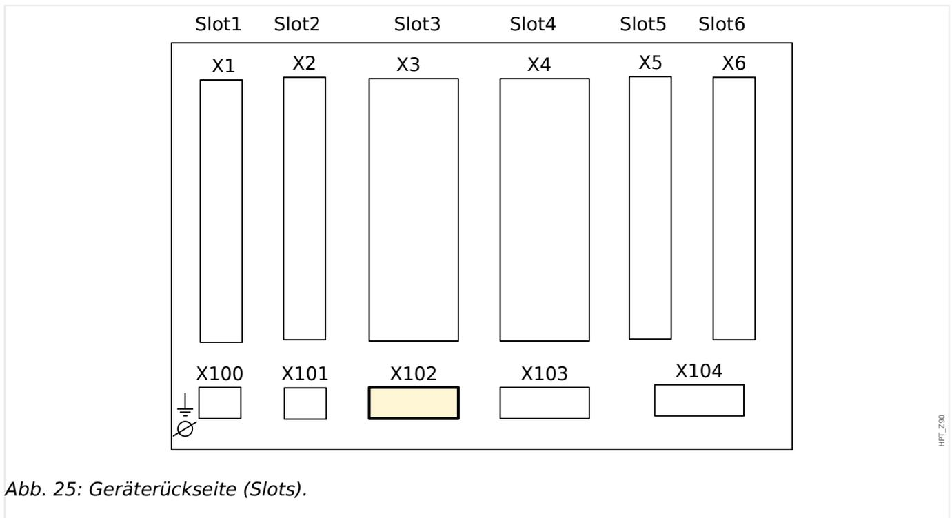
In Slot **X102** ist die Schnittstelle für die Schutzkommunikation verbaut.
