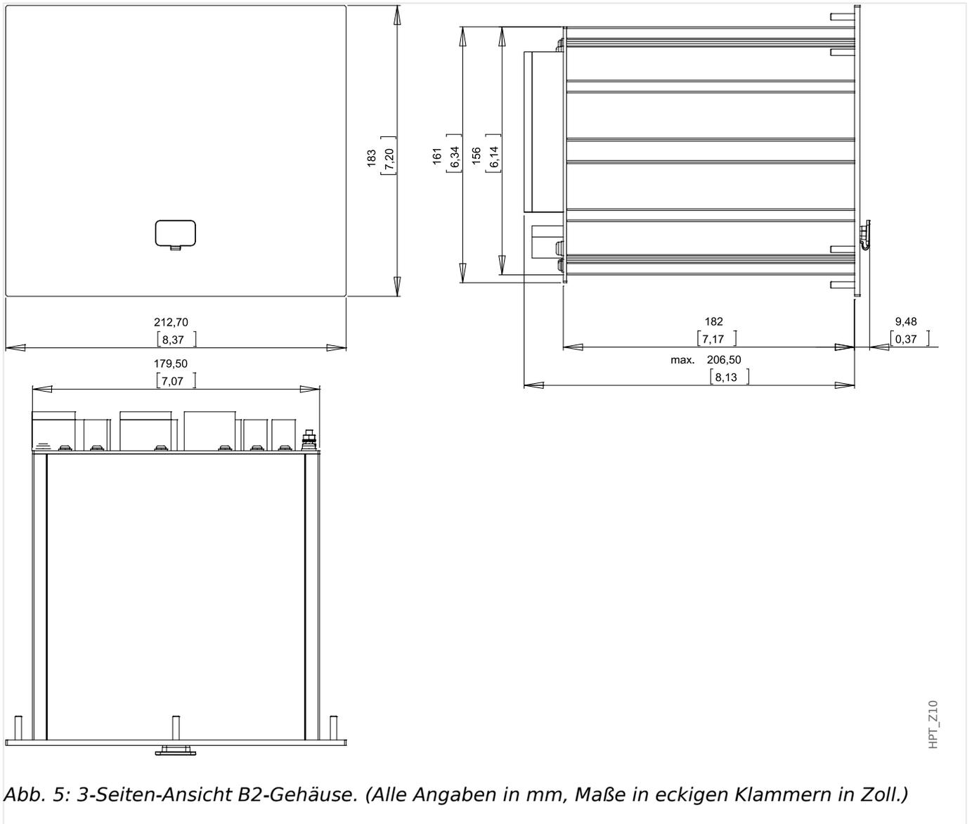
Abb. 5: 3-Seiten-Ansicht B2-Gehäuse. (Alle Angaben in mm, Maße in eckigen Klammern in Zoll.)
