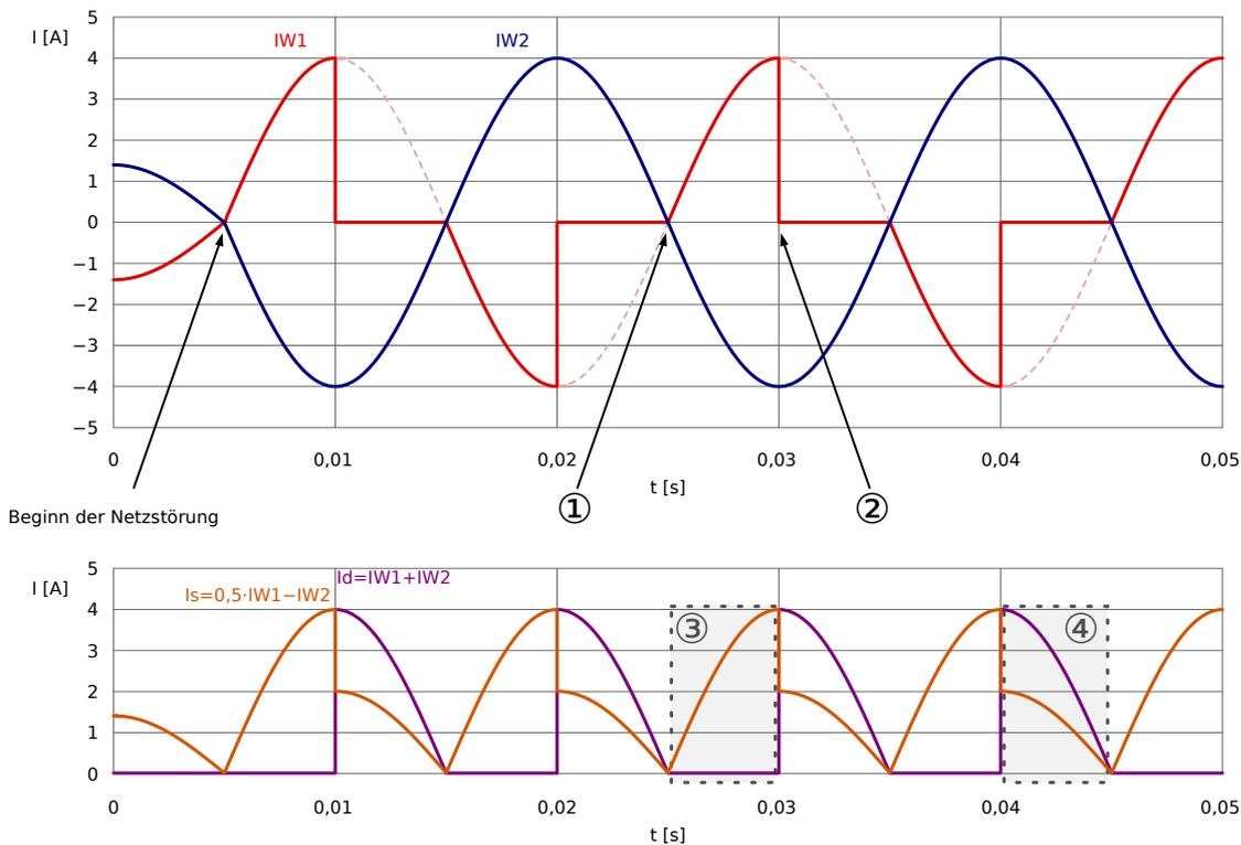
Abb. 48: Charakteristik von  $I_d$  und  $I_s$  mit Wandlersättigung auf der  $W1$ -Seite für einen externen Fehler.
