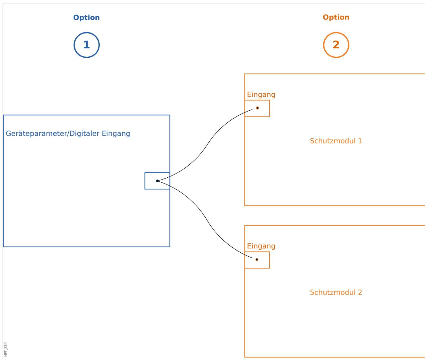
**Option 1** - Einen Digitalen Eingang (einem/mehreren) Modulen zuweisen.
