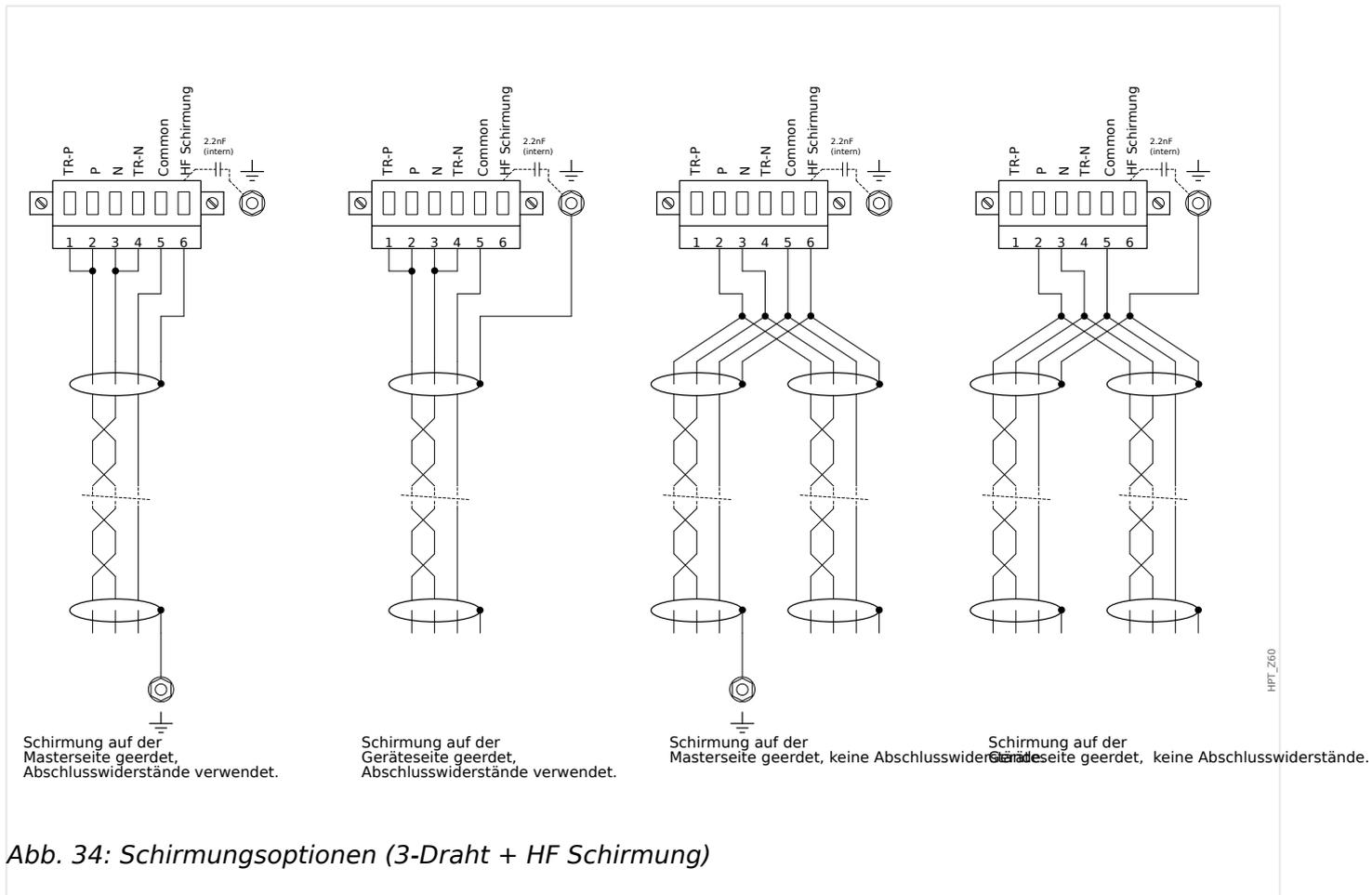
Abb. 34: Schirmungsoptionen (3-Draht + HF Schirmung)
