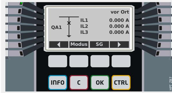
Die neue Stellung des Betriebsmittels wird (nach Ablauf der jeweiligen Schaltzeit bzw. nach entsprechender Rückmeldung durch die Stellungsmeldekontakte) auf dem Display angezeigt.
