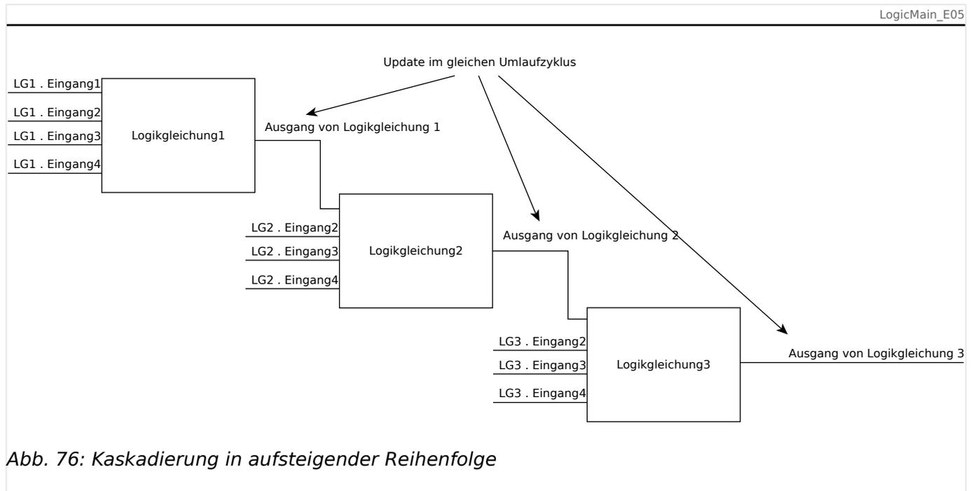
Abb. 76: Kaskadierung in aufsteigender Reihenfolge
