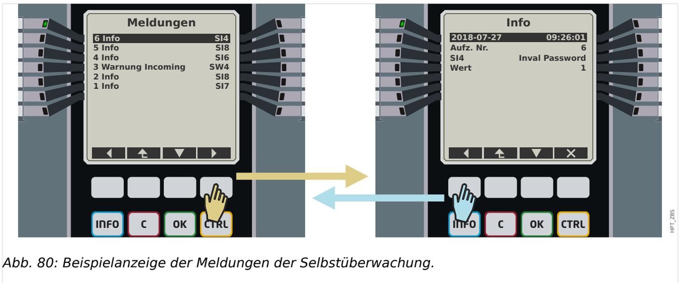
Abb. 80: Beispielanzeige der Meldungen der Selbstüberwachung.
