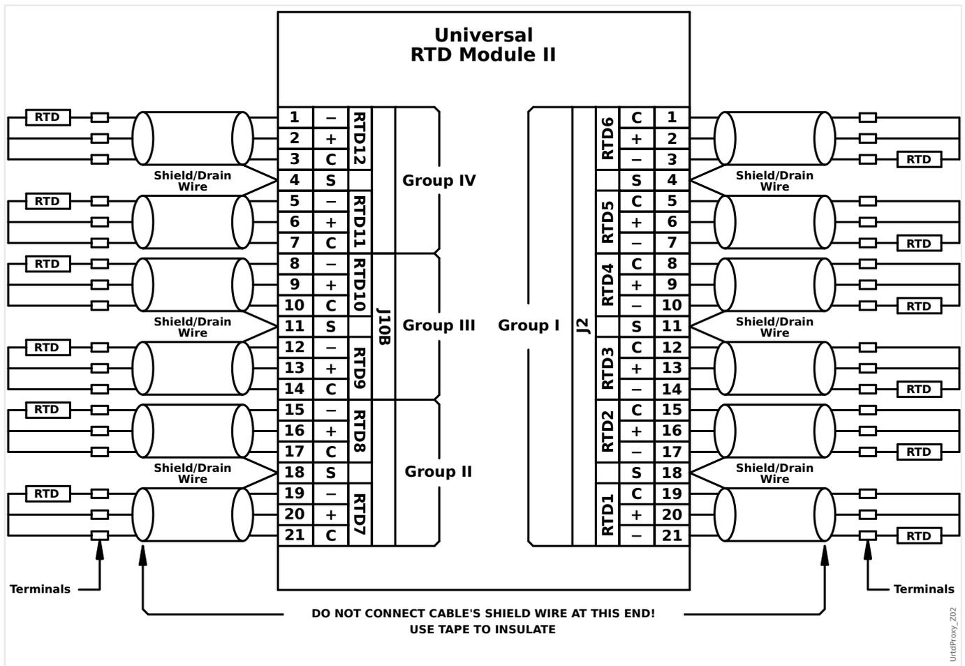
Das Diagramm zeigt die URTDII-Eingänge mit zugehörigen Anschlüssen. Es ist abgeschirmtes Kabel mit drei Adern zu verwenden und wie abgebildet anzuschließen. Wenn ein RTD-Messfühler mit zwei Anschlüssen eingesetzt wird, wird einer der RTD-Anschlüsse mit zwei URTDII-Eingängen verbunden, wie hier abgebildet. Hierbei sollte der Verbindungsknoten so nahe wie möglich am Schutzobjekt liegen.
