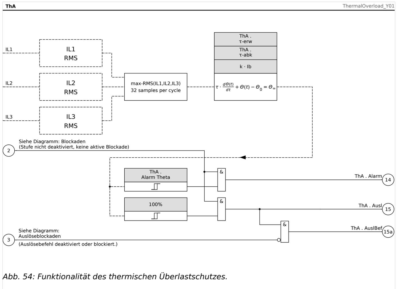
Abb. 54: Funktionalität des thermischen Überlastschutzes.
