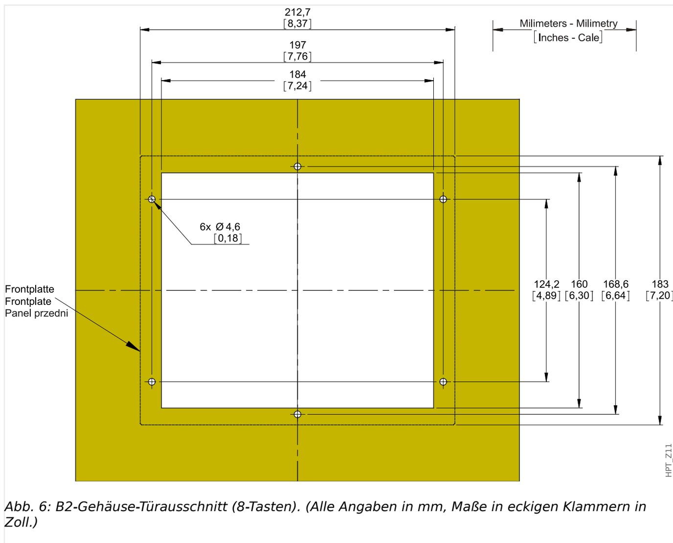
Abb. 6: B2-Gehäuse-Türausschnitt (8-Tasten). (Alle Angaben in mm, Maße in eckigen Klammern in Zoll.)
