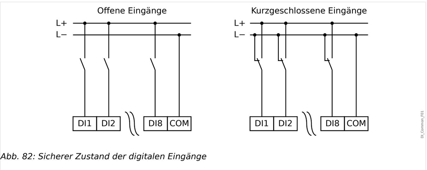
Abb. 82: Sicherer Zustand der digitalen Eingänge
