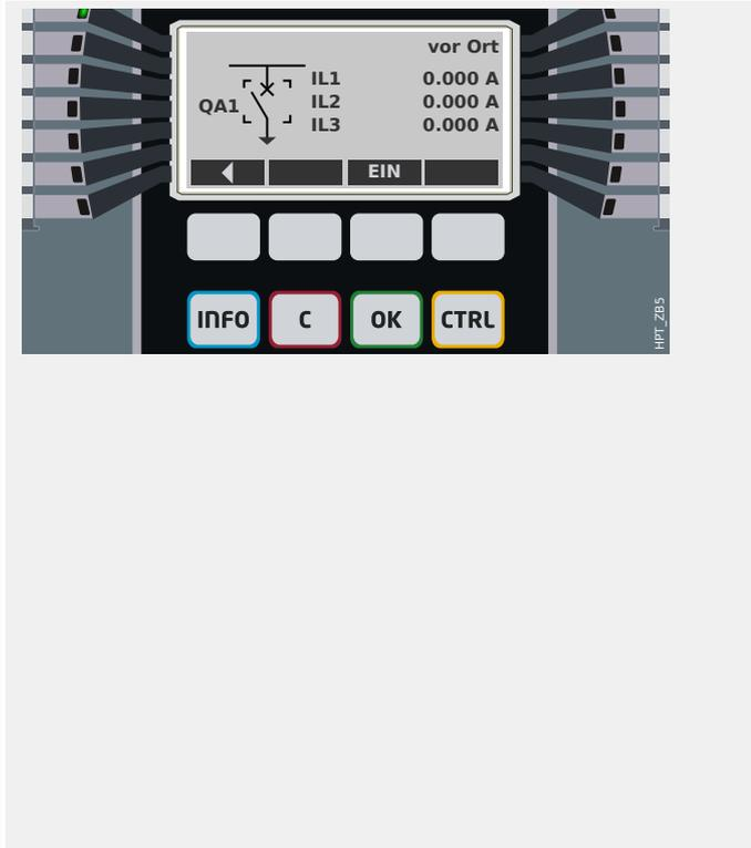
Über den Softkey „►“ (Enter) erreicht man ein erweitertes Abzweigsteuerbild (nachdem das Passwort für den Zugriffsbereich „Strg-Lv1“ eingegeben worden ist); hier ist nun ein Betriebsmittel durch kleine Ecken markiert und dadurch als „ausgewählt“ gekennzeichnet. Falls mehrere Betriebsmittel unterstützt werden, ist außerdem der Softkey „Ausw“ sichtbar, über den (zyklisch durchrotierend) ein anderes Betriebsmittel angewählt werden kann.
