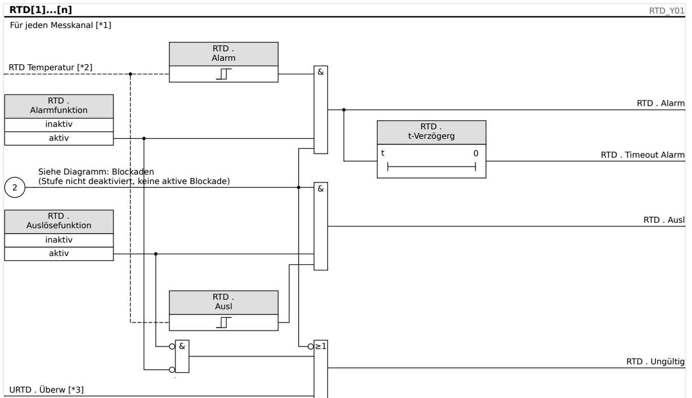
Abb. 57: Generelles RTD-Funktionsprinzip.
