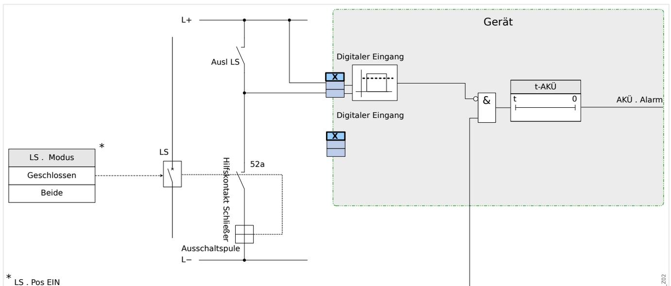
Abb. 59: Anschlussbeispiel: Auslösekreisüberwachung mit einem Hilfskontakt »Hiko EIN« (52a).
