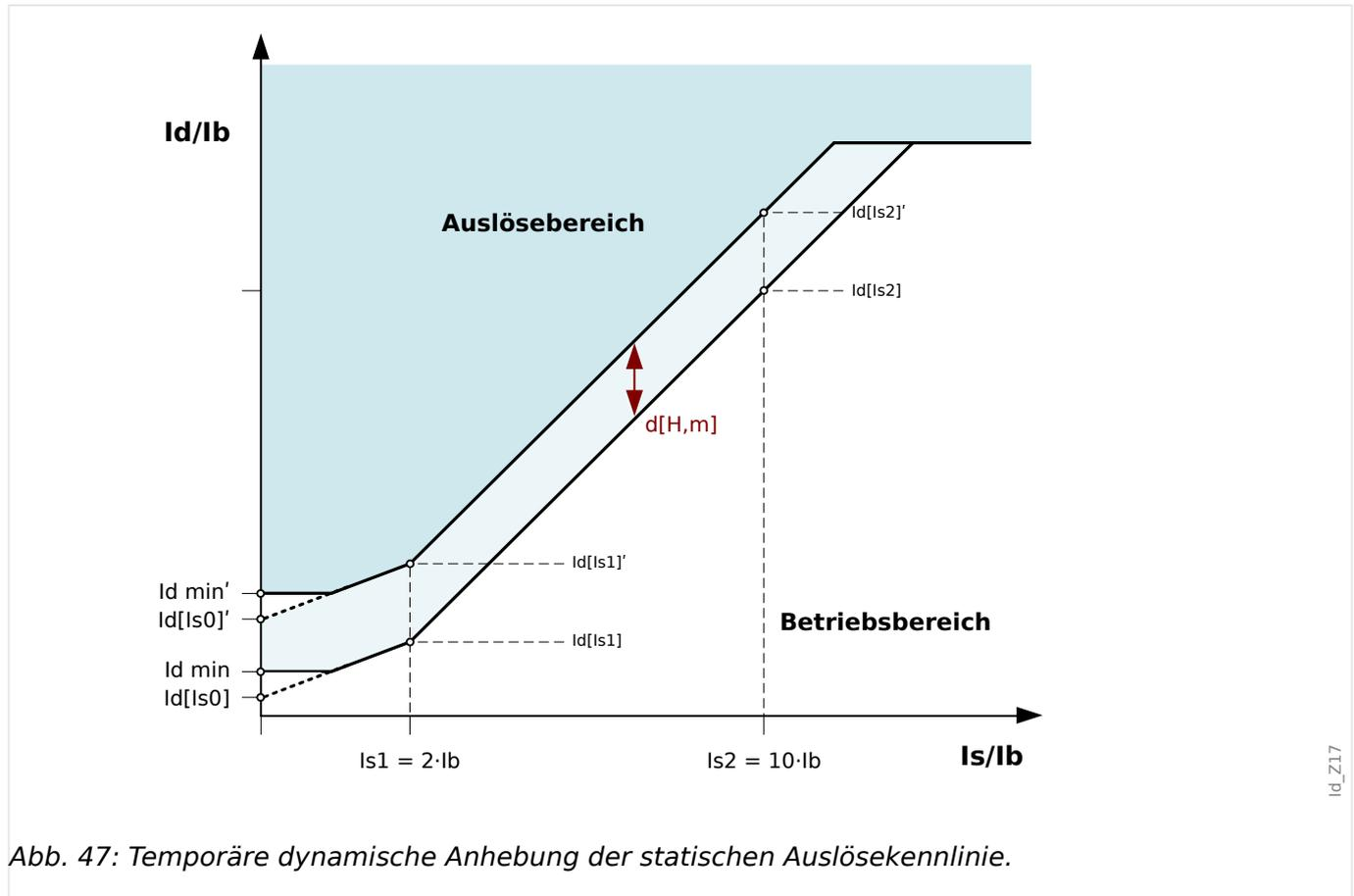
Abb. 47: Temporäre dynamische Anhebung der statischen Auslösekennlinie.
