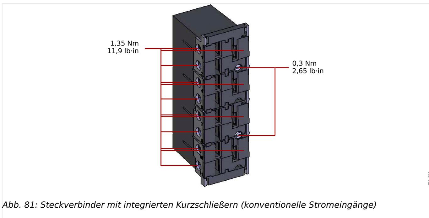
Abb. 81: Steckverbinder mit integrierten Kurzschließern (konventionelle Stromeingänge)
