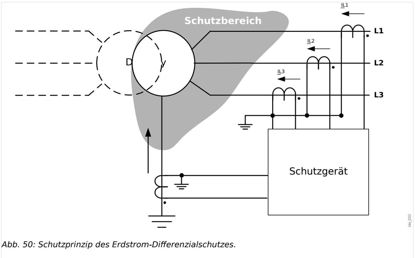
Abb. 50: Schutzprinzip des Erdstrom-Differenzialschutzes.
