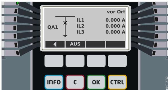
Abb. 61: Beispiel einer Steuer-Seite mit geschlossenem „Leistungsschalter“.
