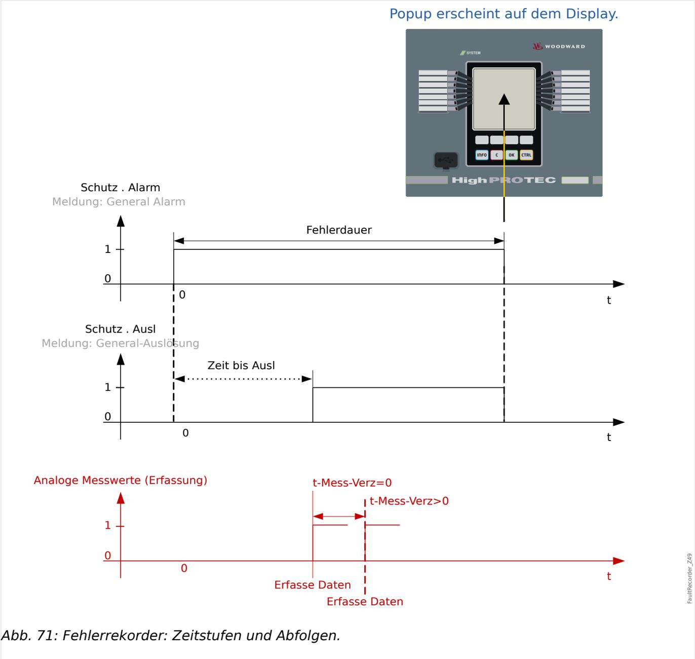
Abb. 71: Fehlerrekorder: Zeitstufen und Abfolgen.
