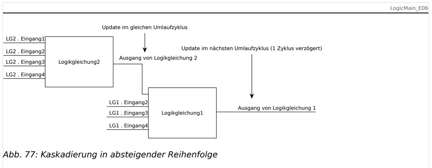
Abb. 77: Kaskadierung in absteigender Reihenfolge
