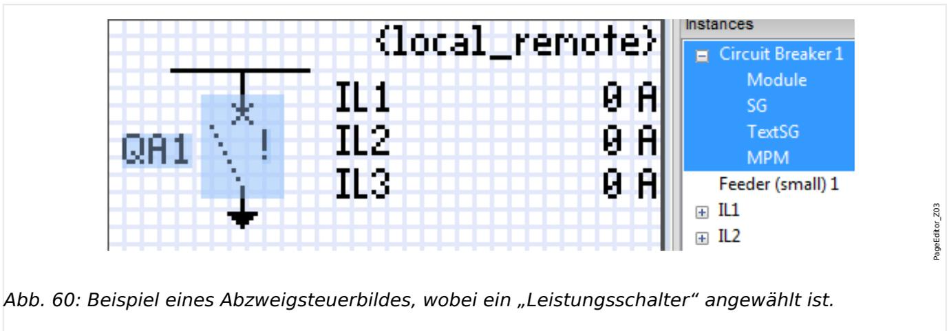
Abb. 60: Beispiel eines Abzweigsteuerbildes, wobei ein „Leistungsschalter“ angewählt ist.
