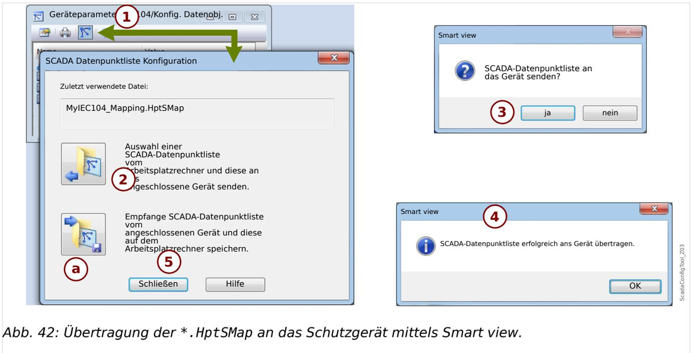
Abb. 42: Übertragung der \*.HptSMap an das Schutzgerät mittels Smart view.
