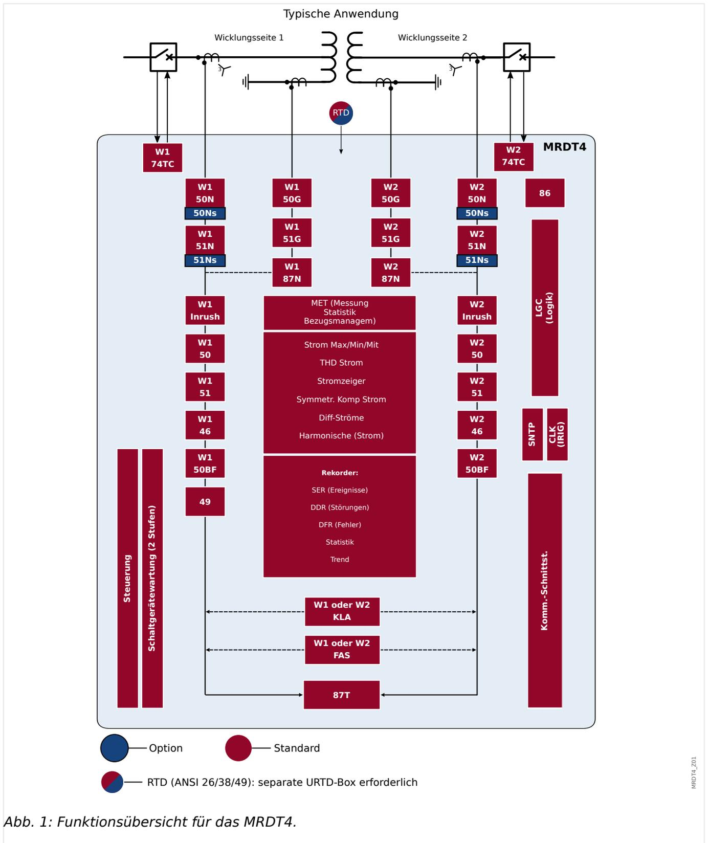
Abb. 1: Funktionsübersicht für das MRDT4.
