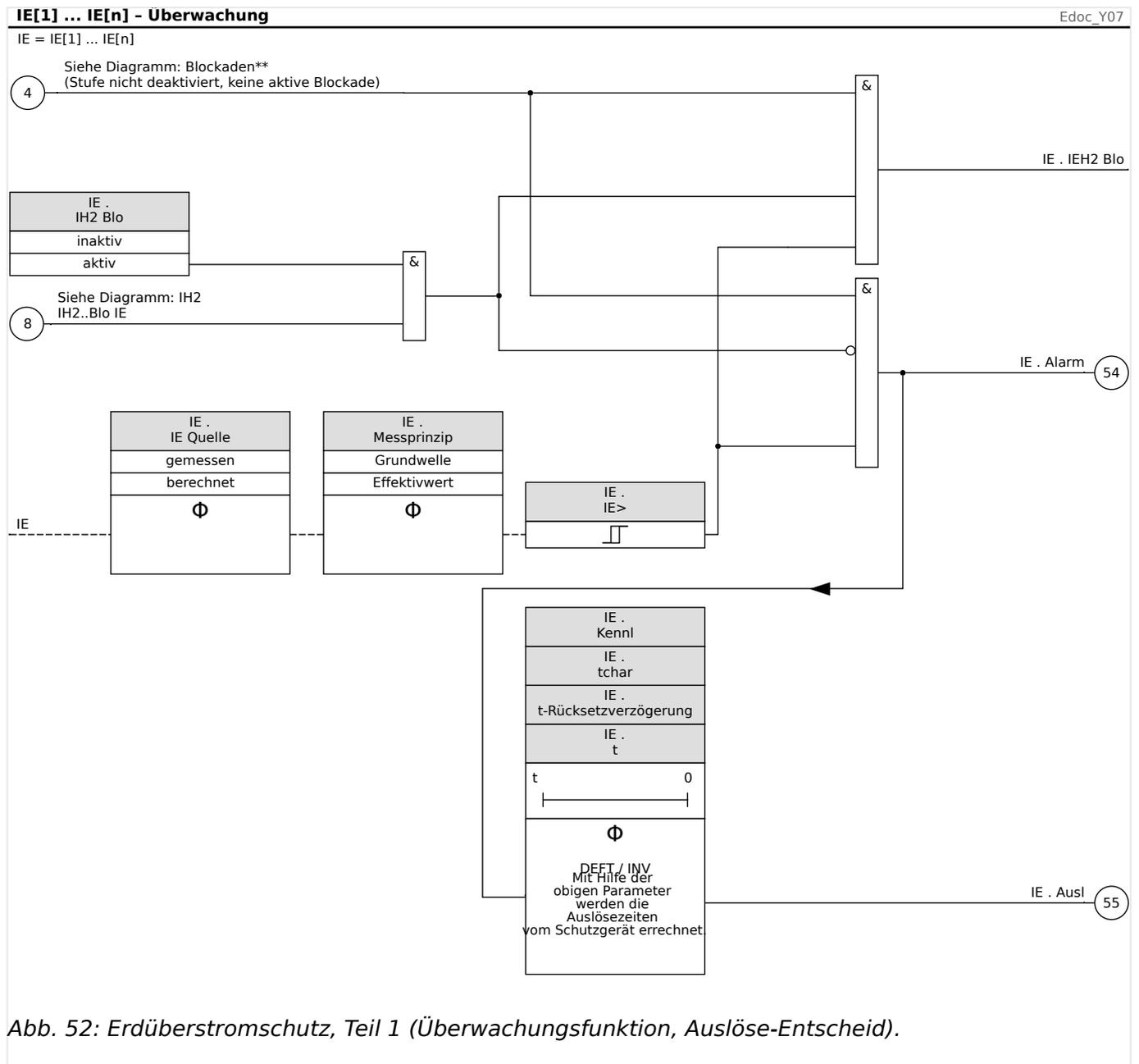
Abb. 52: Erdüberstromschutz, Teil 1 (Überwachungsfunktion, Auslöse-Entscheidung).
