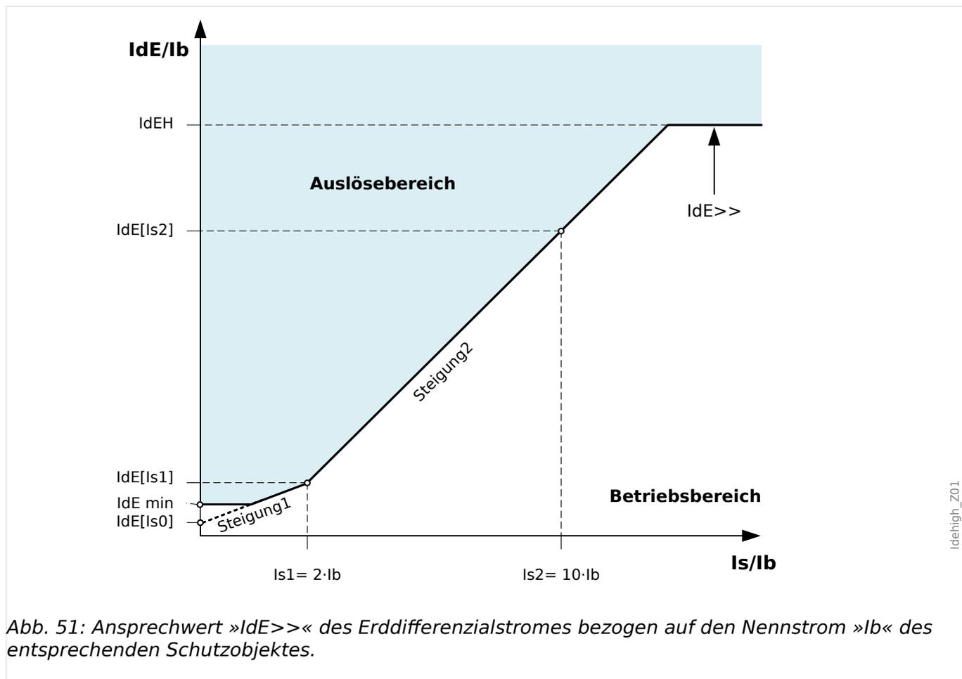
Abb. 51: Ansprechwert » $I_{dE} \gg$ « des Erddifferenzialstromes bezogen auf den Nennstrom » $I_b$ « des entsprechenden Schutzobjektes.
